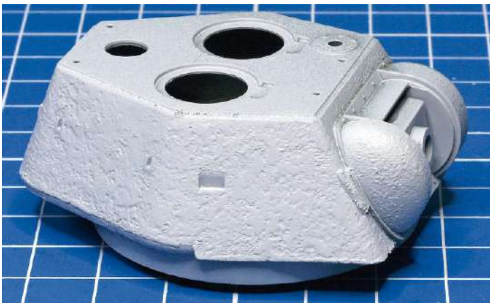
5 Nach Aushärten die Oberflächen vorsichtig anschleifen, bis die gewünschte Struktur entsteht – oder erneut Paste auftupfen
