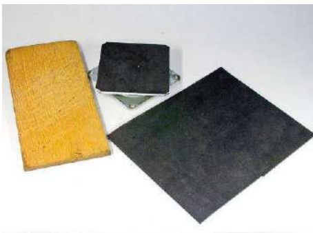
Teller zwei, bis auf das Kugellager reduziert, unten mit Antirutsch-Pads, oben Moosgummi. Das Brett dient für Arbeiten an größeren Modellen
