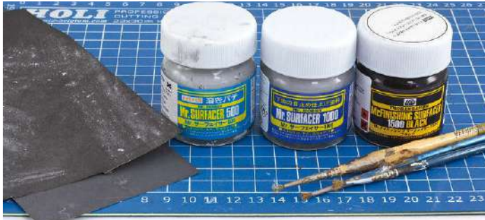
1 Arbeitsmaterial sind Pasten wie Mr. Surfacer 500, 1000 und 1500, wasserfestes Schleifpapier, Körnung 320 und 600, sowie alte Pinsel
