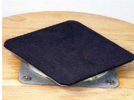
Die größere, obere Platte ist hier abgeschraubt, auf dem drehbaren Metallteil klebt nun Moosgummi als Antirutschschicht
