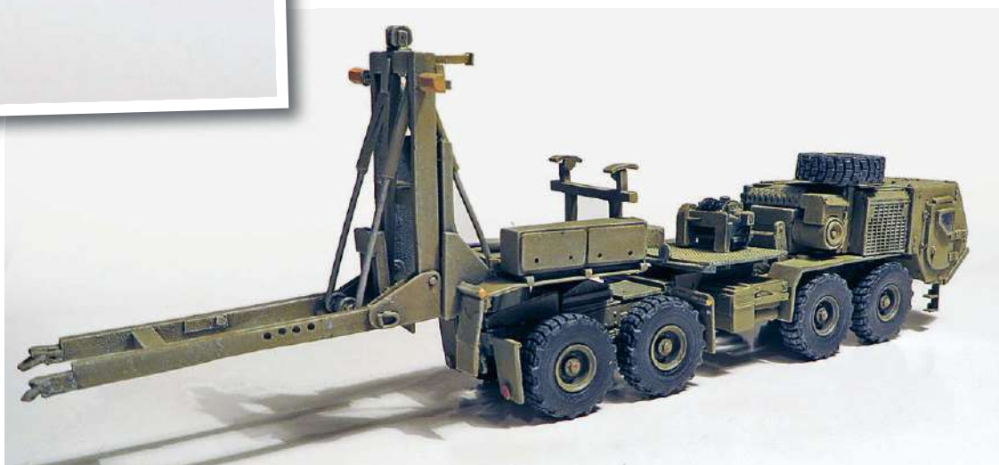
XM1250 FWDRT – eine Vorrichtung, die aus jedem Sattelschlepper einen Abschleppwagen macht. Hier mit M983A4LET, Trident 1:87
