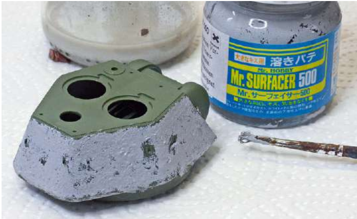
3 Struktur aus der Flasche: Mit einem Borstenpinsel unregelmäßig Mr. Surfacer 500 von Mr. Hobby auf die Oberflächen auftupfen
