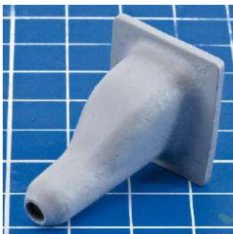
7 „Saukopfblende“: Der Guss war zu glatt, deutliche Unregelmäßigkeiten wirken realistisch
