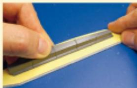
**6** Die Unterseite der beiden einseitigen seitlichen Schürzen wird auf einer plan liegenden Feile geglättet
