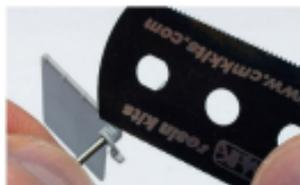
**16** Mit einer feinen Resin-Säge, Geduld und Geschick lässt sich die Spiralfederung an diesem Bauteil vorbildgerecht nacharbeiten
