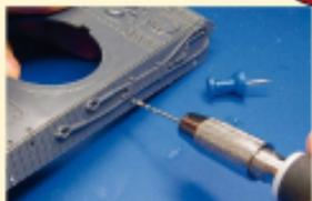
**3** Sollten die Seitenschützen zum Einsatz kommen, sind Löcher zu bohren: von innen ankrömen und von außen durchbohren
