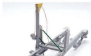
**15** Die Stützverstrebung am Reserveradkran aus 0,8-Millimeter-Blumendraht, das Halteseil aus 0,3-Millimeter-Kupferdraht
