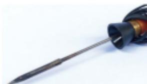
**8** Ein feiner Lötkeil mit regelbarer Temperatur lässt sich sehr gut zur Darstellung der Schweißnähte an der Wanne einsetzen
