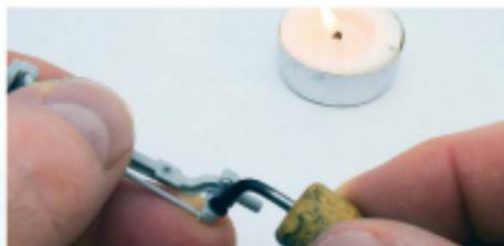
**7** Heiß vernietet, bleibt die Lenkung nach der Lackierung sogar beweglich. Das klappt auch mit einer Skalpell- oder Schraubendreher-Klinge
