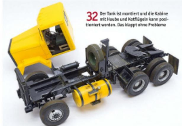
**32** Der Tank ist montiert und die Kabine mit Haube und Kotflügeln kann positioniert werden. Das klappt ohne Probleme
