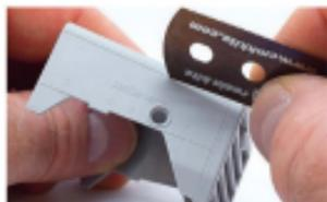
**1** Mit einer feinen Resin-Säge lassen sich die sehr flachen Fugen noch etwas nachziehen, um sie deutlich sichtbar darzustellen
