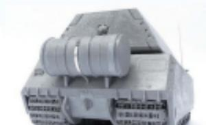
**17** Die nicht korrekte und hier verfeinerte Halterung aus dünnem Aluminiumblech des 1.000-Liter-Zusatztanks am Heck
