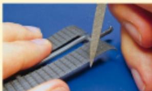
**5** An den Glis Ketten müssen Grate an zurückliegenden Bereichen entfernt werden. Dazu eignet sich gut eine Schlüsselstelle
