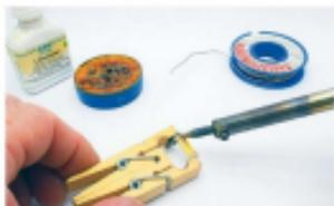
**11** Auch das ist eine Art, zu „löten“: ein Lötkeißen dient dazu, Ätzelemente miteinander dauerhaft und stabil zu verbinden
