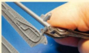
**2** Die Teile sind schön stabil ausgeführt. So sollte man beim Abtrennen idealerweise den Seltenschneider verwenden
