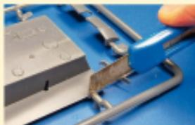
**1** Die meisten Angüsse, wie hier an der Unterwanne, sind dünn und lassen sich leicht mit einem Cutter-Messer lösen
