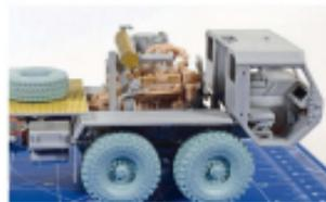
**9** Die richtige Einbauhöhe des Motorhalters ist wichtig, damit das Triebwerk später in einem flachen Winkel von zirka 80 Grad sitzt
