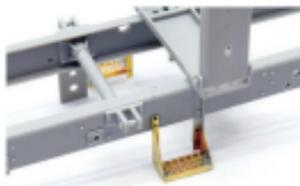
**13** Weitere Trittstufen am Rahmen, ebenfalls „weich“ gelötet und dann mit Schraubenattrappen und Klebstoff befestigt
