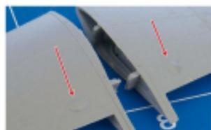
**6** Die Sinkstellen füllt man am besten mit Sekundenkleber, der sich gut verschleifen lässt und eine harte Oberfläche aufweist
