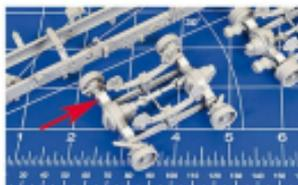
**1** Bremszylinder im Winkel von 45 Grad anbringen. Statt aufwendig zu verschleifen, je ein Stück Sheet auf die Achsenden kleben
