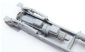
**3** Kein Motor: Die erste Passprobe hat die Ölwanne mit dem Getriebe bestanden, alles fügt sich sauber in den Rahmen ein
