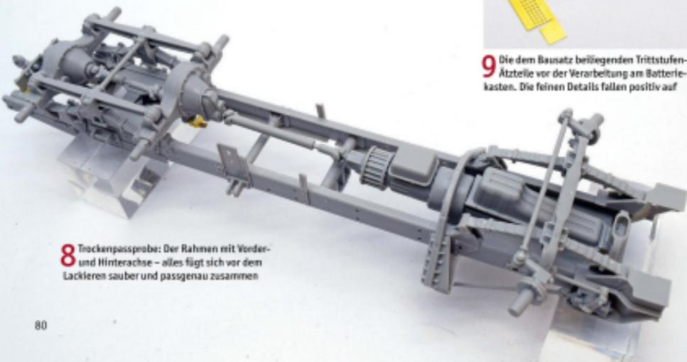
**8** Trockenpassprobe: Der Rahmen mit Vorder- und Hinterachse – alles fügt sich vor dem Lackieren sauber und passgenau zusammen
