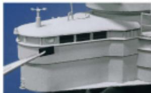
**14** Einsetzen der selbst gefertigten Schelben in die Brückenfenster
