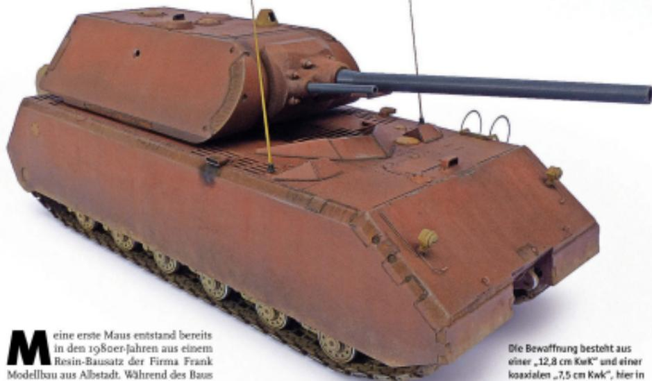
Die Bewaffnung besteht aus einer „12,8 cm KwK“ und einer coaxialen „7,5 cm KwK“, hier in Grau lackiert, sowie einem MG
