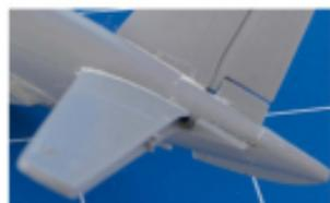
**8** Das V-Leitwerk passt hervorragend. Kleine Spalte werden verschpachtelt und mit einem in Alkohol getränkten Wattestäbchen geglättet
