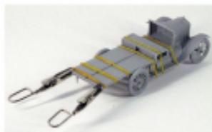
**2** Das Chassis lässt sich zum Beispiel mit Klammern und Gummiringen an den Bodenplatten recht einfach ausrichten
