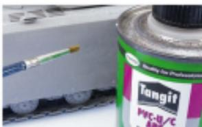
**13** Die großen Flächen lassen sich gut mit Tangit, einem PVC-U-Klebstoff und Reiniger, aufweichen und so sehr leicht strukturieren
