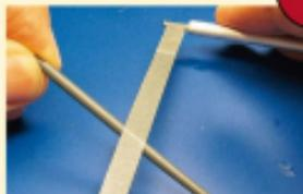
**3** Das Rohr hat eine Mittelnaht. Damit es nicht plattgefellt wird, bedient man sich eines entsprechenden Schleifwerkzeugs
