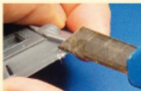
**1** Glatte Kanten kann man schnell mit einem Cutter entgraten. Den Dornen zur Hilfe nehmen, mit wenig Druck agieren
