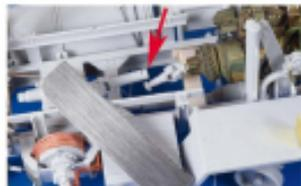
**20** Die Kardanwelle für den neuen Motor ist um zwei Millimeter zu kürzen, sie ist später unter der Arbeitsbühne gut zu sehen
