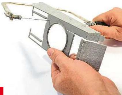
**1** Auf den Teilen der Panzerwanne werden die Schnittlinien markiert und danach die Säge angesetzt
