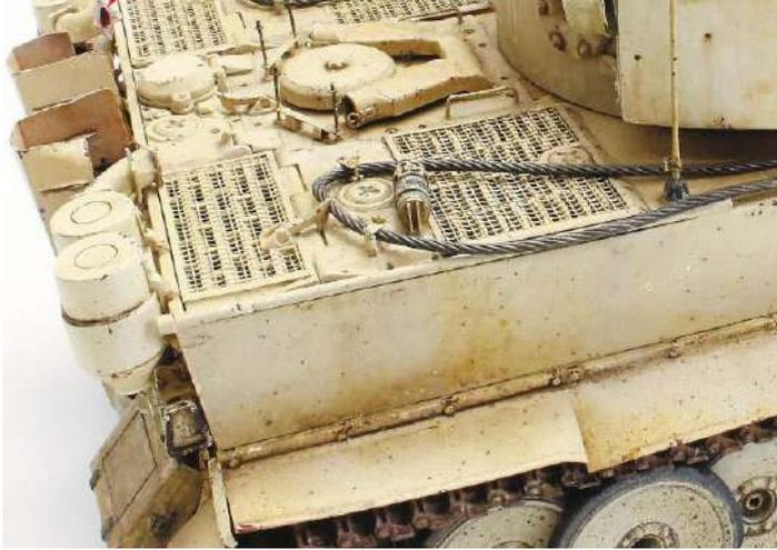
Stellt man die Luftschläuche der Feifel-Filter demontiert dar, unbedingt die Verbindungspunkte an den Filtern aufbohren
