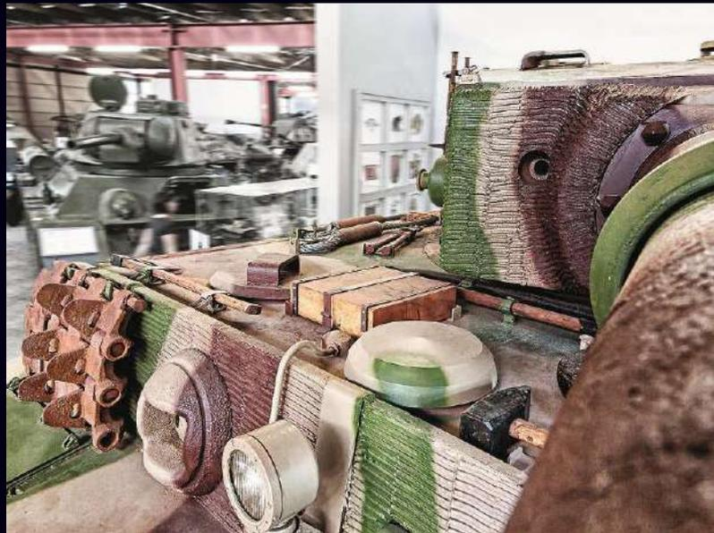
Links befindet sich die Kugelpfanne des Bug-MG, das der Funker bediente. Der Fahrer saß rechts daneben. Beiden stand eine eigene Einstiegsluke zur Verfügung
