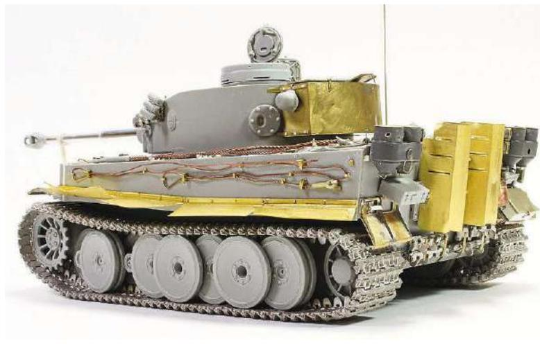
Die 0,6-Millimeter-Kupferseile von Karaya ermöglichen eine sehr realistische Nachbildung des seitlichen Kettenaufziehseils
