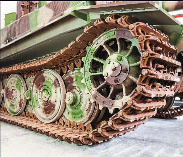
Das höhere Gewicht und die breiteren Ketten machten zusätzliche Laufrollen erforderlich. Insgesamt sorgte das Schachtellaufwerk für eine gute Federung
