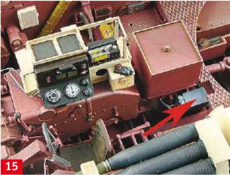
**15** Der kleine graue Kasten neben dem viereckigen Ölvorratsbehälter ist der Umwandler für den Kreiselkompass. Das Teil fehlt im Bausatz
