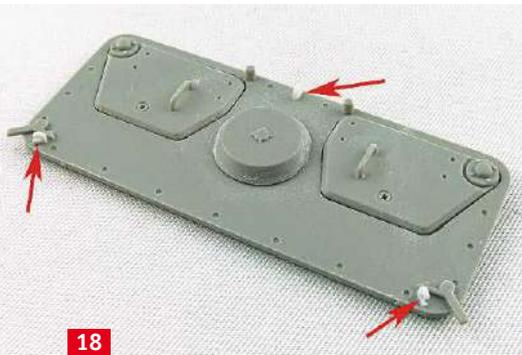
**18** Die zu dünnen geätzten Hebeösen an der Abdeckung des Fahrer- und Funkerbereichs sind hier, optisch überzeugender, ersetzt
