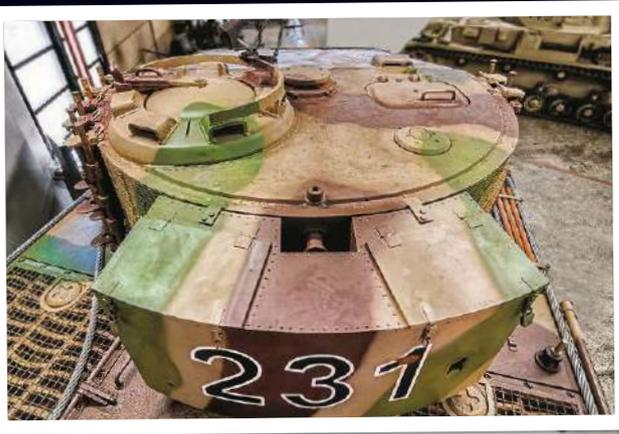
Der Heckkasten des Turms (links) diente als „Gepäck-ablage“ für die Besatzung. Die aufmontierten Gleisketten (unten) fungierten als zusätzlicher Panzerschutz
