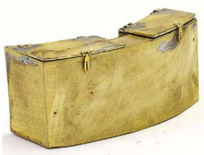
Bei größeren Ätzteilen wie der Staukiste empfiehlt sich ein Verlöten. Überschüssiges Lötzinn ist immer abzuschleifen
