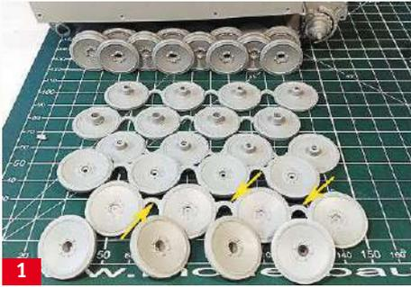
**1** Die innovative Laufrollen-Montage ergibt im Ergebnis ein sauber ausgerichtetes Fahrwerk, hier nur Probe-weise an der Wanne montiert
