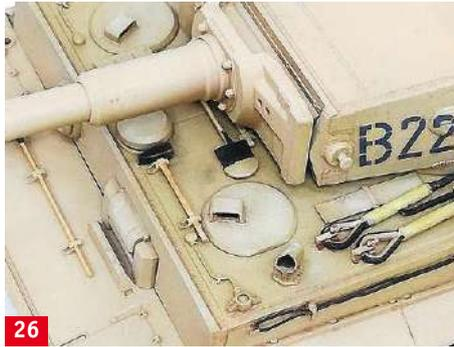
**26** Die erste Alterung durch einen Filter. Auch spätere Bauausführungen zeigten die Verstärkung der Blende im Bereich der Richtschützenoptik
