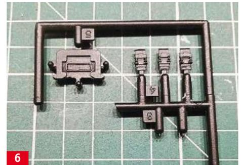
**6** Winkelspiegel und Fahrersichtblende in der passenden schwarzen Farbe, grundiert nach Maskierung mit Tamiya-Tape mit Mr. Surfacer 1500 black
