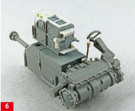
**6** Hier sollte man sich auf alte Modellbauer-Fähigkeiten besinnen: die Getriebeeinheit mit den deutlich scratch überarbeiteten Funkgeräten
