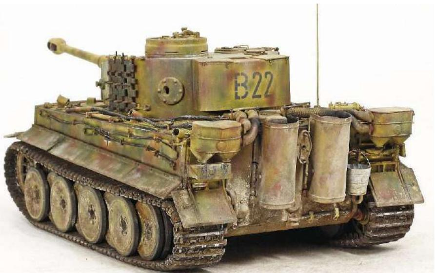
Die Behälter rechts und links außen am Heck waren Bestandteil des Feilfiltersystems und wurden bis Dezember 1943 an den Tiger I verbaut
