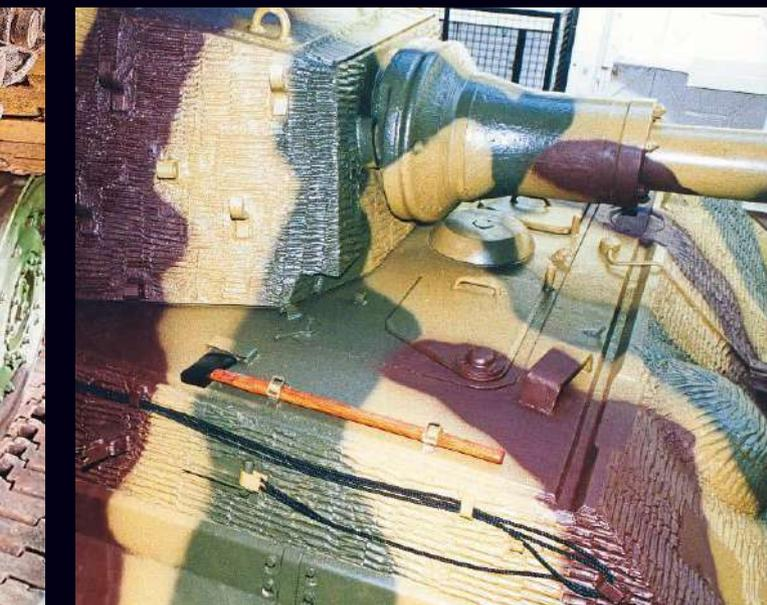
Die Panzerplatte der Turmfront ist um 80 Grad geneigt und 185 Millimeter stark (!). Die um 69 Grad geschrägten Seiten kommen immerhin auf 80 Millimeter
