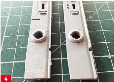
**4** Nach dem Abschleifen ergibt sich eine feine Struktur. Beide Frontplatten liegen dem Kit bei, an diesem Baucos kommt die rechte Platte zum Einbau
