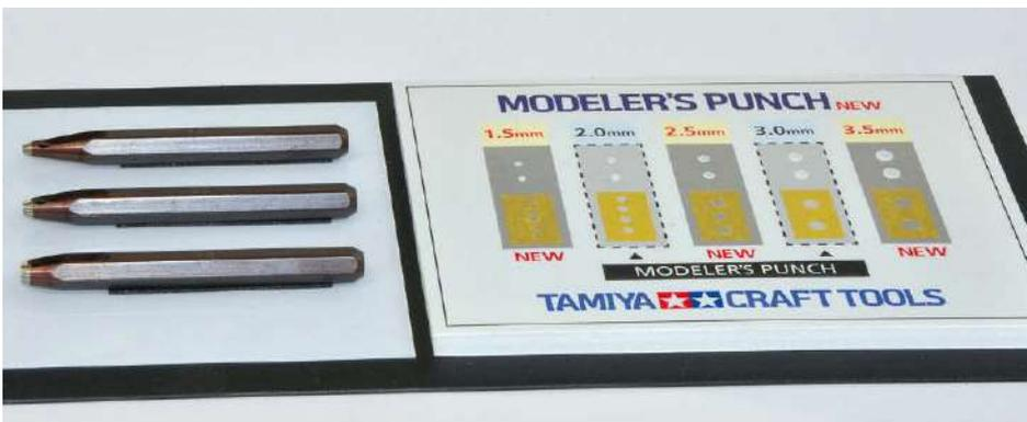
Tamiya-Werkzeug ist weltweit verbreitet und hat einen hervorragenden Ruf. Hier Lochpfeifen verschiedener Durchmesser zum Ausstanzen von Kreisen aus Plastikplattenmaterial
