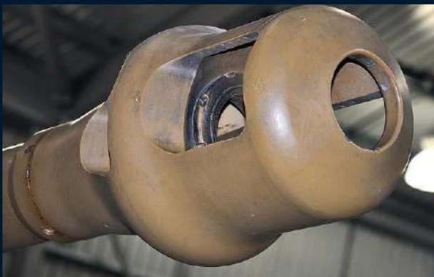
Nahaufnahme der aufgeschraubten Mündungsbremse der KwK 36 L/56 (KwK steht für Kampfwagenkanone)
