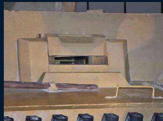
Fahrsichtluke vorne links. Der Tiger I war der erste mit einem „Lenkrad“ gesteuerte deutsche Kampfpanzer
