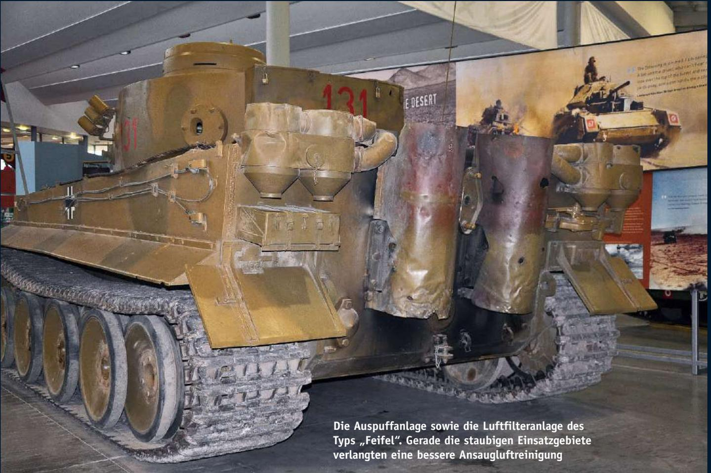
Die Auspuffanlage sowie die Luftfilteranlage des Typs „Feifel“. Gerade die staubigen Einsatzgebiete verlangten eine bessere Ansaugluftreinigung
