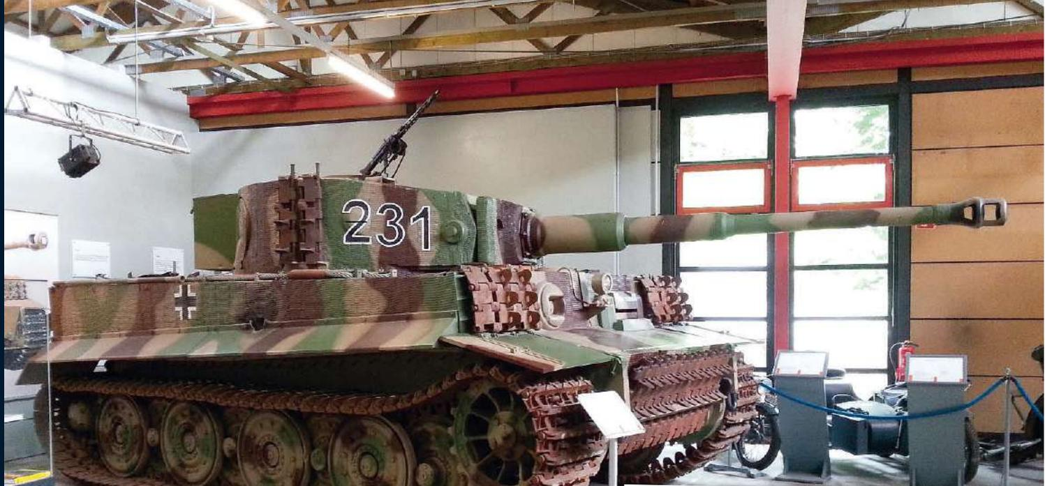
**Tiger 231 im Panzermuseum Munster.** Er ist mit den späteren Stahllaufrollen ausgestattet. Lauter, aber haltbarer galt für diese Laufwerkkonstellation, bei der auch auf die äußersten Laufdrumscheiben verzichtet werden konnte. Dieser Tiger I besteht zu zirka 90 Prozent aus Originalteilen mehrerer Fahrzeuge sowie rekonstruierten Teilen
