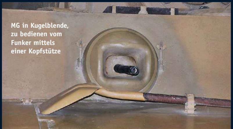
MG in Kugelblende, zu bedienen vom Funker mittels einer Kopfstütze
