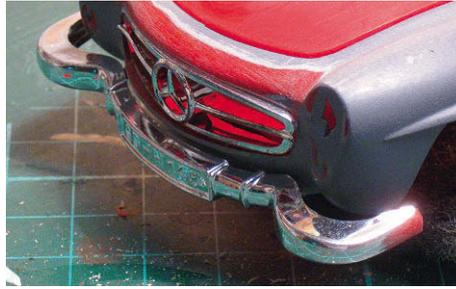
**2** Die beiden Stoßstangen sind deutlich überdimensioniert und müssen in Größe und Breite überarbeitet werden
