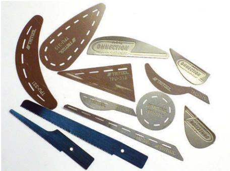
Für die Bearbeitung von Resin-Bausätzen bislang unerlässlich waren und sind diverse Sägen wie diese teils geätzten Exemplare
