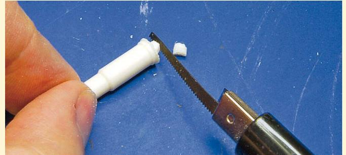
**5** Der Steckzapfen des Rohres ist für das vorgesehene Loch an der Rohrblende zu lang. Mit einer Mikrosäge einkürzen
