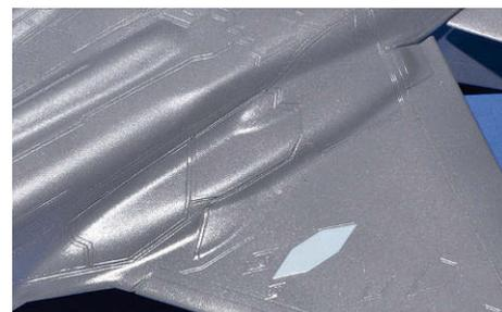
**24** Die überzähligen Klappen passen so gut, dass sie ohne Fixierung als Lackiermasken dienen. Das Decal dient als Farbmuster
