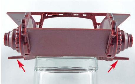
**1** Hier erkennt man deutlich den starken negativen Out-of-Box-Sturz der Schwingarme, den es unbedingt zu korrigieren gilt
