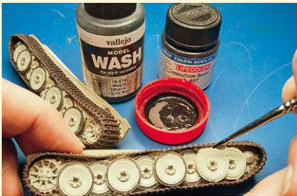
**4** Die Gummimantelungen lassen sich mit Acryl-Wash erstellen. Das verläuft entlang den Aufkantungen selbstständig
