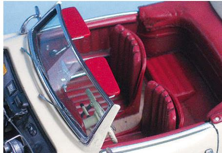
**18** Die Frontscheibe besteht aus transparenter Acetat-Folie. Exakt zugeschnitten, bedarf es keines Klebstoffes
