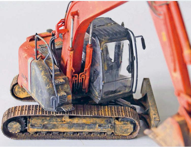
Auch die Hydraulikleitungen liegen dem Kit bei. Die einteiligen und flexiblen Strangkettens sind in diesem Maßstab ausreichend
