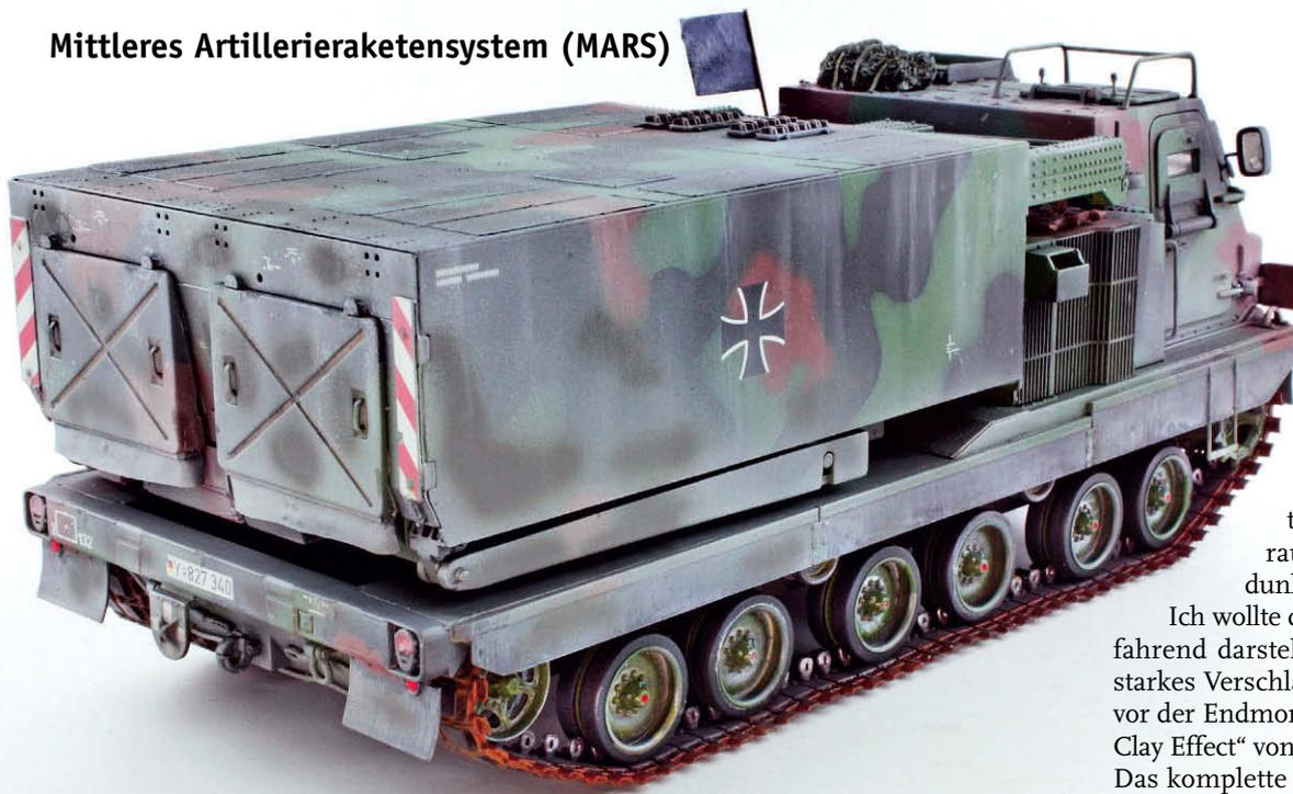
Die beiden großen Deckel, am Original bei längeren Straßenfahrten über die hinteren Öffnungen des Werfergehäuses gesetzt, fehlen im Kit und sind hier nach Fotos scratch nachgebaut
