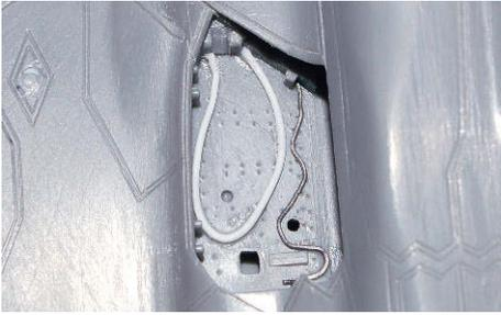
**14** Die fehlende Detaillierung der Schächte kann man mit einfachen Mitteln wie Plastikstäben und Bleidraht nachholen
