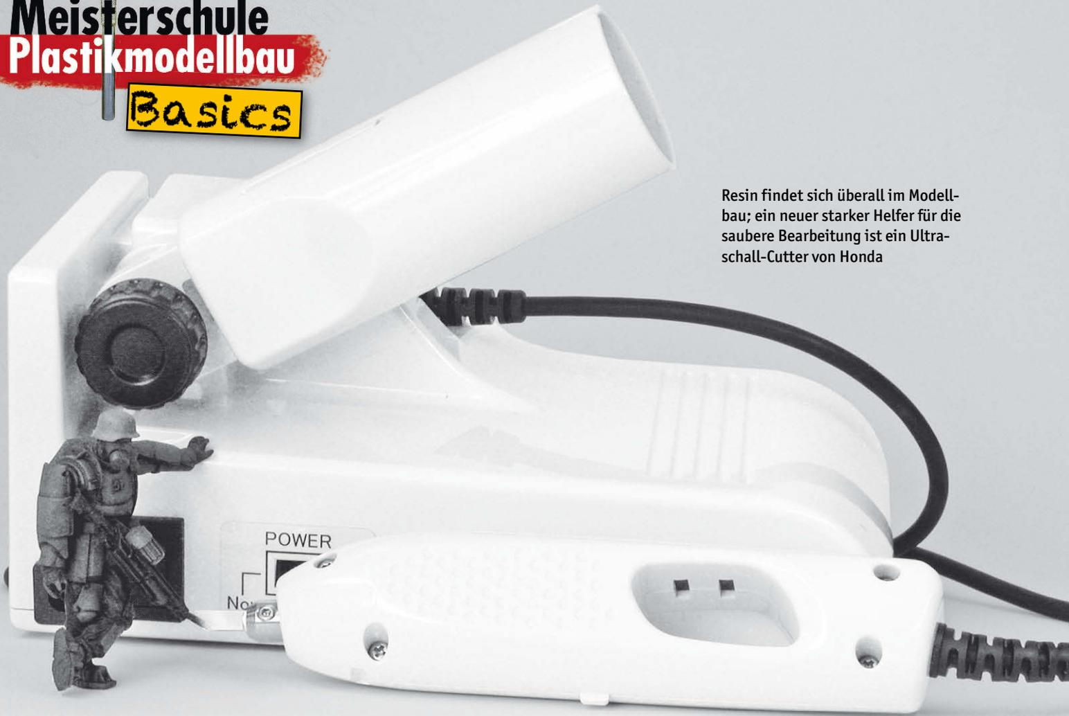
Resin findet sich überall im Modellbau; ein neuer starker Helfer für die saubere Bearbeitung ist ein Ultraschall-Cutter von Honda
