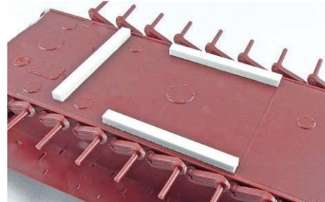
**3** Die Wanne wird auf 3,2 Millimeter hohe Plastikprofile gestellt, damit die Schwingarme später die richtige Stellung aufweisen
