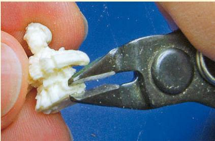
**1** Eine Trockenpassung der Figur ergibt, dass diese nachzuarbeiten ist. Mit einem Seitenschneider zurechtschneiden
