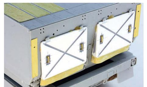
**11** Abdeckungen als Sandwich (zwei 0,5er-Plastikplatten). Die ausgeschnittenen Versteifungen mit Flüssigsachtel ausfüllen
