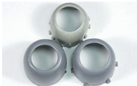
2 Korrigierte Motorcowlings: Oben das zu kleine Quickboost-Resinteil. Links unten ein normales, daneben ein modifiziertes Bausatzteil
