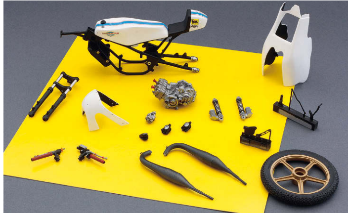
3 Die vorbereiteten Teile sind fertig zur Montage. Hier gilt besondere Vorsicht, um (Lack-)Schäden zu vermeiden
