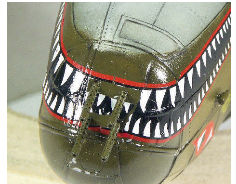
16 Leider waren die Decals schon älter und recht brüchig. Das machte sich insbesondere beim Haifischmaul am Bug bemerkbar
