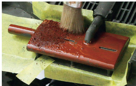
19 Struktur und Farbnuancen lassen sich mittels Pigmenten erzielen: mit breitem Pinsel in die noch feuchte Farbe „einstippen“
