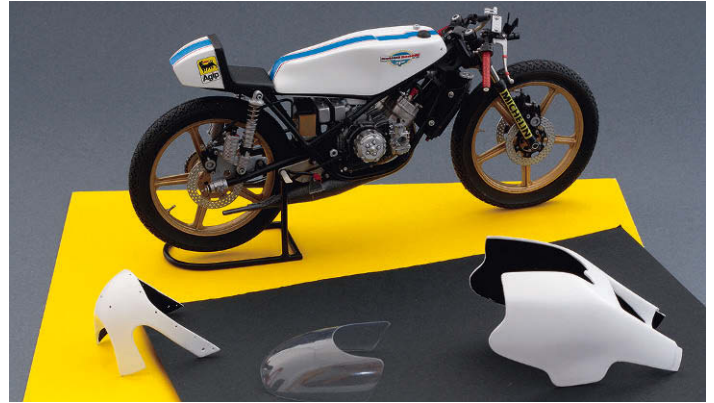
8 Farbe marsch: Die Teile der Karosserie können vor dem Zusammenbau weiß lackiert werden. Die blauen Flächen sind Decals
