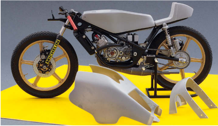
7 Testpassung: Die Karosserieteile sind grundiert, aber noch nicht lackiert. Die Passform ist aber perfekt
