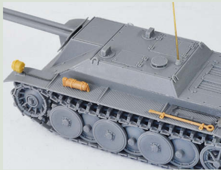
10b Boschfahrcheinwerfer, Feuerlöscher und Brecheisen werden auf der linken Kettenabdeckung nachgerüstet
