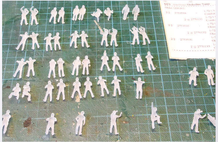
11 Drucksache: Die Figuren für die Besatzung kommen als 3D-Drucke von einem Dienstleister
