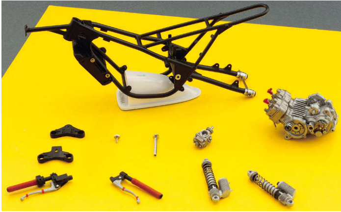
2 Der Motorblock wie auch die weiteren Kleinteile werden trocken angepasst, aber dann vor der Montage lackiert
