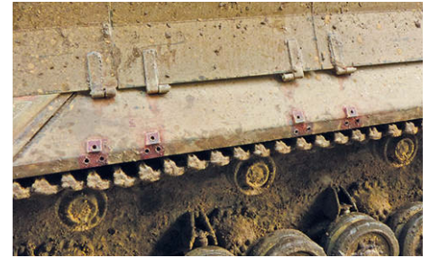
6 An den Stellen, an denen die Schürzen-Halterungen saßen, befinden sich nun Schraubenlöcher und Befestigungsplatten
