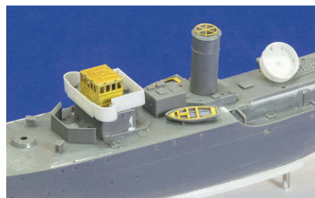
9 Die eigengebaute Plattform für das 40-Millimeter-Geschütz, die verbesserten Teile für Brücke, Schornstein und Beiboote
