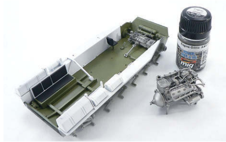
8 Motor und Getriebe werden vor dem Einbau mit „Engine Grime“ akzentuiert und gewinnen an Tiefe
