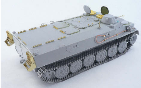
19 Die Ätzteile verbessern die Detaillierung, auch die Kette von Masterclub sollte man jetzt anpassen
