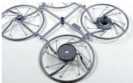
Große Feinheit: Die Felgenteile mit angespritzten Speichen sind schon große Formbaukunst
