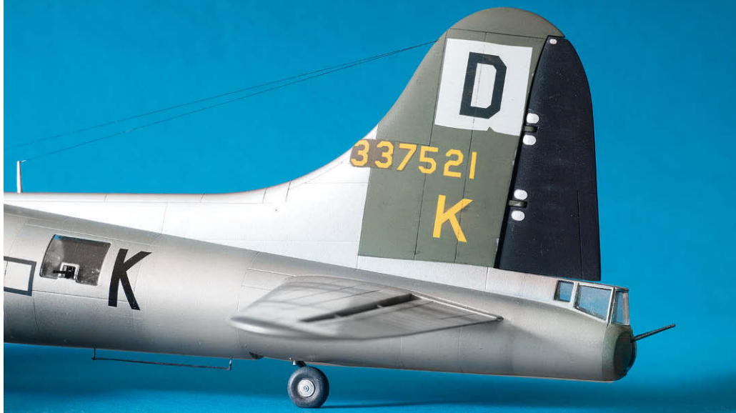
Die Ober- und Unterrumpfantennendrähte entstanden aus flexiblem Faden von Uschi van der Rosten. Die Ruder des Modells sind nur eingesteckt
