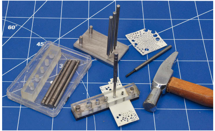
Wer es hat, nutzt es regelmäßig – das Punch-&-Die-Set, vorne für das Ausstanzen von runden Plättchen, dahinter die Sechskant-Version
