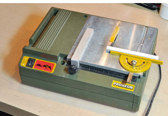
Für die Tischkreissäge gibt es verschiedene Blätter: diamantiert, aus Hartmetall (Vollmaterial), aus Spezialstahl oder Hartmetall-bestückt
