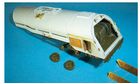
24 Etwas Gewicht im Tank des Aufliegers sorgt für den notwendigen „Boden-druck“, damit alle Räder den Boden erreichen
