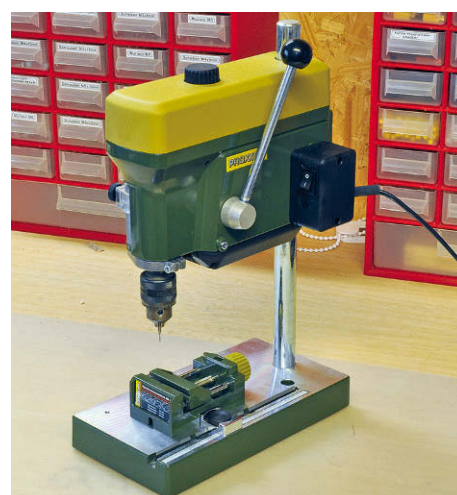
Die Alternative: statt eines Bohrständers zum Einspannen einer Kleinbohrmaschine eine Tischbohrmaschine (hier eine TBM 220)
