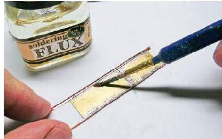
**2** Die zu verlötenden Teile mit Flussmittel benetzen. Es entfernt eine Oxidschicht und reinigt die zu verbindenden Flächen
