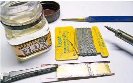
**1** Kettenabdeckungen lassen sich mittels LötKolben (15 bis 20 Watt) sowie Kupfer- und Messingblech auch selbst herstellen
