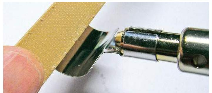
**2** In diesem Fall kommt ein Gas-LötKolben mit halbrundem Aufsatz zum Einsatz, der zum Anwärmen der Beschädigungsstelle dient
