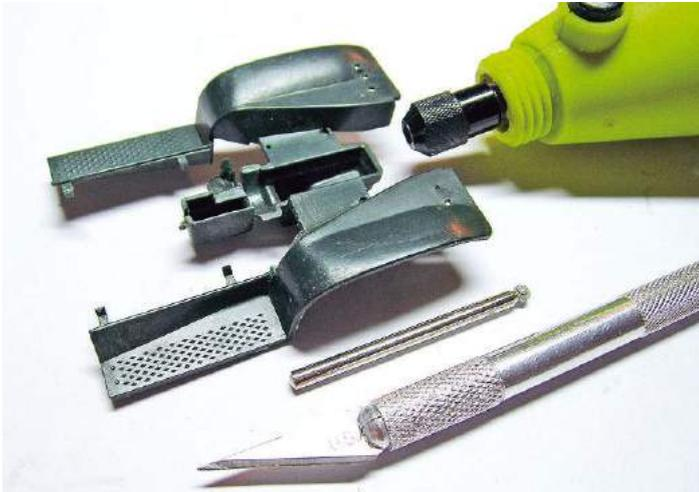
**1** Werkzeug: Minibohrmaschine, Kugelkopf-Fräser und Bastelmesser. Die Drehzahl muss regulierbar sein (Schmelzgefahr des Kunststoffes)
