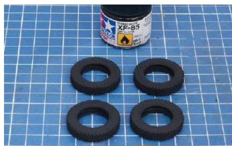
10 Die Gummireifen, nach der Grundierung mit Tamiya Fine Sufacer, mit XF-85 überlackiert, als Schutz vor Weichmachern
