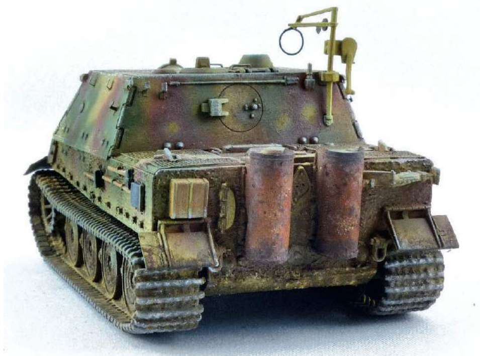
Der Sturmträger zeigt sich von allen Seiten beeindruckend dimensioniert. Der kleine Kran oben am Aufbau dient der Munitionsverladung
