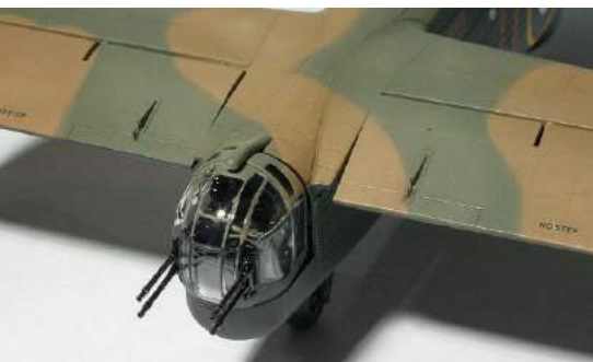
Der Heckabwehrstand mit den MG-Läufen aus Messing. Die Anlenkungen der Trimmklappen bestehen aus je drei Ätzteilen
