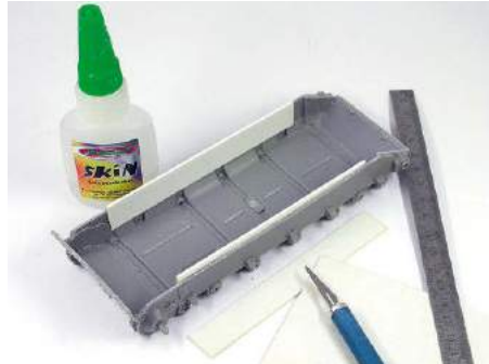
Damit beim Verkleben von Ober- auf Unterwanne die Seitenwände nicht verrutschen, zwei Streifen aus Plastic-Sheet einsetzen
