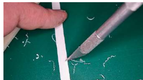
19 Arbeit, die sich lohnt: Auf jeden einzel-nen Kunststoff-Streifen lässt sich mit dem Skalpell eine Maserung aufbringen
