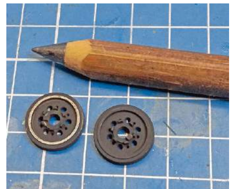
15 Die Innenseiten der Laufrollen sind einfacher mit Grafitstift zu bemalen, auch hier kann man Metallfarben einsetzen
