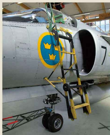
Eine Studie der ausklappbaren Einstiegsleiter für die Viggen
