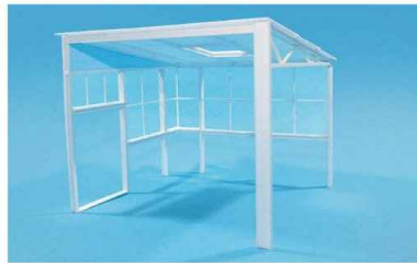
5 Das „Stahlskelett“ der Studiohalle besteht aus verschiedenen Polystyrolprofilen von Evergreen und Plastruct
