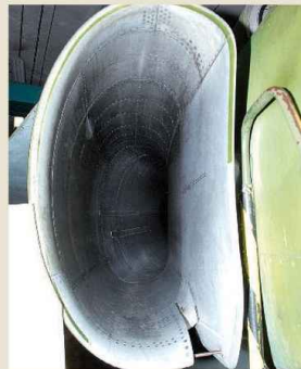
Frontaler Blick in den steuerbordseitigen Lufteinlass
