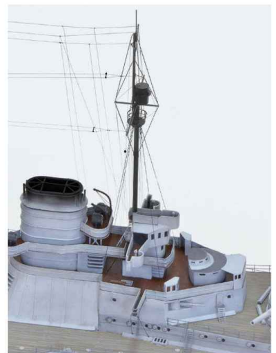
Wenn man genau schaut, erkennt man, dass der Mastkorb auch wichtig ist als Befestigungspunkt für Wanten und Stage
