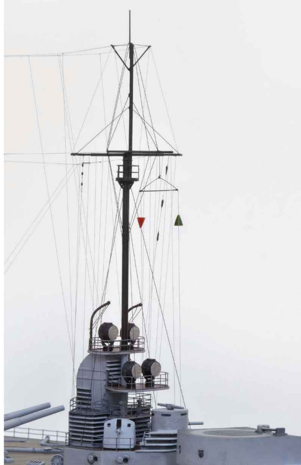
Auch der achtere Mast zeigt Wanten, Signalleinen und etliche Drähte, die zur Funkausrüstung des Schweren Kreuzers aus der Epoche des Ersten Weltkriegs gehören
