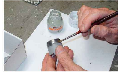
6 Der Ausstoß wurde vor dem Einbau mit Metallfolie verkleidet und versiegelt
