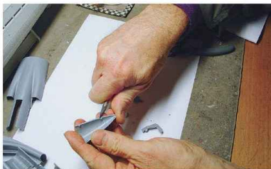
12 Vor dem Verkleben der Nasensektion entfernt der Autor die Passstifte
