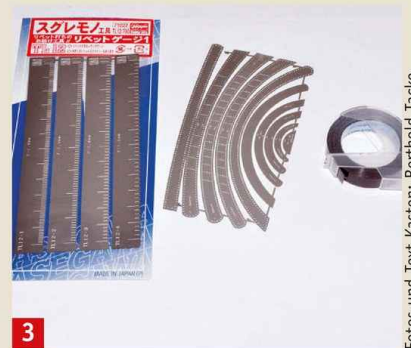
3 Zur Führung der Graviernadel sind neben dem Klassiker Dymoband (rechts) auch verschiedene Radien und flexible Lineale sehr geeignet
