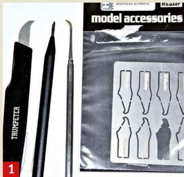
1 Eine Auswahl verschiedener Gravurwerkzeuge, die nicht nur im Handling, sondern auch im Schnittbild klar voneinander abweichen
