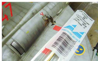
31 Die unteren und oberen Luftbremsen sind mit Aktuatoren von Albion Alloys ausgestattet
