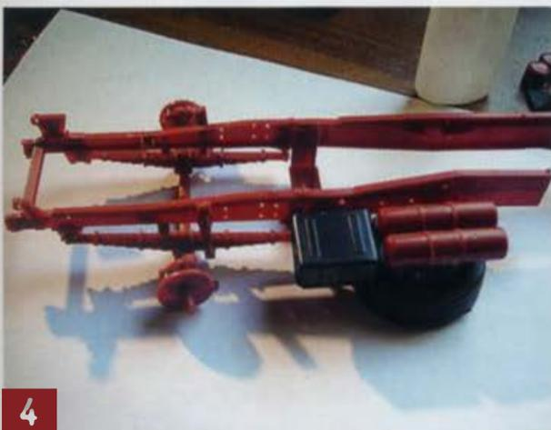
**4** Um die optimale Länge herauszufinden, wurden Batteriekasten, geänderte Luftkessel und die Ersatzradhalterung angebaut.
