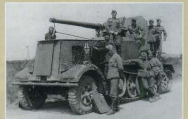
12-t-Zugmaschine mit 8,8 cm Flak 18 während eines technischen Halts.
