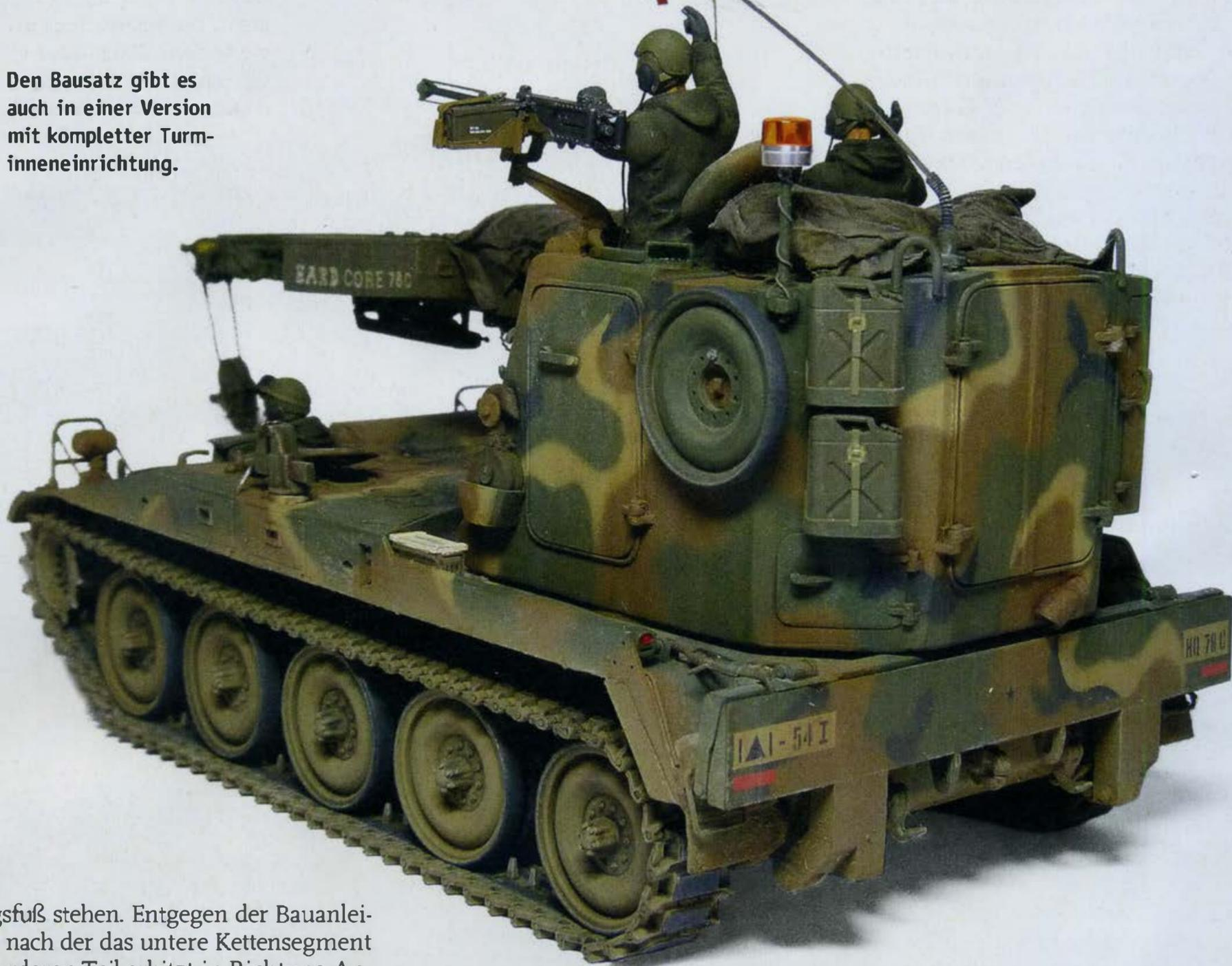
Kriegsfuß stehen. Entgegen der Bauanleitung, nach der das untere Kettensegment am vorderen Teil erhitzt in Richtung Antriebsrad gebogen werden soll, habe ich die beiden kurzen Segmente abgetrennt. Somit lassen sich die Ketten nach dem Bemalen leichter anbauen und wirken am Modell wesentlich realistischer (1).
