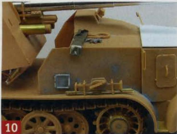
10 Unter der neuen Auflage für den Wagenheber auf der rechten Seite finden sich nun Wagenheber und Rohrreinigungsgestänge.
