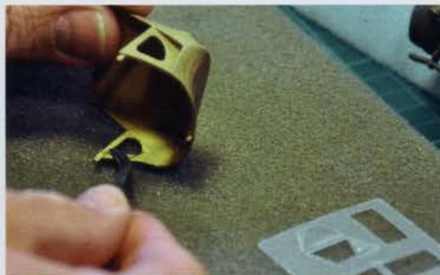
Klarsichtteile mit einer sauberen (!) Pinzette aufnehmen/einsetzen, mit einem anderen, nicht spitzen Werkzeug andrücken.
