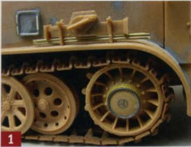
**1** Die Antriebsräder wurden mit einem geätzten Mercedes-Stern aus dem Automodellbau und einem Ring aus Bleidraht verfeinert.
