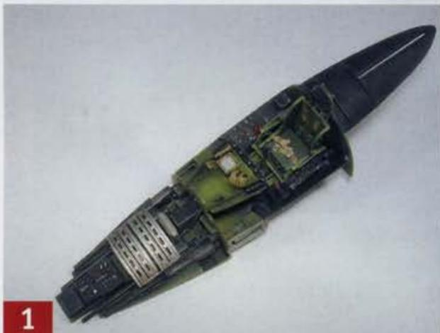
**1** Bugbewaffnung und Cockpit vor Einkleben in eine der Rumpfhälften zusammenfügen. Geätzte Gurte stammen aus der Restekiste.
