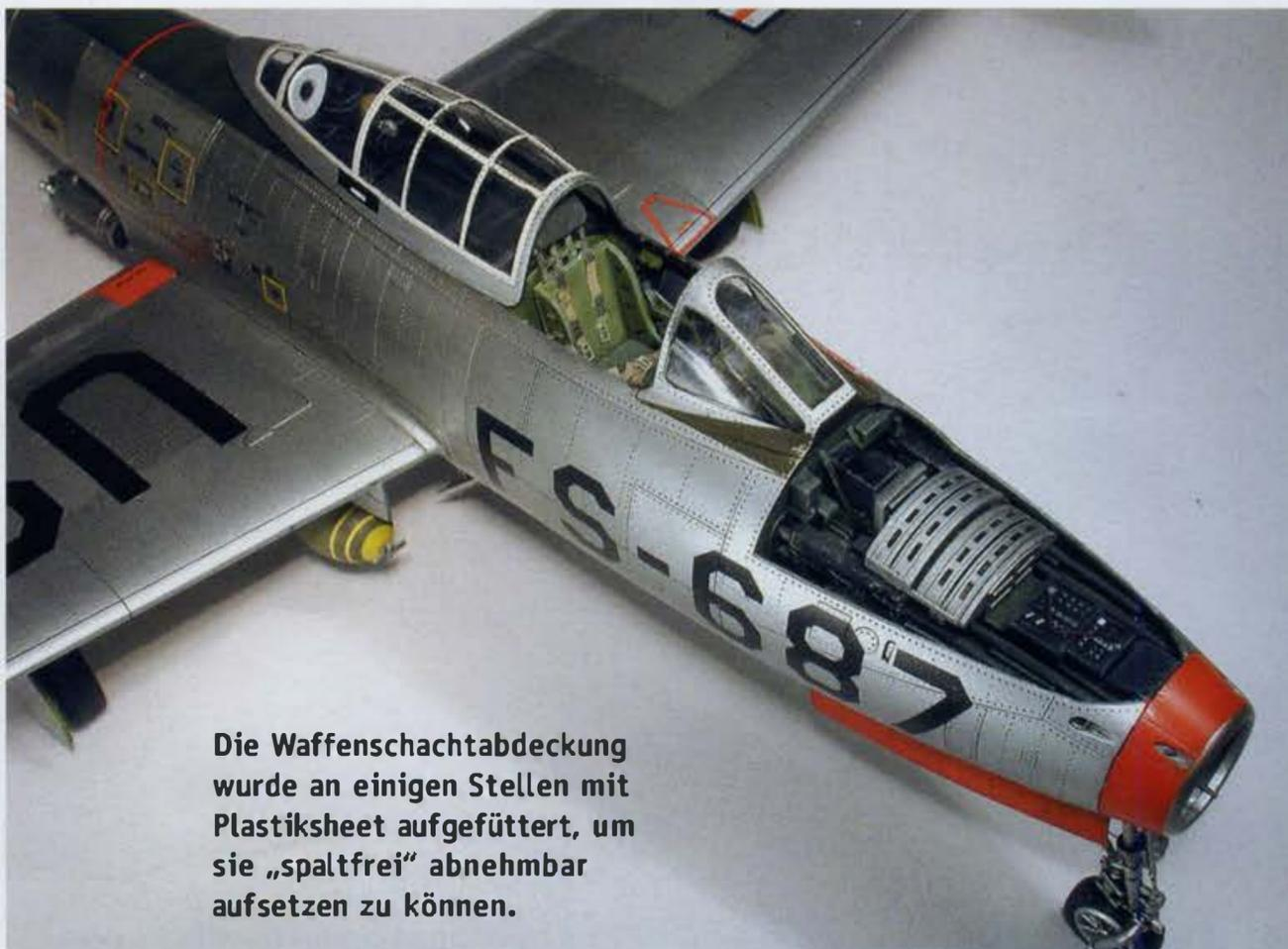
Die Waffenschachtabdeckung wurde an einigen Stellen mit Plasticsheet aufgefüttert, um sie „spaltfrei“ abnehmbar aufsetzen zu können.
