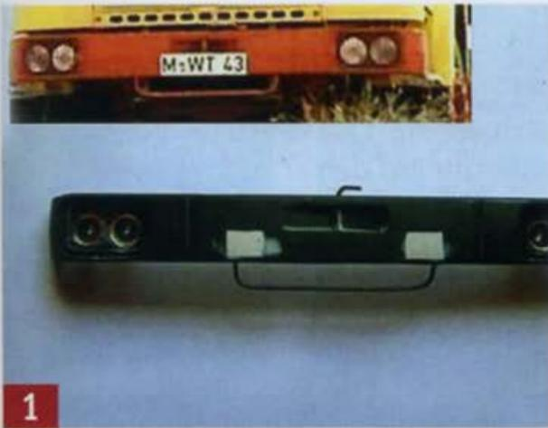
**1** Eine weitere Änderung an der Kabine ist der Abschlepphaken; der Trittbügel wurde aus Draht gebogen und eingeklebt.
