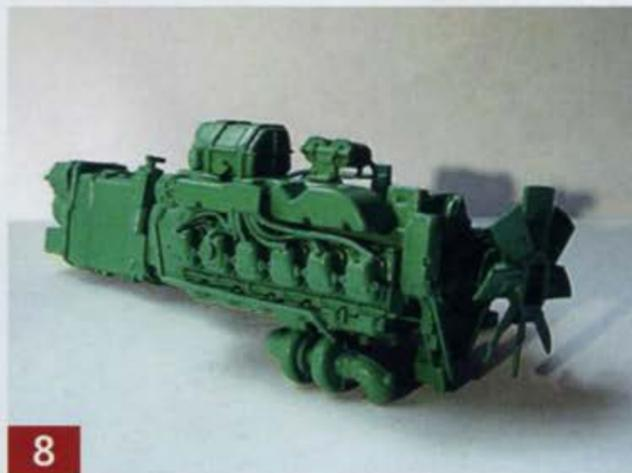
**8** Im Anschluss wurde alles in einem helleren Grün von Revell mit der Airbrush lackiert und mit Wasserfarben gealtert.
