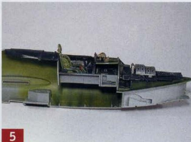
**5** Triebwerk, Cockpitsektion, Bugfahrwerkschacht und Hydraulikschacht für die Luftbremse in eine Rumpfhälfte geklebt.
