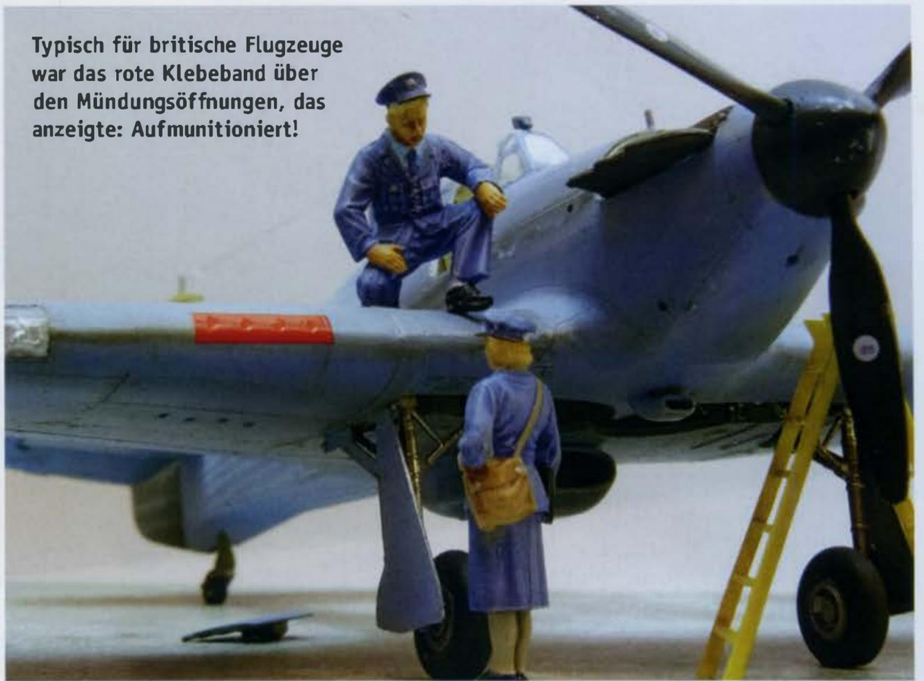
Typisch für britische Flugzeuge war das rote Klebeband über den Mündungsöffnungen, das anzeigte: Aufmunitioniert!
