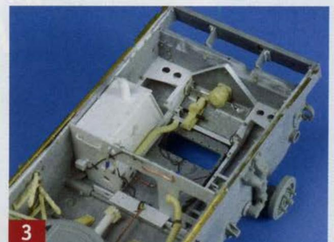
Der eigentliche Kraftstofftank auf der rechten Seite wurde aus Aluminiumfolie und Plastikprofilen erstellt. Die Federung im Dragon-Kit ist bereits gut nachgebildet und wurde nach Fotos noch mit neuen Teilen ergänzt. Die Kabel bestehen aus Kupfer- und Bleidraht.
