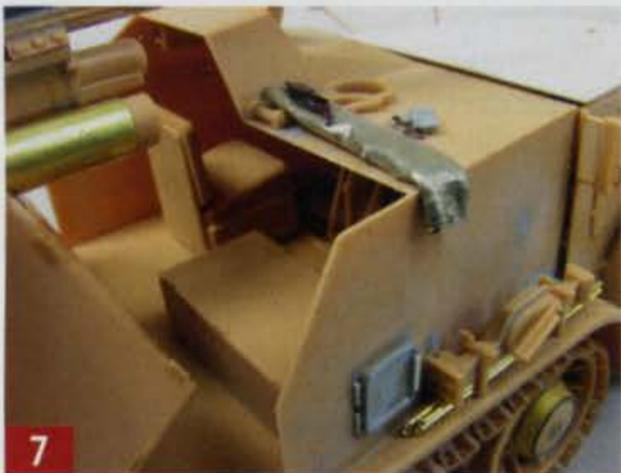
7 Die nach hinten versetzte Kiste neben dem Fahrer. Auf dem Dach der Kabinenpanzerung: die geänderte Rohrzurrung.
