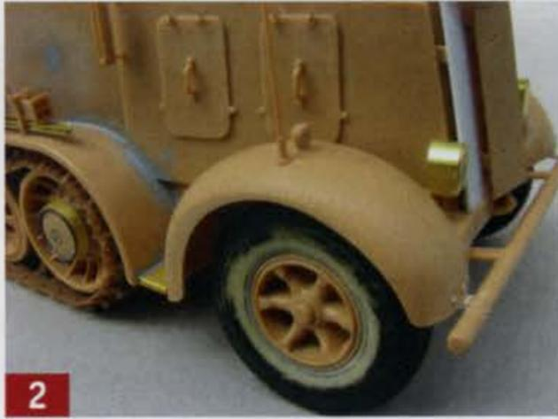
**2** Resin-Abgüsse ersetzen die Bausatzreifen. Abgeformt wurde der Reifen aus einem alten Bausatz eines 12-Tonner von DES kit.
