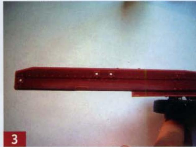
**3** Für den Umbau zu einem Zweiachser musste somit die ganze Pendelei-Aufhängung weggeschnitten und verschliffen werden.
