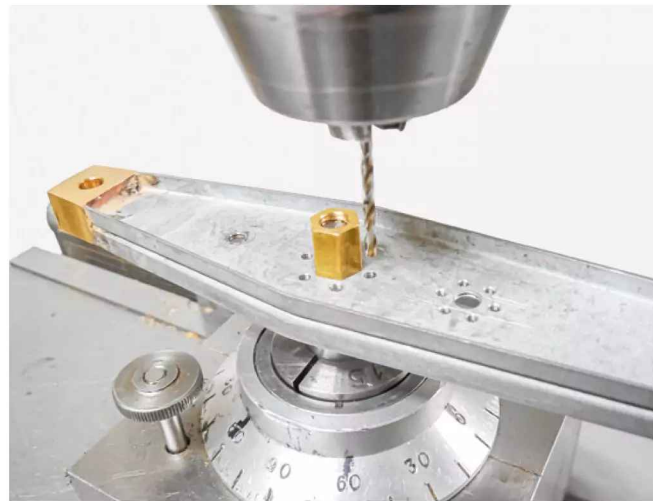
Die einzelne Bohrungen werden hergestellt
