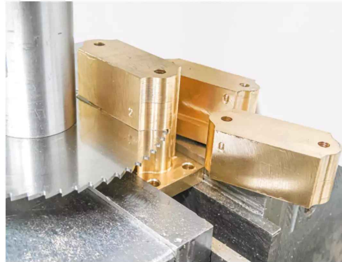
Das Lager wird getrennt
