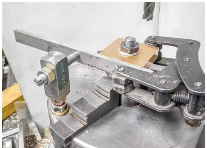
Ausrichten des Werkstückes der unteren Traverse
