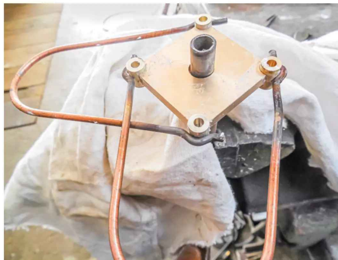
Fixieren der Buchse, (Werkstück von unten)
