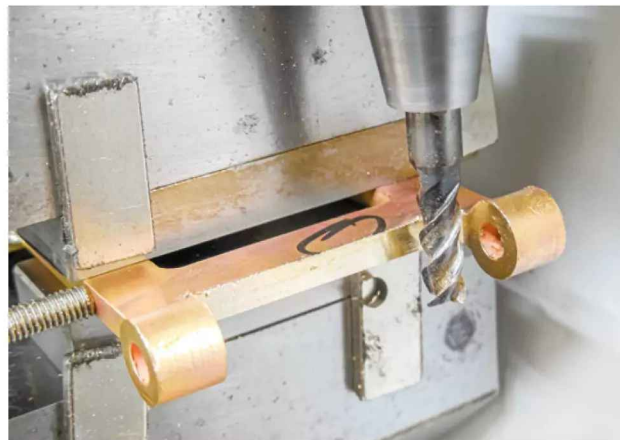
Die Gelenkaugen werden gefräst
