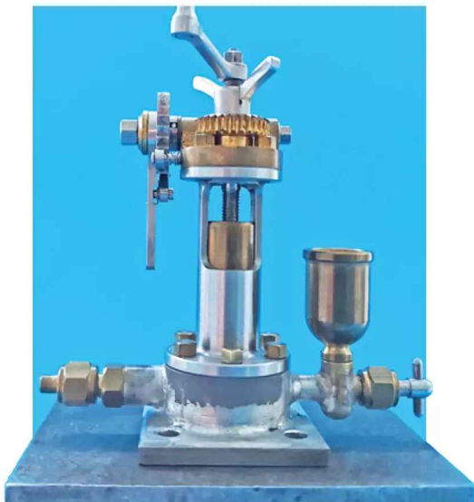
Bau einer Zylinderölpresse
