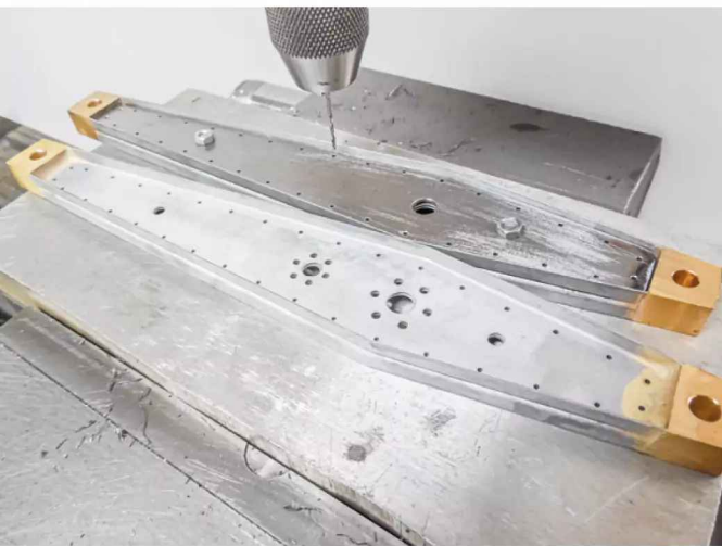
Die Nietbohrungen werden hergestellt
