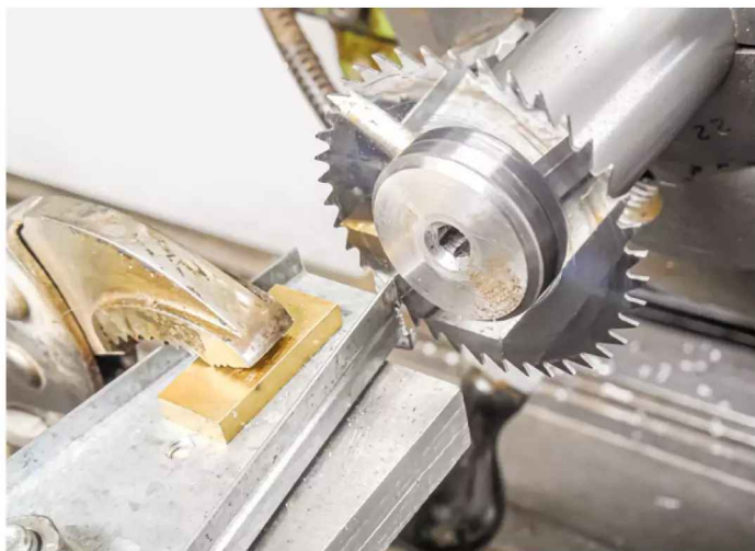
Die Länge wird gesägt
