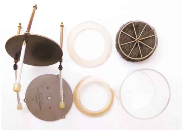
▲ Der Hielscher Motor vollständig demontiert. Im Bild links sieht man die defekte Dichtung ▶
