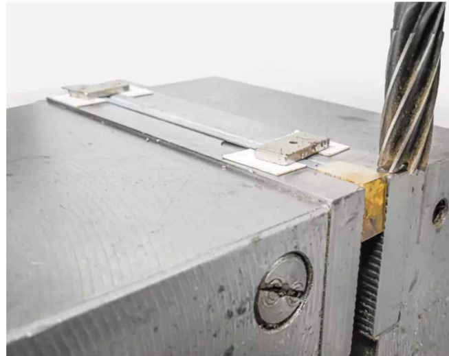
Die Außenform vom Gelenkauge wird gefräst
