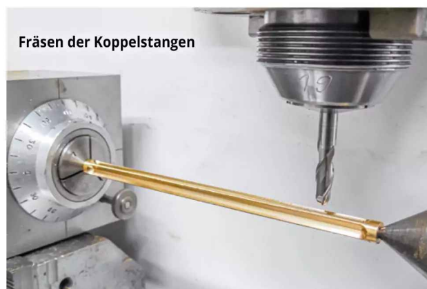
Die Gelenkaugen werden gefräst
