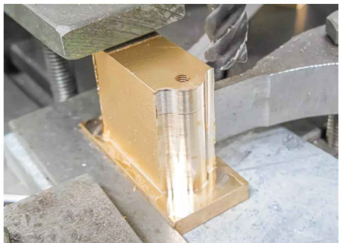
Die Außenform des Kurbelwellenlagers wird gefräst
