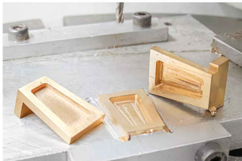
Das Emblem wird gefräst
