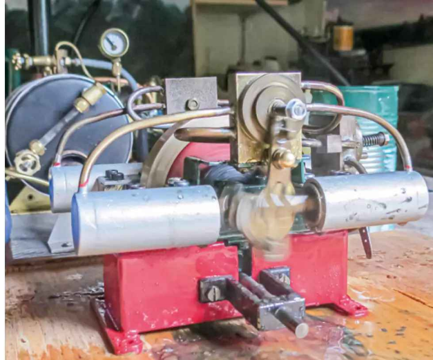
Lauf bei etwa 1 bar, gut ist die Funktion der Dampfverteilung zu sehen
