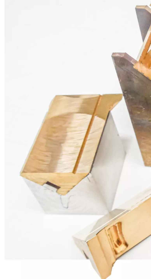
Die Eckteile werden zusammengelötet
