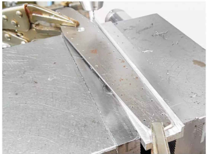
Die Bohrschablone wird hergestellt
