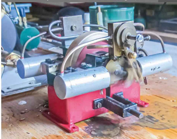
Restaurierung einer Vierzylinder-Boxer- Dampfmaschine aus den sechziger Jahren
