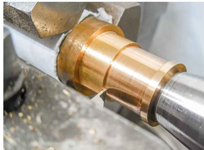
Die Lagerbuchse wird hergestellt
