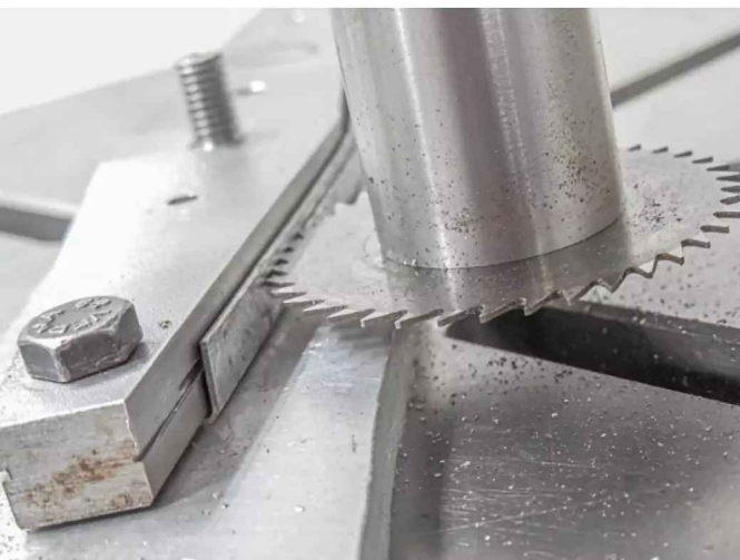
Die Höhe wird gesägt
