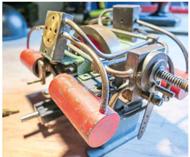
Die beschädigte Aufnahme des Steuerschiebers
