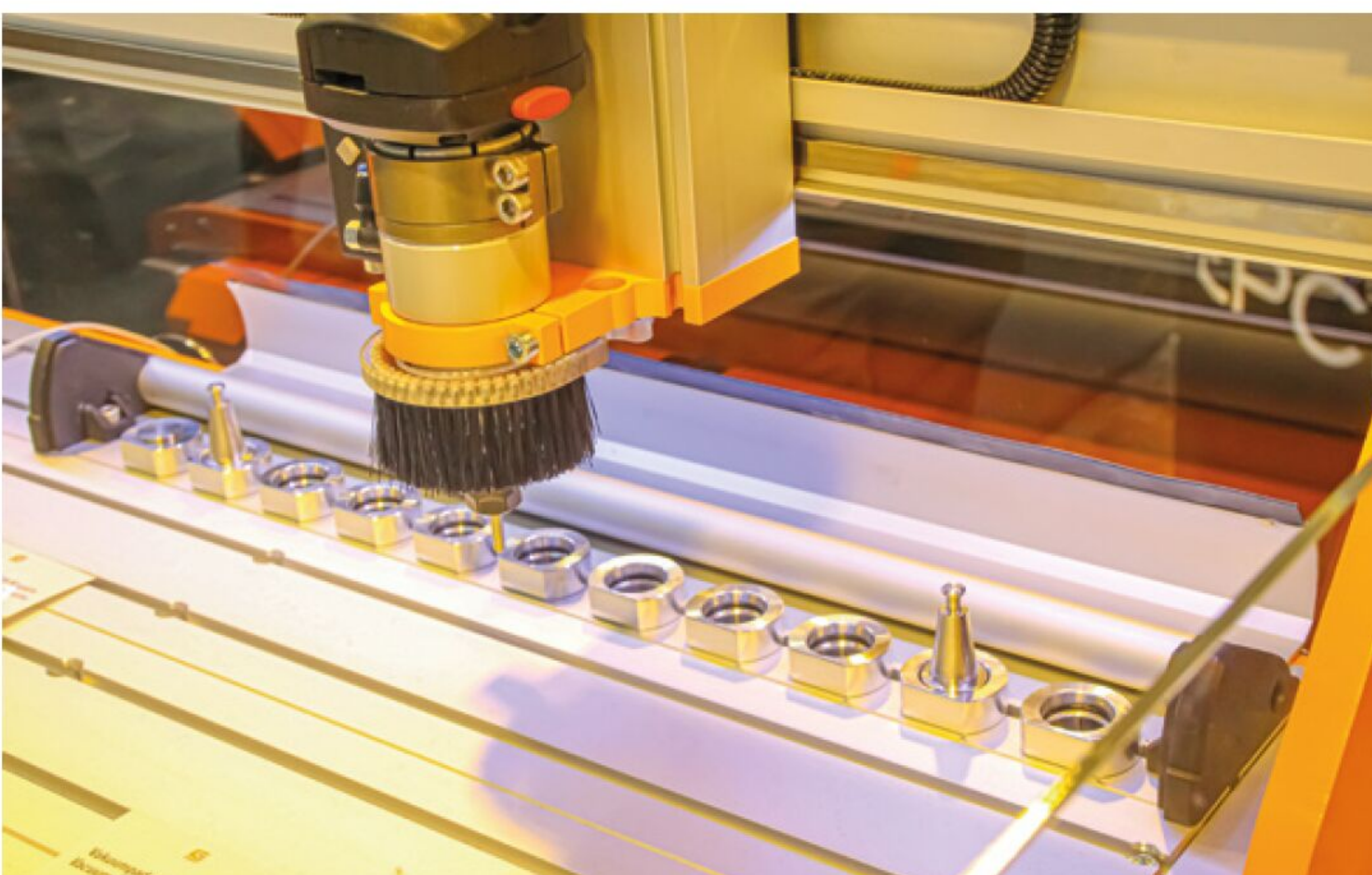
Das neue, sich verschließende Werkzeugwechsellmagazin von Stepcraft offen...
