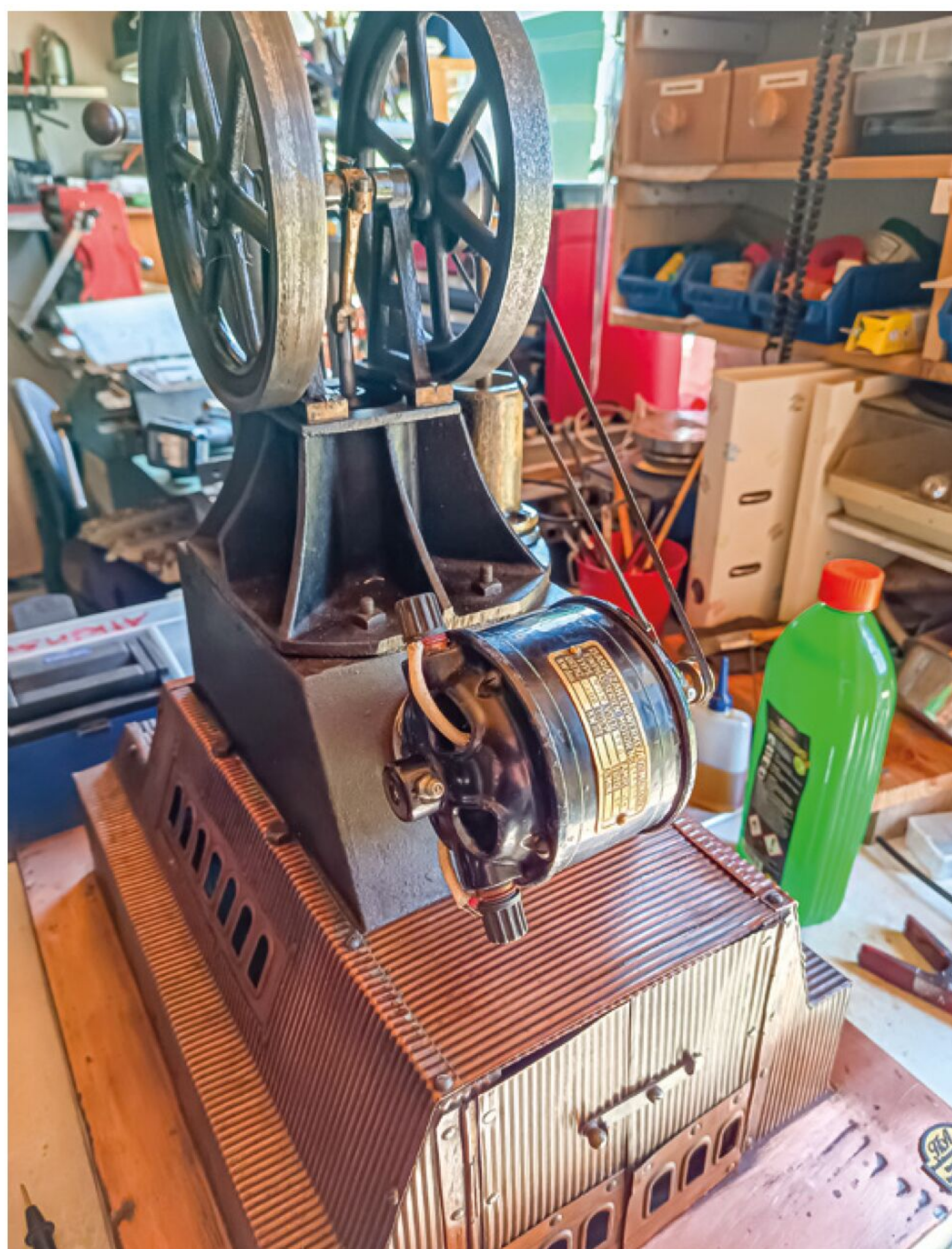
Mit dem angebrachten Generator kann der Motor wieder eine Arbeit verrichten
