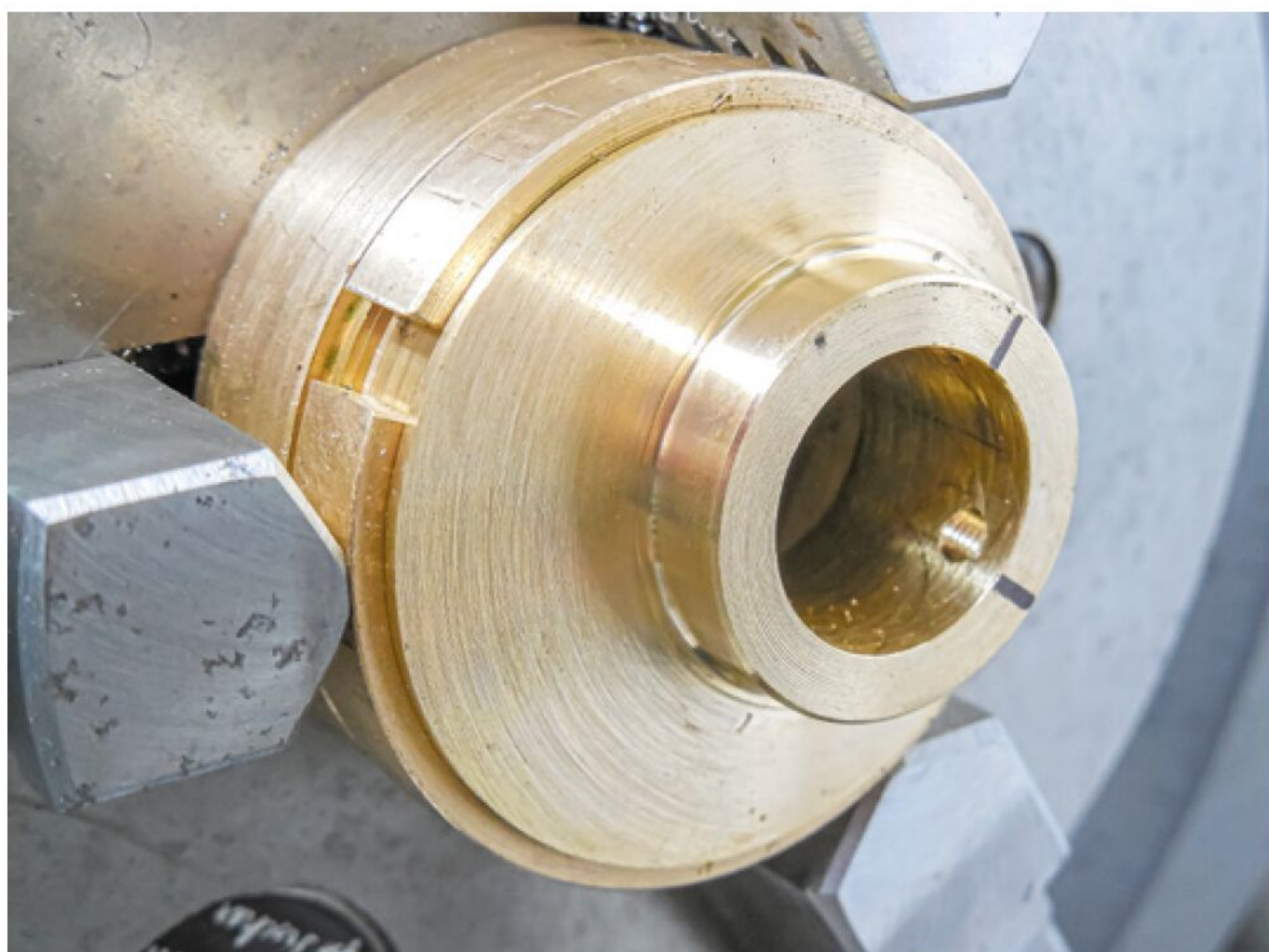
Der Exzenter mit eingelegtem Ring zum Spannen
