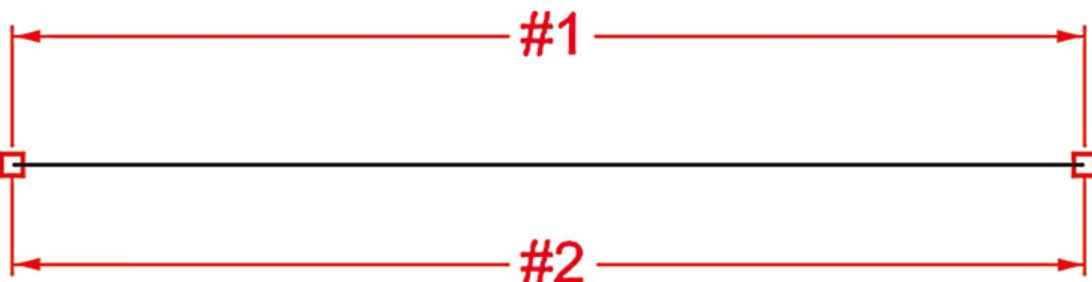
Bild 3: Zeichnungsfehler „Doppelte oder mehrfache Elemente“
