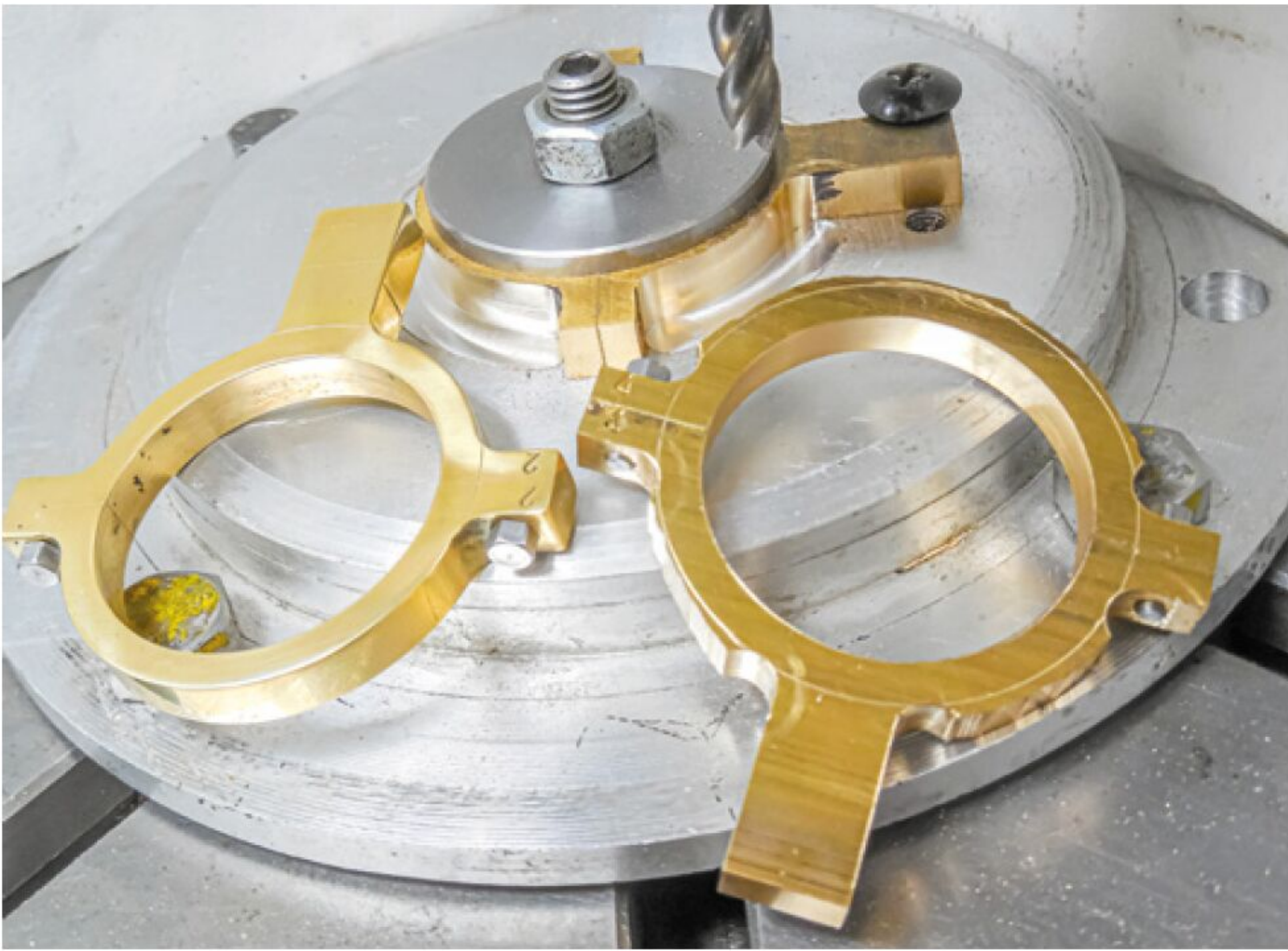
Der am außen Ø gefräste Ring
