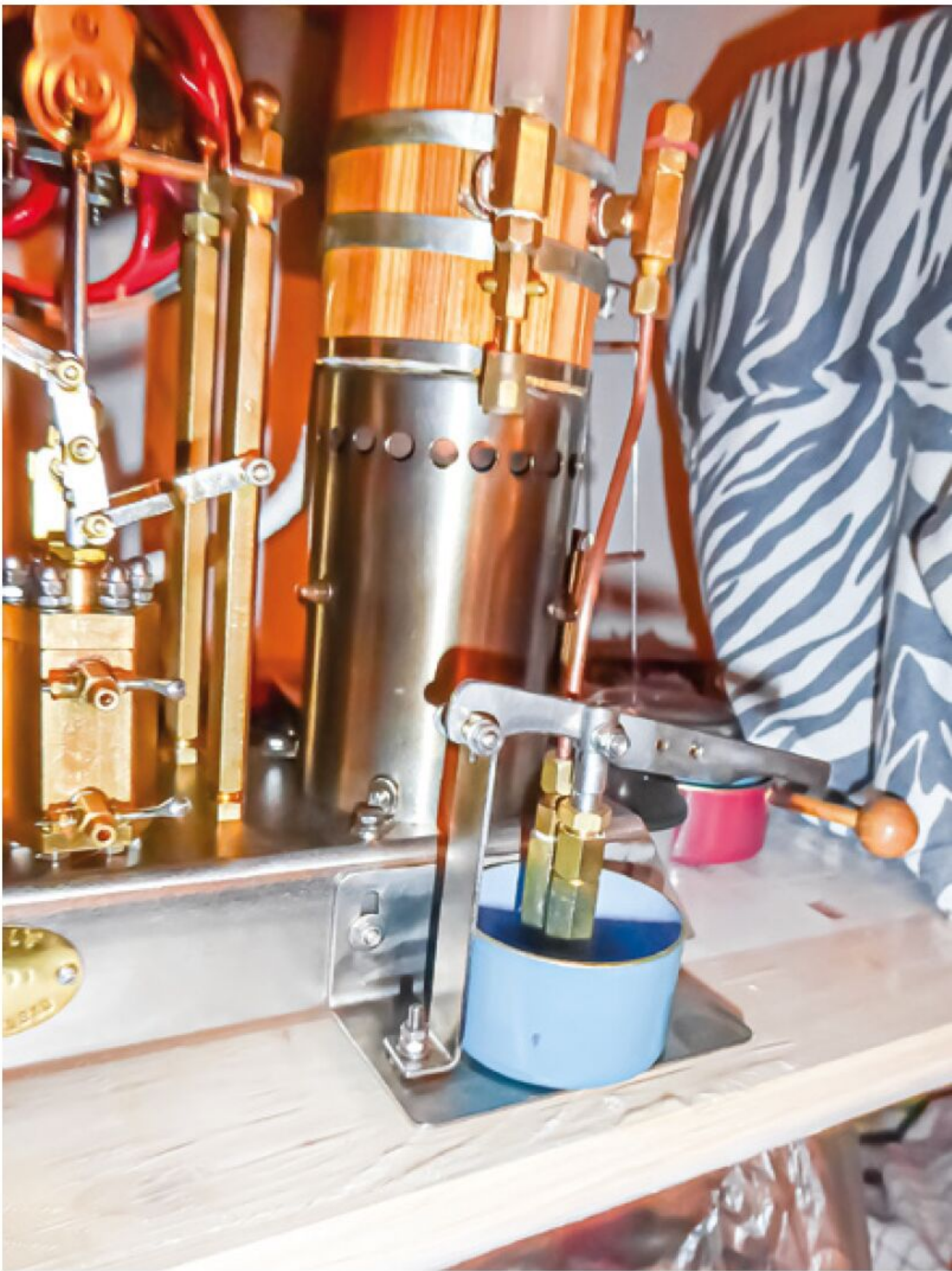
Eine ähnliche Pumpe hatte ich mir vor einiger Zeit für die Neumann-Bockdampfmaschine gebaut. Hier mit Stopfbuchse am Plunger und Wasserbassin an der Basis
