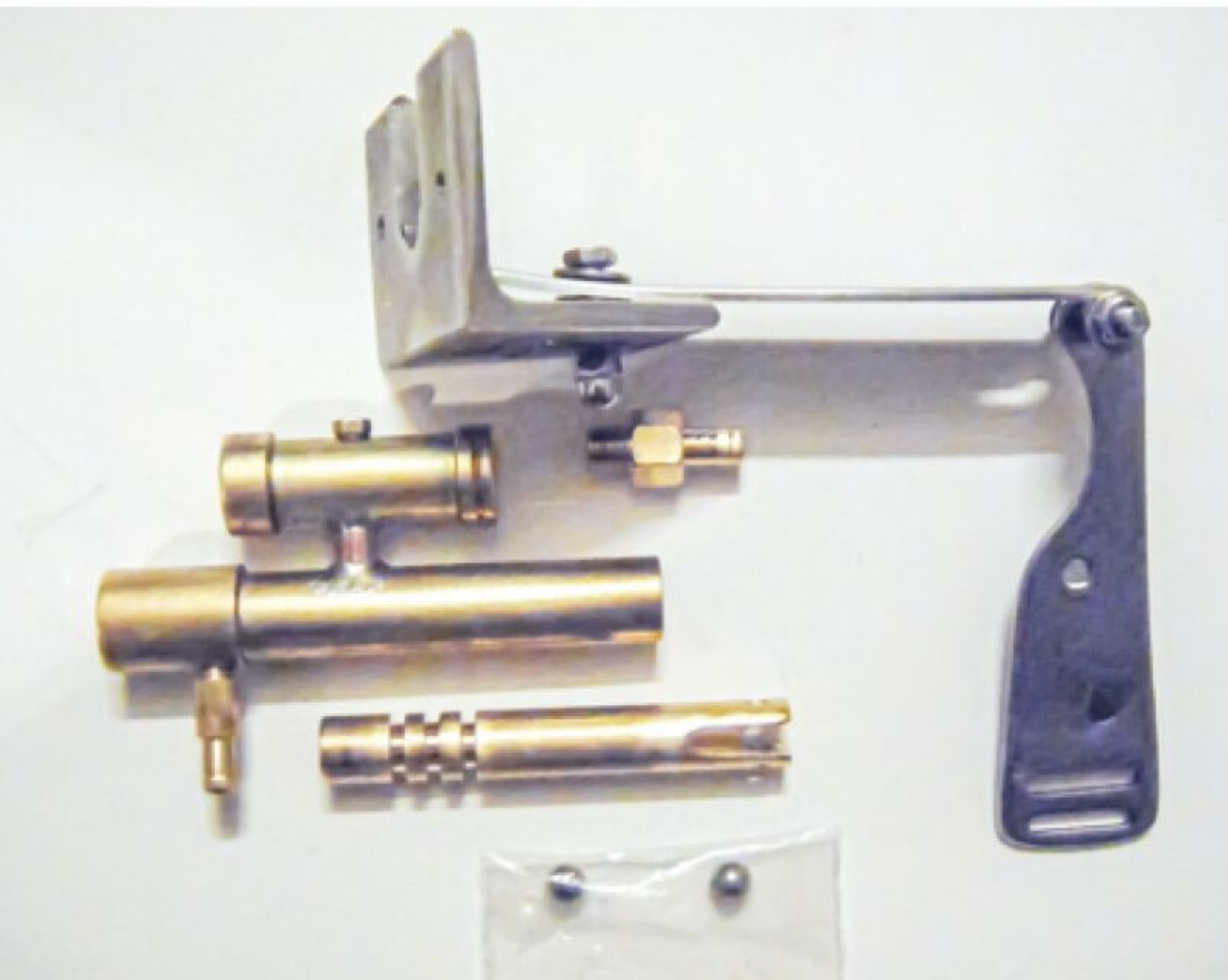
Alle Komponenten sind nun fertig und können auf einer gemeinsamen Basis montiert werden. Unten im Bild die 5-mm-Ventilkugeln aus rostfreiem Stahl. Man beachte die „Einstiche“ am Plunger, die mit Teflonband dicht aufgefüllt werden
