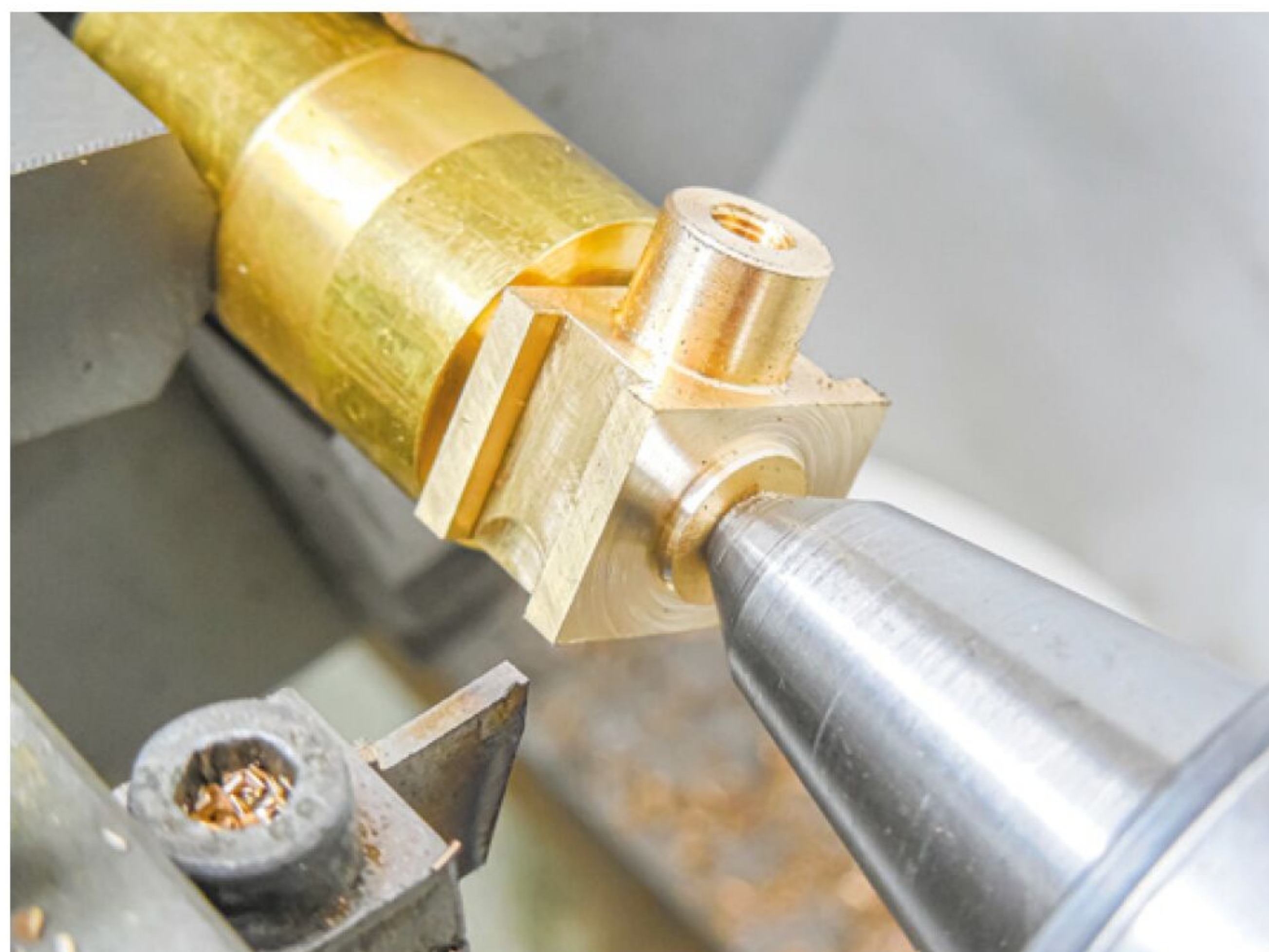
An den fertigen Gleitsteinen wird der Anlaufbund gedreht
