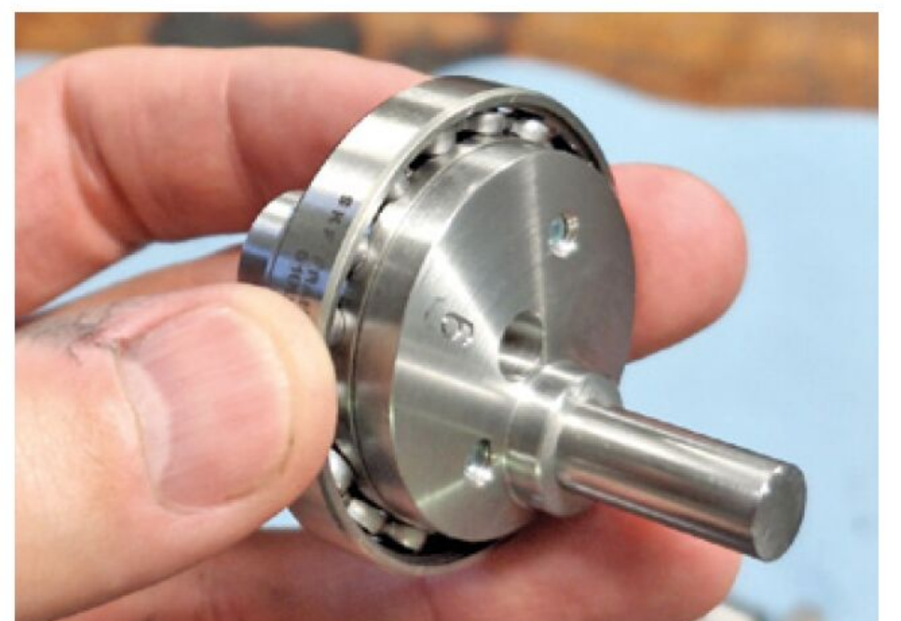
Herstellung Kurbelwelle, einzelnes Segment
