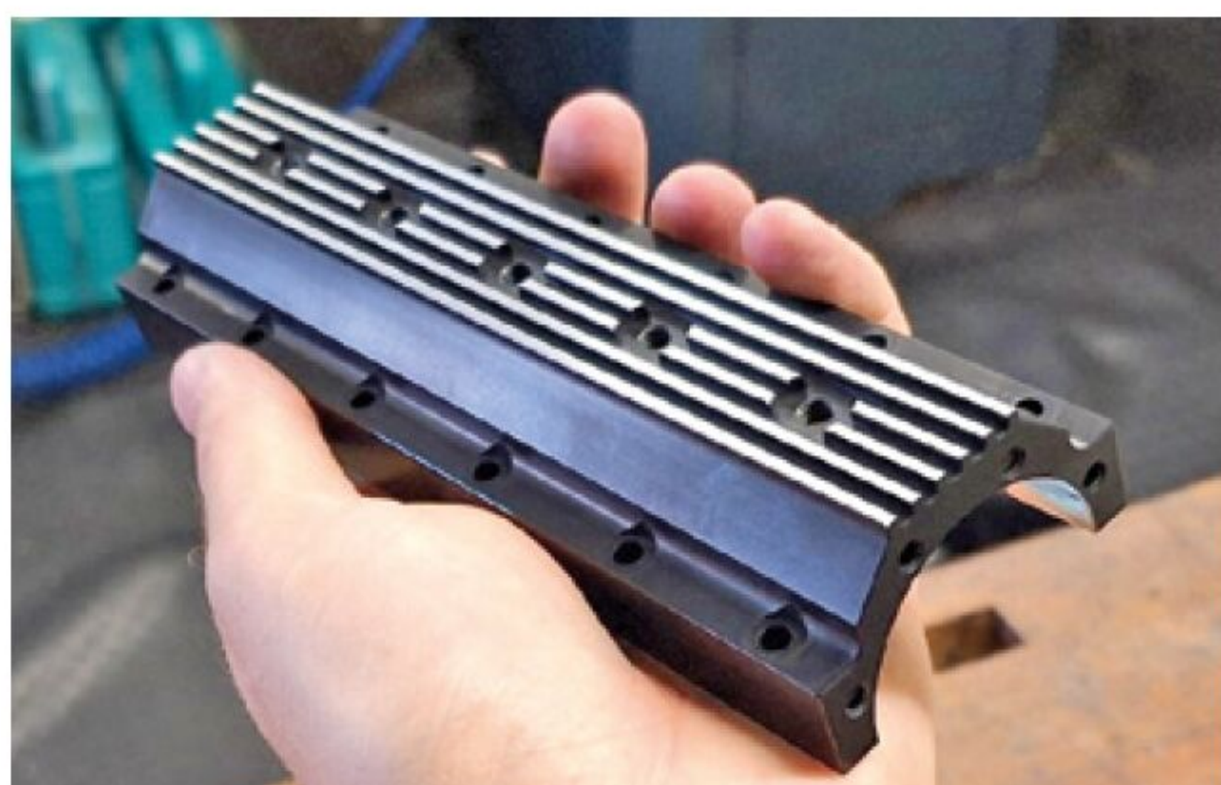
Ölwanne, Unterseite mit Dekorschliff
