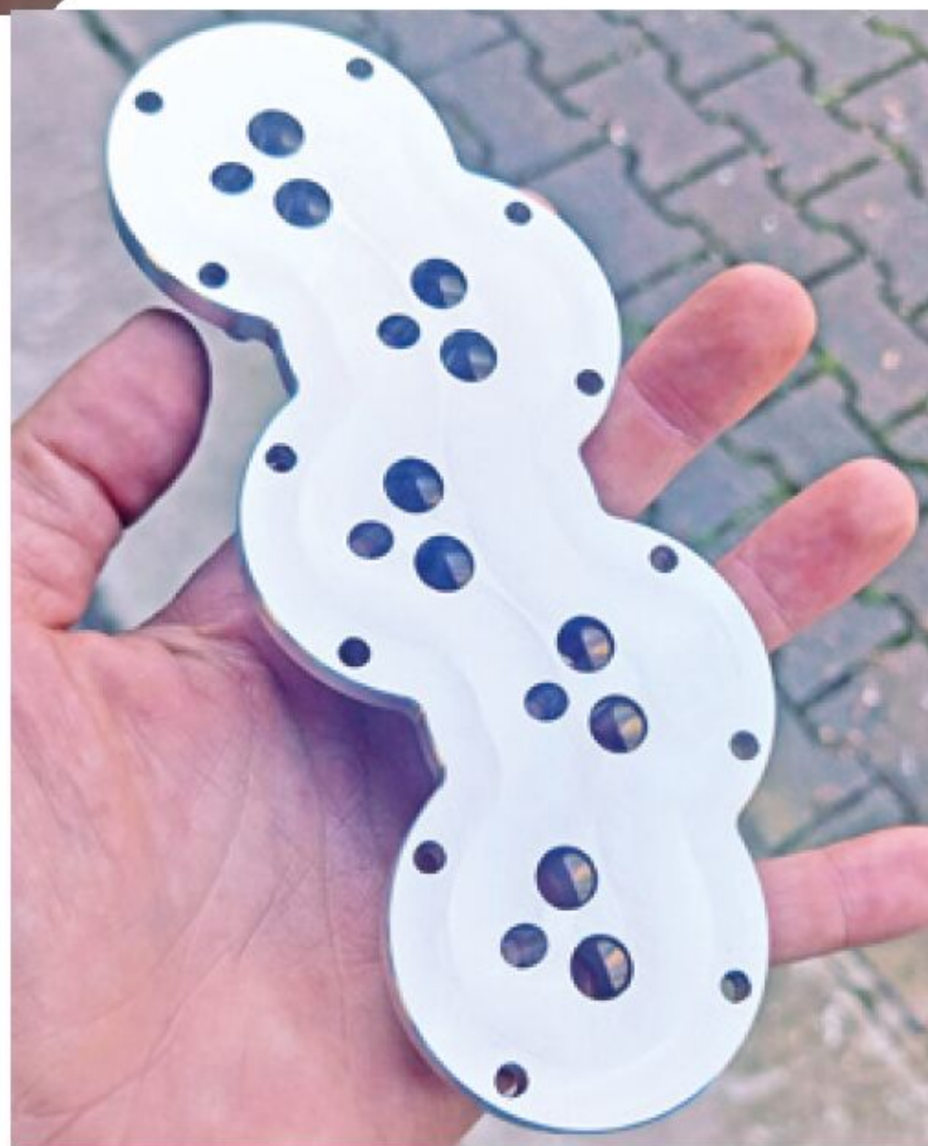
Herstellung Zylinderkopf, Unter- seite mit Ventilsitzen
