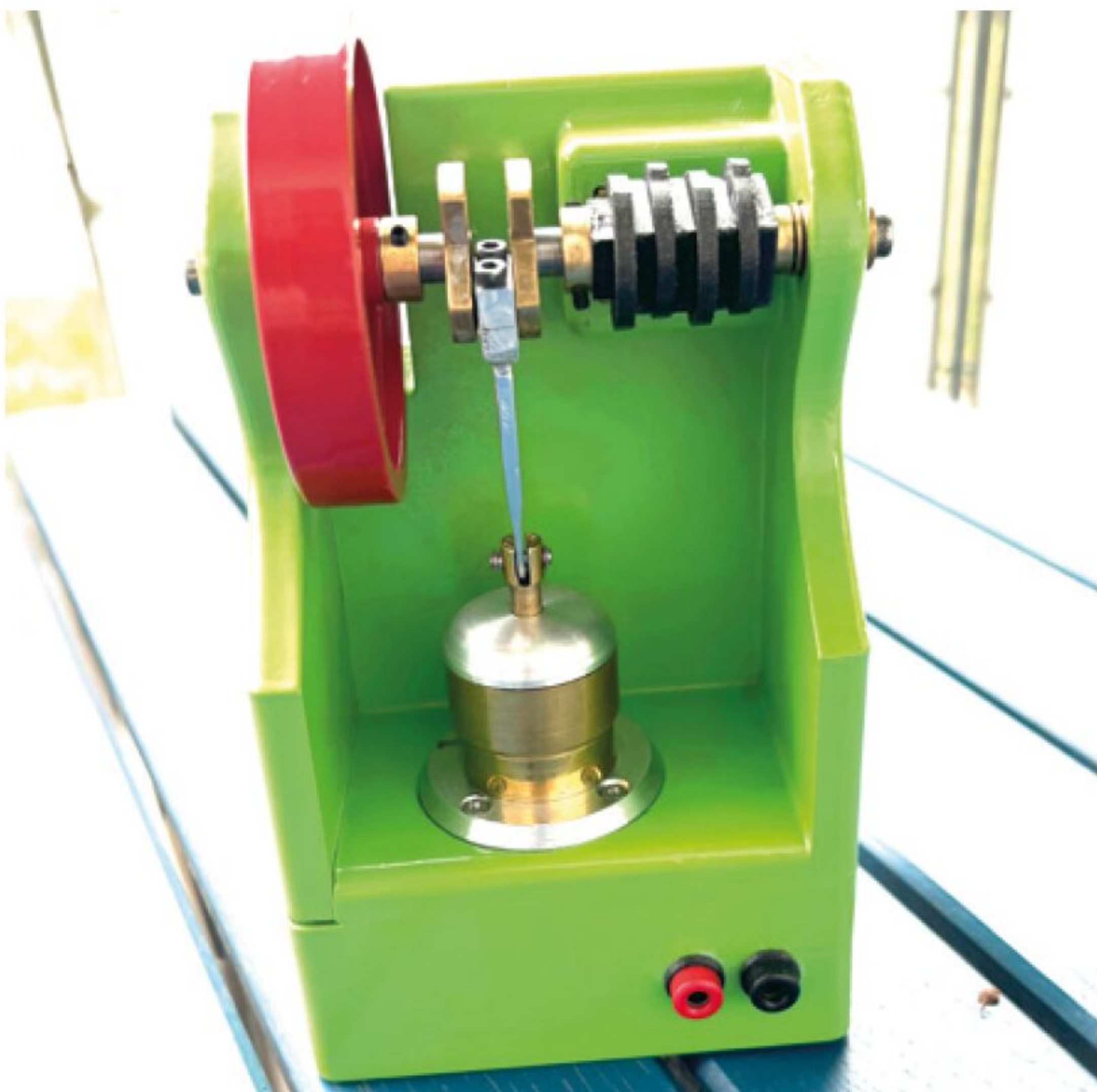
46 Elektromotor nach Page – Original und Modell
