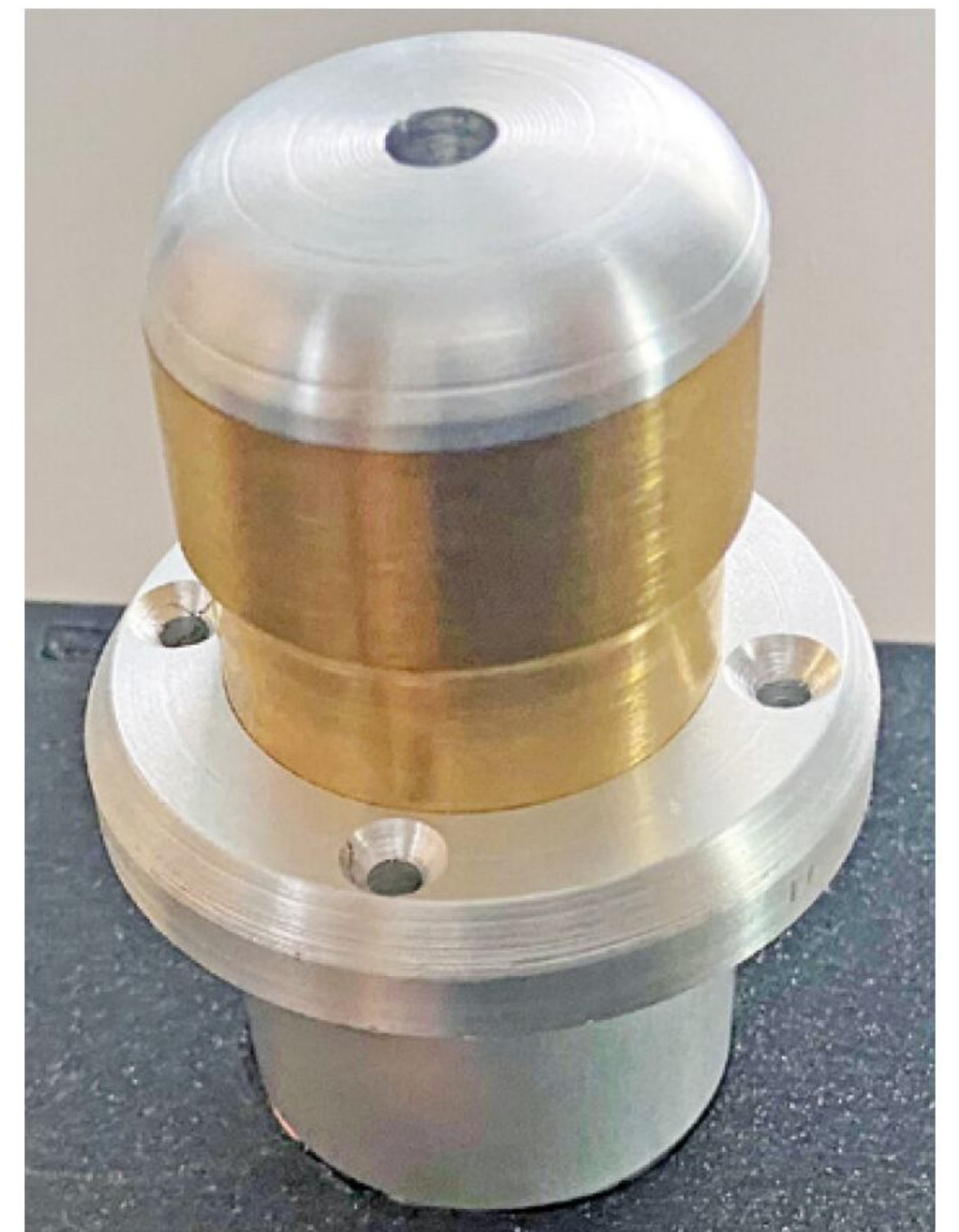
Zylindereinheit aus Magnet, Flansch, Zylinder, Deckel
