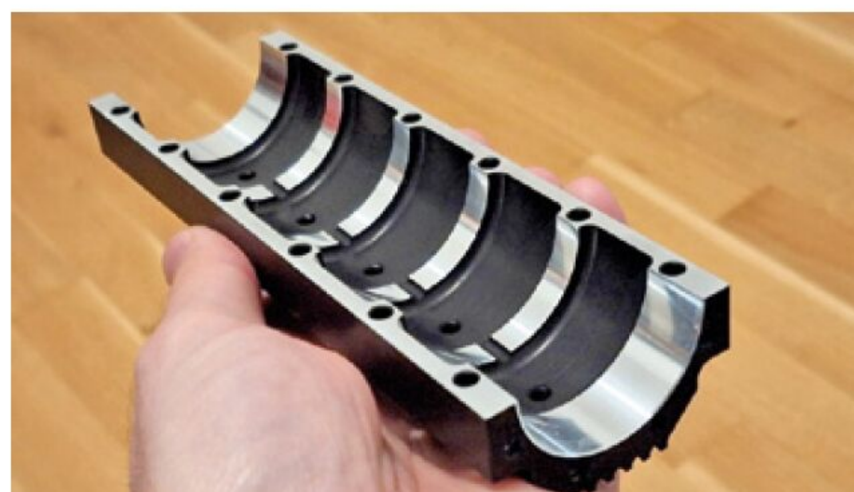
Ölwanne nach dem Eloxieren nachgearbeitete Hauptlagergasse
