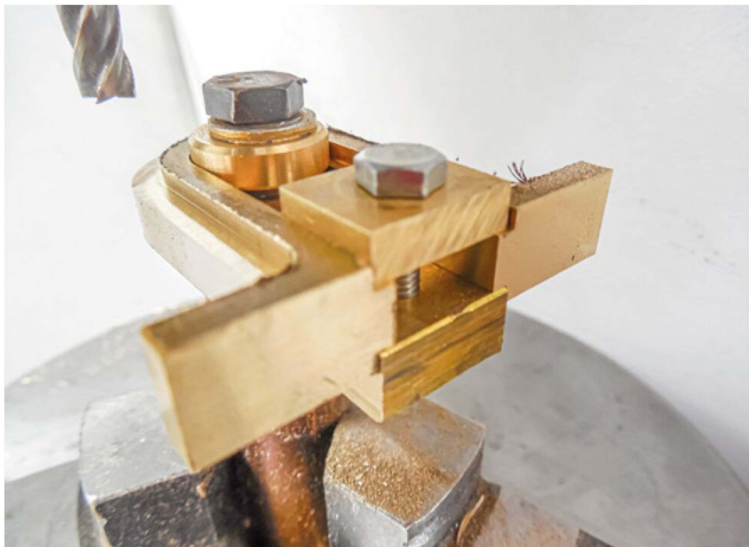
Das U wird außen gefräst.
