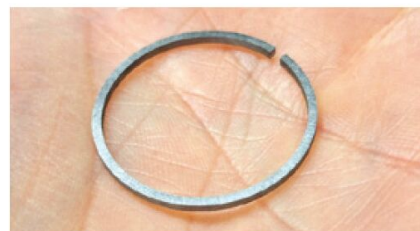
Kolbenring aus GG25
