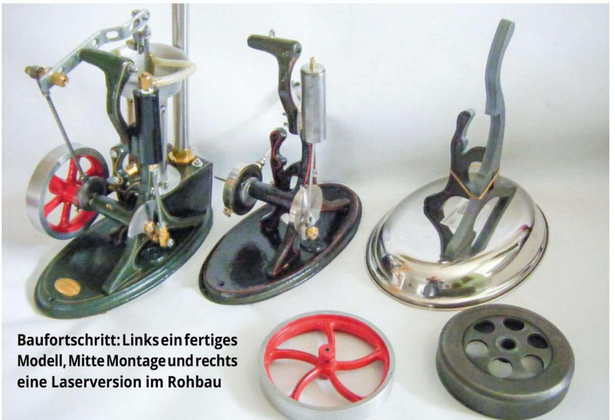
Baufortschritt: Links ein fertiges Modell, Mitte Montage und rechts eine Laserversion im Rohbau
