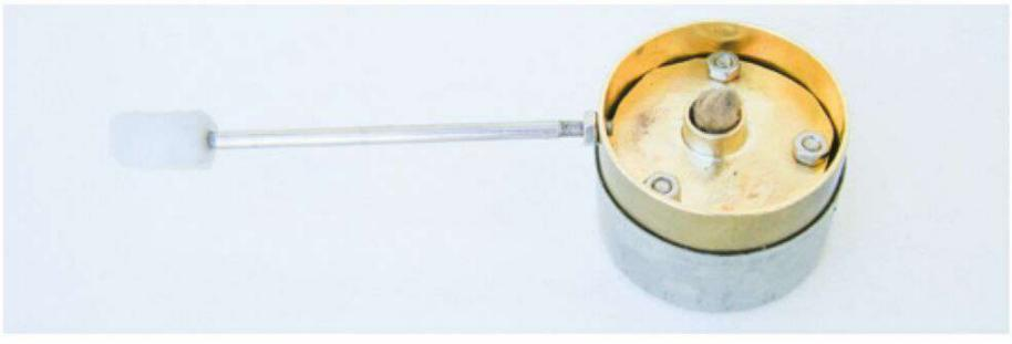
Bei dieser Eigenkonstruktion wird der Dachteinsatz mit Deckelschale zum Befüllen herausgenommen. So geht man auf „Nummer Sicher“, dass nicht zu viel Brennstoff eingefüllt wird
