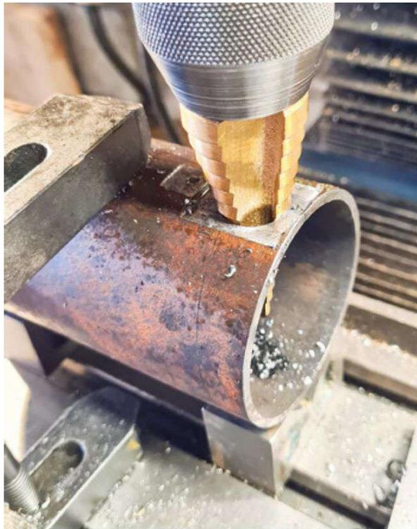
Bohren des Kesselmantels
