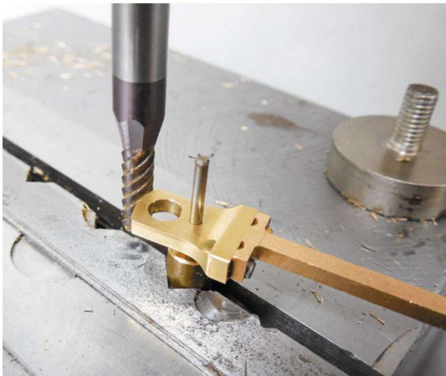
Die Rundung an der Lagerstütze wird gefräst
