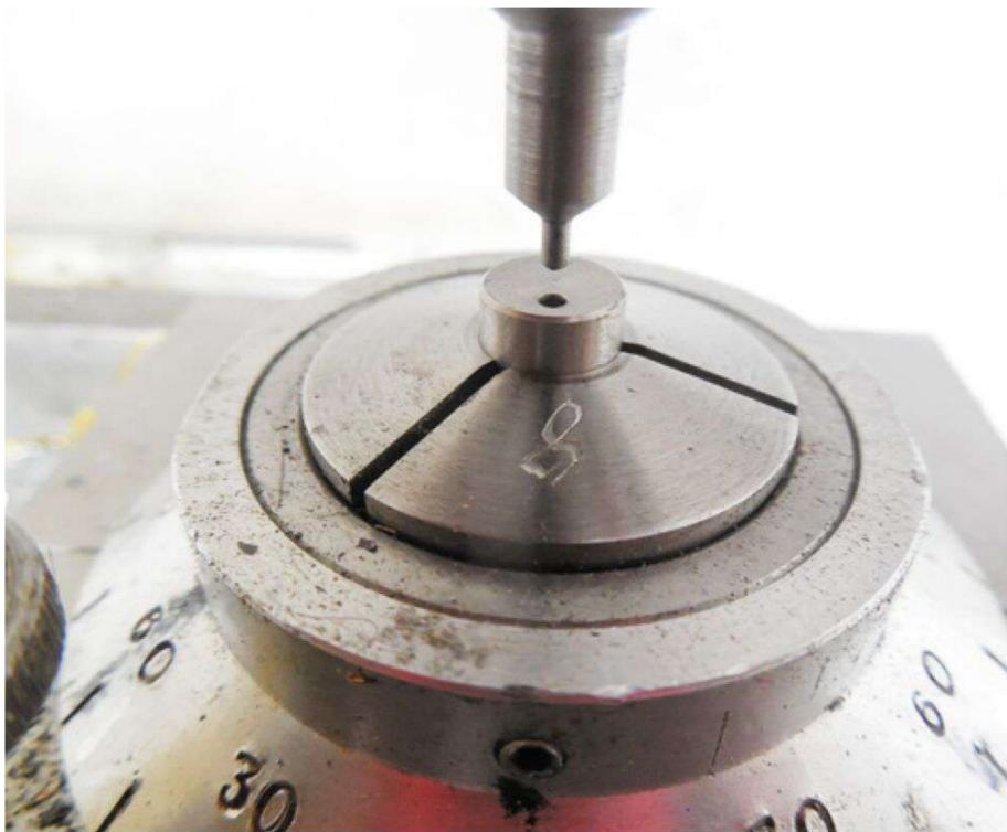
Der Wangenrohling wird ausgerichtet
