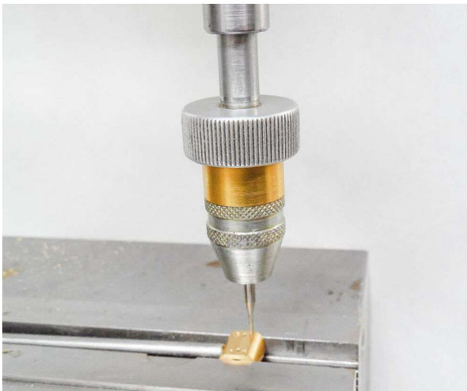
M1-Gewinde wird geschnitten, zu sehen ist auch die Führung für den Gewindebohrer
