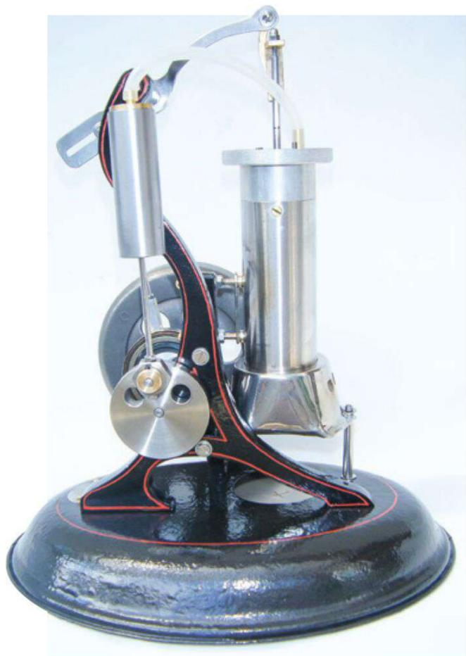
**Das Modell mit den Laserteilen ist nun auch fertig. Die Verdrängereinheit ist im Durchmesser etwas größer gewählt, was eine etwas bessere Leistung mit sich bringt**
