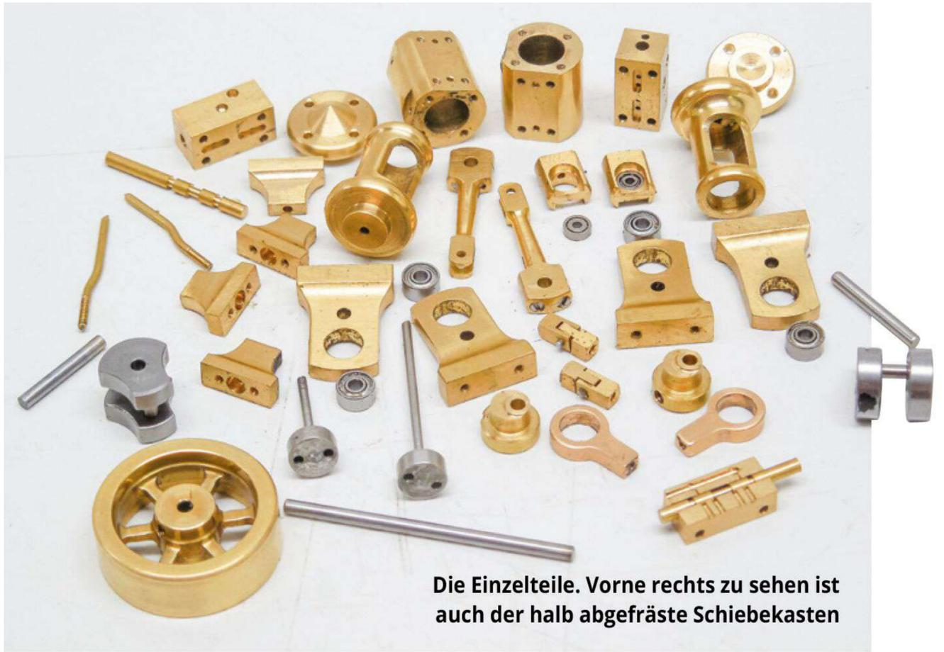
Die Einzelteile. Vorne rechts zu sehen ist auch der halb abgefräste Schieberkasten
