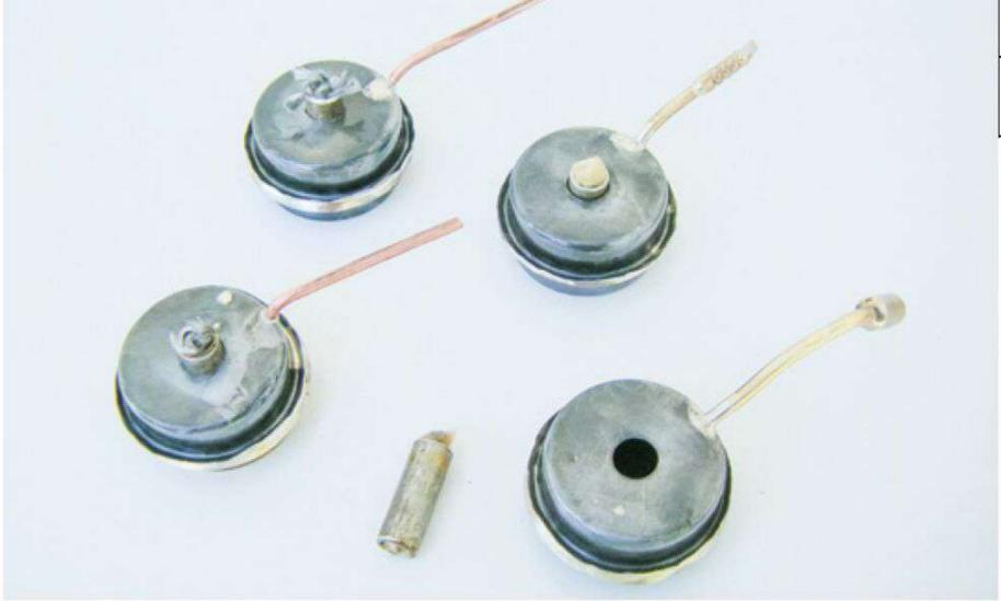
Aus Blechteilen von Herrn Reichelt wurden mehrere Brenner gebaut. Man beachte den Griff, der gleichzeitig als Entlüftungsrohr dient und Spiritusgase ins Freie leitet
