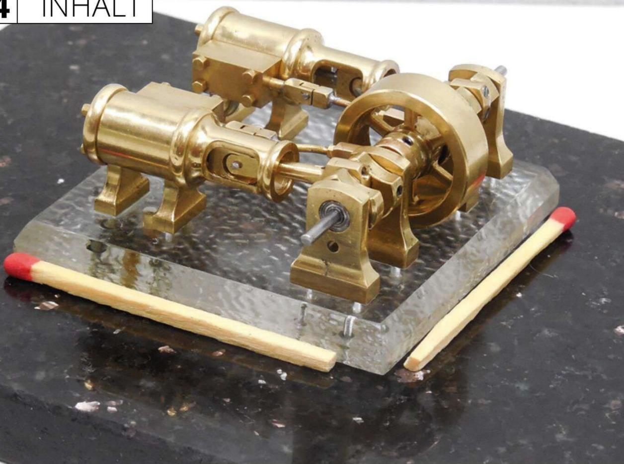
Kleine doppelwirkende 2-Zylinder-Dampfmaschine 26
