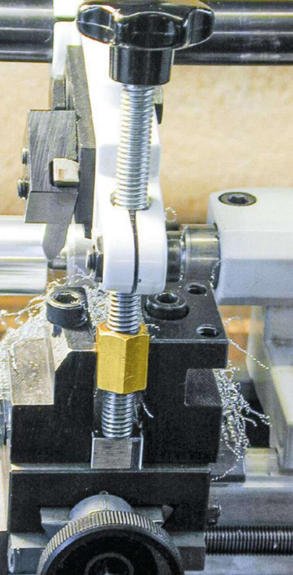
rung, welche gerade auf dem Abwärts-Weg (nach rechts) ist. Auch hier ist Schmierfett als Gleitmittel erforderlich. Im Bereich der starken Abwärtsbewegung ist das Handrad des Längsantriebes ganz, ganz langsam zu drehen.
