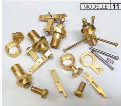
Die Einzelteile der Ventile, auch sieht man die drei Schrauben zum Klemmen des Ventilschaftes
