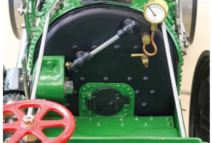
Blick über das hintere Kesselende: Manometer, gläserner Wasserstand noch ohne Absperrvorrichtungen!, das Feuerloch. Der kleine Zischhahn unter dem Manometer zeigt bei Bedarf an, ob Dampf oder Wasser austritt. Dies ist nötig, um den immer erforderlichen Wasserspiegel oberhalb der Feuerbüchse zu prüfen. Ja, sehr kompliziert war es um 1850 noch nicht! Oder?
