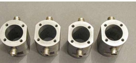
▲ **Die fertigen Zylindergehäuse**
