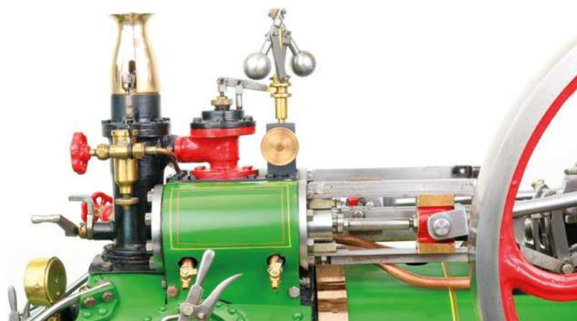
**Zylinder und Kreuzkopfansicht, darüber der frühe rote Fliehkraftregler, hinter dem oberen Absperrhahn der zylindrische Verdrängungsöler mit unterer Ablassschraube, gut zu sehen die beiden Zischhähne, oben links der vasenförmige Schutz um das federbetriebene Sicherheitsventil. Oberhalb des Manometers liegt der Dampfregler. Weit dahinter der rote Bläserhahn**
