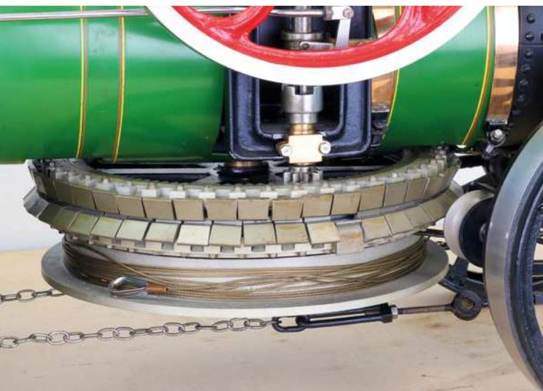
**Detailansicht der Seiltrommel: oben clip drum verantwortlich für das durchlaufende Seil, darunter fest verbunden eine übliche Seiltrommel zum Spulen**
