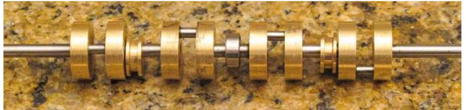
**Die fertige Kurbelwelle mit Exzenternaben**
