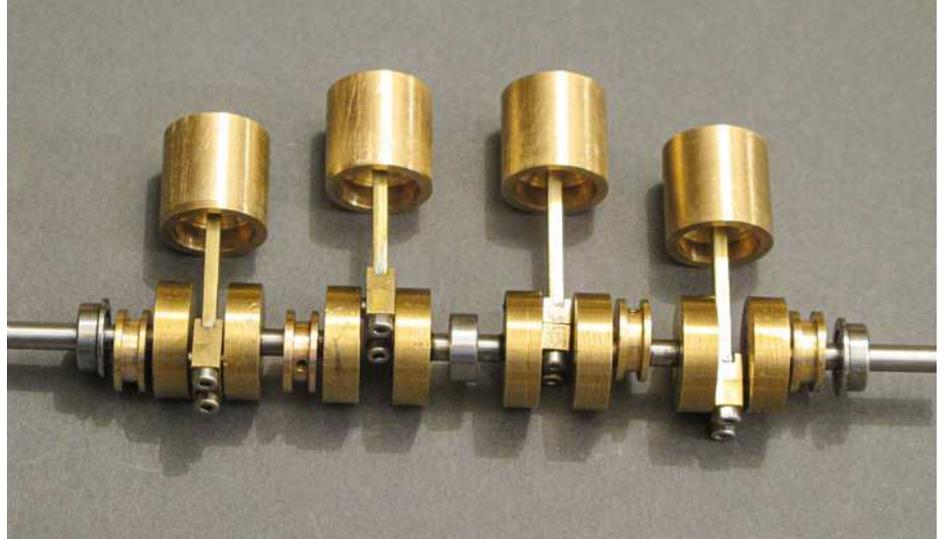
**Kolben und Pleuel an Kurbelwelle montiert**
