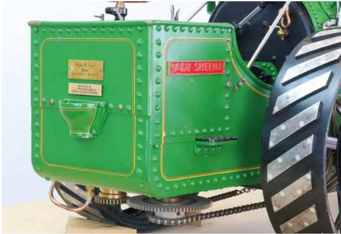
Unter dem Tender die beiden Lenkungs­zahn­räder für die Steuerungs­über­set­zung. Diese half, dass das Steuerrad bei Linksdrehung die Vorderachse auch nach links ausschlagen ließ und war kräftesparend. Die frühen Fowler Dampf­pflüge hatten auf Grund Zahnrad­über­set­zung noch die entgegengesetzte Steuerung: Linksausschlag bedeutete Lenkung nach rechts!
