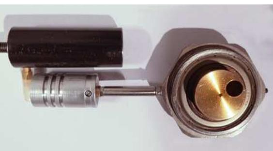
Hubzylinder mit Kolben aus Aluminium und Kugellagerexzenter. „Gefasst“ wird das Kugellager hier durch eine große Mutter mit Feingewinde, die vom Innendurchmesser her angepasst ist; alles Schrottmaterialien
