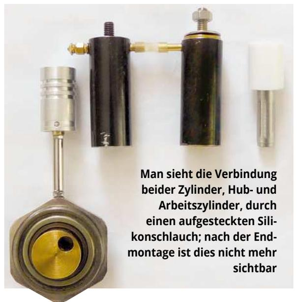
Man sieht die Verbindung beider Zylinder, Hub- und Arbeitszylinder, durch einen aufgesteckten Silikonanschlauch; nach der Endmontage ist dies nicht mehr sichtbar
