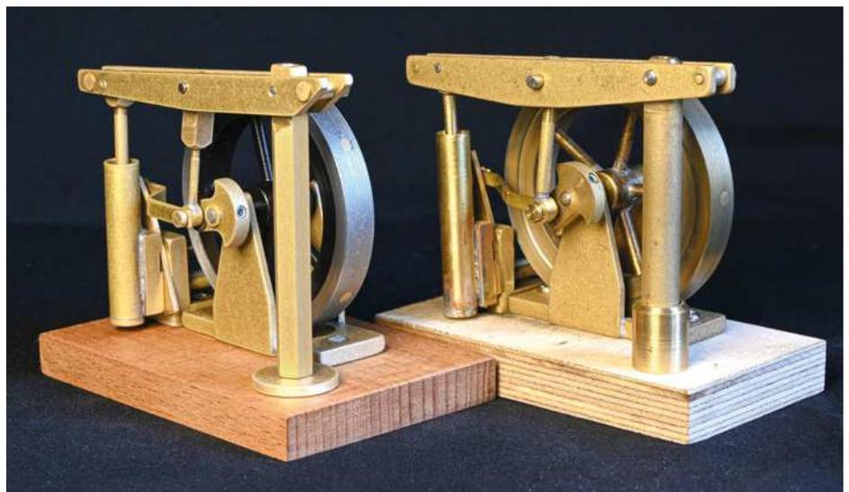
Der Prototyp rechts und das fertige Modell links. Das linke Modell ist in der Höhe nochmals um wenige Millimeter geschrumpft. Das schlankere Balancier und die sechseckige Säule lassen das endgültige Modell eleganter erscheinen
