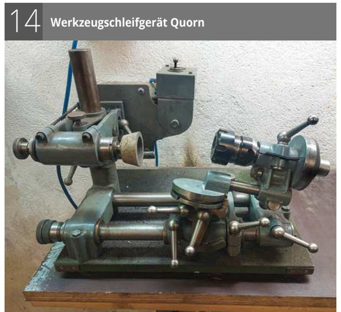
14 Werkzeugschleifgerät Quorn
