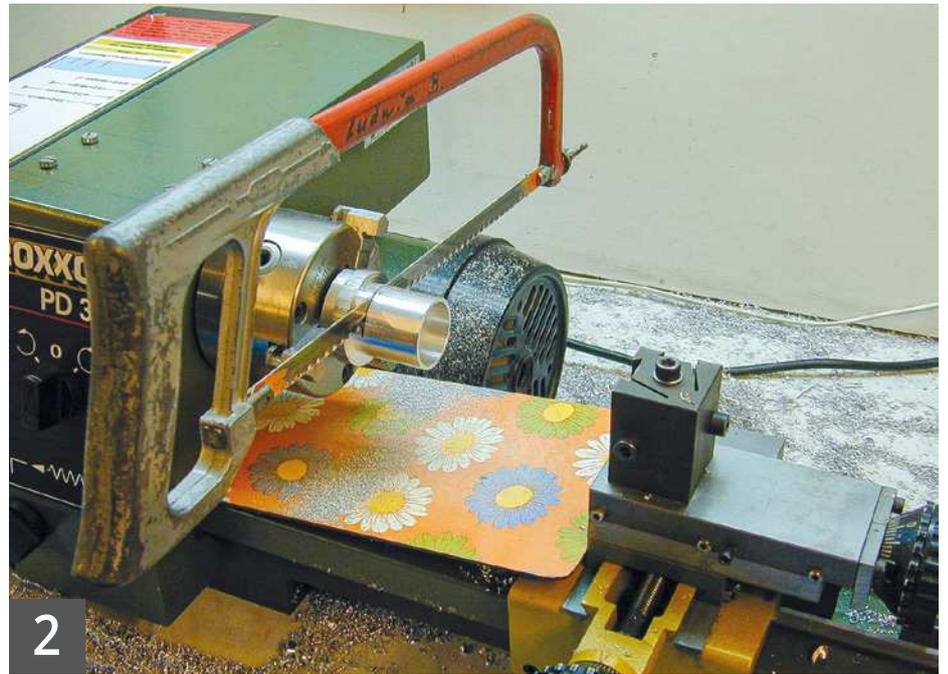
Nach dem Außen- und Innendrehen wurde „abgestochen“ (**Bild 2**). Na ja nicht wirklich, bei stehender Maschine abgesägt. Das ist manchmal einfacher.
