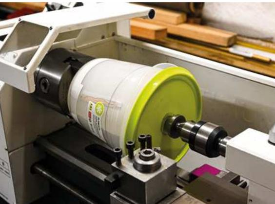
Um den Bauteilen ein mattes Finish zu geben, trowalisierte ich sie einige Stunden in einer Trommel, kurzerhand eingespannt in meine Drehmaschine. Als Schleifmittel verwendete ich ein Material, das normalerweise zum Sandstrahlen benötigt wird. Die trowalisierten Teile lackierte ich anschließend mit Zaponlack. Das Ergebnis ist beim fertigen Modell gut zu sehen
