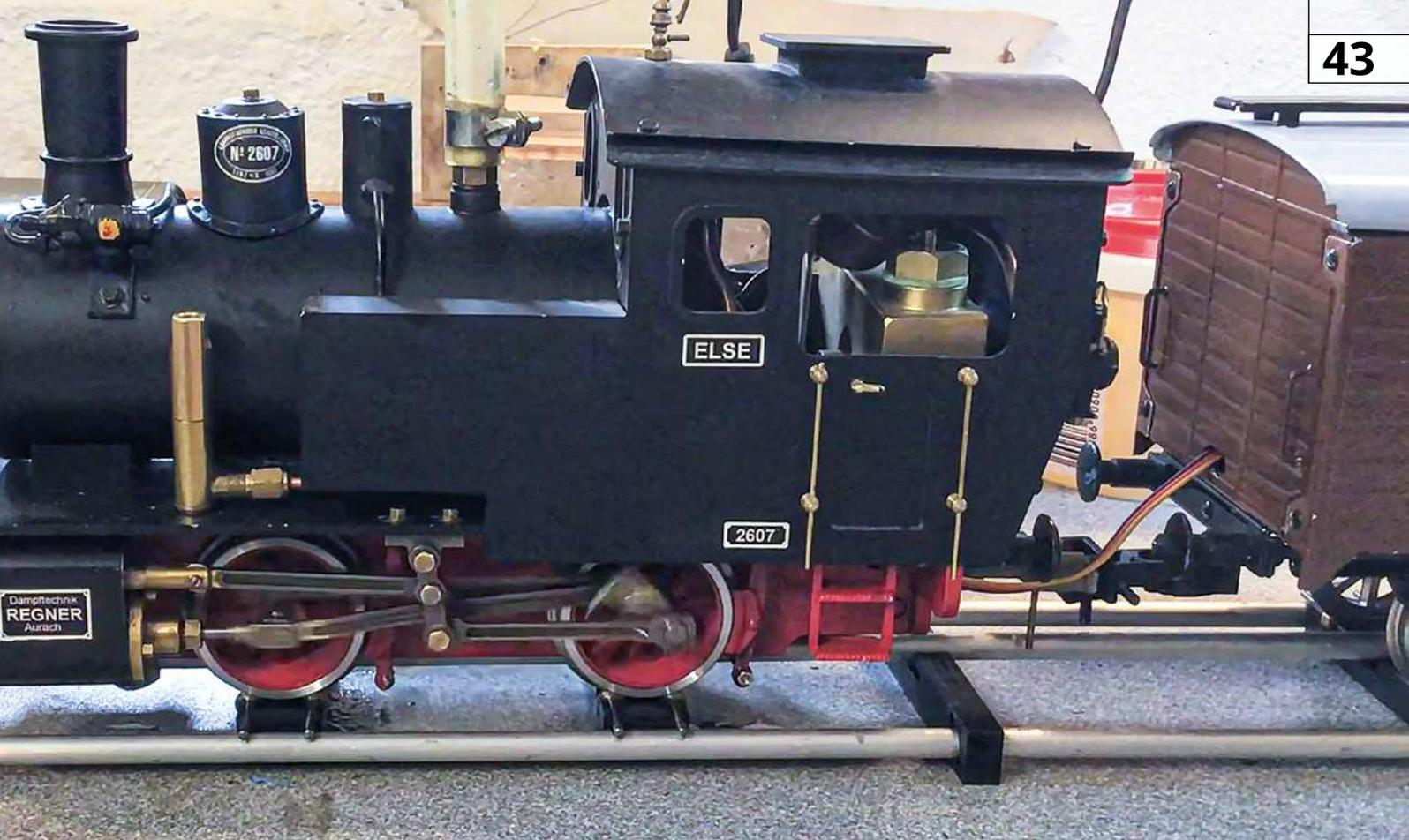
falsche Entscheidung. Genau darunter sitzt der Gastank und der Knebel schlägt an diesen an. Deshalb zurückgerüstet auf das Dampfventil mit Stellrad und die Finger unter Dampftrieb an Hitze gewöhnen. Die Dichtheitsprobe der neuen Anschlüsse unter Luft wurde mit Seifenschaum aus der Sprühdose durchgeführt.
