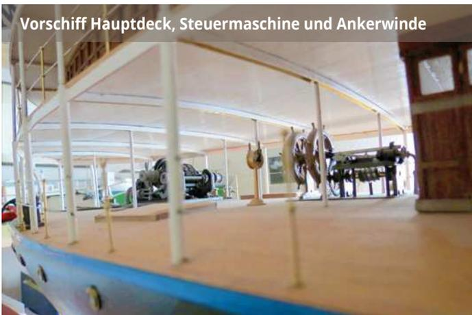
**Vorschiff Hauptdeck, Steuermaschine und Ankerwinde**
