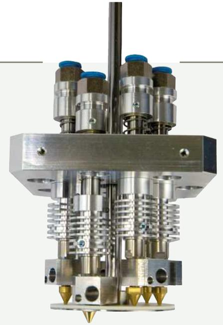
**Der 6-fach-Druckkopf ist das Herzstück des Industrie-3D-Druckers (Foto: Multec)**
