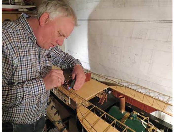
**Bau der Dachträger aus Messingprofil**
