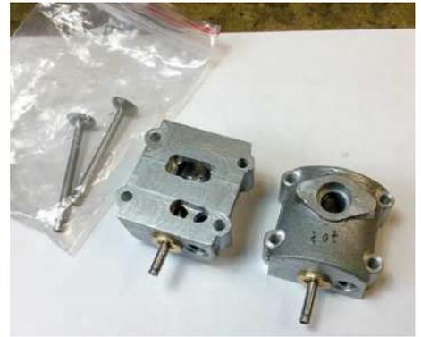
Die beiden Ventilkästen, der Sitz für das Auslassventil ist aus Messing und eingepresst
