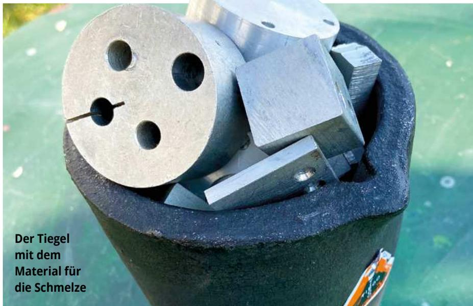
**Der Tiegel mit dem Material für die Schmelze**
