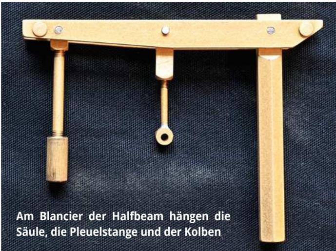
Am Blancier der Halbbeam hängen die Säule, die Pleuelstange und der Kolben
