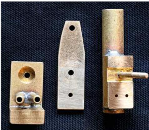
Die drei Teile des Zylinderblocks: Halter mit Ein- und Auslass, Schieber und Zylinder. Ein- oder Auslasskönnenge-tauscht werden. Die Drehrichtung der Maschine kehrt dann um
