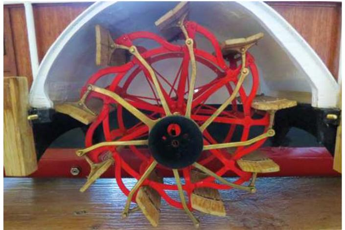
Schaufelrad kann nach Entfernen der Spiegel leicht herausgezogen werden
