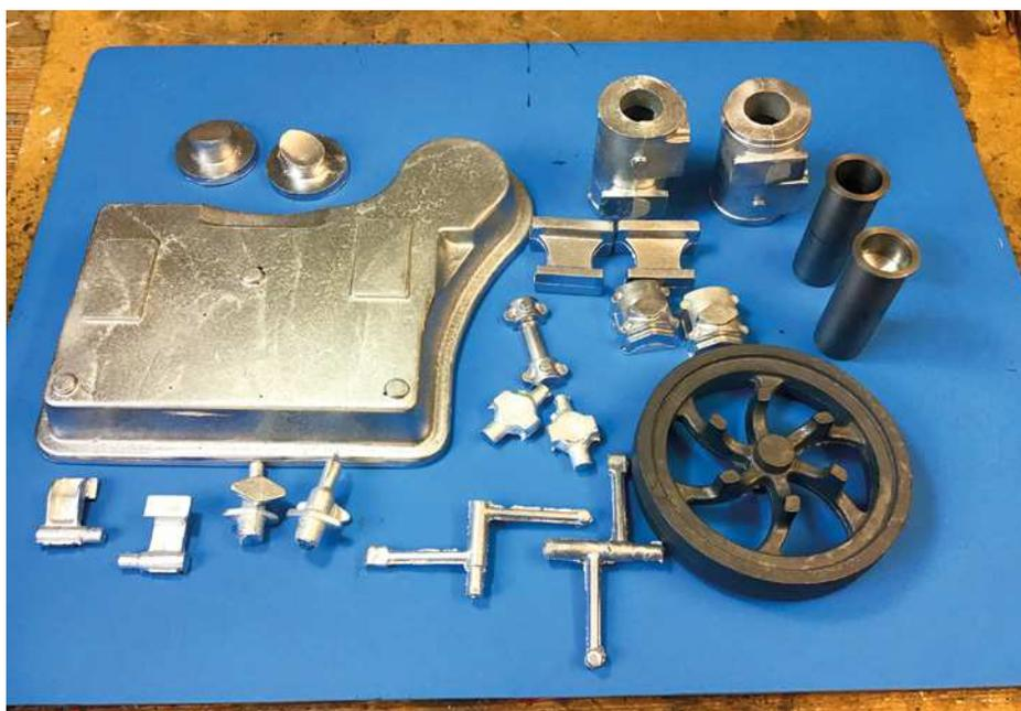
Der Gussteilesatz, auf dem Bild fehlt noch das später gelieferte Kurbelgehäuse, die Laufbuchsen sind schon fertig
