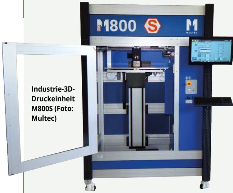
**Industrie-3D-Druckeinheit M800S (Foto: Multec)**
