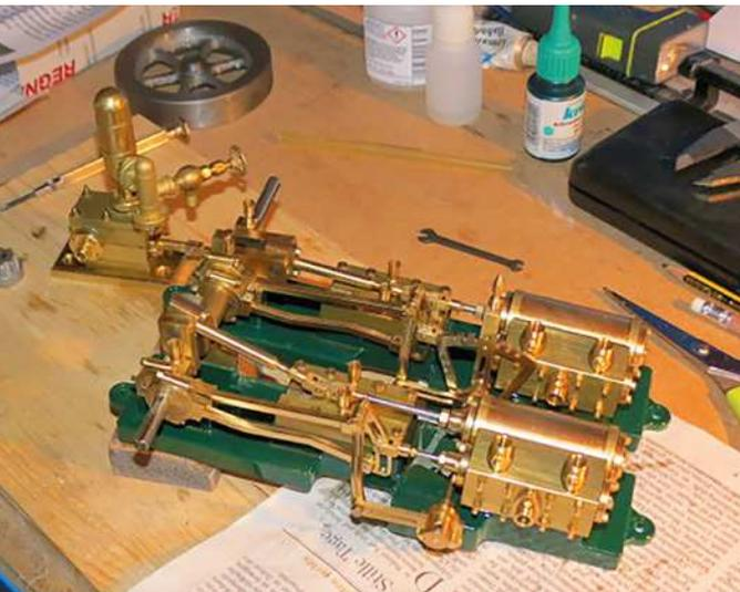
**Maschine mit Speisepumpe**
