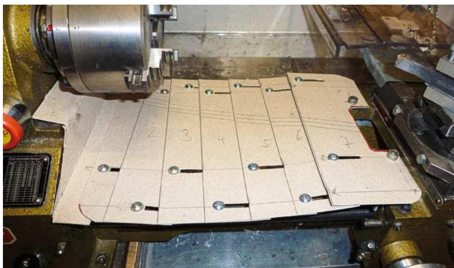
**Späneschutz für die Drehmaschinen-Bettführung**
