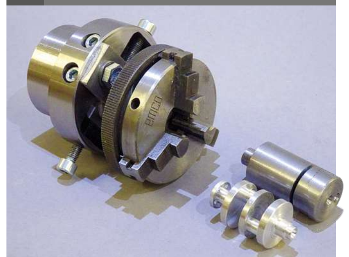
Hilfsvorrichtung zum Drehen von Exzentrern
