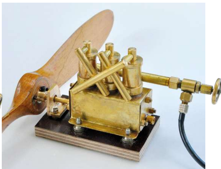
Anschluss an den Airbrushkompressor, der Probelauf steht bevor
