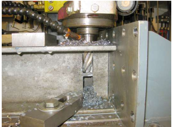
Von beiden Seiten wird mit dem 20-mm-Fräser gefräst
