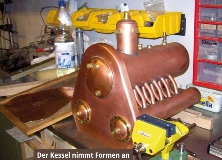
Die Armaturen wurden teilweise selbst gebaut, auch nach Bauplänen des VTH
