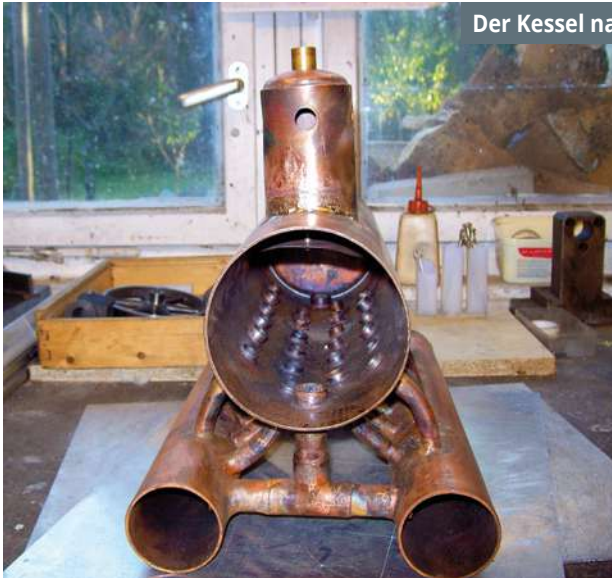
Hilfsvorrichtung für das Verlöten des Kessels
