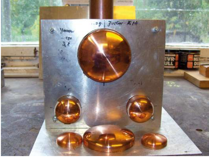
Hilfsvorrichtung für das Verlöten des Kessels
