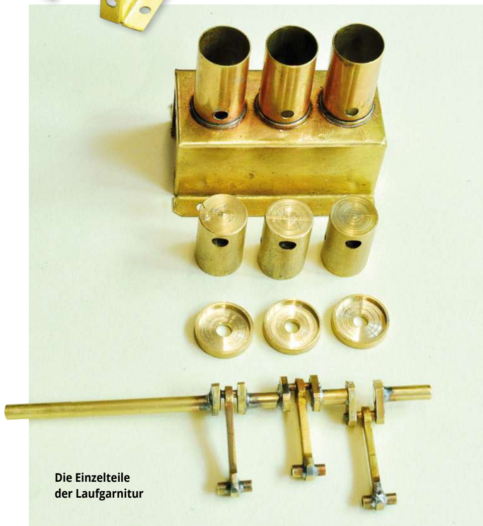
Die Kurbelwelle aus verlöteten Messingteilen
