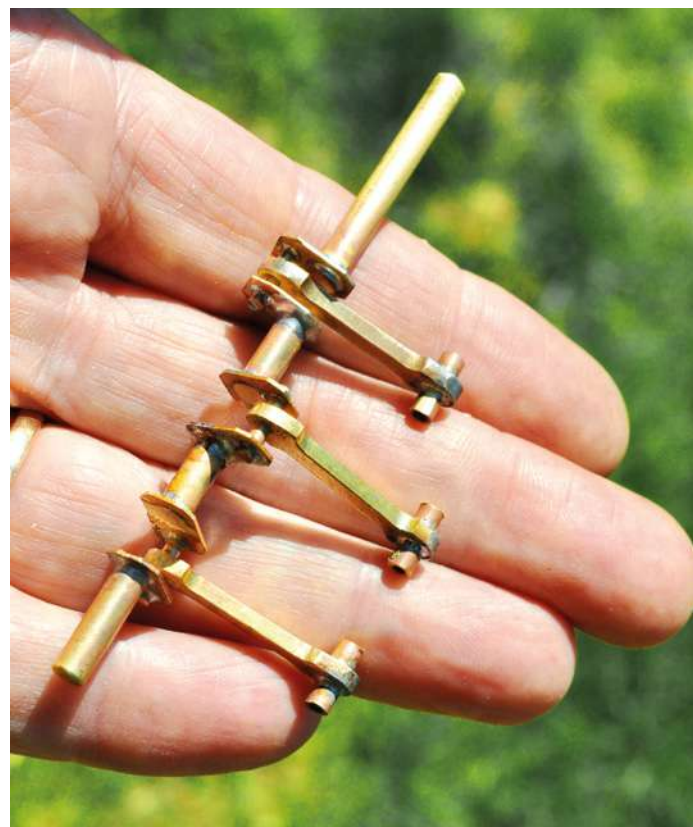
Die Kurbelwelle aus verlöteten Messingteilen
