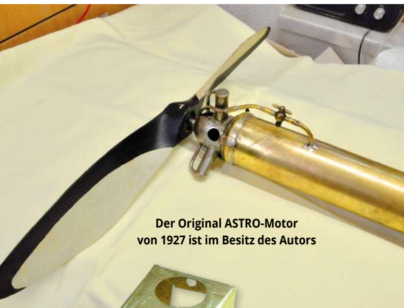
◄ Das aus 0,5-mm-Mes- singblech gebogene Motorgehäuse
