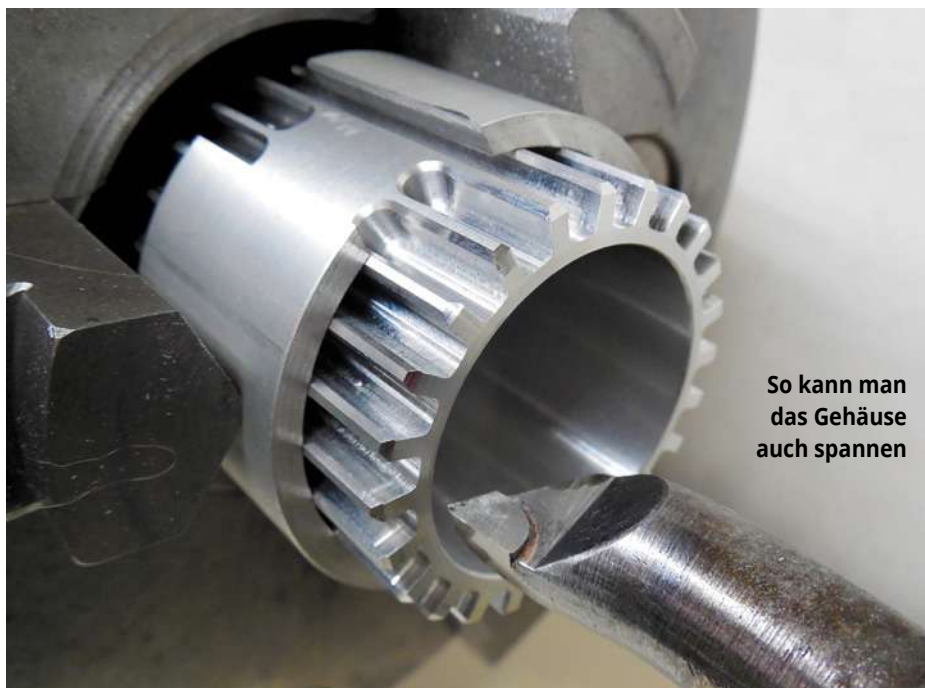
Der Innendurchmesser wird ausgedreht
