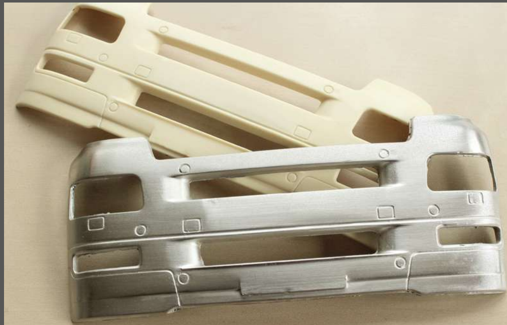
Die galvanisch hergestellte Kopie der Truckmodell-Stoßstange mit ihrer Vorlage aus Resin
