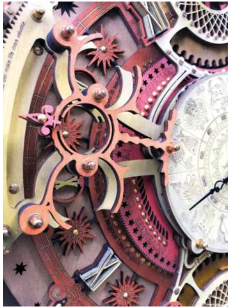
Abweichend vom Bausatz wurden viele vergoldete Messingschrauben, -muttern und -nieten verwendet
