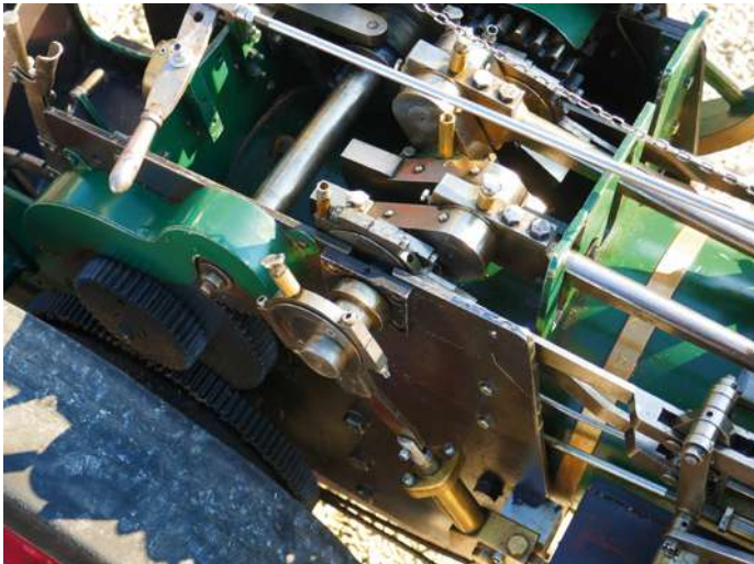
Freelance Modell: Triebwerksblick von oben: zwischen Hinterrad und Frontplatte: vorn mechanische Wasserpumpe dahinter der Abtrieb der zweiten zur dritten Welle; Schwungrad; 2-zyldrige, massige fein ausbalancierte Kurbeln in 90°-Stellung
