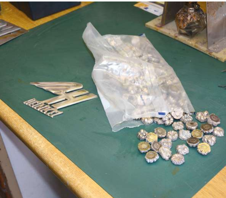
Die „Crowns“, auch Nickel-Rosen genannt, sind der Rohstoff für das Repro-Emblem
