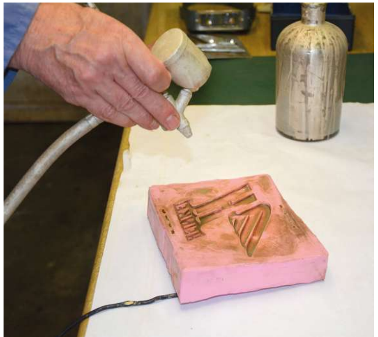
Gunter Kühn besprüht die Form mit einer leitfähigen Silberschicht. Diese muss komplett dicht sein, sonst misslingt die Oberfläche der Reproduktion. Gut zu erkennen auch der eingegossene Elektrodraht
