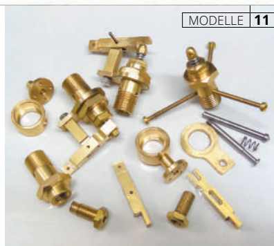
Die Einzelteile der Ventile, auch sieht man die drei Schrauben zum Klemmen des Ventilschaftes
