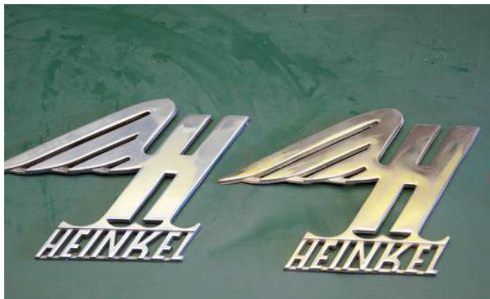
Das linke Original aus Aluminium hat einen etwas kälteren Glanz, ansonsten sind beide Teile einschließlich einer kleinen Schramme absolut identisch!
