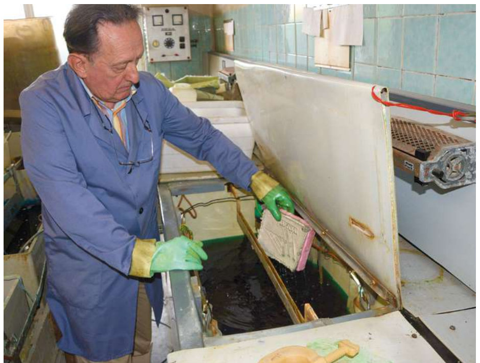
In zwei bis drei Tagen in nickelsalzhaltiger Säure lagern sich im Gleichstrom zwischen 1,5 und 3 Volt mit 1 bis 5 Ampere die Nickelionen Teilchen für Teilchen an der Silberoberfläche an, bis ein massives Stück von mehr als zwei Millimetern Stärke entsteht
