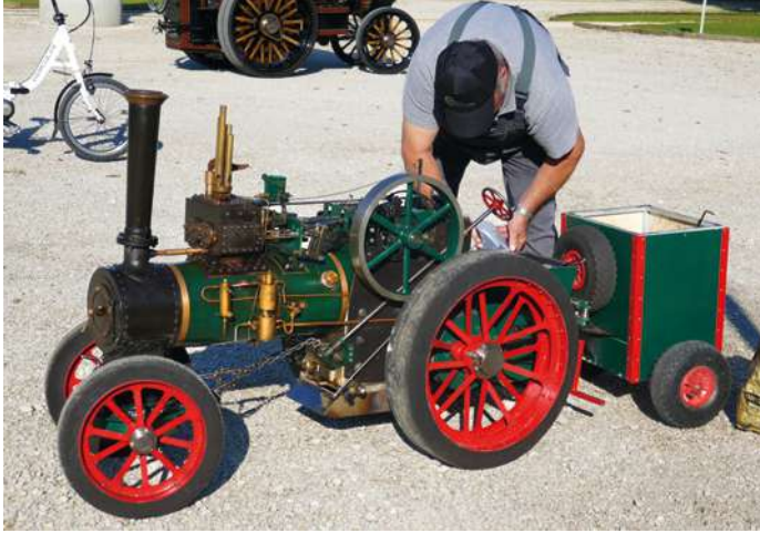
Freelance-Modell, Zweizylinder; mit linksseitiger Dampfspeisewasserpumpe die auch bei Maschinenstillstand fördert; davor Verdrängungsöler; Mehrklangpfeife auf dem Zylinder; dahinter die mechanische Ölpumpe; Sitzanhänger mit innerem Stauraum und Hängerreserverad
