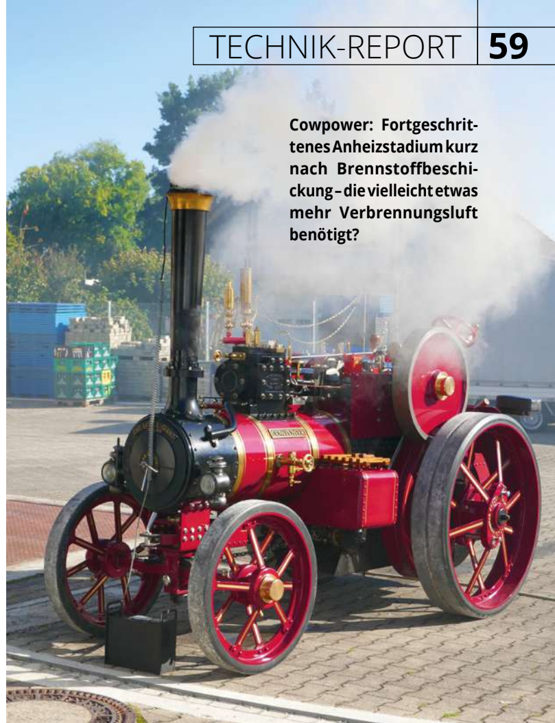
Freelance-Modell, Zweizylinder; mit linksseitiger Dampfspeisewasserpumpe die auch bei Maschinenstillstand fördert; davor Verdrängungsöler; Mehrklangpfeife auf dem Zylinder; dahinter die mechanische Ölpumpe; Sitzanhänger mit innerem Stauraum und Hängerreserverad
