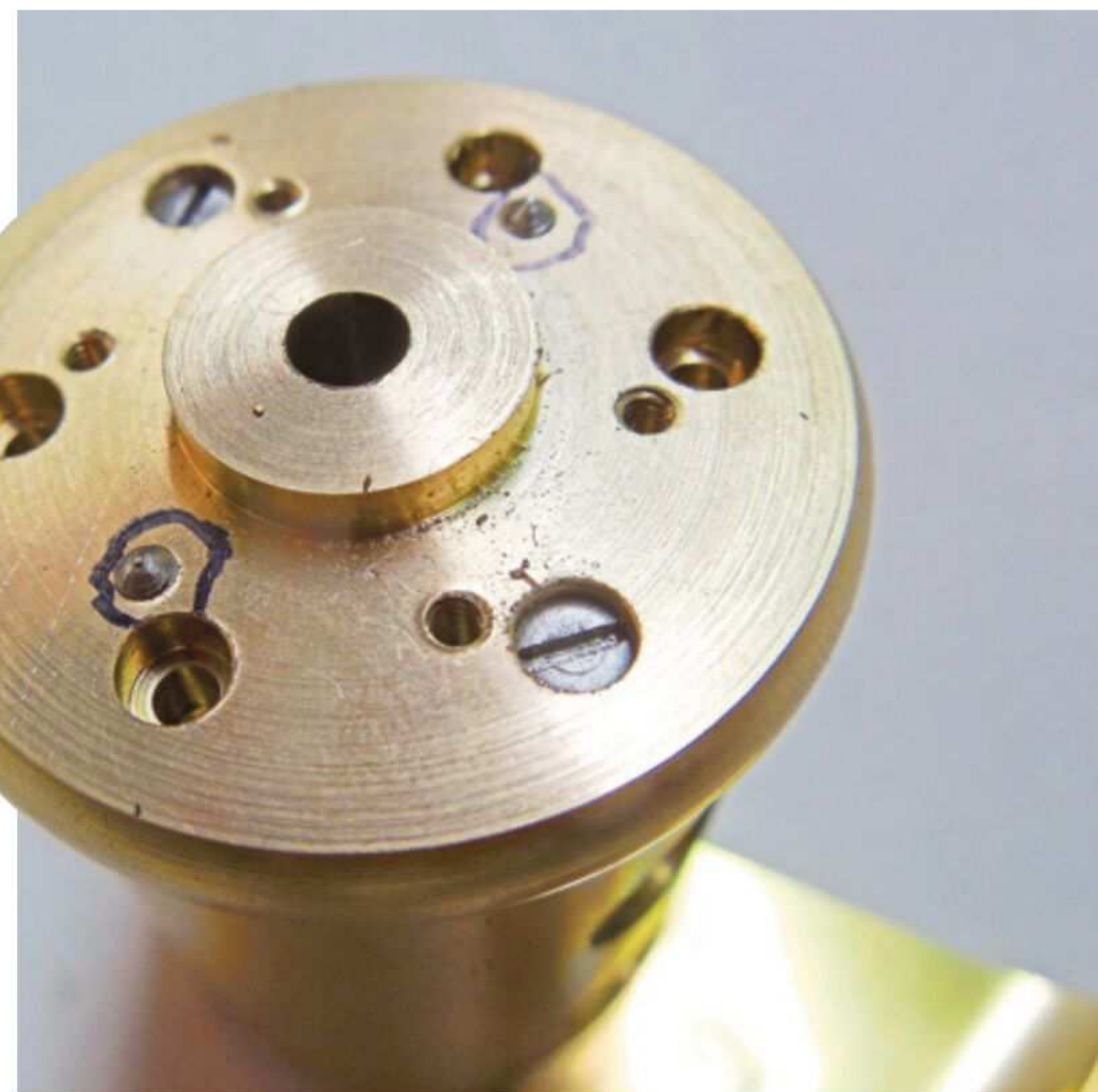
Das Mittelteil zum Ankörnen der Bohrung, zu sehen auch die angespitzten Stiftschrauben
