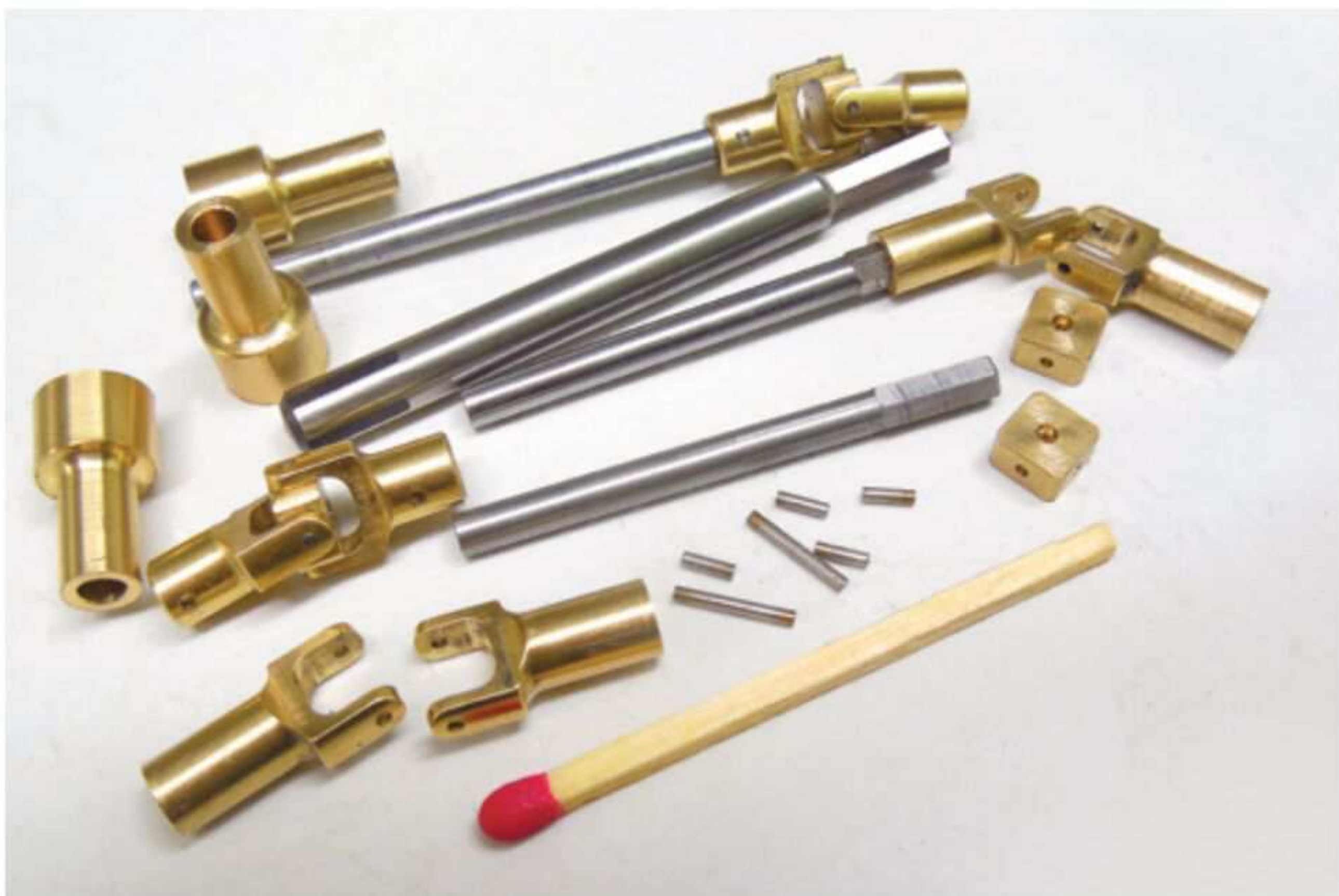
Einzelteile vom Kardangeln. Mit dem zweiten Stempel von oben wird der Sechskant gestoßen
