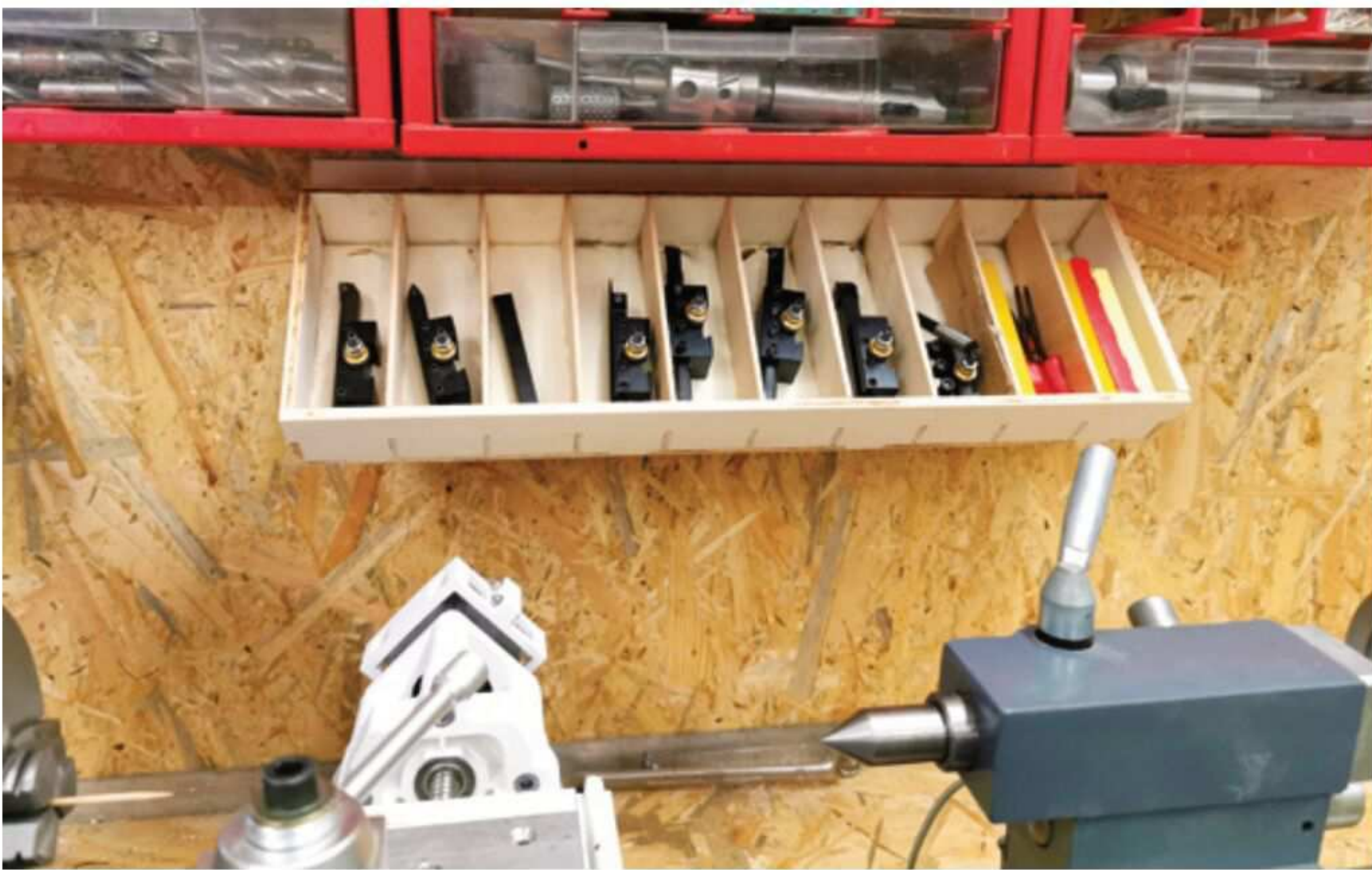
Das Magazin für Drehstähle mit Halter
