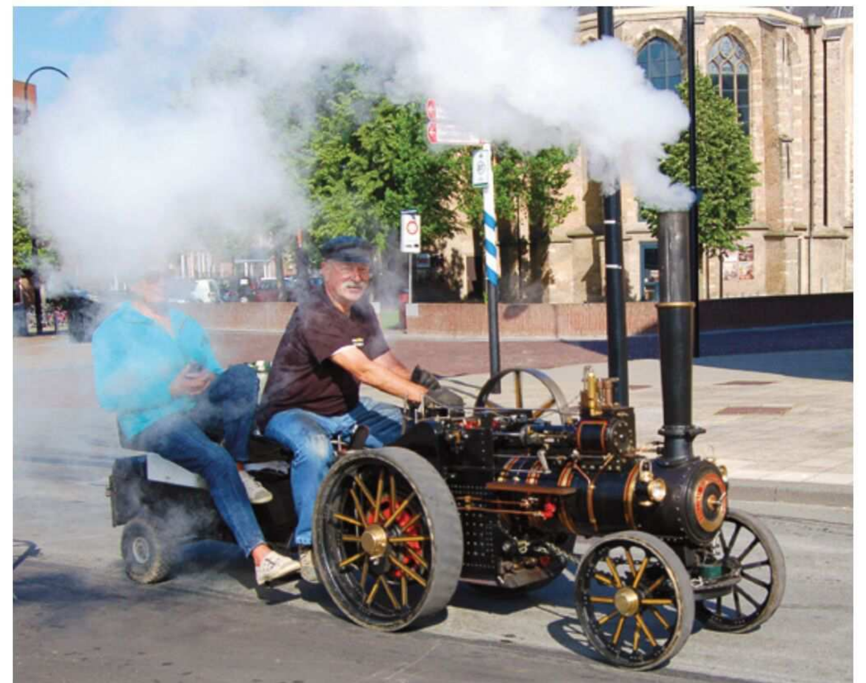
Anfahrt am frühen Morgen zum Ausstellungsbereich am Hafen. Dabei z. B. ein niederländisches Foster Modell; Maßstab 1:3; zwei Gänge; wegen des besonders zugangsfreiliegenden Maschinenaufbaus und seiner Kraft, sehr beliebt und als solides Erstmodell mehr als dauerhaft ein ganzes dampferlebenlang empfehlenswert!
