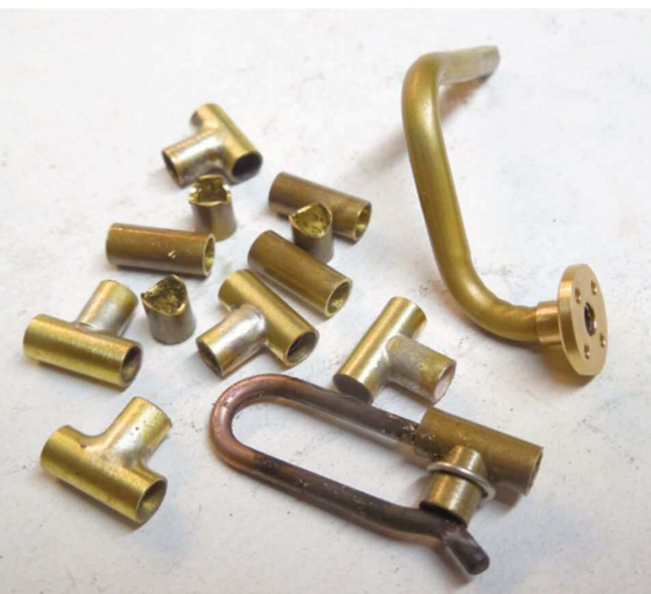
Herstellung der T-Verteiler, im Inneren des Bogens sieht man die leichten Falten
