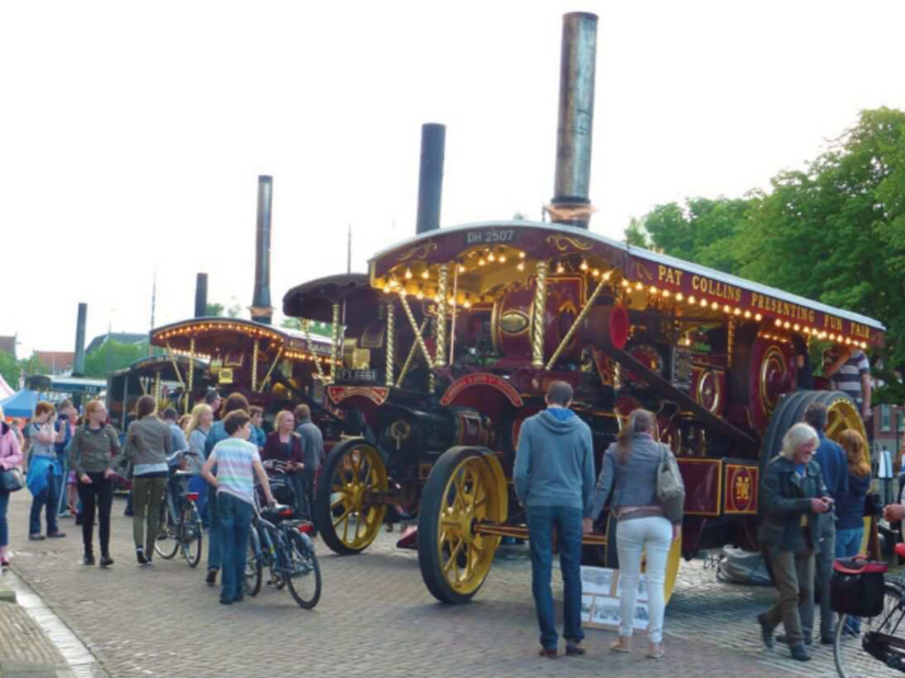
Vorn Seitenansicht der Pat Collins Maschine Burrell Showmansengine DH 2507 von 1920; DCC; 8 NHP (ein New Horse Power entspricht etwa sieben PS); Pat Collins ist ein auf der Insel wohl bekannter und dampfaktiver Fan wie ich seit 1990 Dordrecht!
