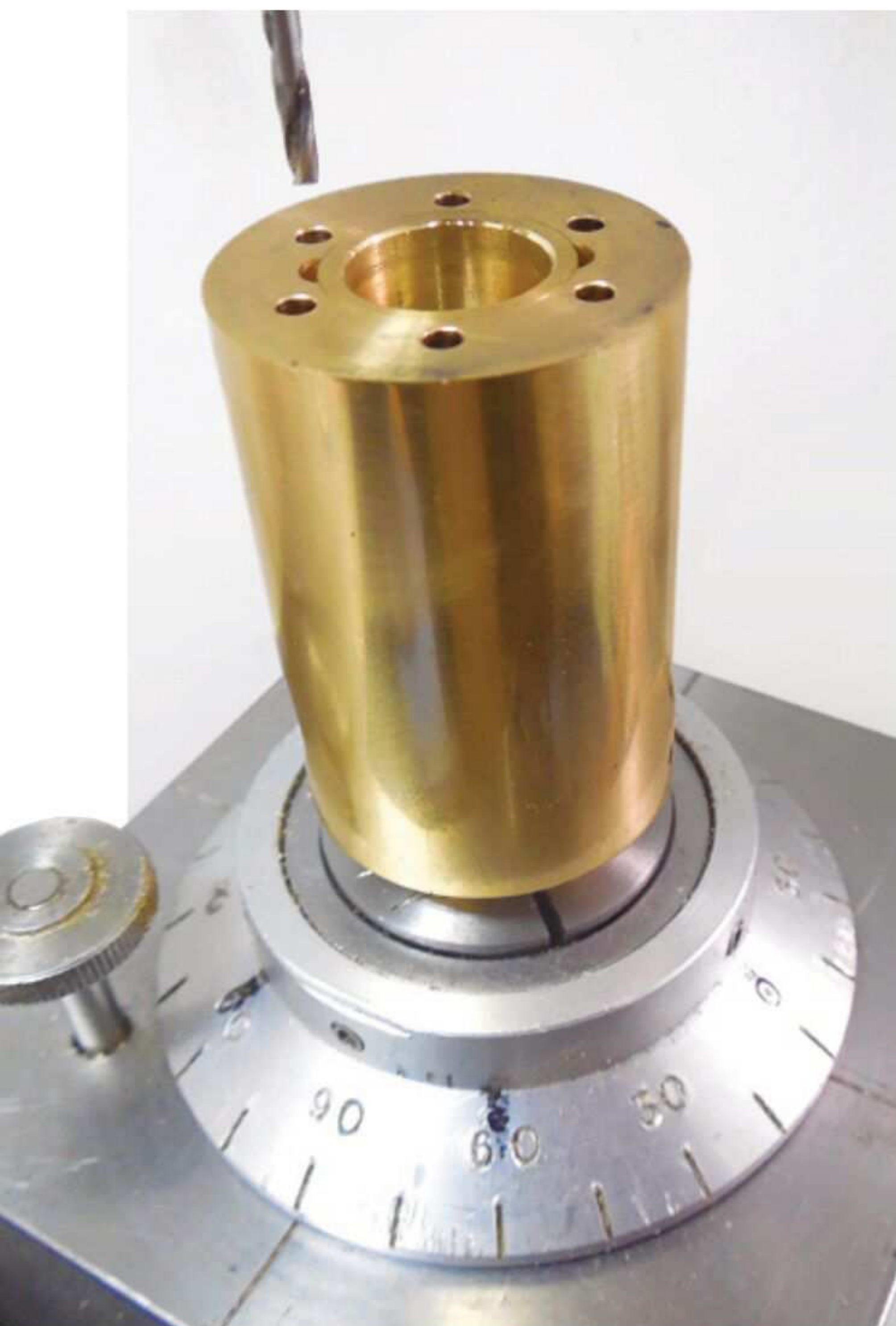
Die Bohrungen, welche durch den ganzen Zylinder gehen, werden hergestellt
