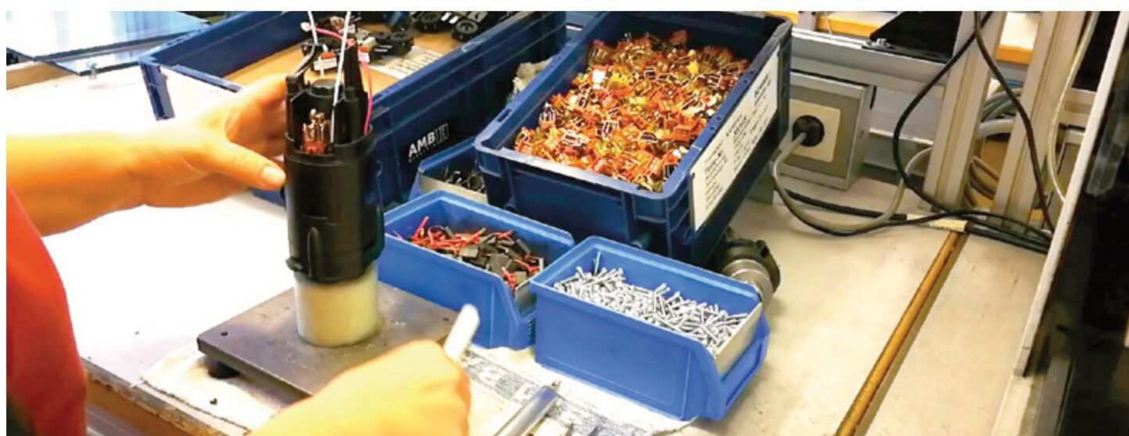
Montage der Kohlebürstenhalter mit Bürsten
