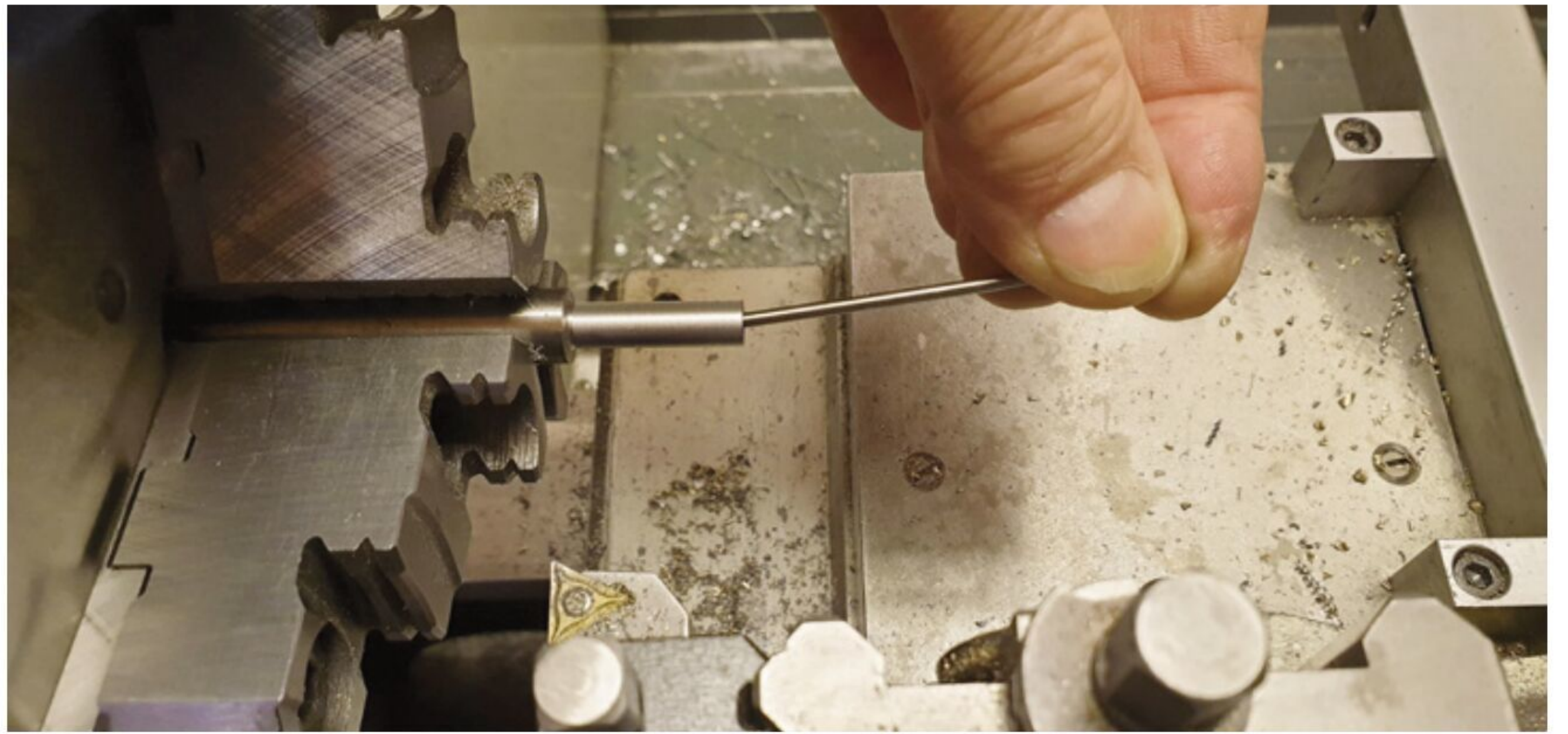
Bild 3: Der Test mit der Stößelstange in wie weit der Winkel sich ändern lässt
