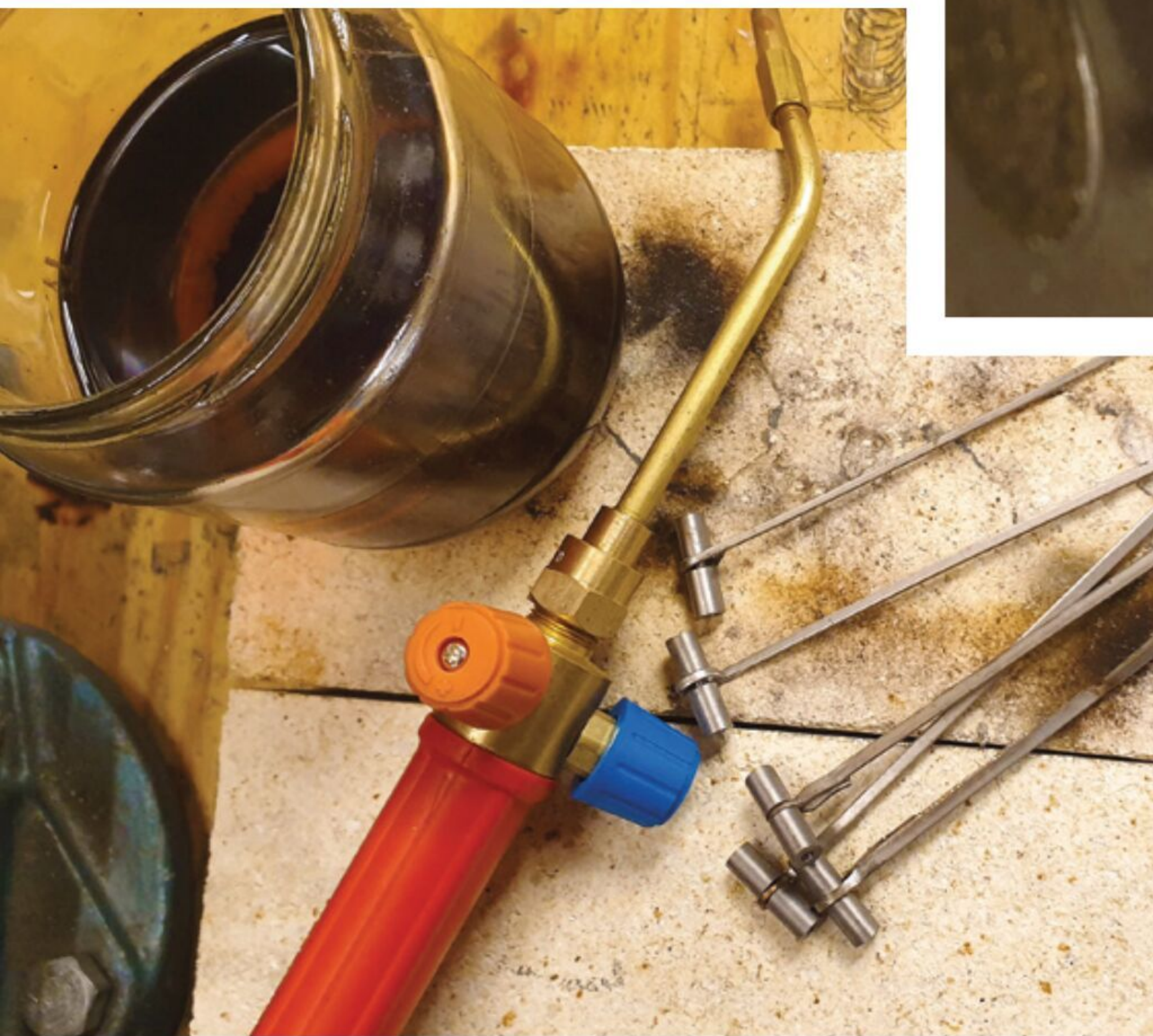
Bild 5: Fünf Paar Stößel zum Härten vorbereitet. Das Ölbad zum Abschrecken befindet sich im Glas
