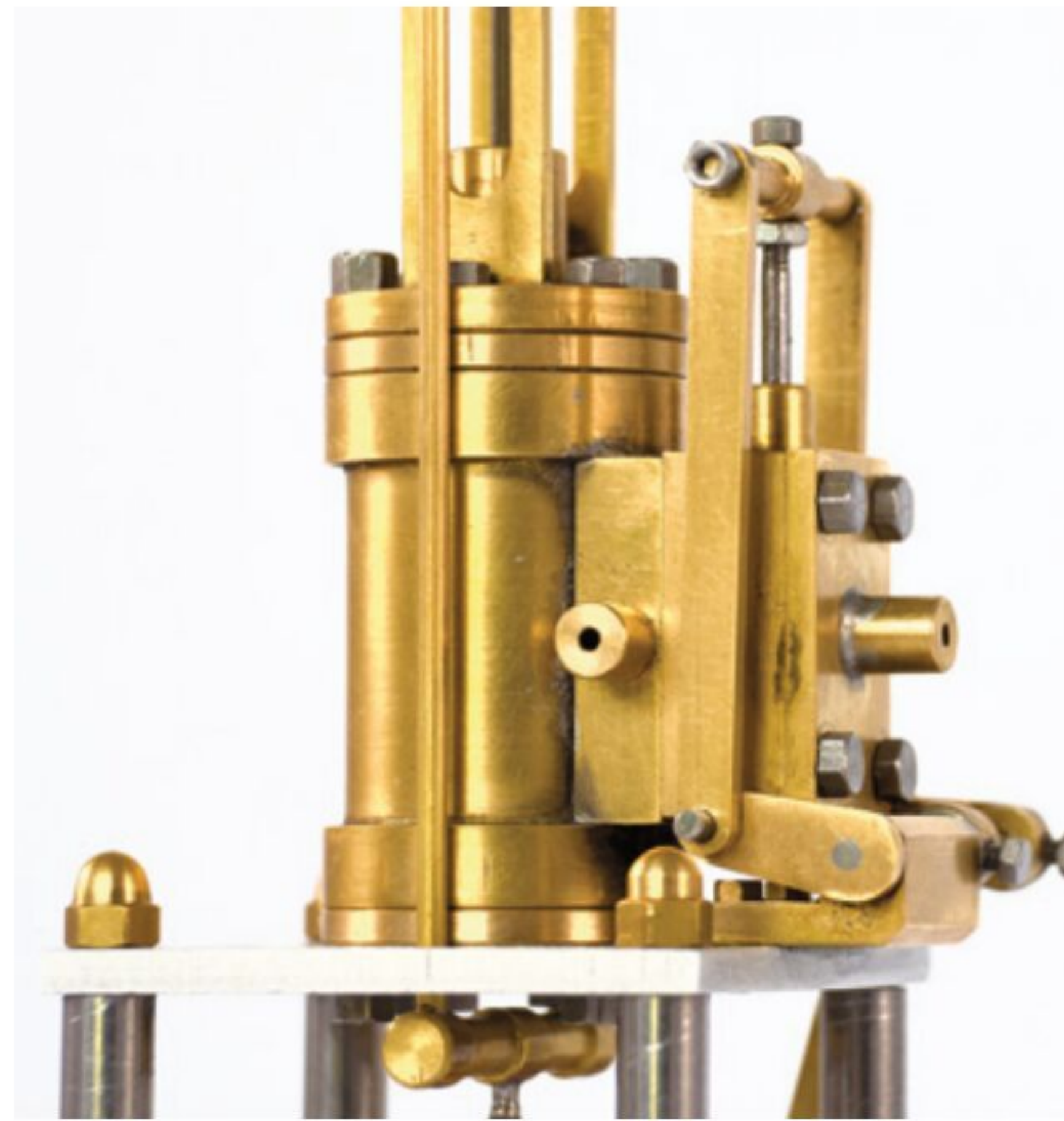
Der Zylinder wird aus Messinggrundmate- rial gefertigt
