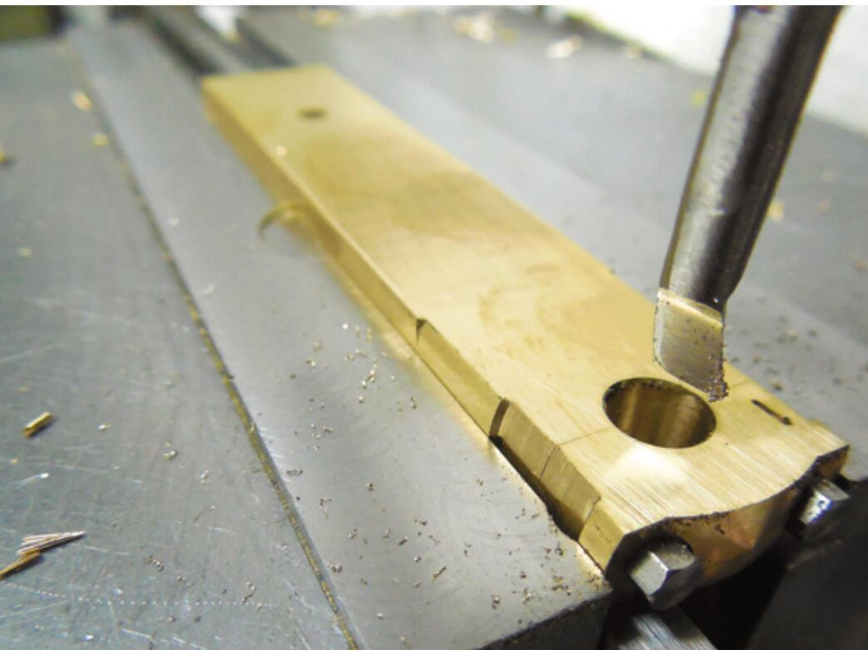
Herstellung der Pleuelkopf Bohrung
