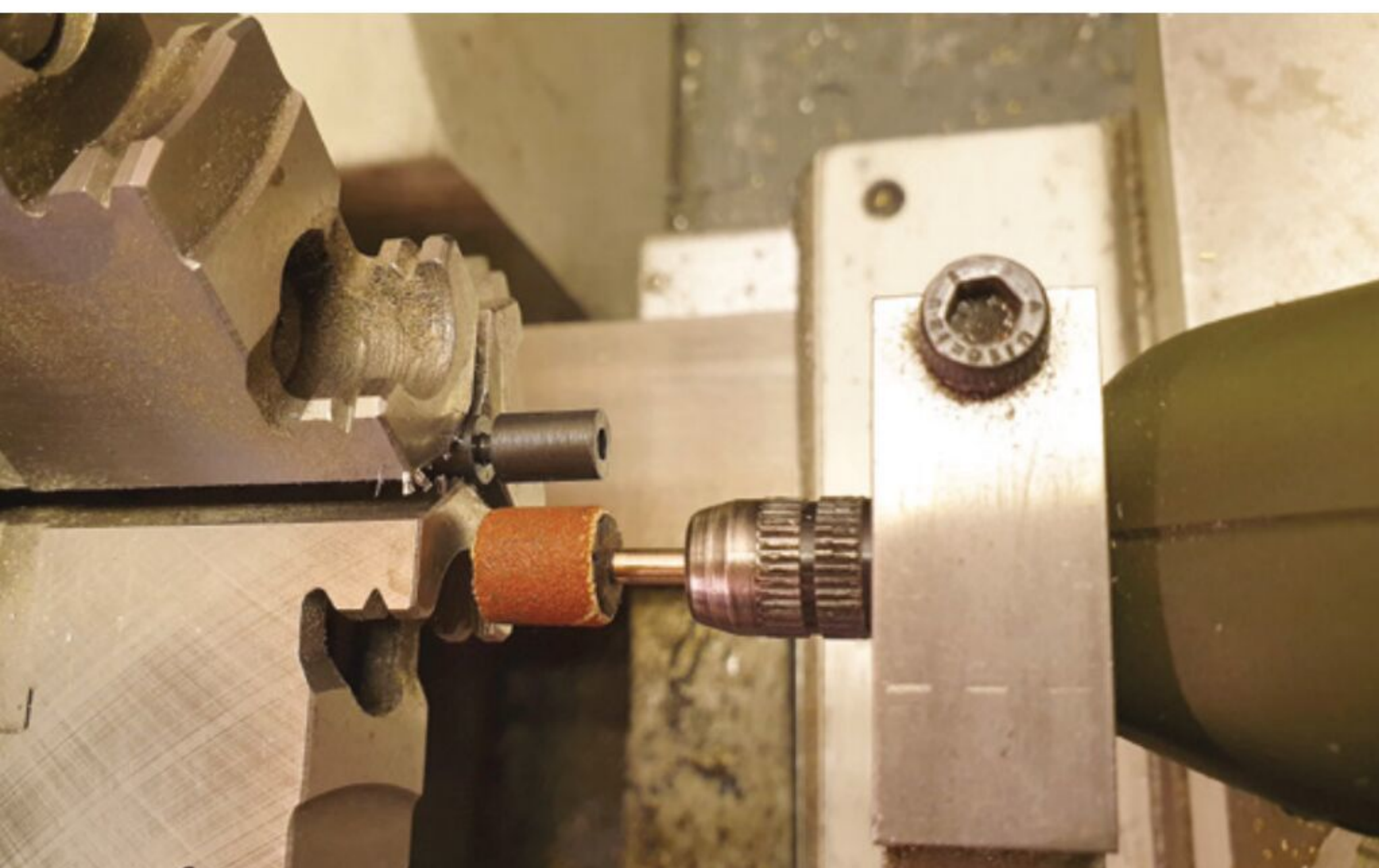
Bild 7: Der Stößel wird geschliffen...
