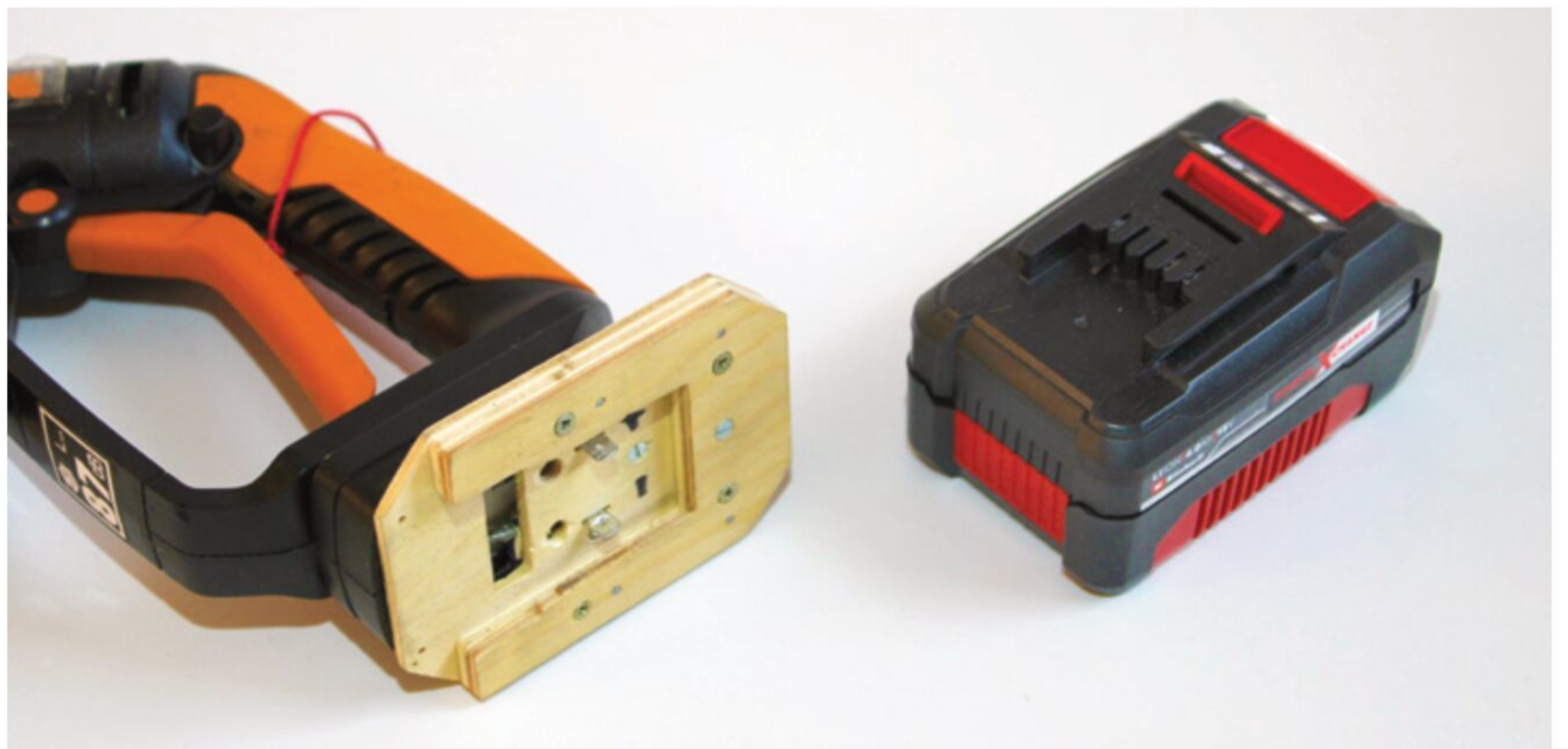
Der Umbau für den Worx-Hochdruckreiniger basiert auf gefrästen Holzplatten. Die Außenkontur war ursprünglich für eine Akkuschrauber und war bereits ausgefräst vorhanden
