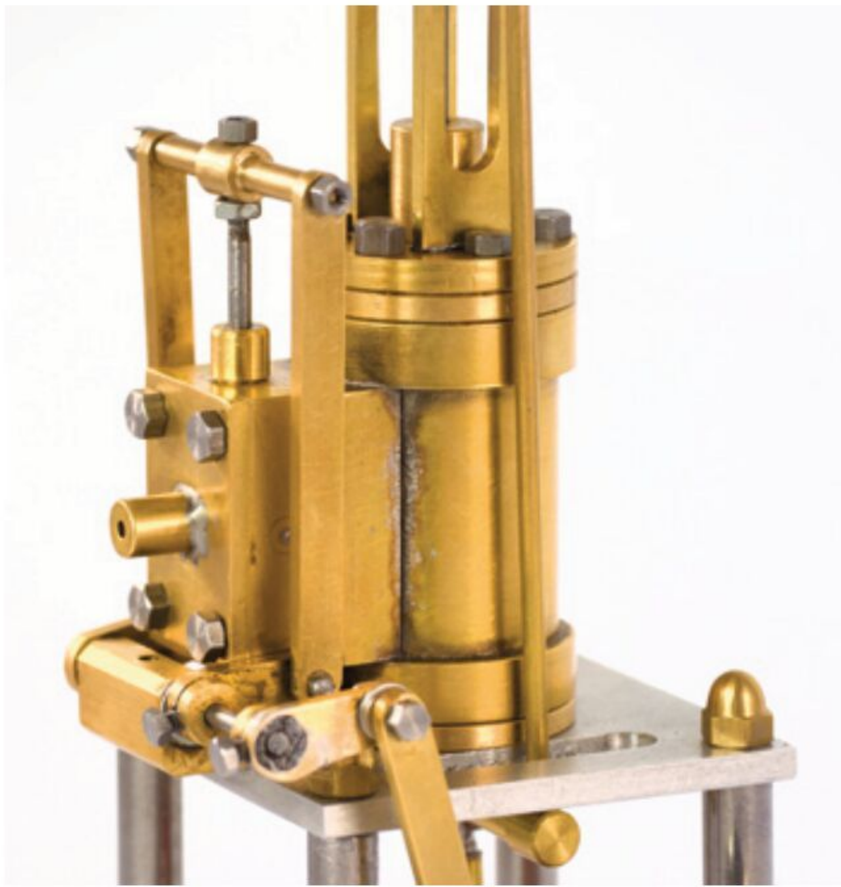
Charakteristisch ist der Maschinentisch, hier auch gut zu sehen das Schieberge- stänge
