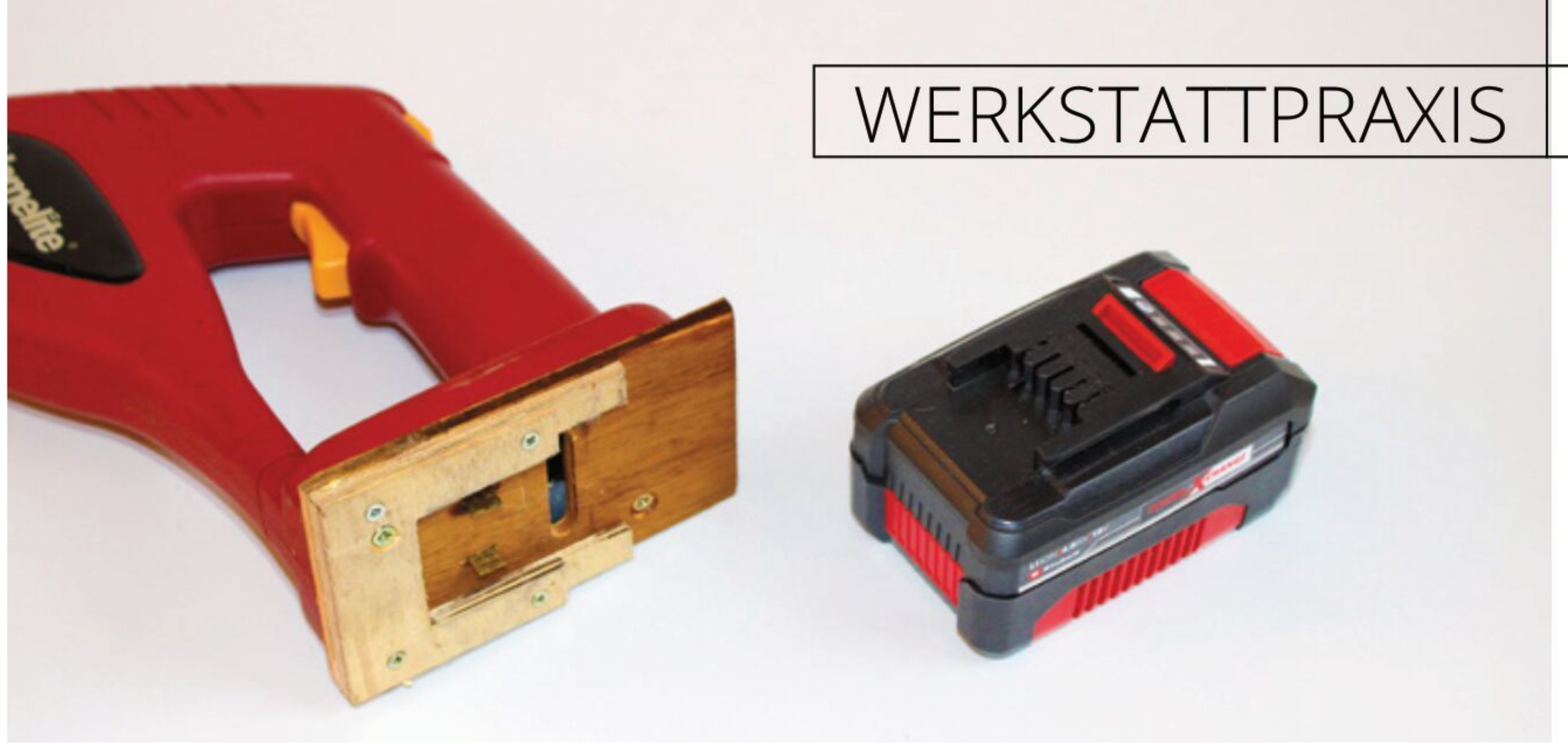
Ein früherer Umbau der Astsäge. Die vorhandenen Sperrholzplatten sind eher grob ausgesägt und die Kontakte von oben mit Heißkleber eingeklebt. Sieht nicht so schön aus, aber funktioniert
