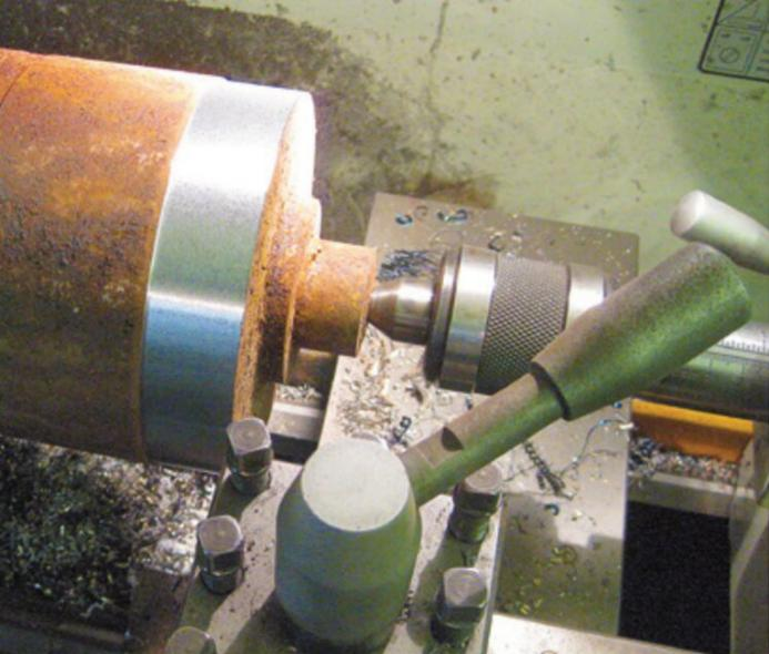
**Bild 15: Materialauflagerollen drehen**
