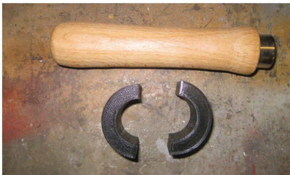
**Bild 18: Die fertigen Teile für die Kurbel**
