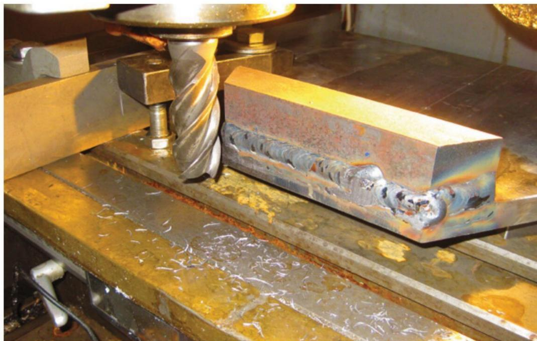
**Bild 3: Das Überfräsen an der oberen Verstärkung kann beginnen**
