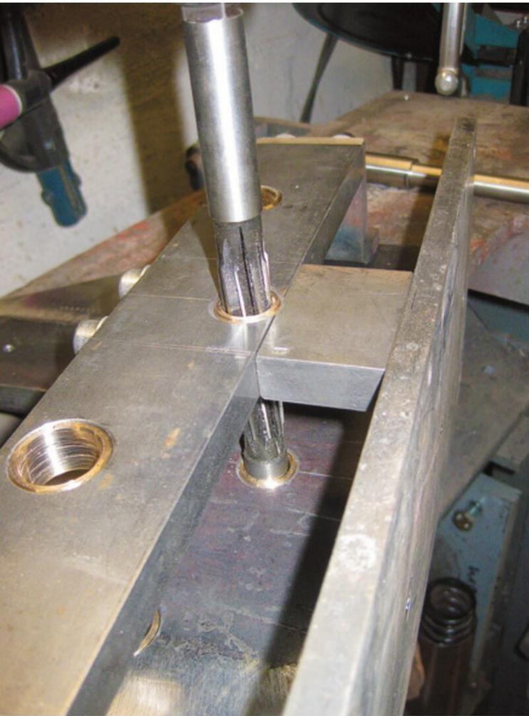
**Bild 20: Bohrung 15 mm wird gerieben**
