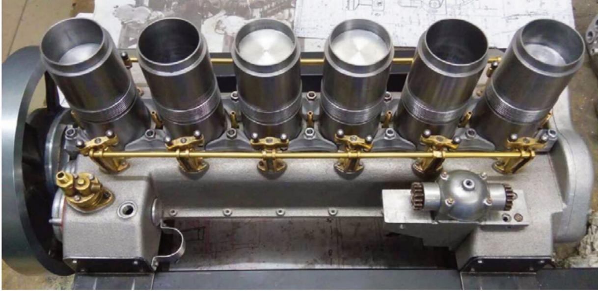
Die Zylinderlaufbuchsen mit Kolben
