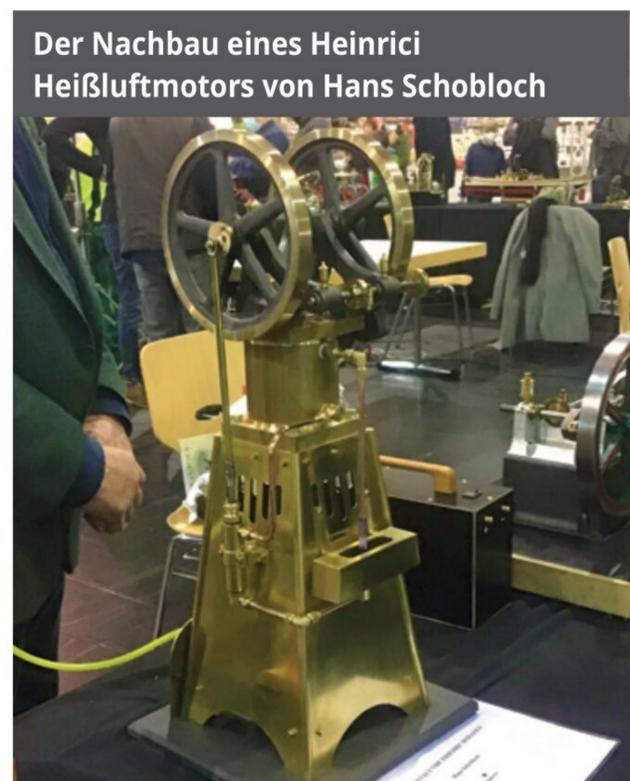
Der Nachbau eines Heißluftmotors von Hans Schobloch
