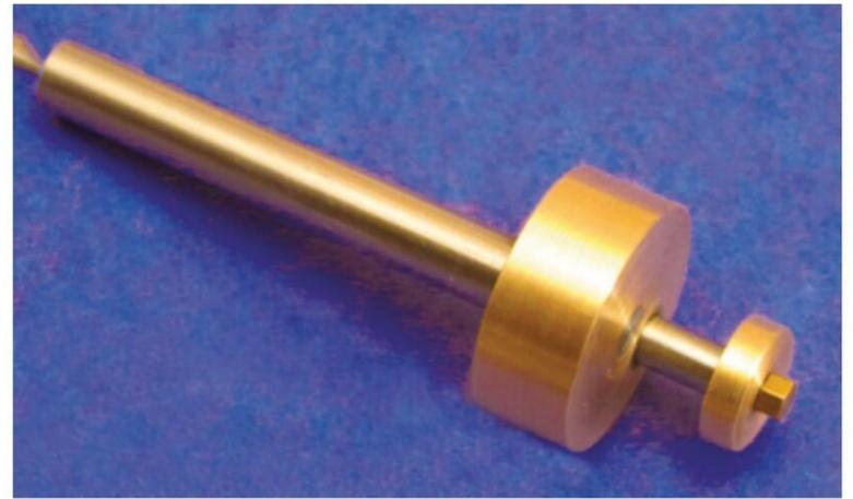
Abb. 11: Die fertige Kurbelwelle mit Fixierdeckel
