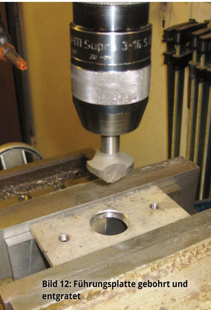
Bild 12: Führungsplatte gebohrt und entgratet
