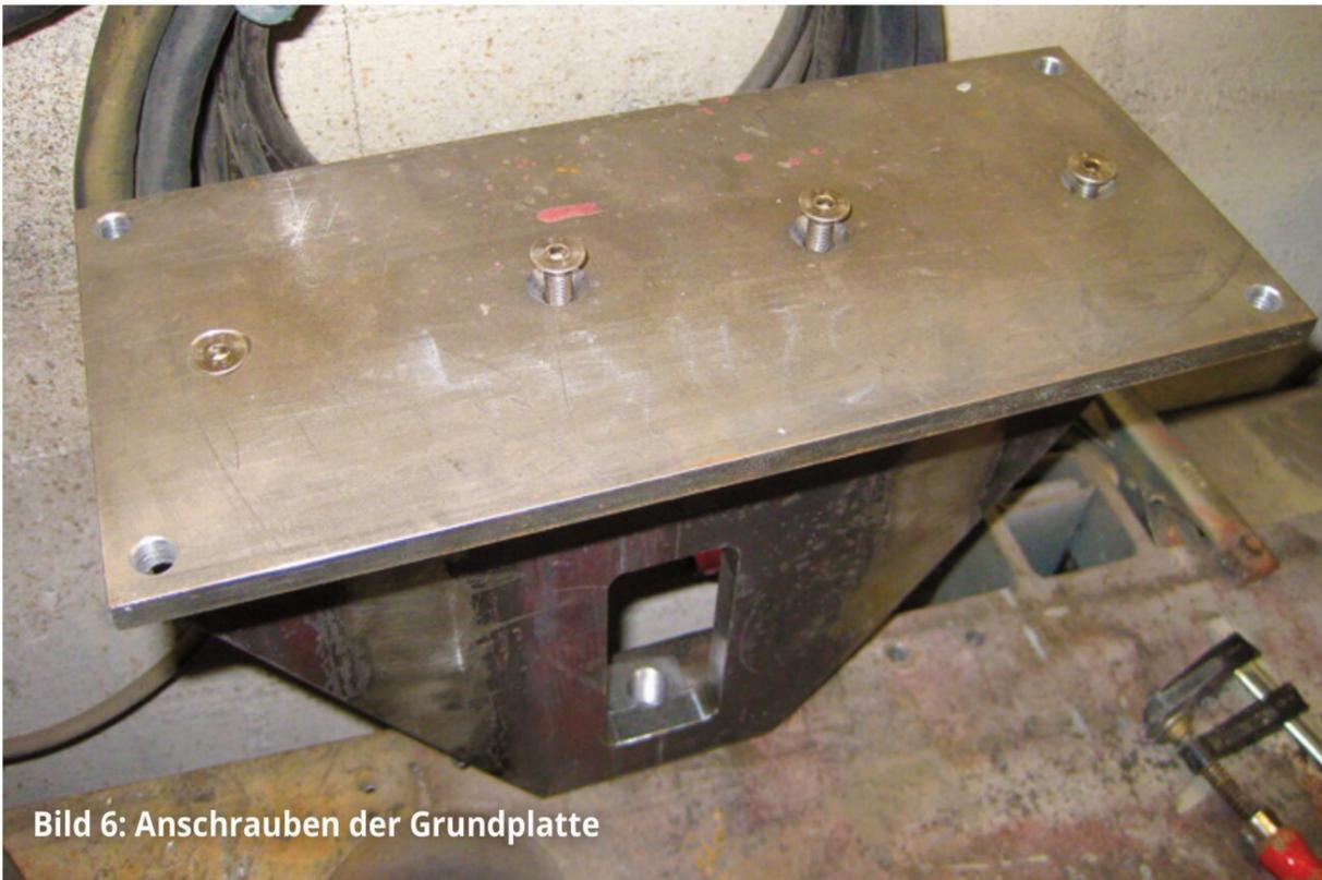
Bild 6: Anschrauben der Grundplatte
