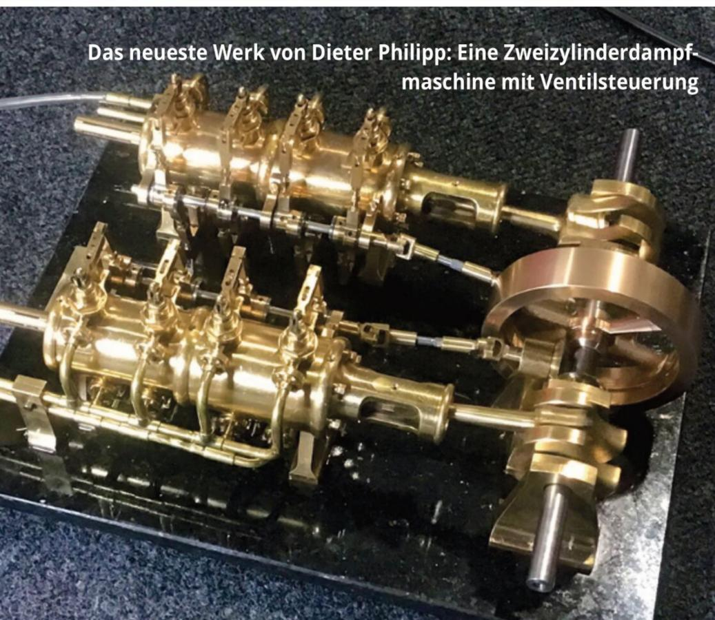
Das neueste Werk von Dieter Philipp: Eine Zweizylinderdampfmaschine mit Ventilsteuerung
