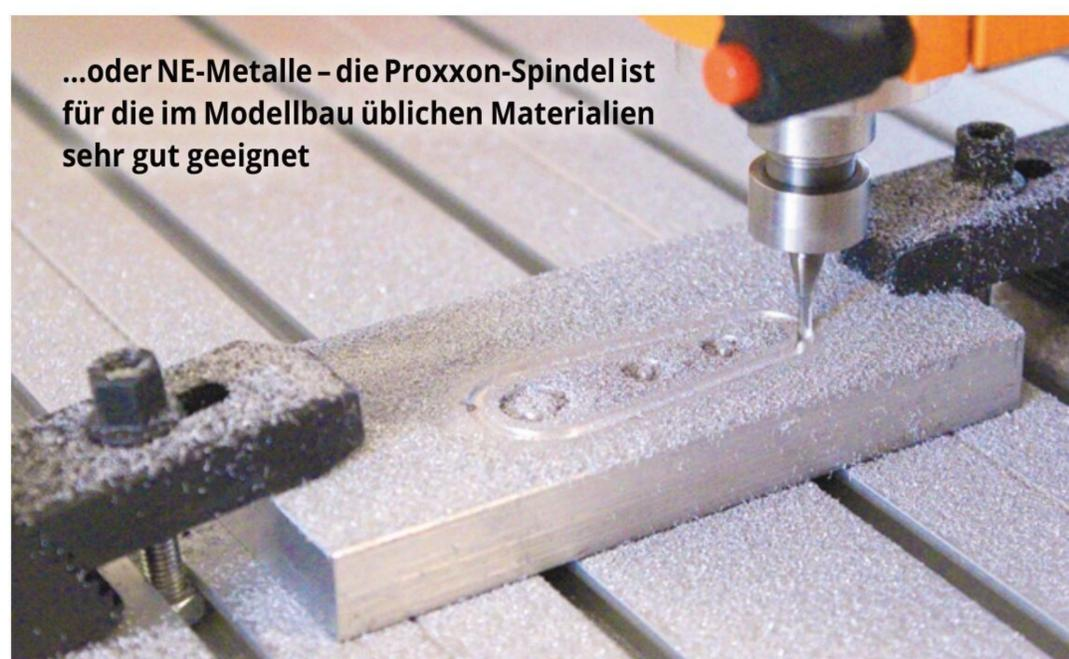
...oder NE-Metalle – die Proxxon-Spindel ist für die im Modellbau üblichen Materialien sehr gut geeignet
