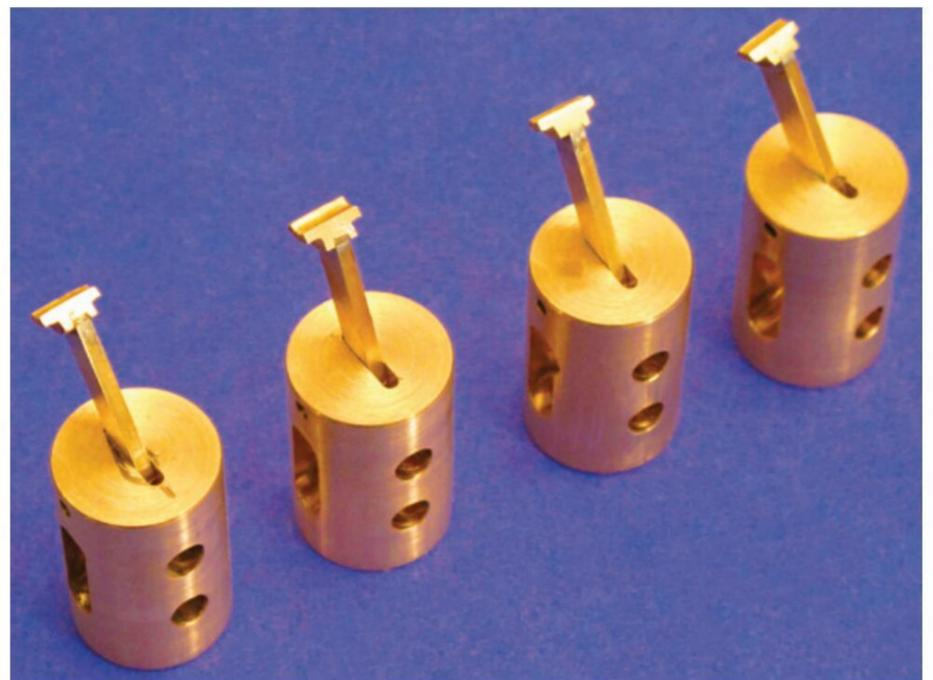
Abb. 6: Die vier Kolben mit Kolbenstange
