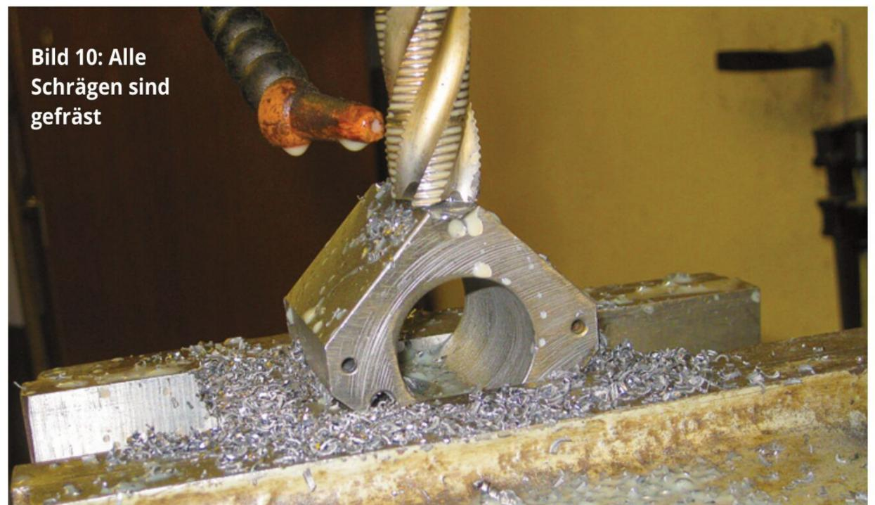
**Bild 10: Alle Schrägen sind gefräst**
