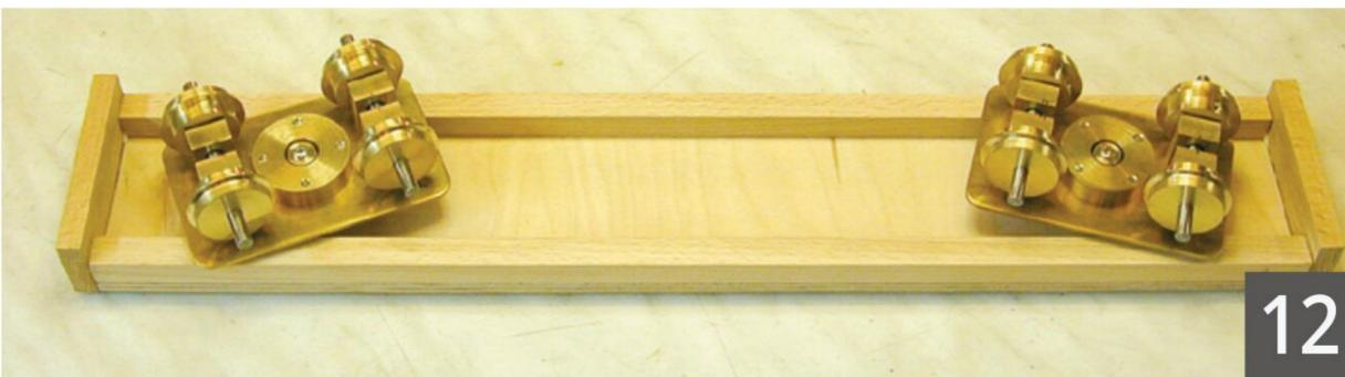
Im **Bild 11** sind die Achsträger an der Bodenplatte angeschraubt, darin stecken fest die kurzen Achs-Stücke. Die Montageschrauben mit Unterlagen für die aufsteckbaren Rad-Dreh-Gestelle liegen bereit.
