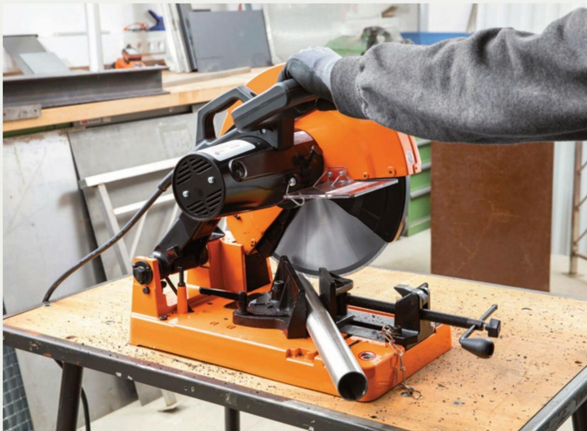
**Mit der MKAS 355 sind Trenn- und Gehrungsschnitte mit Tiefenanschlag bis 45 Grad sowohl in der Werkstatt als auch bei der Montage vor Ort möglich (Foto: Fein)**
