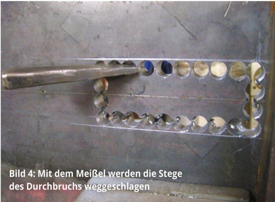
Bild 4: Mit dem Meißel werden die Stege des Durchbruchs weggeschlagen
