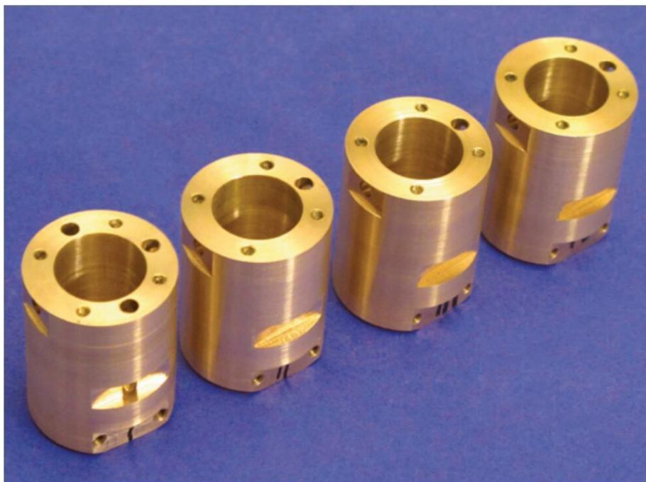
Abb. 5: Die vier vorgedrehten Zylinder
