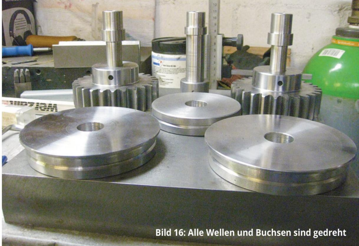
**Bild 16: Alle Wellen und Buchsen sind gedreht**
