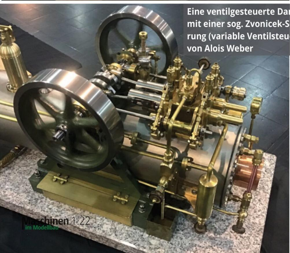
Eine ventilgesteuerte Dampfmaschine mit einer sog. Zvonicek-Schwabe Steuerung (variable Ventilsteuerung) gebaut von Alois Weber
