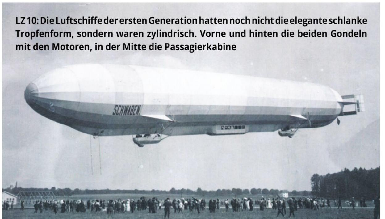
**LZ 10: Die Luftschiffe der ersten Generation hatten noch nicht die elegante schlanke Tropfenform, sondern waren zylindrisch. Vorne und hinten die beiden Gondeln mit den Motoren, in der Mitte die Passagierkabine**
