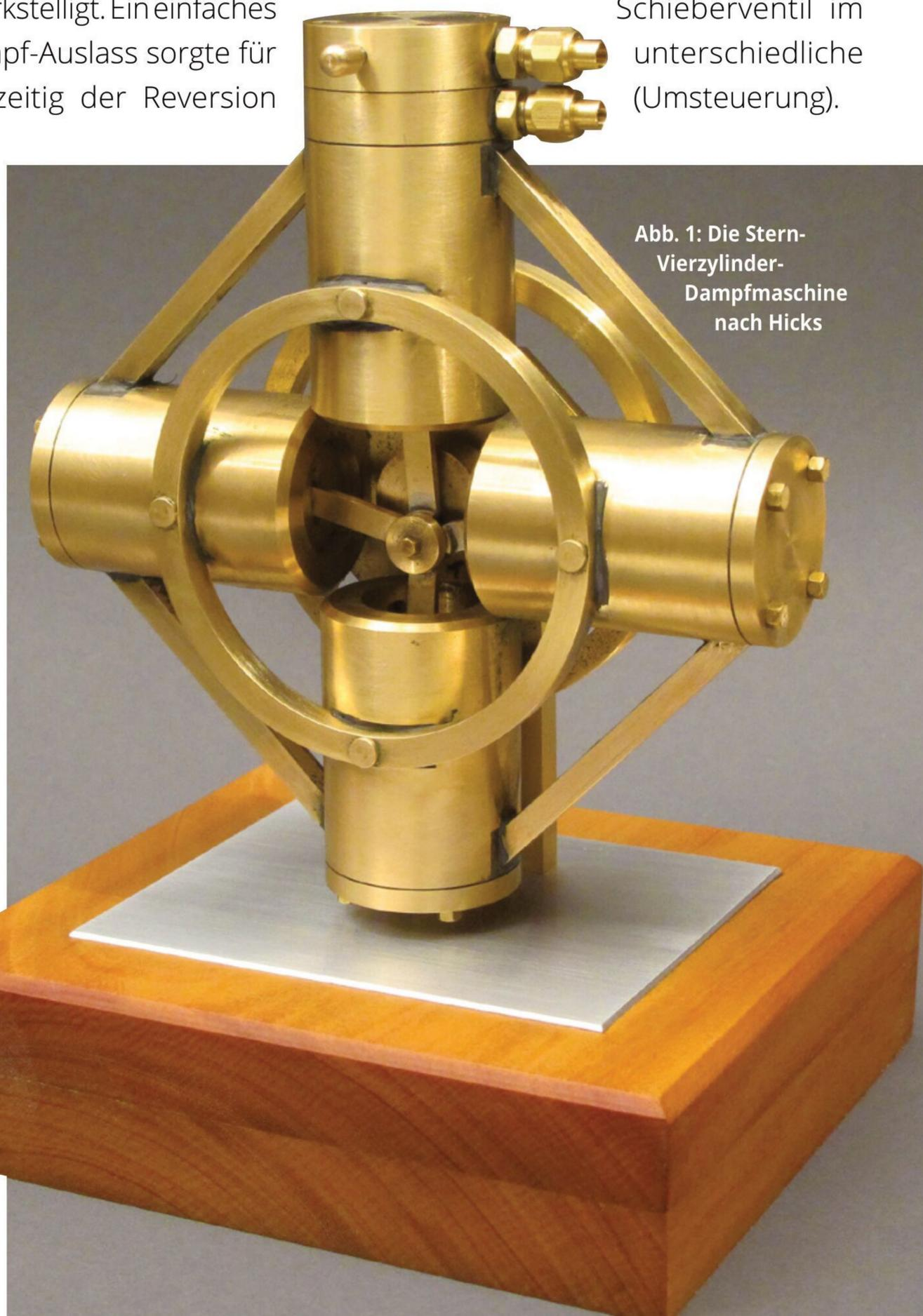
Abb. 1: Die Stern-Vierzylinder-Dampfmaschine nach Hicks
