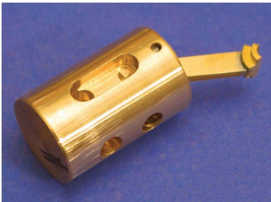
Abb. 7: Ein Kolben mit Sicht auf Dampf-schlitz und Steuerbohrungen
