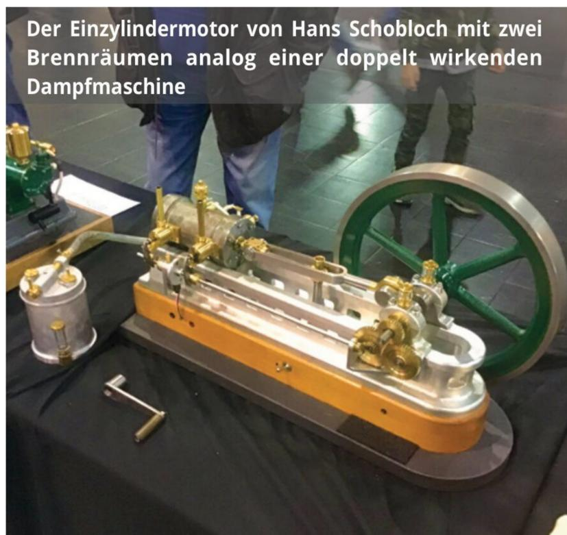
Der Einzylindermotor von Hans Schobloch mit zwei Brennräumen analog einer doppelt wirkenden Dampfmaschine
