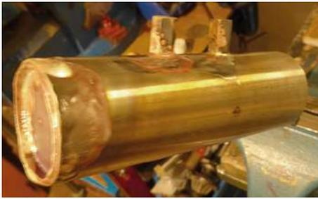
Hier sieht man den hart eingelöteten Kupferdeckel an der Unterseite sowie die angelöteten Befestigungsstege an der Zylinderwandung
