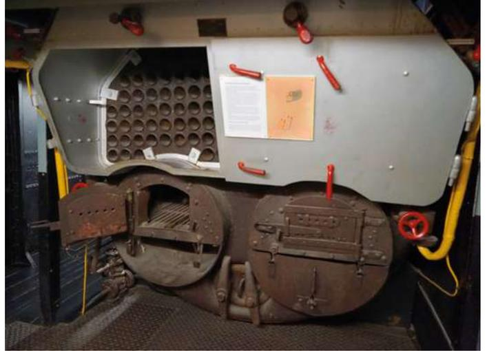
Teilgeöffnete Heizwand vom Kessel zeigt die Siederöhre; darunter oben die beiden Feuerklappen und darunter der Aschefall
