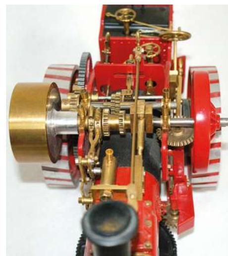
es in das Zahnrad auf der Kurbelwelle eingreift. Für den Betrieb der Trommel verpasste Regner dem Dampftraktor einen Leerlauf, der mittig über dem Kessel geschaltet werden kann. Die Drehrichtung der Trommel wird mit der Stephenson-Umsteuerung gewechselt, ohne dabei die Maschine anhalten zu müssen.
