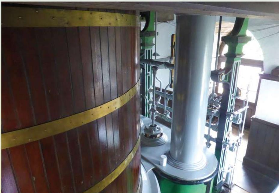
Bild 13: Zylindermantel, unterer Ventilkasten und Frischdampfzuleitung
