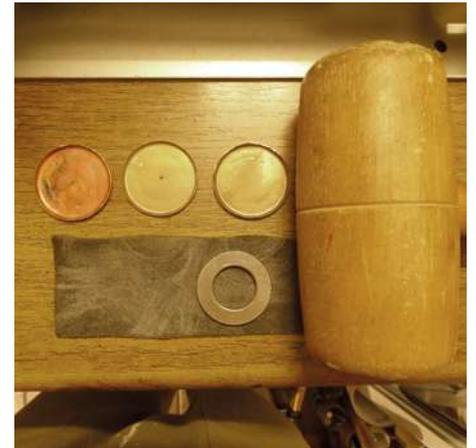
Unten die Druck-Ronde, aus einer starken Stahl-Unterlegscheibe gedreht, oben fertig gedrückte Deckel aus 0,5-mm-Kupfer- und Messingblech. Die Ronde liegt auf der Lederbeilage neben dem Kopf des Holzhammers. Bei der Arbeit vorsichtig und mit Gefühl vorgehen, damit das dünne Blech an den Rändern nicht knickt
