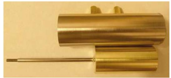
**Die fertig überarbeiteten Verdrängerbaugruppen. Es ist besonders auf Präzision und Sauberkeit zu achten. Schlimm wäre es, wenn der Kolben später an der Zylinderinnenwand schleift, also hier möglichst nicht „schludern“**
