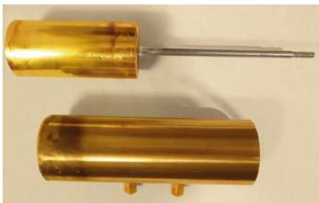
Verdrängerzylinder und -Kolben nach dem Lötén. Die Flussmittelreste sind hier bereits beseitigt
