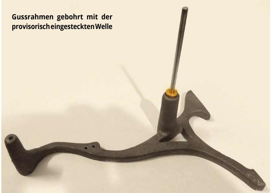
Gussrahmen gebohrt mit der provisorischeingesteckten Welle
