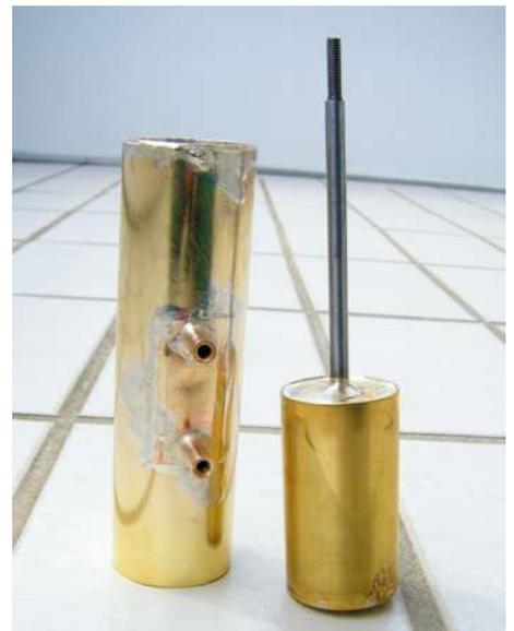
**Hier sind die Befestigungsstege zunächst mit einer gebogenen Messingplatte verschraubt, die dann mit dem Verdränger verlötet wird. Auch hier kann beim Löten nichts mehr verrutschen. Dieser Wärmetauscher ist aus den dafür vorgesehenen Materialien gebaut**
