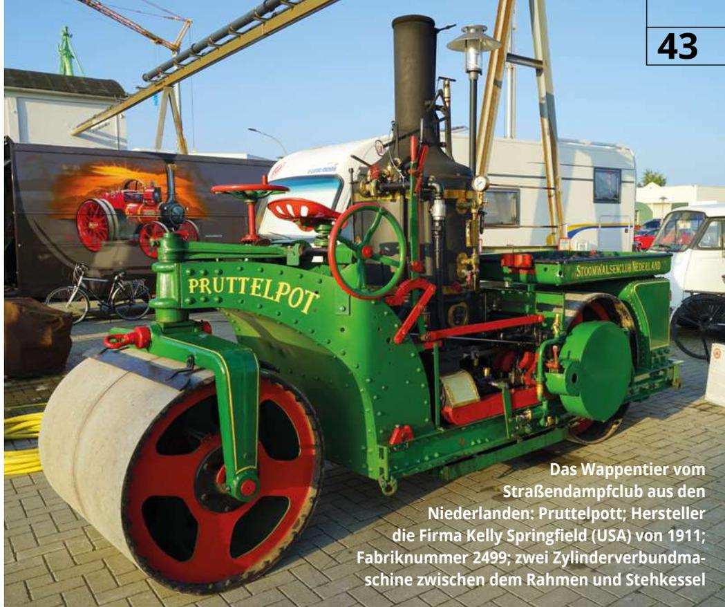
Das Wappentier vom Straßendampfclub aus den Niederlanden: Pruttelpott; Hersteller die Firma Kelly Springfield (USA) von 1911; Fabriknummer 2499; zwei Zylinderverbundmaschine zwischen dem Rahmen und Stehkessel
