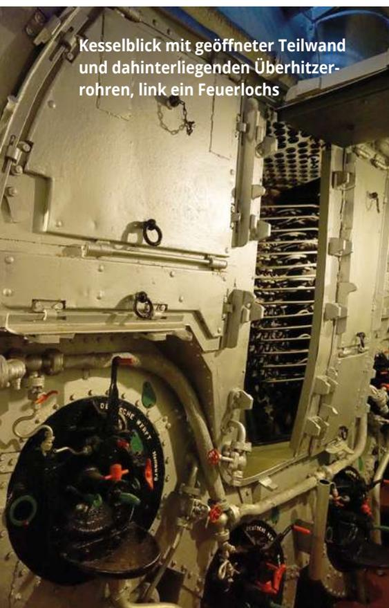
Kesselblick mit ge ffneter Teilwand und dahinterliegenden  berhitzerrohren, link ein Feuerlochs
