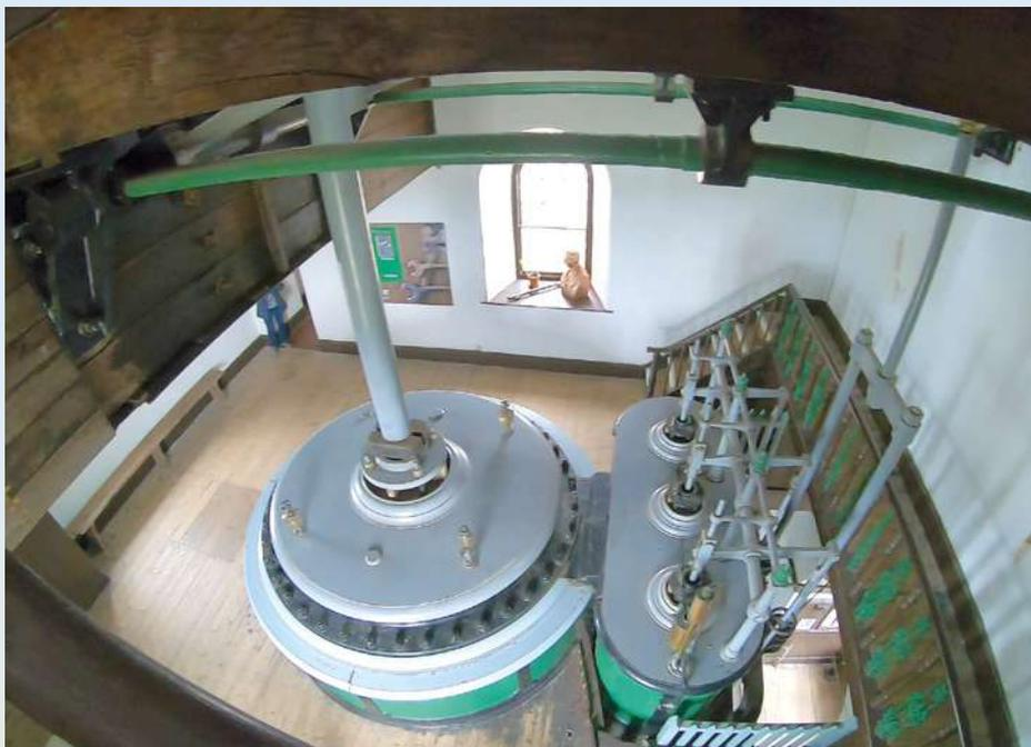
Bild 12: Zylinder, Kolbenstange und oberer Ventilkasten
