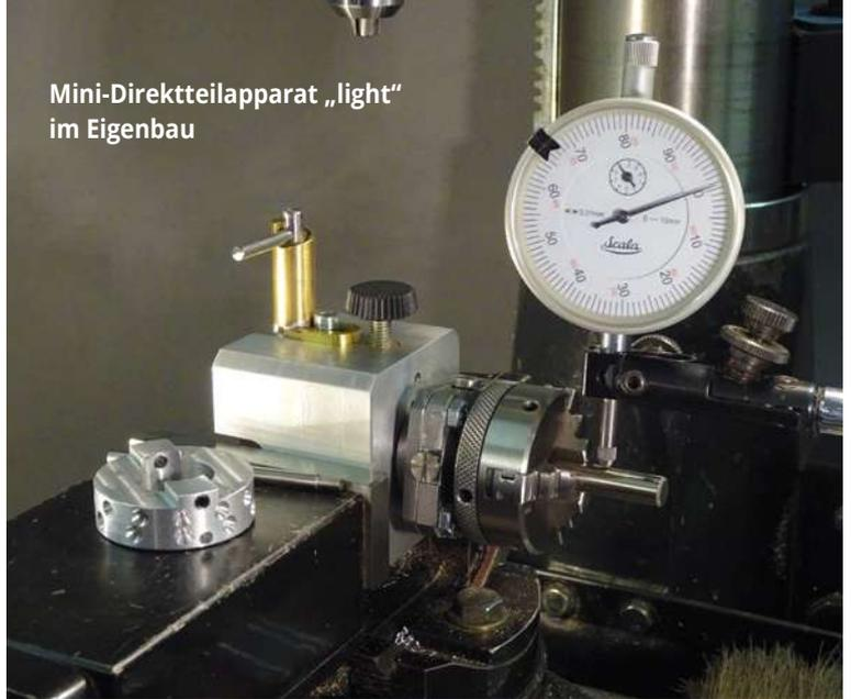
Mini-Direkteilapparat „light“ im Eigenbau
