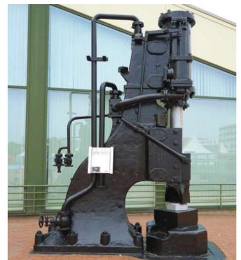
Mittelschwerer Dampfhammer der Firma Brinkmann aus Witten von 1905; Masse 37 t; zum Schmieden von Schiffskurbelwellen und Zylinderkopfmuttern
