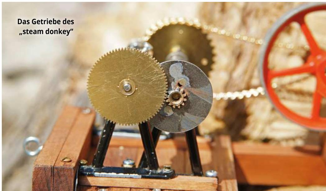
Daher musste ich es mit einer Doppelschnurlaufrolle und zwei vernickelten M2×20-mm-Schrauben verbinden und die Schrauben festlöten.
