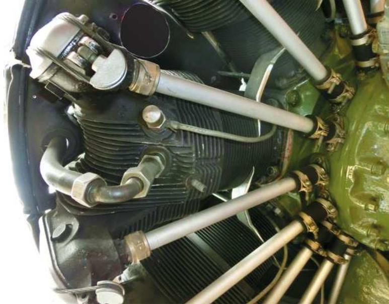
Abb. 4: Detail des Motors. In der linken Bildmitte ist der Pressluftanschluss neben dem vorderen Zündstecker am Zylinder zu sehen. Die Stößelstangen verlaufen radial um das Kurbelgehäuse (rechte Bildmitte)
