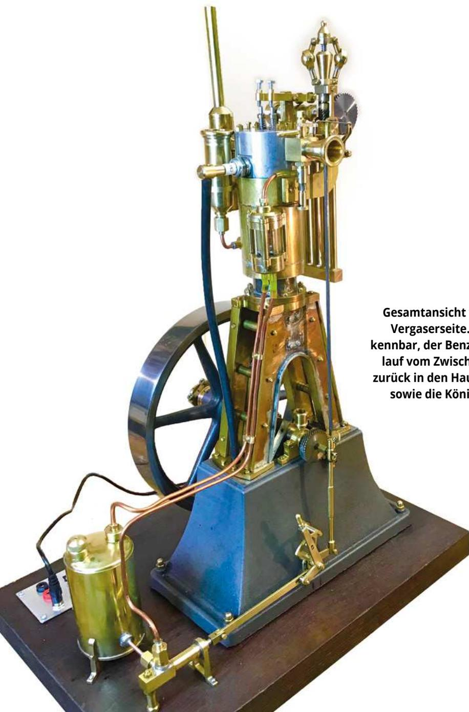
Gesamtansicht von der Vergaserseite. Gut erkennbar, der Benzinrücklauf vom Zwischentank zurück in den Haupttank sowie die Königswelle
