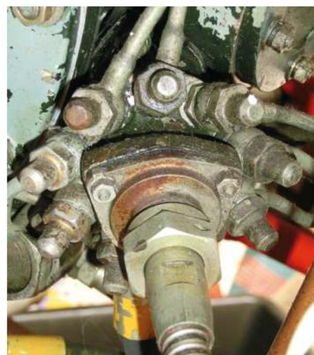
Abb. 6: Sekundärer Neunfach-Pressluftverteiler. Unten ist neben dem Presslufteingang (gelber Stecker), auch der Anschluss für die flexible Motorwelle zu sehen
