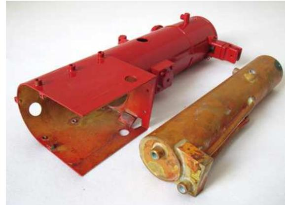
**Außenkessel mit Feuerbüchse und Innenkessel**
