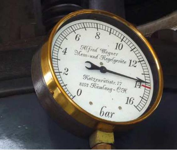
**Kleiner Druckanzeiger in anderer Fahrtrichtung mit Höchstbetriebsdruckmarkierung von 14 bar**
