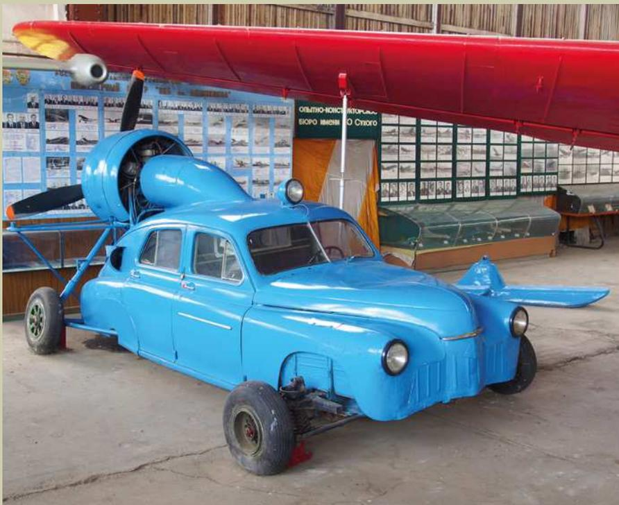
**Abb. 9: Motorschlitten Kamov Sever-2, hier in Ausführung mit Rädern, im Hintergrund sind die Kufen zu sehen**
