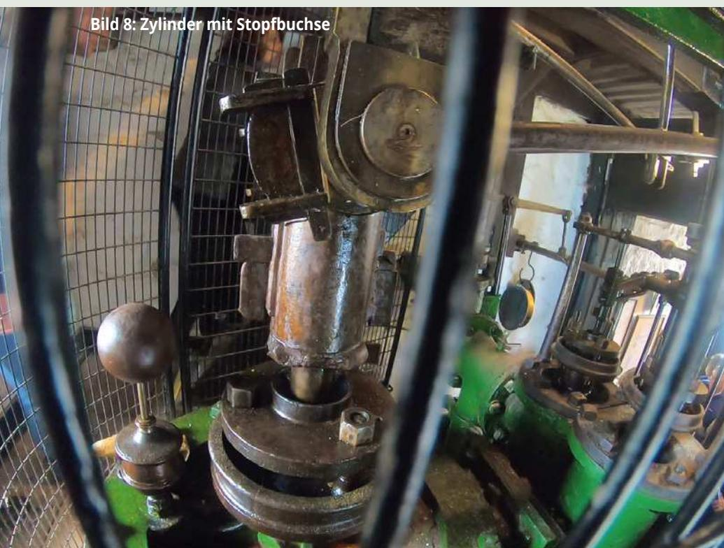
Bild 8: Zylinder mit Stopfbuchse
