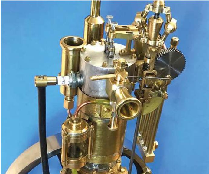
Zylinderkopf, von der Vergaserseite aus gesehen. Gut sichtbar der Mechanismus, wie der Fliehkraftregler den Vergaser steuert
