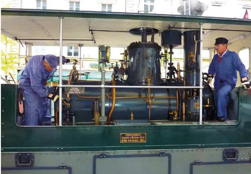
**Zwei dampfgestandene Männer Bedienpersonal – oben von links nach rechts: großer Druckanzeiger; Dampfdom; darauf Sicherheitsventile und Pfeife; rechts daneben Schornstein durchbricht das Dach. Der linke Mann arbeitet an der Wassereinspeisung per Injektor; dickes Dampfzuführungsrohr zu den Zylindern; direkt vor dem Schornstein die stehende Dampfpeisepumpe Typ Westinghouse**
