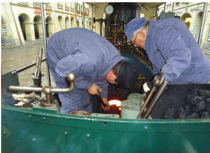
**Zug-Führerstand: links der Umsteuerungshebel; im Vordergrund die Bedienung der Handbremse; Situation beim Befeuern im Führerstand; rechts der Kohlevorrat**
