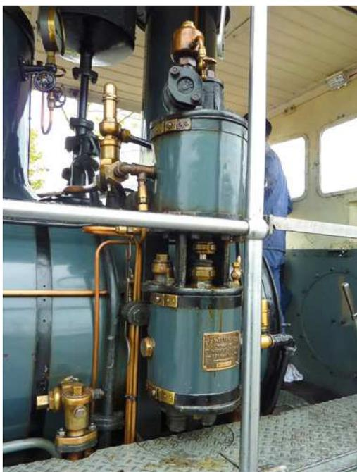
**Nie zuvor gesehenes hochfeines gegen Beschädigung geschütztes Wasserstandsglas und die daran auch zum Durchblasen verbundene Hähne; zusätzlich notfalls flinke Absperrung**
