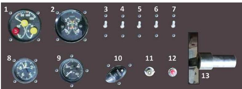
Abb. 3: Steuerpult. 1: Kombiinstrument Öldruck, Benzindruck und Öltemperatur, 2: Kombiinstrument Zylindertemperatur, Umgebungstemperatur, 3: Haupt Ein/Aus, 4: Instrumente Ein/Aus, 5: Startknopf Ein/Aus, 6: Magnetspule links Ein/Aus, 7: Magnetspule rechts Ein/Aus, 8: Drehzahlmesser, 9: Pressluftdruck, 10: Benzinpumpe, 11: Startknopf, 12: Kontrollleuchte Haupt Ein/Aus, 13: Gashebel (aus Pleuel gefertigt)
