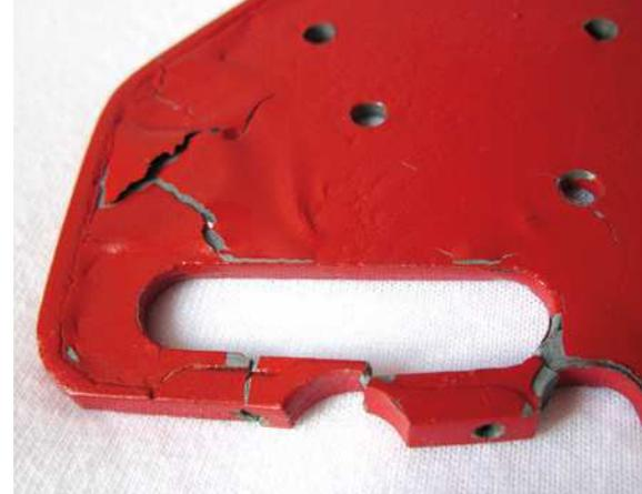
**Schäden am Steuerstand durch Zinkpest**
