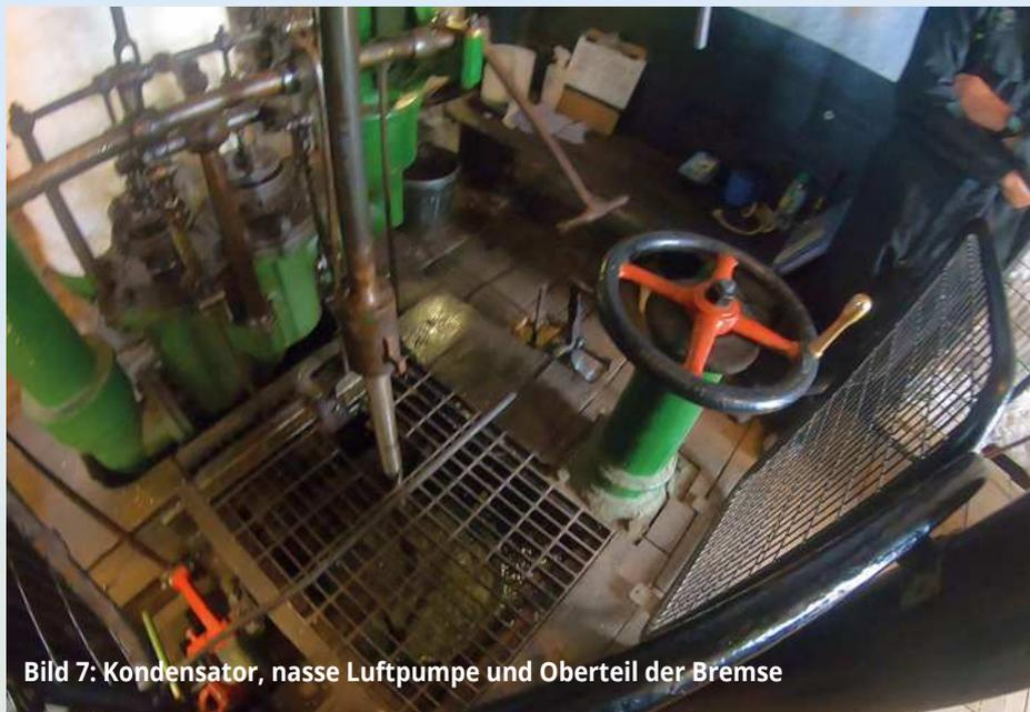
Bild 7: Kondensator, nasse Luftpumpe und Oberteil der Bremse
