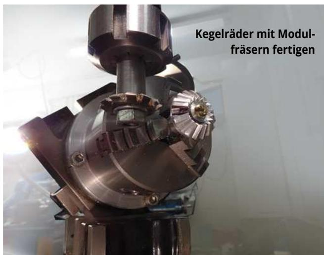
**Kegelräder mit Modulfräsern fertigen**
