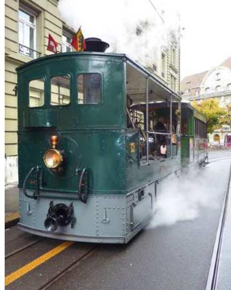
**Die noch kalten Zylinder werden durch Öffnen der Zischhähne vorgewärmt, um einen Wasserschlag sicher zu vermeiden**
