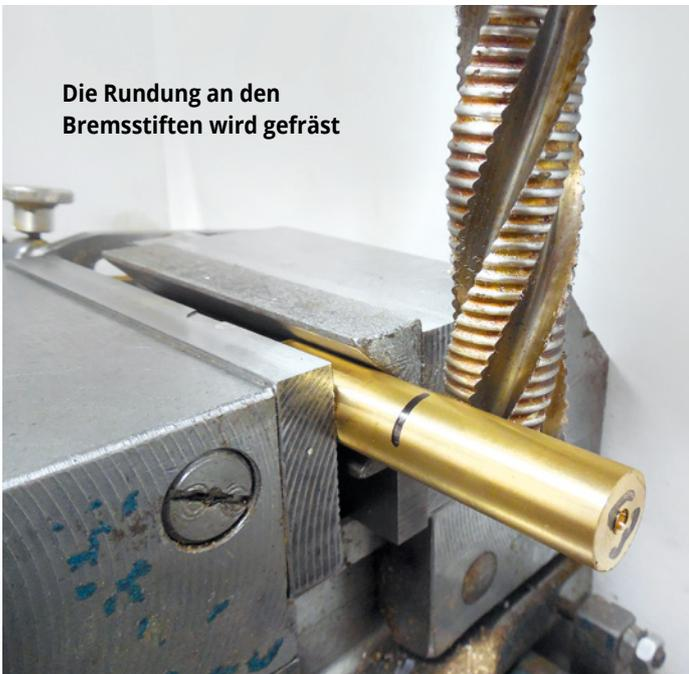
Die Rundung an den Bremsstiften wird gefräst
