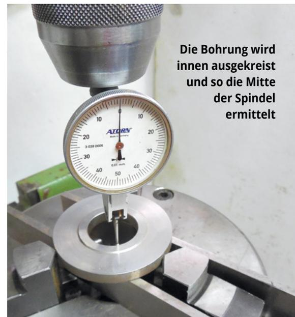
Die Bohrung wird innen ausgekreist und so die Mitte der Spindel ermittelt
