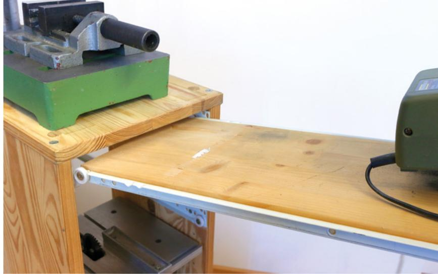
Das gewünschte Gerät wird einfach aus der Schiebebene entnommen... ...und in die Arbeitsebene eingeschoben
