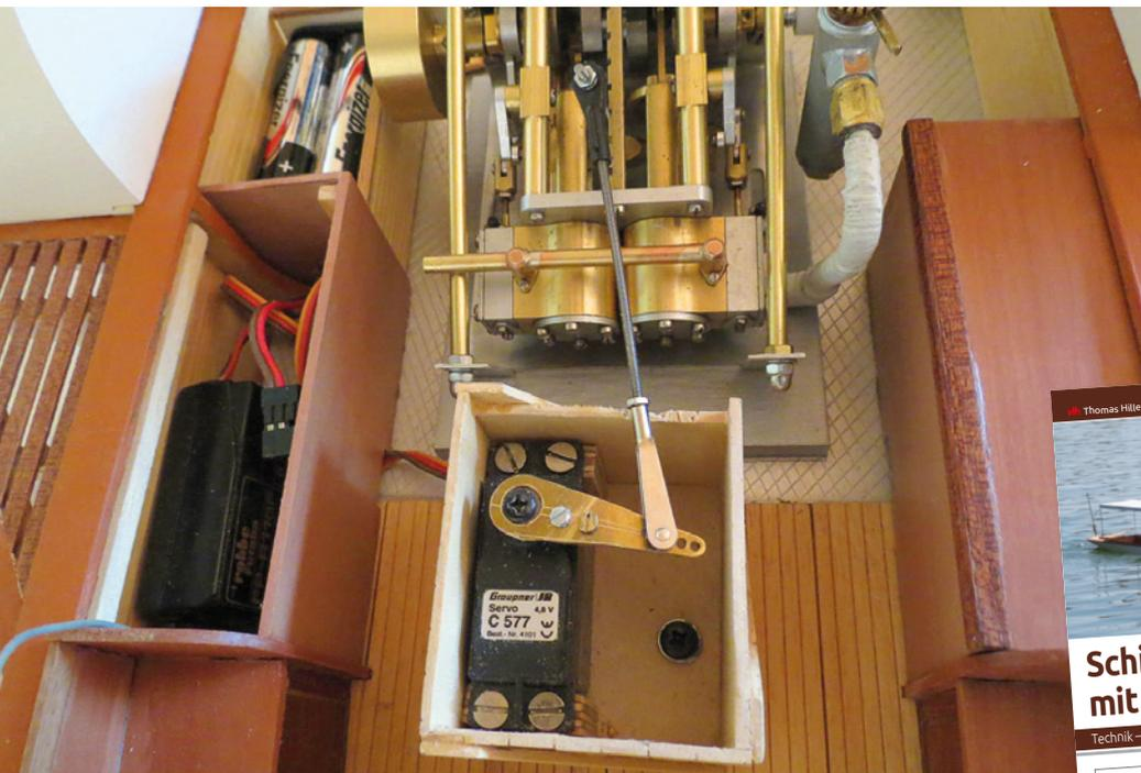
Ansteuerung der Maschine, am oberen Bildrand der Verdrängsöler
