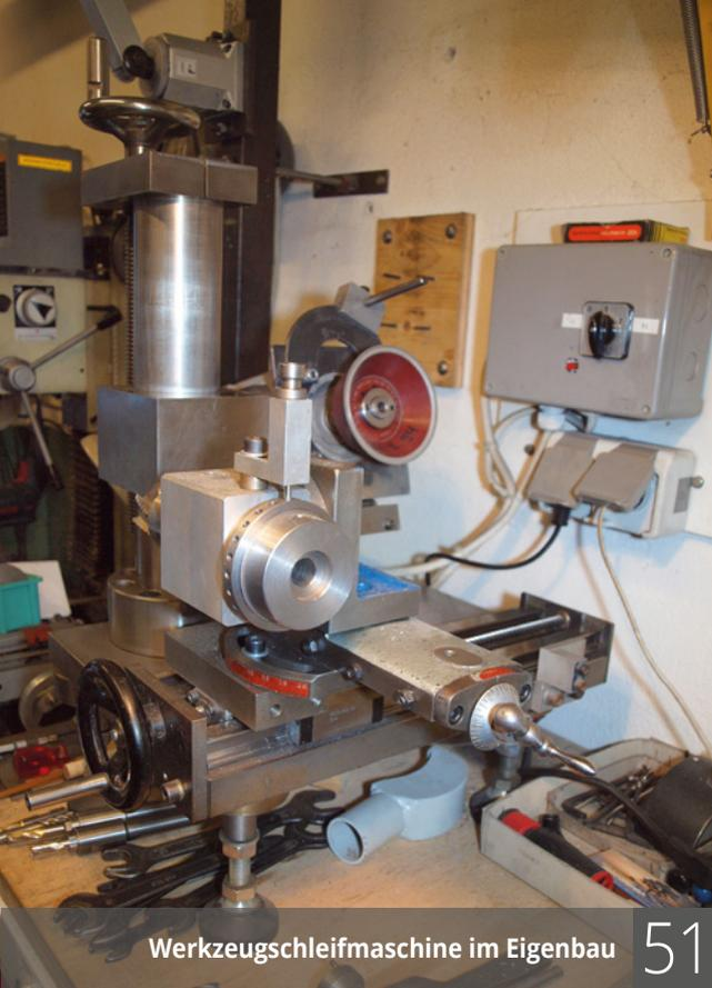
Werkzeugschleifmaschine im Eigenbau 51
