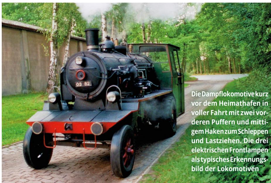
**Die Dampflokomotive kurz vor dem Heimathafen in voller Fahrt mit zwei vorderen Puffern und mittigem Haken zum Schleppen und Lastziehen. Die drei elektrischen Frontlampen als typisches Erkennungs-bild der Lokomotiven**
