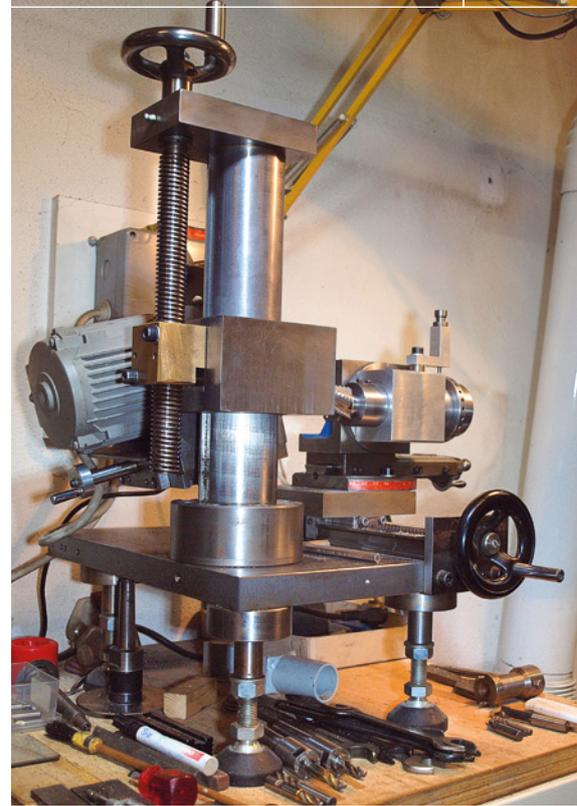
**Grundplatte mit Stellschrauben rechteckiger Block mit Trapezgewindespindel und Längsschlitten mit Handrad**
