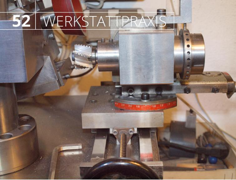
**2. Grundplatte mit Kopierspindel und drehbarem Teilapparat Kugelumlaufschlitten mit Motor**
