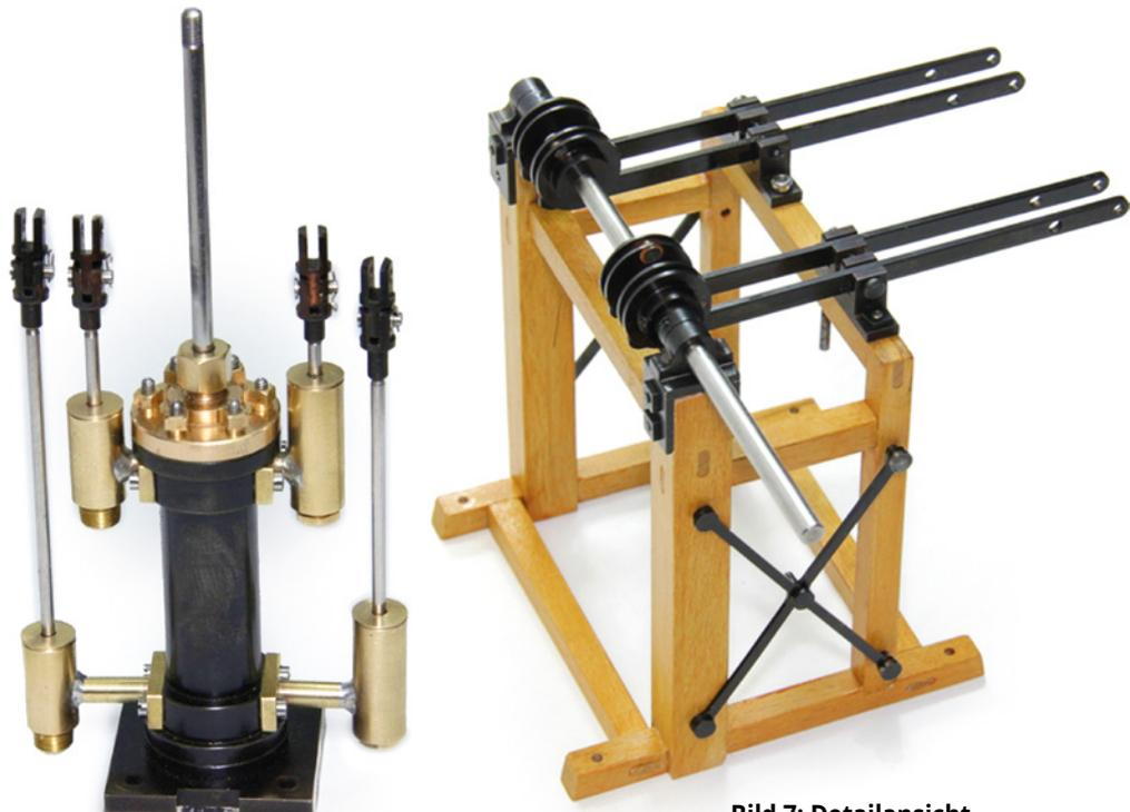
**Bild 5: Zylinder mit den Ventilen**
