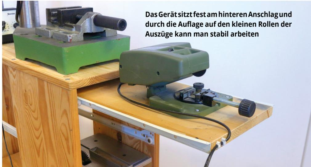
Das Gerät sitzt fest am hinteren Anschlag und durch die Auflage auf den kleinen Rollen der Auszüge kann man stabil arbeiten
