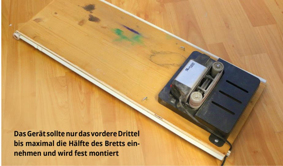
Das Gerät sollte nur das vordere Drittel bis maximal die Hälfte des Bretts einnehmen und wird fest montiert
