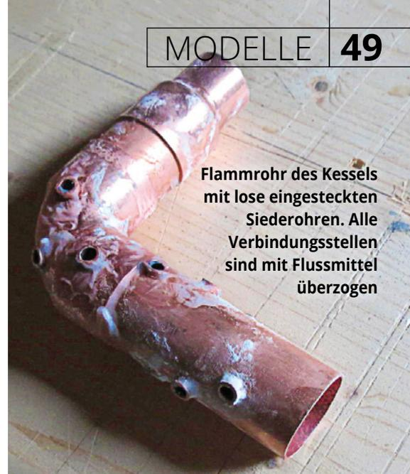
Flammrohr des Kessels mit lose eingesteckten Siederöhren. Alle Verbindungsstellen sind mit Flussmittel überzogen
