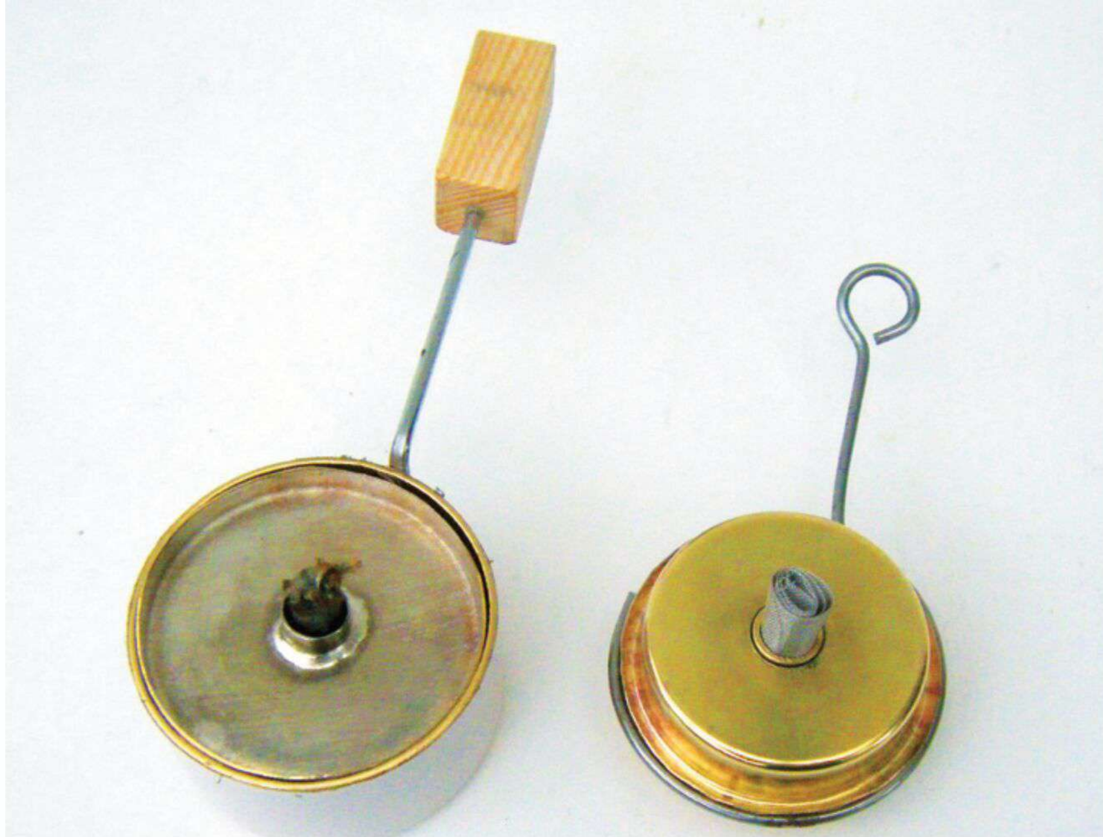
Spiritusbrenner im Vergleich. links Eigenkonstruktion des Autors aus einem stähler- nen Teelichthalter und rechts der fertig gestellte „Reicheltbrenner“ mit Docht aus Edelstahlgaze
