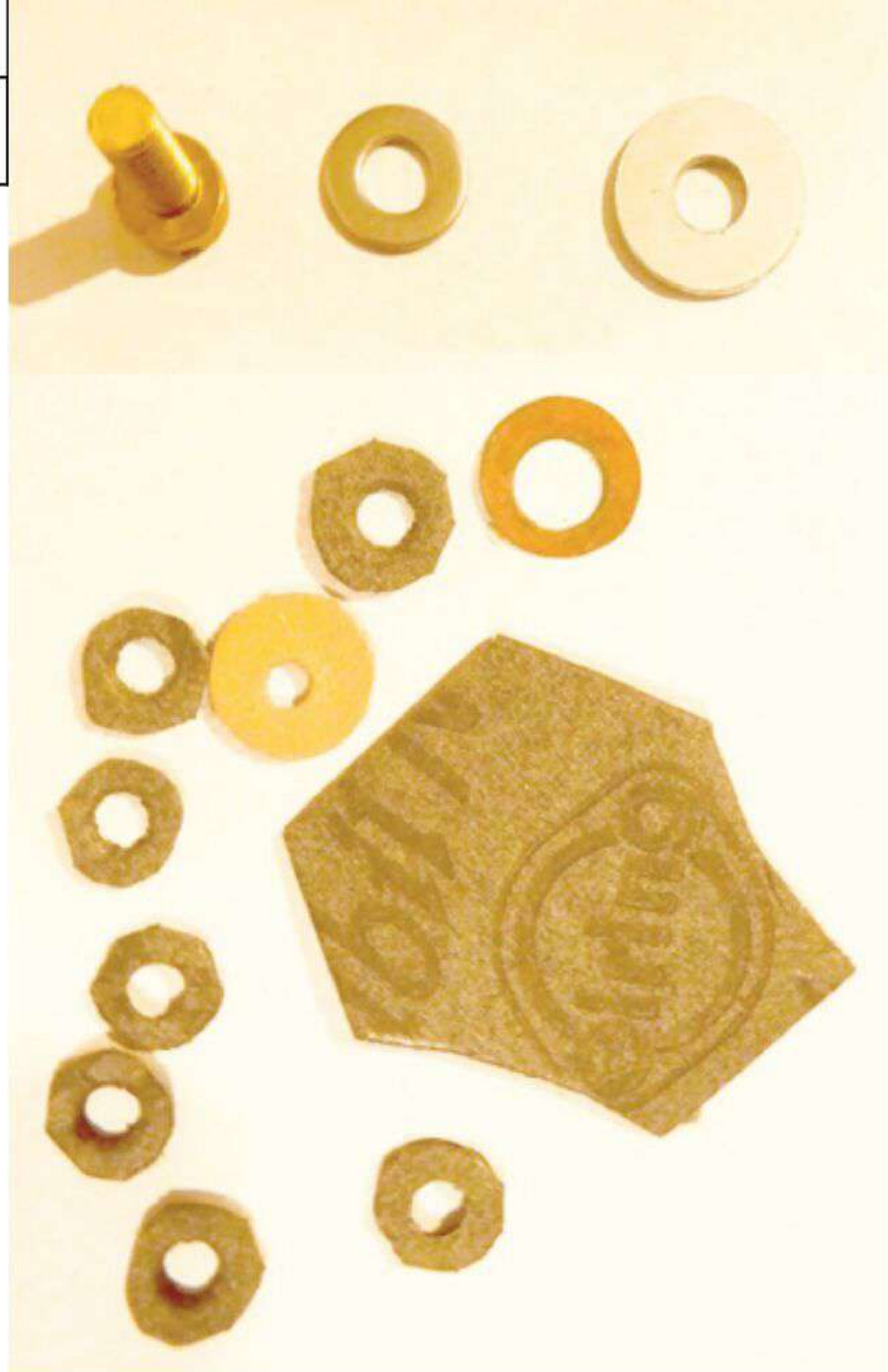
Selbstgefertigte Beilagescheiben aus KFZ-Dichtungspapier als Zwischenlage bei Verschraubungen
