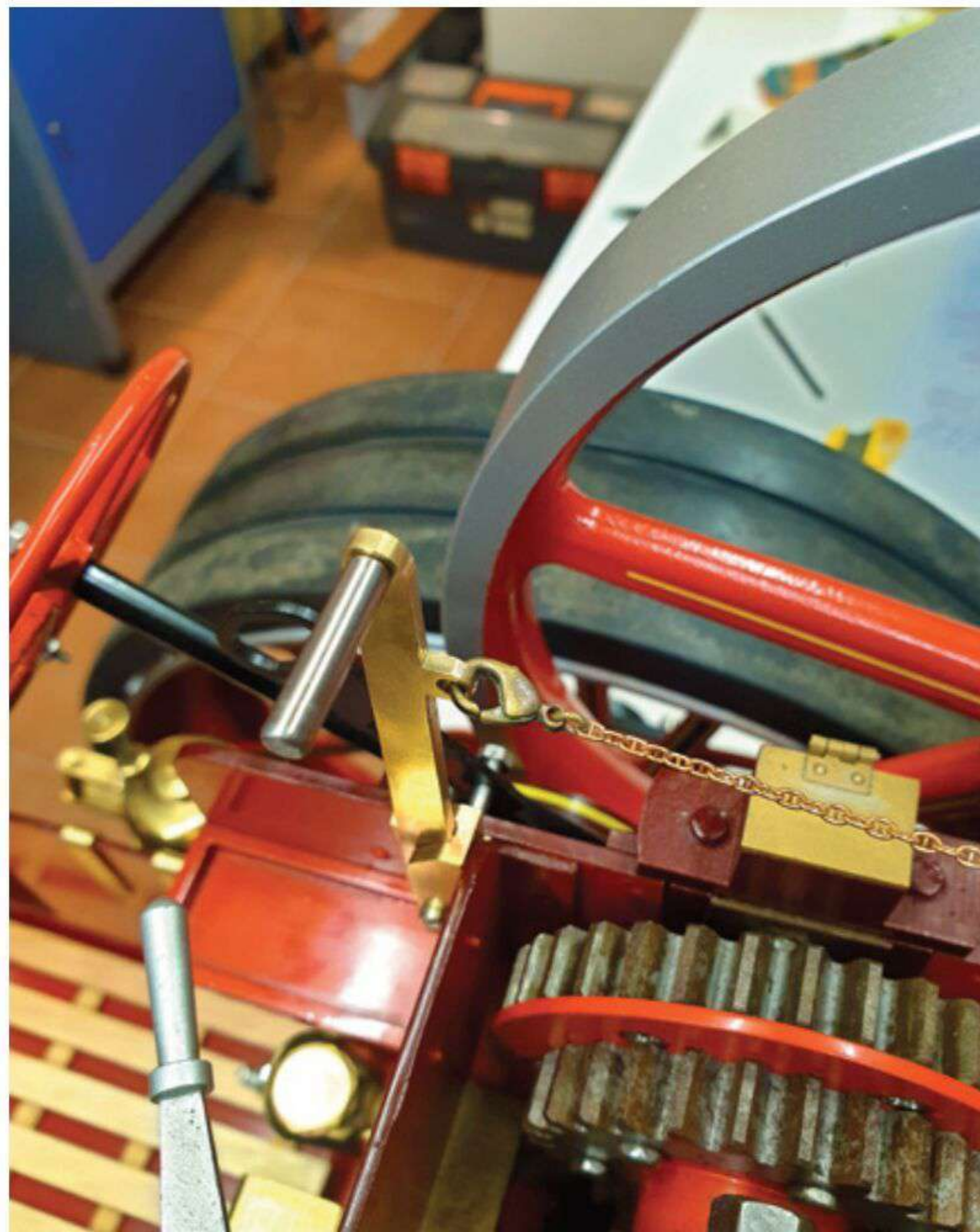
Bedienungshebel für die Dampfpfeife
