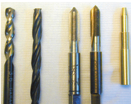
Bild 10 von links: Der Kernlochbohrer für das Feingewinde, ein um-geschliffener Bohrer, die beiden geschliffenen/verjüngten Gewindebohrer und das fast fertiggestellte Ventil-Drehteil
