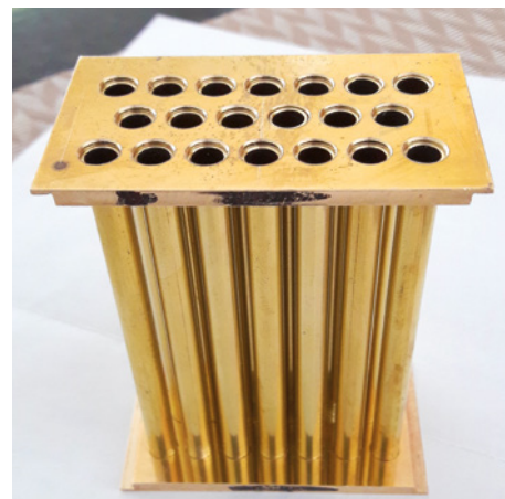
Kühler-Innenteil mit Kühlröhrchen
