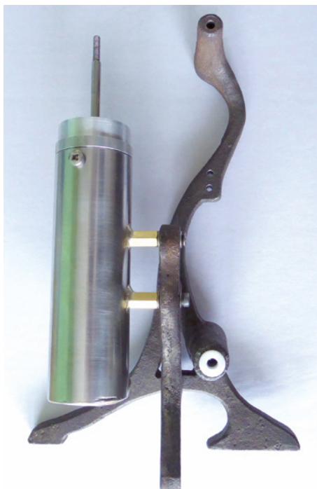
Der Rahmen ist mit dem bereits fertiggestellten Wärmetauscher provisorisch verschraubt
