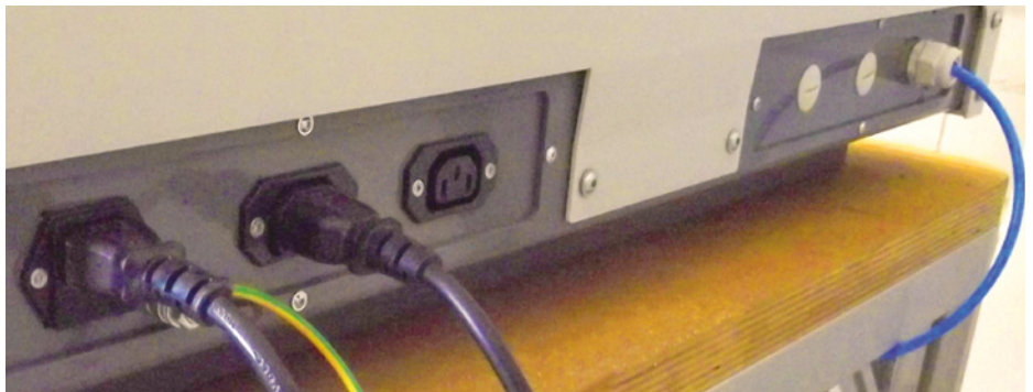
An der Maschinenrückseite befinden sich der Netzanschluss und je nach Ausbaustufe weitere Steckdosen. Diese können vom Programm geschaltet werden, um z.B. einen Staubsauger einzuschalten. Auf dem Bild sieht man auch einen Schlauchanschluss für einen Vakuumschüssel
