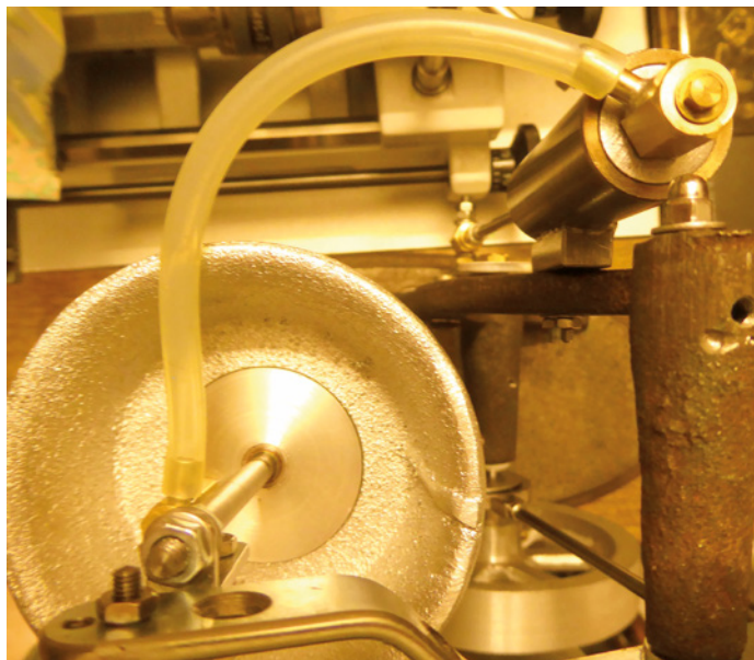
Man erkennt die abnehmbare Silikonschlauchverbindung zwischen Verdränger und Arbeitskolben. Der Schlauch wird auf ein angelötetes 4-mm-Röhrchen aufgesteckt
