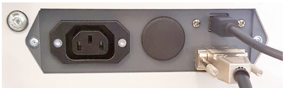
An der rechten Seite der Maschine stehen Anschlüsse für den Steuerungs-PC zur Verfügung. Hier befindet sich auch der Anschluss für das optionale Handrad
