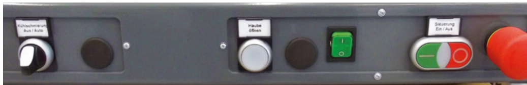
Die Bedientasten sind in der Frontseite unter der Tür eingebaut. Je nach Ausbaustufe können zusätzliche Taster und Schalter angeordnet werden
