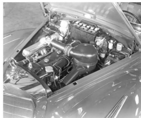
Der Sechszylinder-Einspritzmotor M199 muss sich im 300 Sc schon schmal machen. Aber es passte alles rein, was sogar die Batterie fand noch einen gut zugänglichen Platz.
