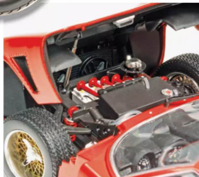
120-Liter-Tank und fünf rote Fanfaren unter der vorderen Haube, dazu eine splendid ausgeführte Radaufhängung mit roten Federn.
