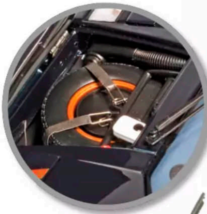
Schmuckschatullenscharniere halten die vordere Haube auf, darin das Reserverad, das mit Gummibändern und Krallen gehalten wird.
