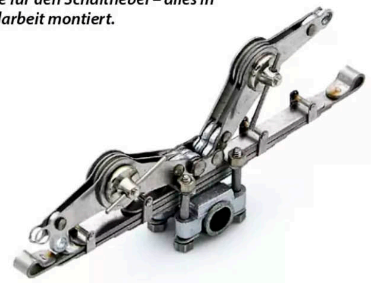
Radaufhängung: An diesem Bauteil mit halbelliptischen Blattfedern (aus Edelstahl) und einstellbaren Reibungsdämpfern werden die Speichenräder befestigt.
