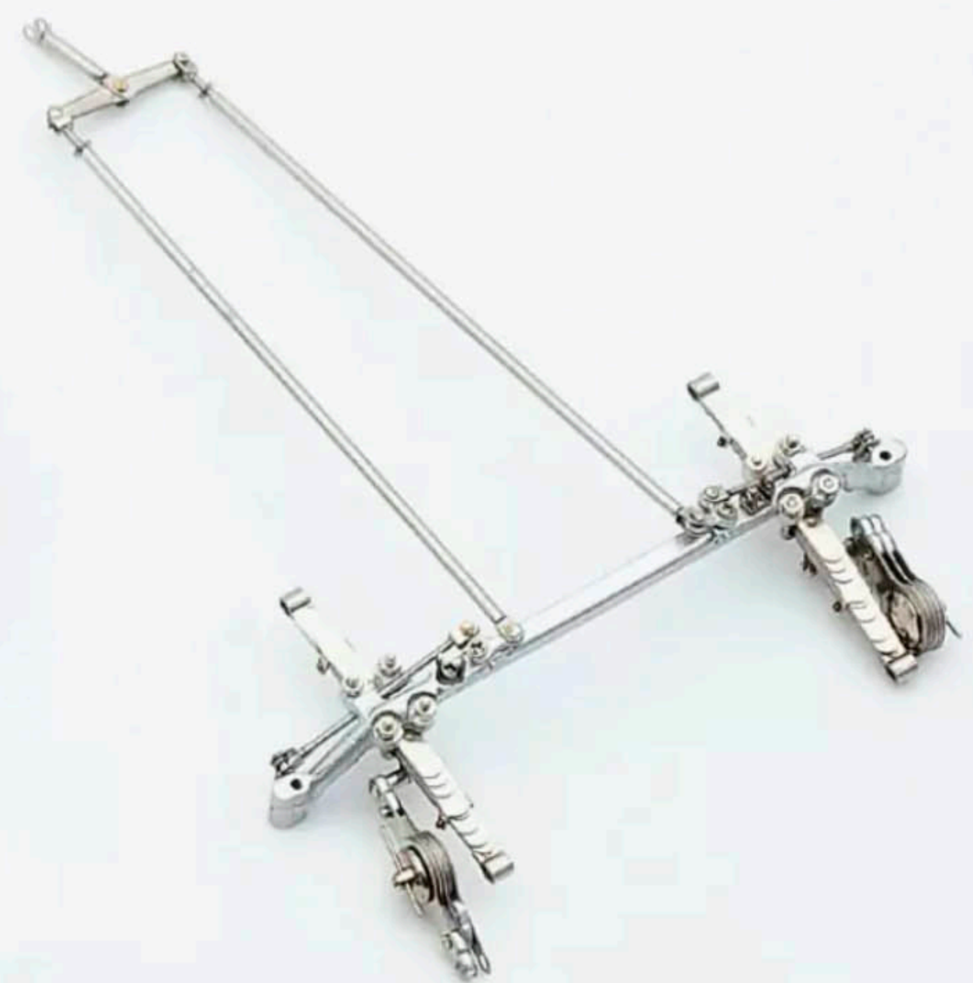
Blattfedereinheit, von Hand eingespeichte Räder, Achtzylinder-Reihenmotor in zwei Blöcken und die Bremsanlage mit Gestänge – in jedem dieser Bauteile stecken viele Einzelteile, allein am Motorblock sind es 85 Edelstahlschrauben.
