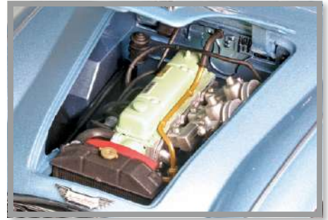
So sahen in den 60ern 3 Liter Hubraum und 124 PS aus, der BMC C-Series-Motor. Man sah einen Motor. Man sah seine Einzelteile und konnte sie zuordnen. Man sah eine grüne Zylinderkopfhaube. Und heute sieht man eine Plastikwüste, die einen irgendwie gearteten Motor von der Außenwelt und vom Betrachter abkapselt. Das geht heute in Richtung Motor-Autismus.
