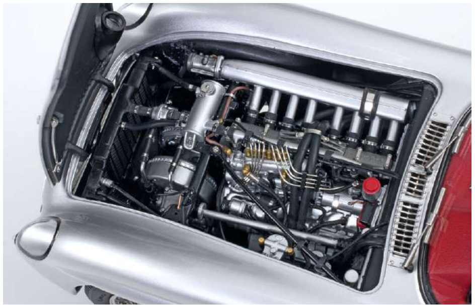
Der Achtzylinder-Reihenmotor aus zwei Viererblöcken mit einem langen, zylindrischen Luftfilter sind nicht zu übersehen, aber auch jede Schlauchverbindung und jede Einspritzleitung hat CMC nachgebildet.
