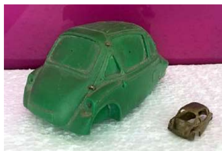
Das grüne Mustermmodell wurde in speziellem Kunststoff im Maßstab 1:25 geschaffen. Rechts das davon herunterkopierte Messing-Urmuster.
