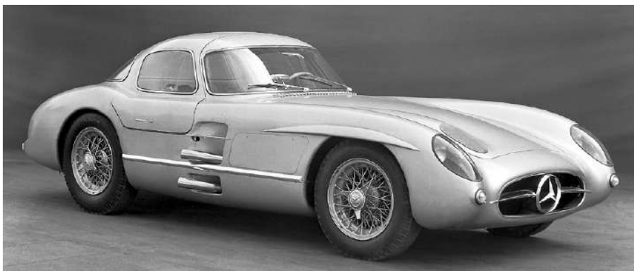
300 SLR: Markante Unterschiede zum 300 SL-Flügeltürer sind die Sidepipes rechts und die fehlenden kleinen Fenster hinter den Flügeltüren.
