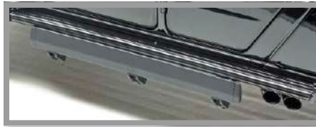
Bewegliche Trittbretter, ausgefahren und eingeklappt. Klappt wie beim Großen.
