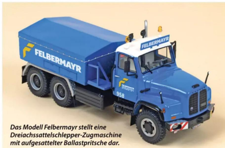
Das Modell Felbermayr stellt eine Dreiachsattel-schlepper-Zugmaschine mit aufgesattelter Ballastpritsche dar.
