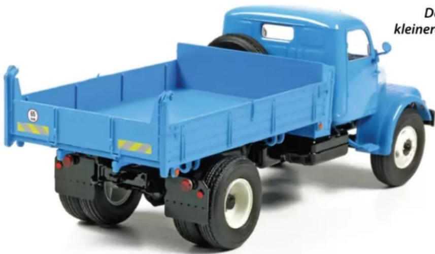
Deutliche Unterschiede beim Aufbau: Große Pritsche beim roten Pritschenwagen, wesentlich kleinere Pritsche beim Dreiseitenkipper, der zwischen Fahrerhaus und Aufbau einen Gerätekasten und sein Reserverad trägt. Beim Pritschenwagen ist es unten an der Pritsche befestigt.
