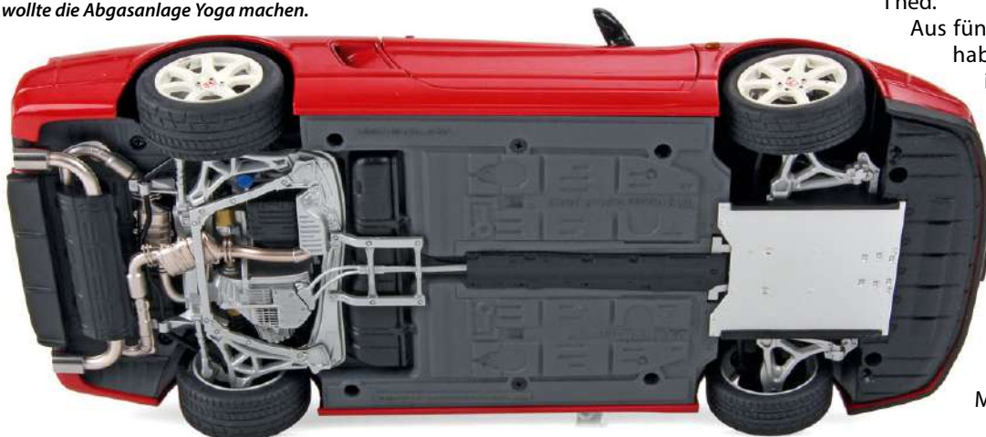
Vorne nahezu nichts, hinten alles. Natürlich der Motor, auch von unten perfekt. Aber man beachte die Abgasanlage. Welcher andere Wagen hat eine dermaßen unorthodoxe Führung der Auspuffrohre? Fast sieht es so aus, als wollte die Abgasanlage Yoga machen.
