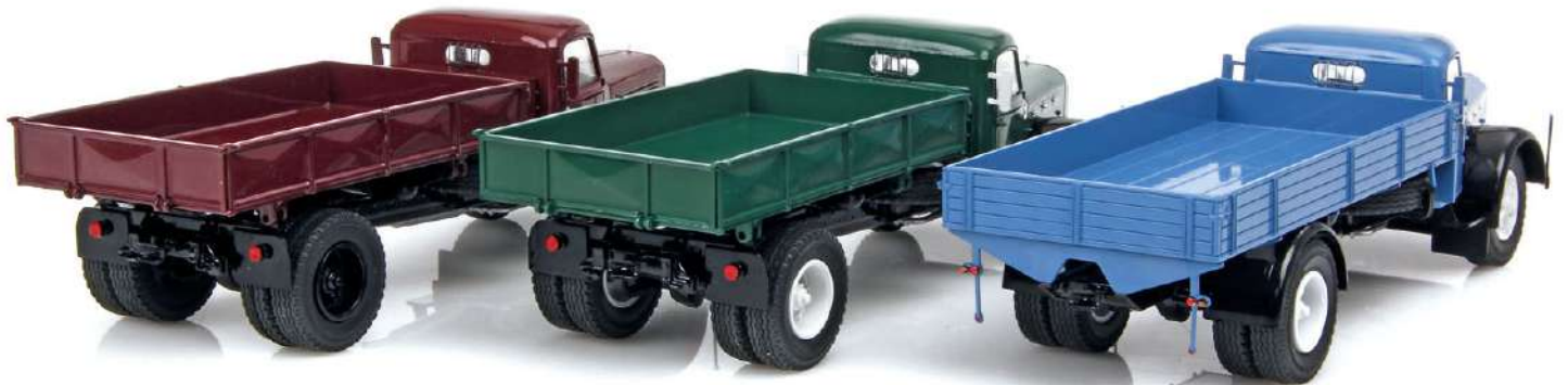
Der blaue Pritschenkipper, hier das 1951er Modell, wirkt durch den längeren hinteren Überhang ausgewogener als der Dreiseitenkipper. Auffällig sind die großen Räder, aber das muss so sein, bei einer Reifengröße von 12.00x22". Die Hochglanzlackierung lässt auf einen restaurierten Wagen schließen. So schön glänzte garantiert kein 1951er Neuwagen-Laster aus der ČSSR – oder sonst wo her...
