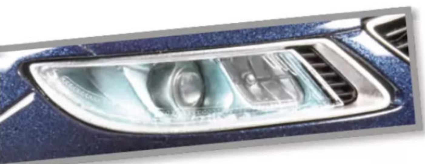
Bläulich getönt: adaptive Bi-Xenon Smart-Beam-Scheinwerfer, perfekt miniaturisiert.
