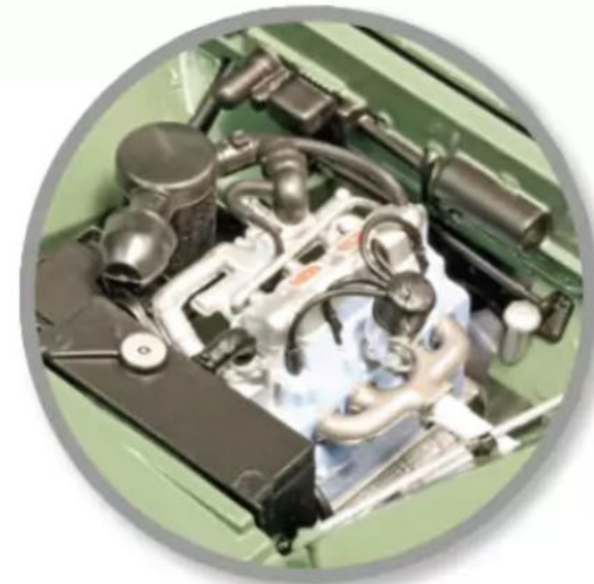
Sehr schön gemachter, altertümlich anmutender Vierzylinder aus dem Rover P4 („Tantchen“), ein 1,6-Liter mit 50 PS.
