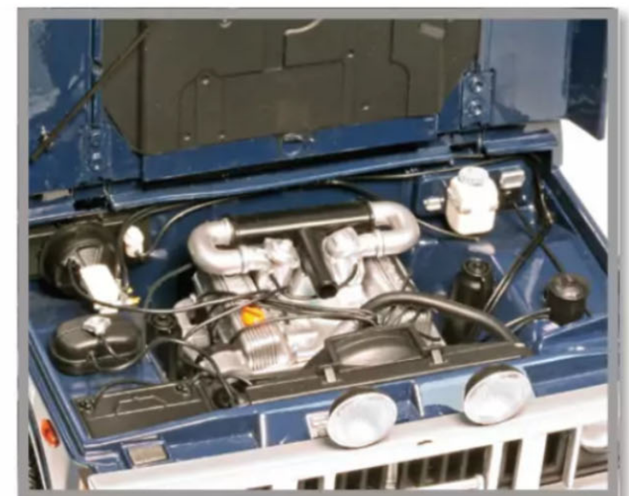
Ein voll verkabeltes Motorwunder aus den frühen 1970er Jahren stellt der 3,5-Liter-Leichtmetall-V8 dar. Für das Foto ist die Haube weiter als üblich geöffnet. Im Normalfall wird sie von der beweglichen Aufstellstange gehalten, die an der Haubeninnenseite befestigt ist.
