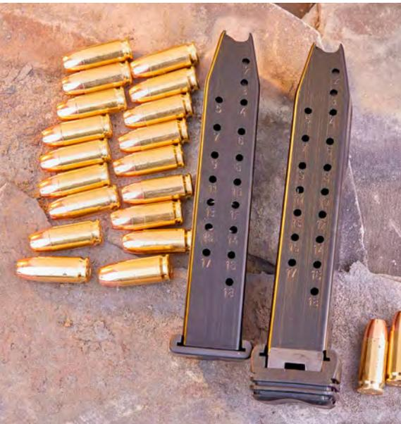
Eines der beiden Magazine aus dem Lieferumfang fasst, des hohlen Magazinschuhes wegen, zwei Patronen mehr.
