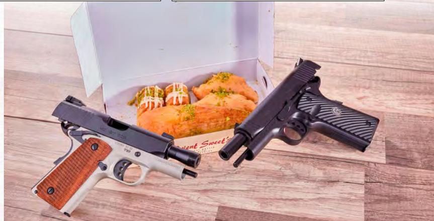
**Braucht keine Mündungsbuchse:** Der Lauf der subkompakten Girsan MC SC9 führt nur über den ausgeprägten Kegel. Bei der etwas längeren kompakten MC 1911 C9 (rechts) führt die klassische Mündungsbuchse.
