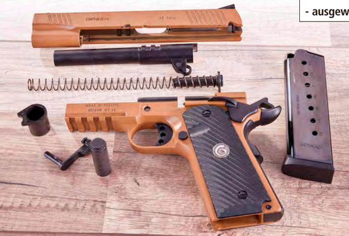
**Zerlegen wie gehabt:** Girsan fertigt seine Standard-1911 im klassischen Aufbau mit Kettenglied, aber mal mit kurzer oder auch langer Federführungsstange.
