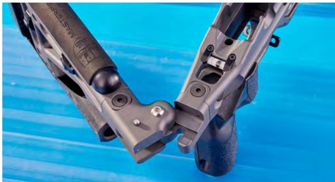
Das absolut spielfreie Klappschaftgelenk. Dies wird mit einem Keilverschluss sowie einer Madenschraube erreicht. Über dem Griff eine Libelle, sie zeigt die seitliche Ausrichtung der Waffe.
