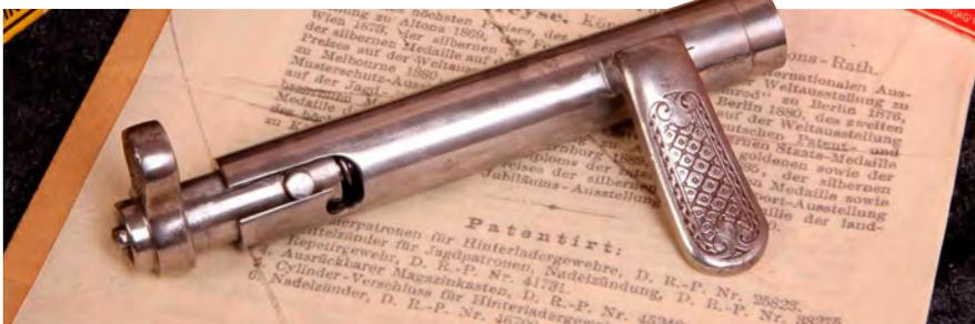
Der Verschluss mit dem biberschwanzartigen Kammergriff: Selbst dieses Element zeigt sich mit einer Gravur in einem geometrisch-symmetrischen Muster.
