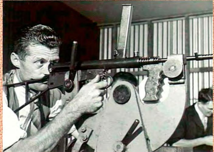
**Diese Halte-Vorrichtung diente den Technikern der Firma Lysaght zum Justieren der seitlich versetzten Elemente Kimme und Korn.**
