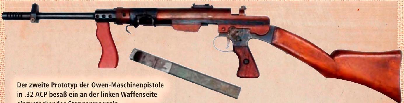
**Der zweite Prototyp der Owen-Maschinenpistole in .32 ACP besaß ein an der linken Waffenseite einzusteckendes Stangenmagazin.**
