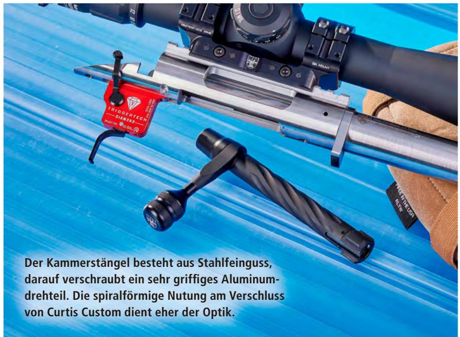
Der Kammerstängel besteht aus Stahlfeinguss, darauf verschraubt ein sehr griffiges Aluminiumdrehteil. Die spiralförmige Nutung am Verschluss von Curtis Custom dient eher der Optik.
