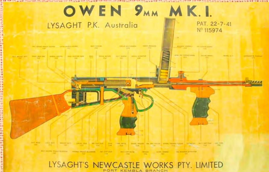
**Die Wandtafel zeigt gut die zwei Kammern des röhrenförmigen Gehäuses.**
