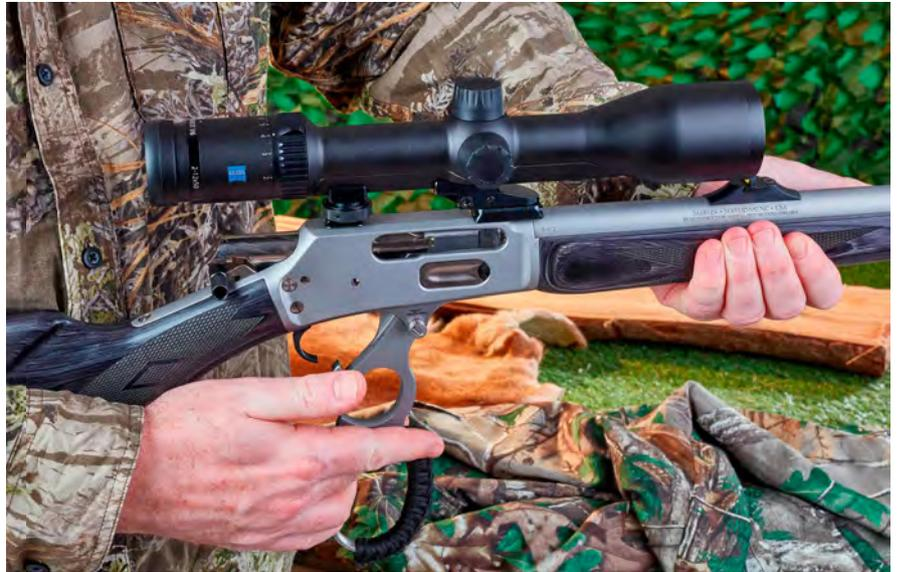
Marlin-gemäß erfolgt der Auswurf zur Seite hin. Das erlaubt die Montage eines Zielfernrohrs, hier Zeiss 2 – 12x50 Conquest V6 auf einer Henneberger-Montage.
