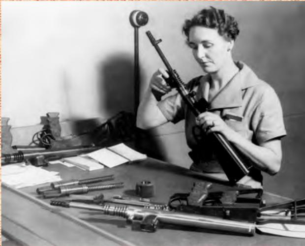
**Blick in die Fertigung – hier geht es um die ersten Owen, erkennbar an den Kühlrippen am Laufansatz.**
