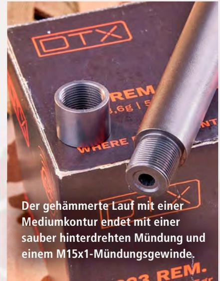
Der gehämmerte Lauf mit einer Mediumkontur endet mit einer sauber hinterdrehten Mündung und einem M15x1-Mündungsgewinde.
