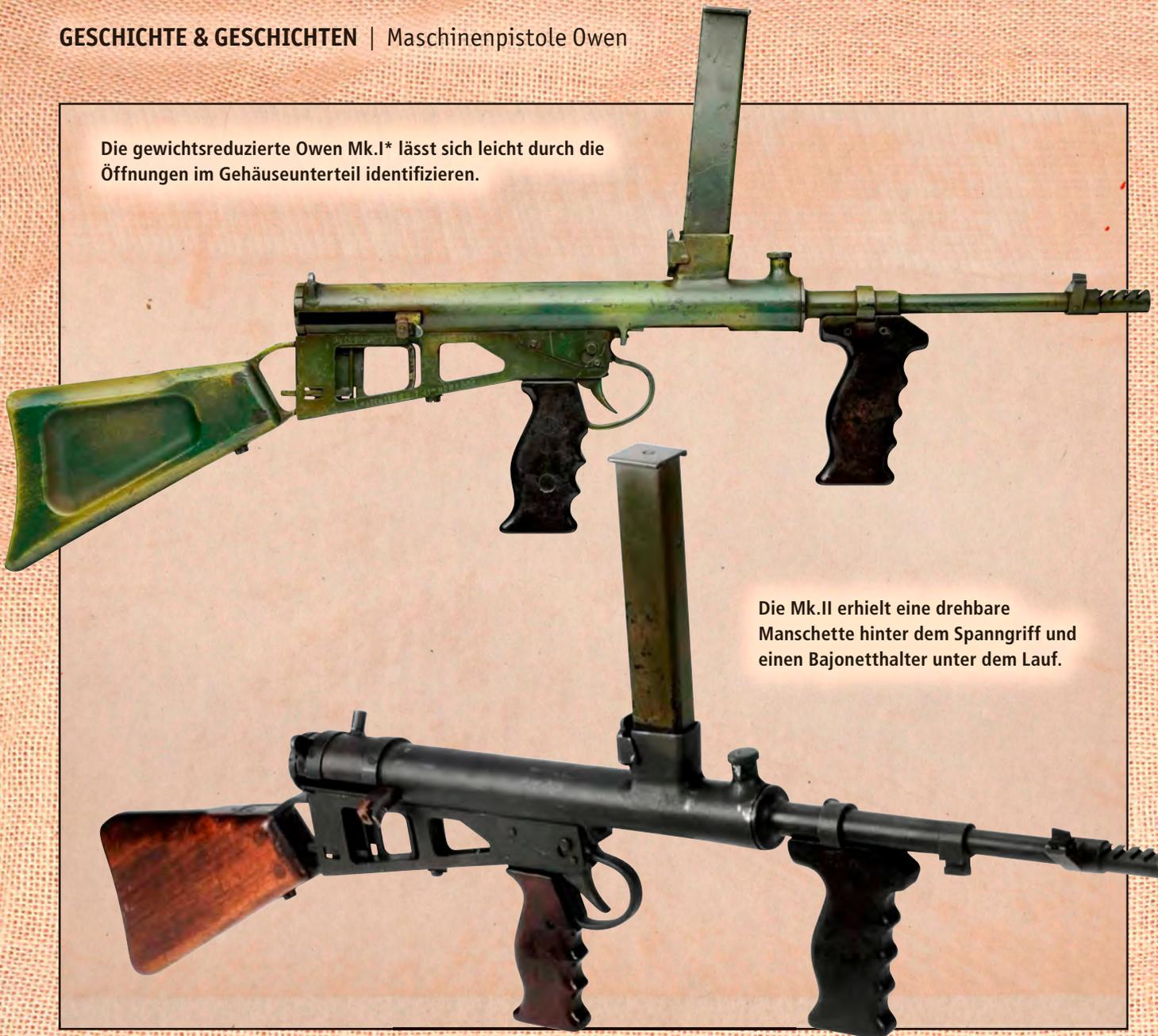
Die Mk.II erhielt eine drehbare Manschette hinter dem Spanngriff und einen Bajonetthalter unter dem Lauf.
