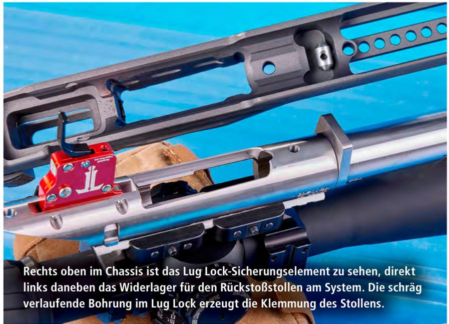
Rechts oben im Chassis ist das Lug Lock-Sicherungselement zu sehen, direkt links daneben das Widerlager für den Rückstoßstollen am System. Die schräg verlaufende Bohrung im Lug Lock erzeugt die Klemmung des Stollens.
