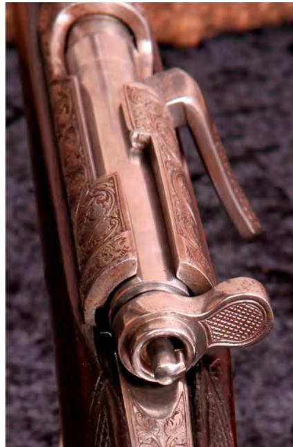
Die geriffelte Handhabe hinten oben an der Schlagbolzenmutter ist die Handspannung. Ist sie nach rechts umgelegt, heißt das: Die Schlagbolzenfeder ist gespannt und bei verriegeltem Schloss ist der Dreyse-Stutzen schussfertig. Das Element lässt sich auch als Sicherung einsetzen, um die Waffe geladen, aber entspannt führen zu können.
