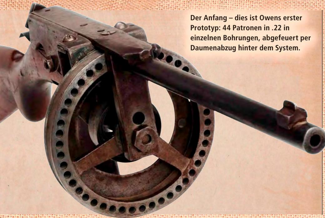
**Der Anfang – dies ist Owens erster Prototyp: 44 Patronen in .22 in einzelnen Bohrungen, abgefeuert per Daumenabzug hinter dem System.**
