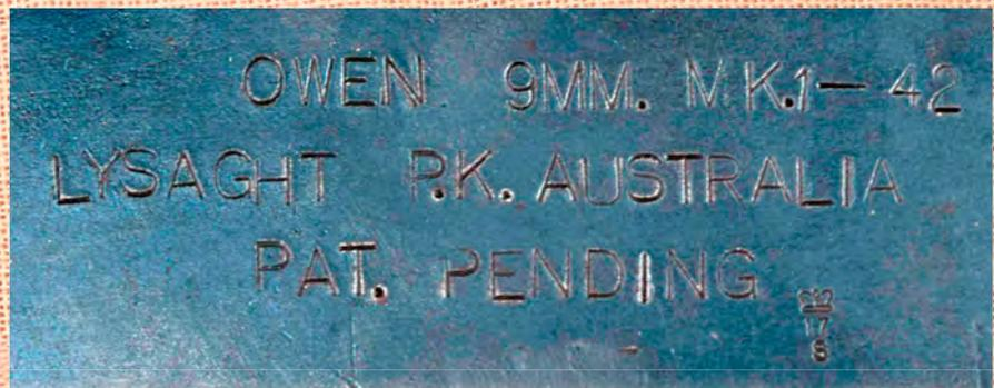
**Von Hand eingeschlagene Beschriftung auf einer frühen Owen Mk.I von 1942, die für das Kaliber 9 mm Luger war.**
