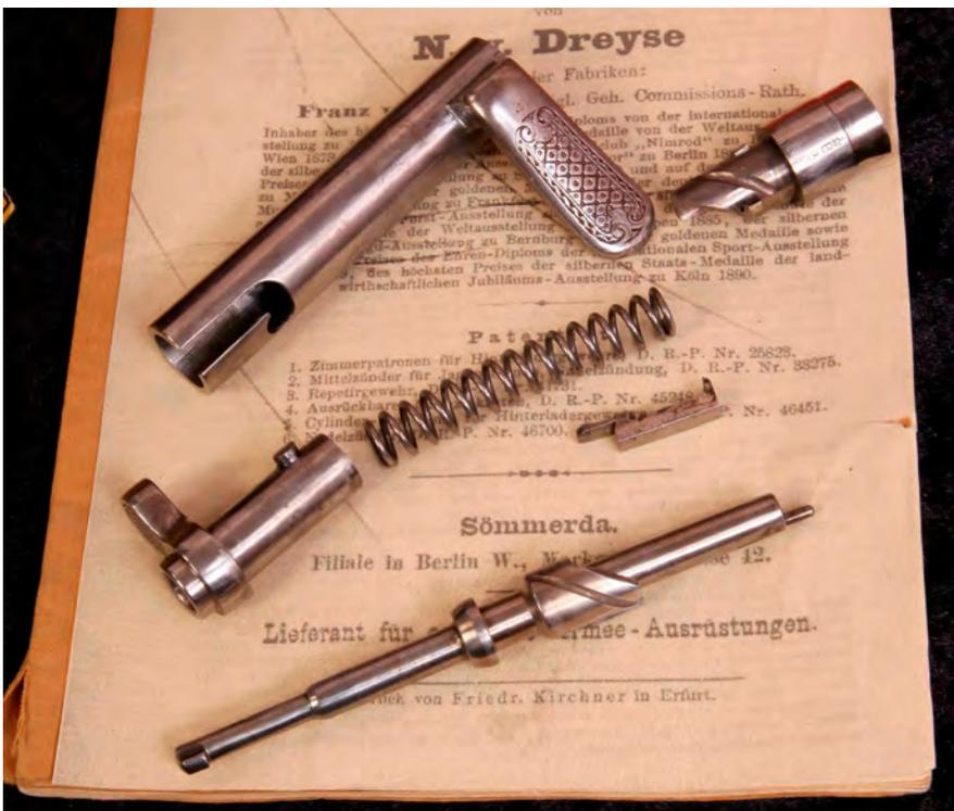
Kammerhülse mit Griff, Schlagbolzenmutter (M. l.), Schlagbolzenfeder, Verschlusskopf (M. r.), Auszieher und Schlagbolzen, alles in bestechender Qualität.
