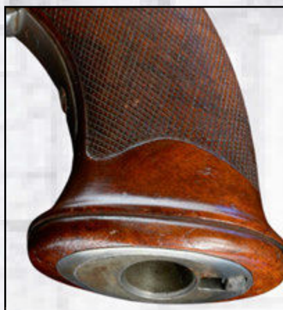
Unten im Griffende eingelassen sitzt ein kleines Stahl-Fach, dessen Deckel ist am Scharnier abgebrochen.
