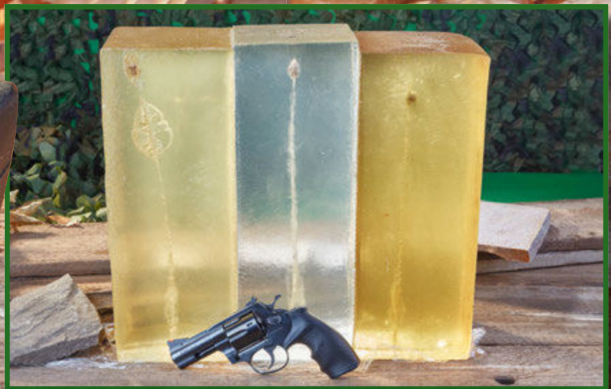
Den einzigen Durchschlag produzierte die schwächste Laborierung in .38 Special (nicht abgebildet). Es fehlte der „Bremsfallschirm“ der größer aufgepülzten Geschosse in .357 Magnum. Von links: 125 gr Magtech JHP, 135 gr Hornady Critical Duty, 158 gr Magtech SJHP.
