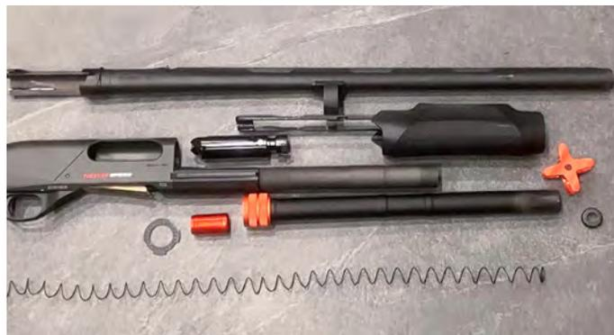
Das Magazin ist deutlich länger als bei einer herkömmlichen Nova/Supernova, der neue Vorderschaft dafür erheblich kürzer.
