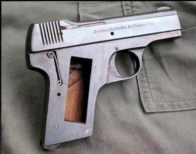
Ist die für den Militärkontrakt typische Griffschale der Beholla entfernt, sieht man hinten oben im Griff die Belastungsfeder des Sicherungshebels.
