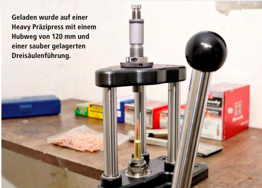
Geladen wurde auf einer Heavy Präzipress mit einem Hubweg von 120 mm und einer sauber gelagerten Dreisäulenführung.
