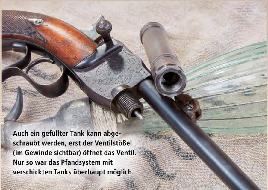
**Auch ein gefüllter Tank kann abgeschraubt werden, erst der Ventilstößel (im Gewinde sichtbar) öffnet das Ventil. Nur so war das Pfandsystem mit verschickten Tanks überhaupt möglich.**
