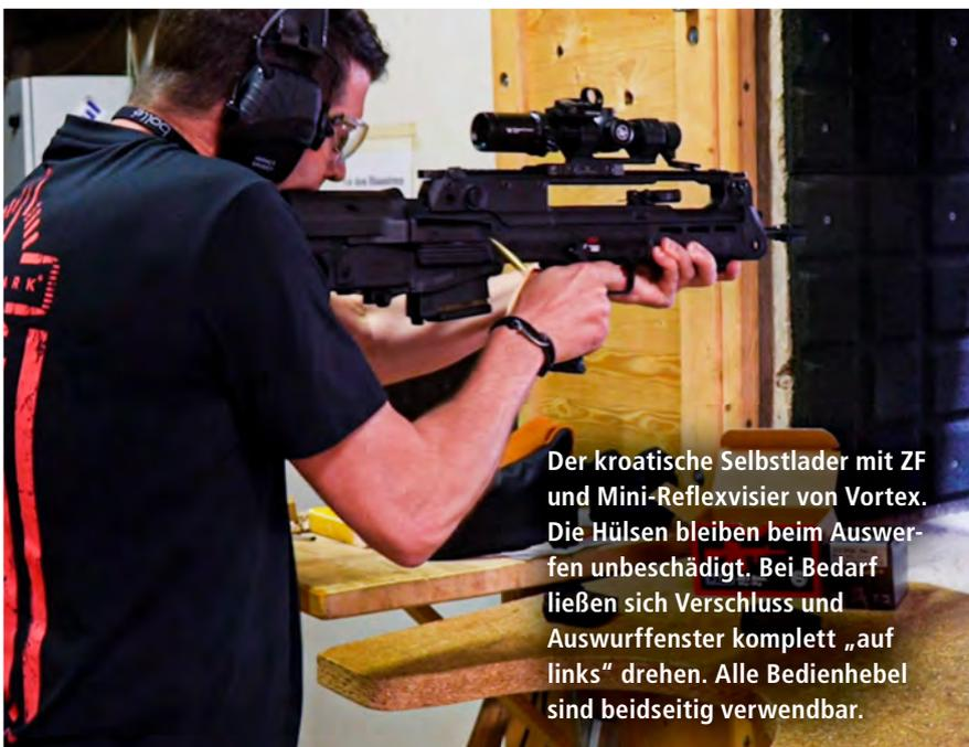
Der kroatische Selbstlader mit ZF und Mini-Reflexvisier von Vortex. Die Hülsen bleiben beim Auswerfen unbeschädigt. Bei Bedarf ließen sich Verschluss und Auswurffenster komplett „auf links“ drehen. Alle Bedienhebel sind beidseitig verwendbar.
