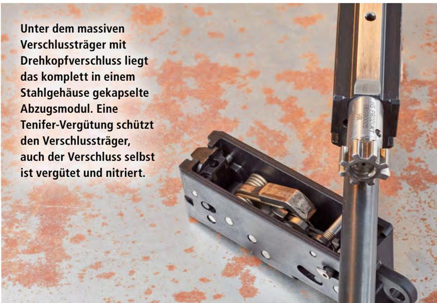
Unter dem massiven Verschlussträger mit Drehkopfverschluss liegt das komplett in einem Stahlgehäuse gekapselte Abzugsmodul. Eine Tenifer-Vergütung schützt den Verschlussträger, auch der Verschluss selbst ist vergütet und nitriert.
