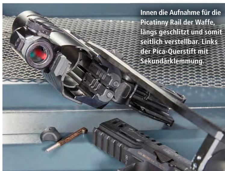
Innen die Aufnahme für die Picatinny Rail der Waffe, längs geschlitzt und somit seitlich verstellbar. Links der Pica-Querstift mit Sekundärklemmung.
