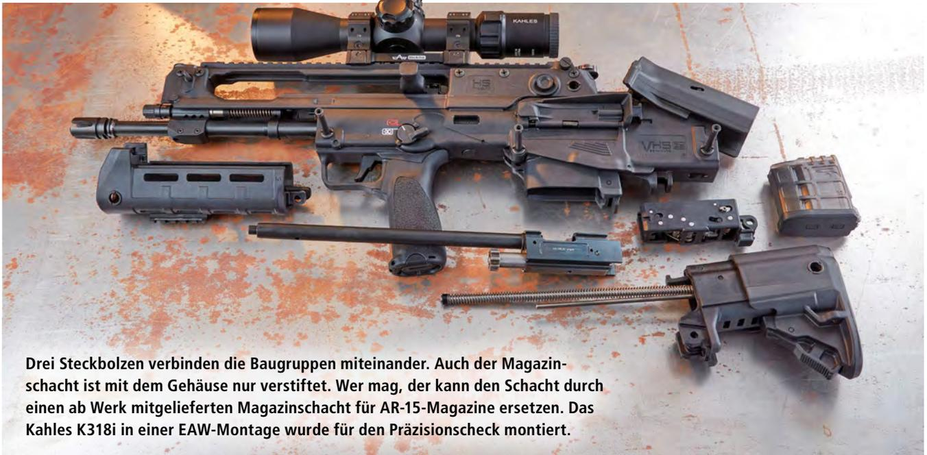
Drei Steckbolzen verbinden die Baugruppen miteinander. Auch der Magazinschacht ist mit dem Gehäuse nur verstiftet. Wer mag, der kann den Schacht durch einen ab Werk mitgelieferten Magazinschacht für AR-15-Magazine ersetzen. Das Kahles K318i in einer EAW-Montage wurde für den Präzisionscheck montiert.
