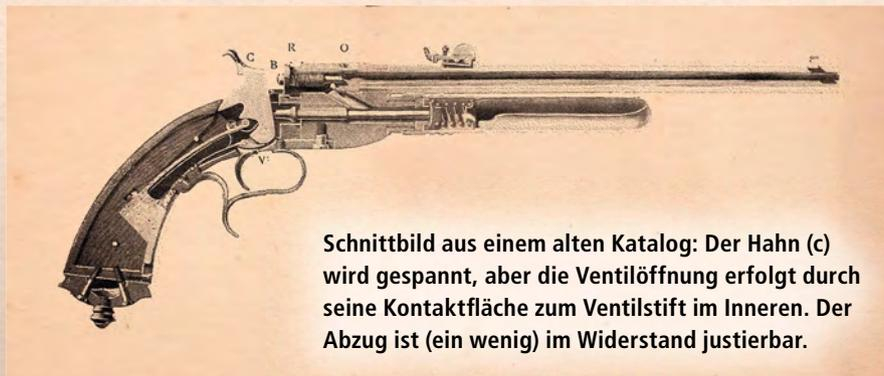
Schnittbild aus einem alten Katalog: Der Hahn (c) wird gespannt, aber die Ventilöffnung erfolgt durch seine Kontaktfläche zum Ventilstift im Inneren. Der Abzug ist (ein wenig) im Widerstand justierbar.
