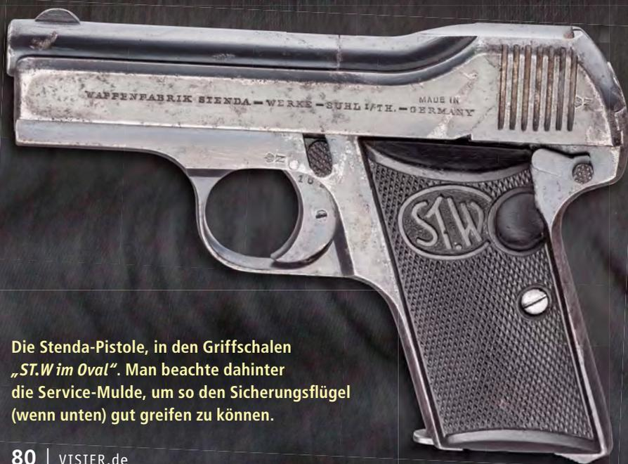
Die Stenda-Pistole, in den Griffschalen „ST.W im Oval“. Man beachte dahinter die Service-Mulde, um so den Sicherungsflügel (wenn unten) gut greifen zu können.
