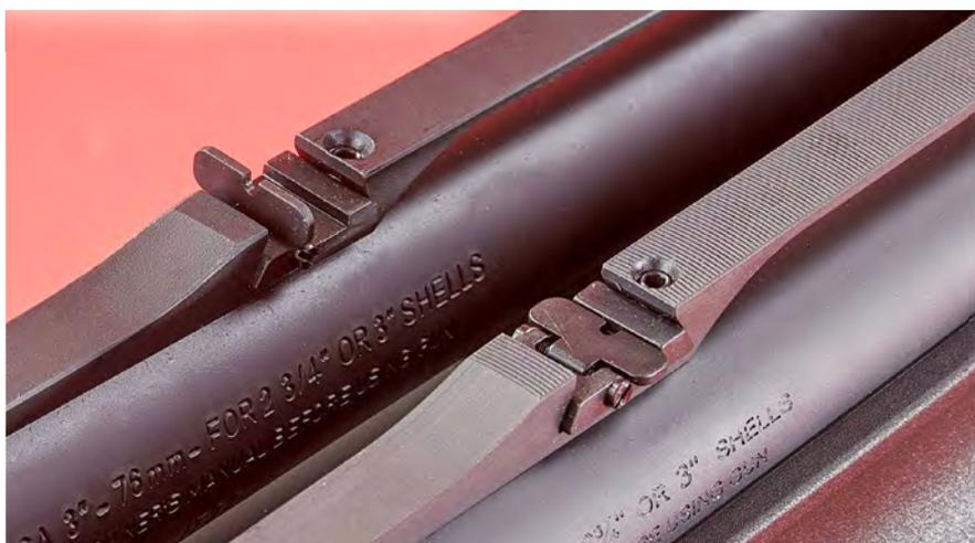
Wenn es besonders fix gehen muss mit der Aufnahme des Zieles, kann man die tief in die ventilierte Laufschiene eingelassene Kimme einfach umklappen und nutzt dann bei der Benelli Nova Speed nur Schiene und Leuchtkorn als Zielhilfe.
