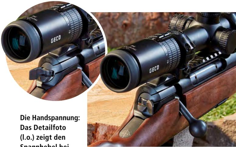
**Die Handspannung:** Das Detailfoto (l.o.) zeigt den Spannhebel bei entspanntem Schloss. Steht der Hebel nach rechts auf „feuerbereit“, sieht man einen roten Punkt oben auf der Entspanntaste.
