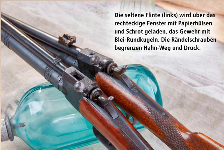
Die seltene Flinte (links) wird über das rechteckige Fenster mit Papierhülsen und Schrot geladen, das Gewehr mit Blei-Rundkugeln. Die Rändelschrauben begrenzen Hahn-Weg und Druck.
