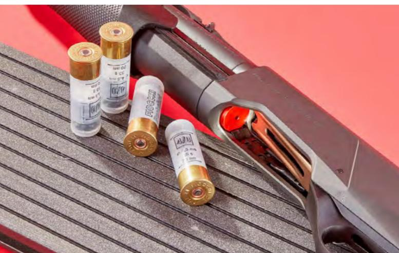
Die Ladeöffnung ist einseitig extrem tief ausgefräst, dies erleichtert das Laden ungemein. Einmal angetippt, verharrt der Ladelöffel bei allen Pump Actions von Benelli im Gehäuse.
