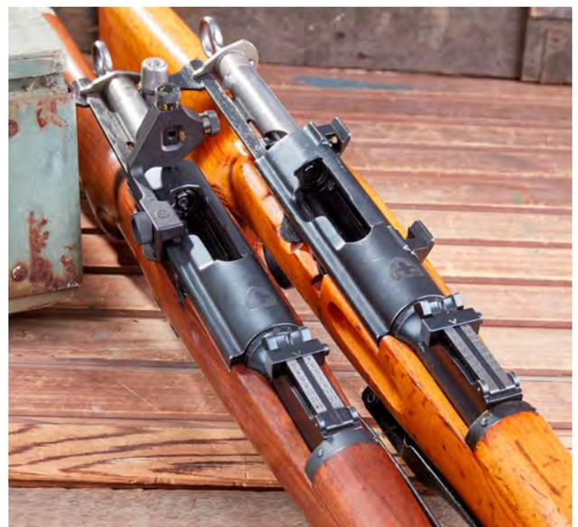
Die Systemhülse des Zielfernrohr-Karabiners 55 (rechts) weicht von der des Karabiners 31 stark ab. Sie wurde etwa um 10° nach rechts geneigt gefertigt, um den Hülsenauswurf am Tubus des Zielfernrohres vorbei nach rechts hinaus zu gewährleisten.
