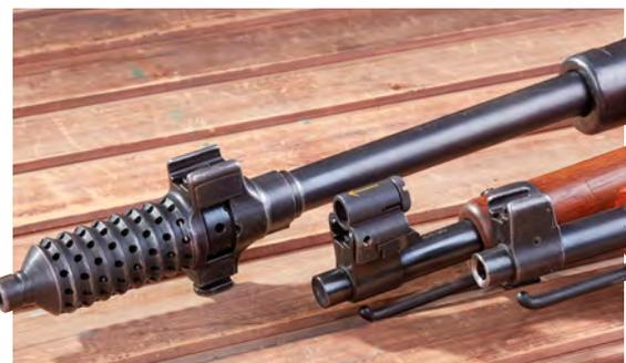
Der massive und optisch längere Lauf des Zielfernrohr-Karabiners 55 endet in einem recht imposanten Signaturdämpfer. Das Ringkorn am Diopter-Karabiner 31 ist auf dem Original-Kornträger nur angeschraubt.
