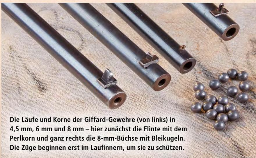
Die Läufe und Korne der Giffard-Gewehre (von links) in 4,5 mm, 6 mm und 8 mm – hier zunächst die Flinte mit dem Perlkorn und ganz rechts die 8-mm-Büchse mit Bleikugeln. Die Züge beginnen erst im Laufinnern, um sie zu schützen.
