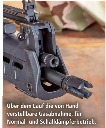
Über dem Lauf die von Hand verstellbare Gasabnahme, für Normal- und Schalldämpferbetrieb.
