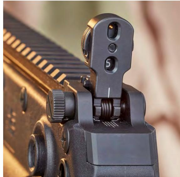
Die flache, klappbare Lochkimme des HS Produkt VHS 2s arretiert sowohl geschlossen als auch hochgeklappt. Durch verdrehen stehen mehrere Lochkimmen für unterschiedliche Distanzen zur Verfügung. Die Stellschraube links ist für die Seitenjustierung der Kimme zuständig.
