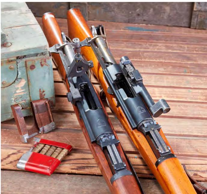
Die Systemhülsen des K 31 links, hier mit nachgerüstetem Diopter, und dem Zielfernrohr-Karabiner 31/43 (r.) sind völlig gleich.
