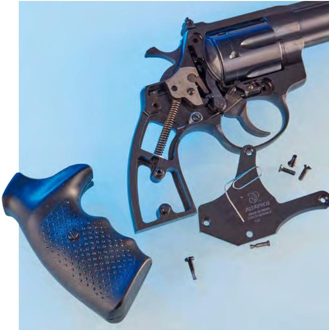
**Stellwerk:** Der Exzenter zum Regulieren des Abzugswiderstandes ist auch ohne Abnahme der Schlossplatte zugänglich. Wer die Schlossplatte entfernt, muss vor dem Wiedereinsetzen durch das kleine, obere Loch einen federnden Druckstift mittels Büroklammer oder Stecknadel fixieren.
