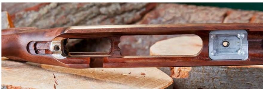
Das System ruht im Schaft in zwei Aluminiumelementen. Das vordere, große Teilstück nimmt den aus der Systemhülse herausgearbeiteten Block der Laufklemmung auf.
