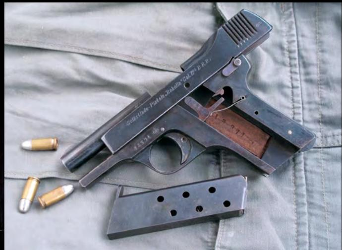
Zeitgemäß steckte in Menta, Beholla, Leonhardt und Stenda je ein einreihiges Sieben-Schuss-Blechmagazin, in diesem Fall mit sechs Löchern zur Sichtkontrolle des Ladezustands.
