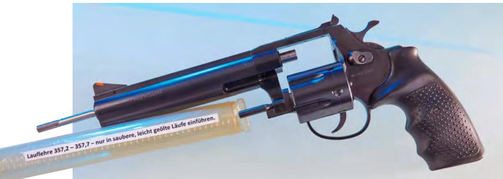
**Bloß nicht anecken:** Die Lauflehre, leicht konisch geschliffen, dient der Überprüfung des Fluchtens von Kammer-Ausgängen zum Lauf. Das Messmittel stieß nirgends an.
