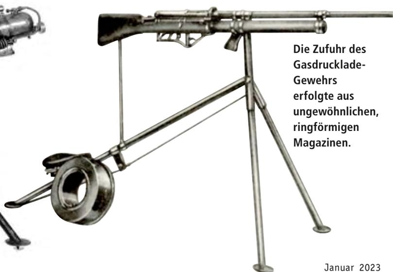
Die Zufuhr des Gasdrucklade-Gewehrs erfolgte aus ungewöhnlichen, ringförmigen Magazinen.
