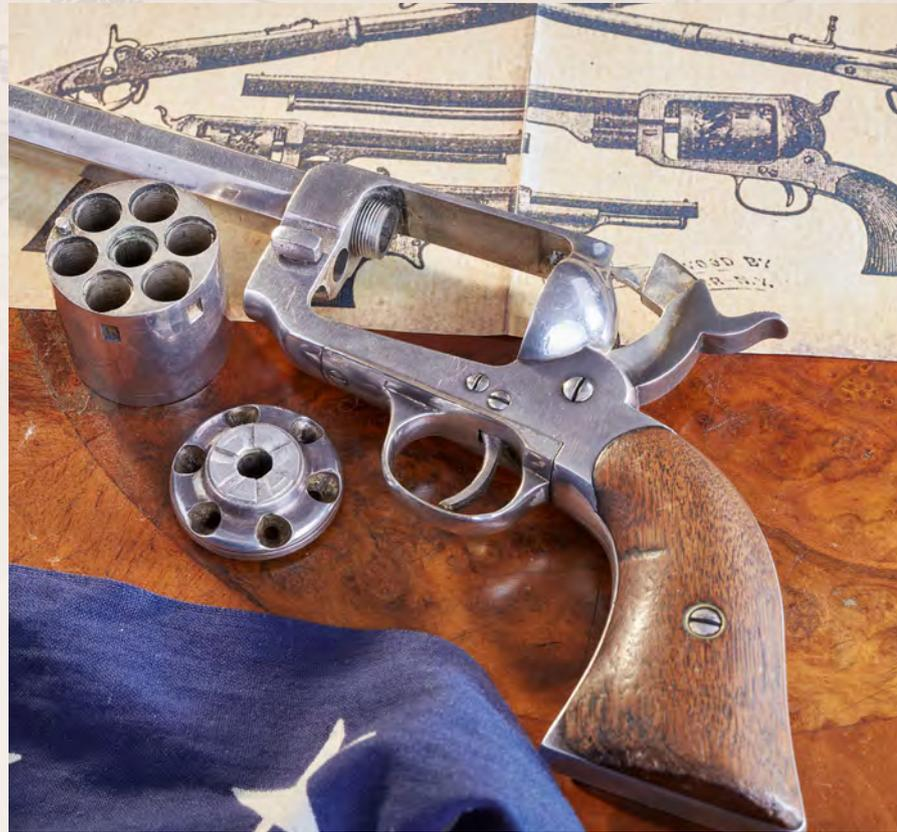
Zum Zerlegen Hahn in Laderast, Knebelschraube am Rahmen waagrecht stellen. Ladepresse abklappen, Achse ausziehen, Trommel entnehmen. Die Abdeckplatte kommt draußen runter. Dann sieht man, dass sie per Pin auf der Walze zentriert wird.
