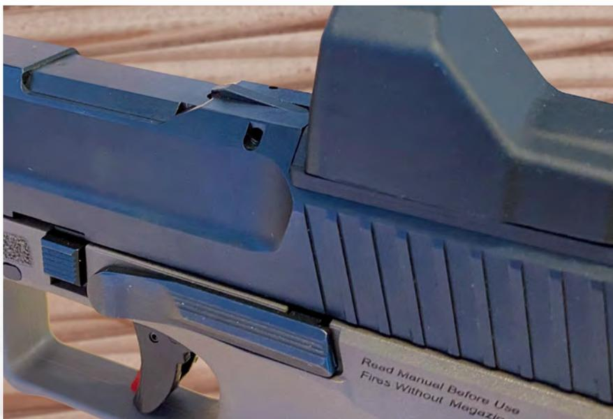
Nummer Sicher 2.0: Die relativ weit und oben aus dem Verschluss ragende Anzeigeklinke signalisiert sehr deutlich, dass eine Patrone (oder Hülse) im Lauf steckt.
