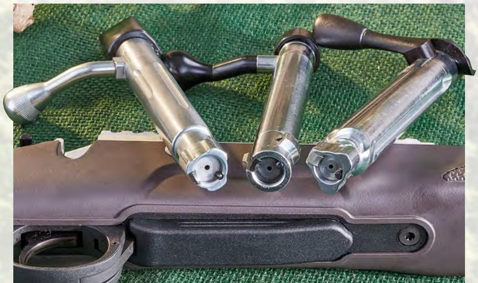
Alles Kopfsache: Der Verschluss der Brenner (links) und der Mercury (rechts) verriegelt mit drei, der mittlere (Monza) mit zwei Warzen. Alle Verschlüsse laufen auch penibel entölt leicht bis sehr leicht. Die Öffnungswinkel liegen unter 70 Grad.
