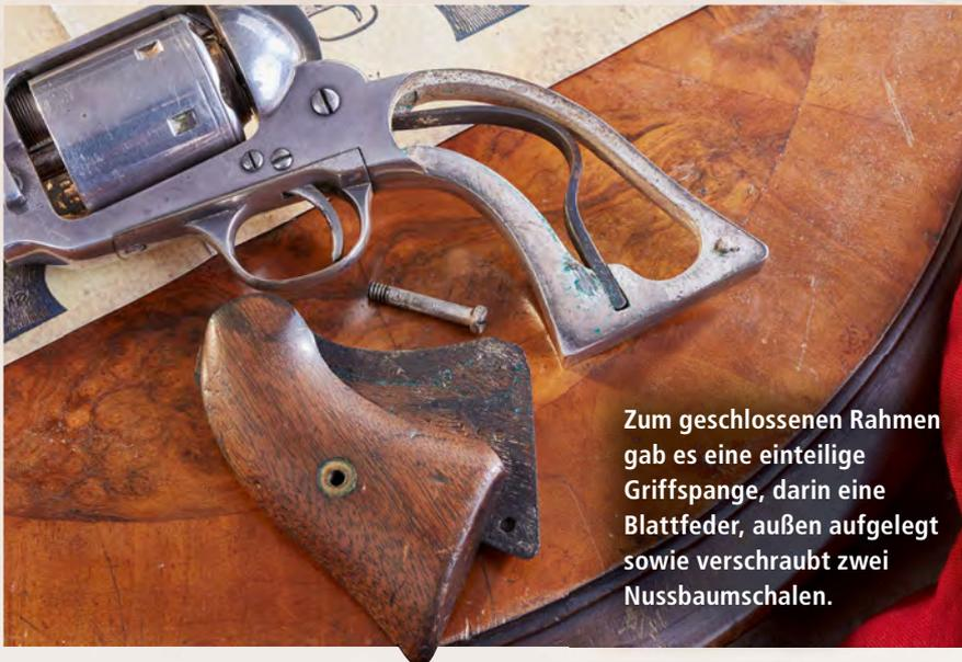
Zum geschlossenen Rahmen gab es eine einteilige Griffspange, darin eine Blattfeder, außen aufgelegt sowie verschraubt zwei Nussbaumschalen.
