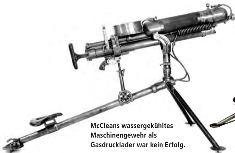
McCleans wassergekühltes Maschinengewehr als Gasdrucklader war kein Erfolg.
