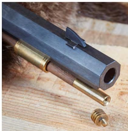
Über der angesenkten Mündung sitzt das seitlich driftbare Korn. Der Ladestock der Büchse hat einen eingeschraubten Putzkopf.
