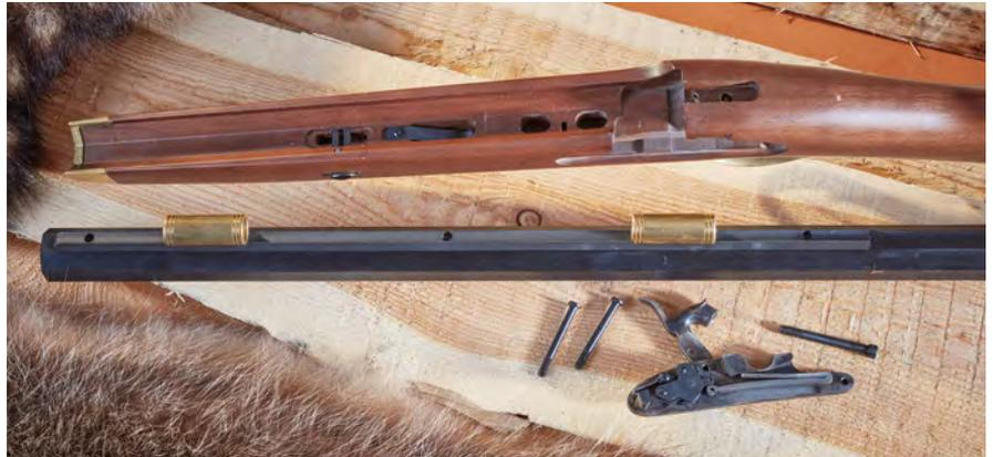
Ladestock raus, drei Schrauben lösen, Laufkeil austreiben – dann lassen sich der Lauf (mit Schiene) und das Perkussionsschloss vom sauber gearbeiteten Schaft abnehmen.
