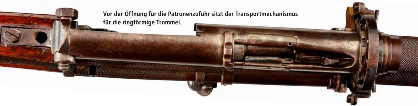
Vor der Öffnung für die Patronenzufuhr sitzt der Transportmechanismus für die ringförmige Trommel.
