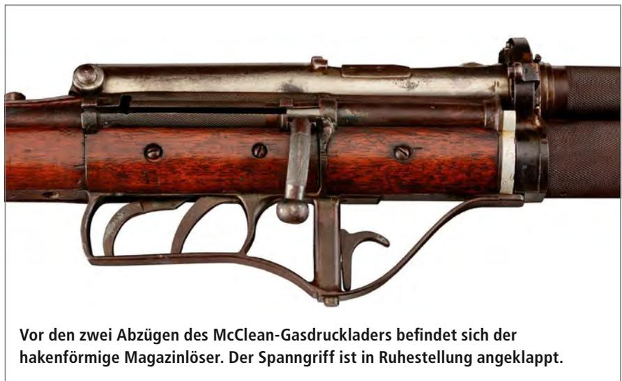
Vor den zwei Abzügen des McClean-Gasdruckladers befindet sich der hakenförmige Magazinlöser. Der Spanngriff ist in Ruhestellung angeklappt.
