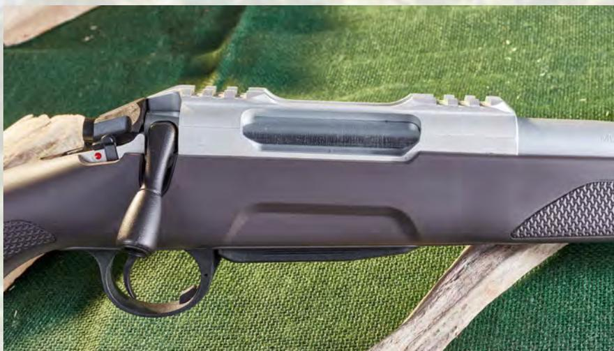
Alles aus einem Guss: Picatinny-Schiene und Systemhülse der Mercury bestehen aus einem Stück Aluminium. Daher ist sie die mit Abstand leichteste Testbüchse.
