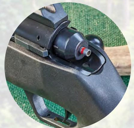
Auch bei der Monza signalisiert der weit herausragende Schlagbolzen mit roter Markierung das gespannte Schloss.
