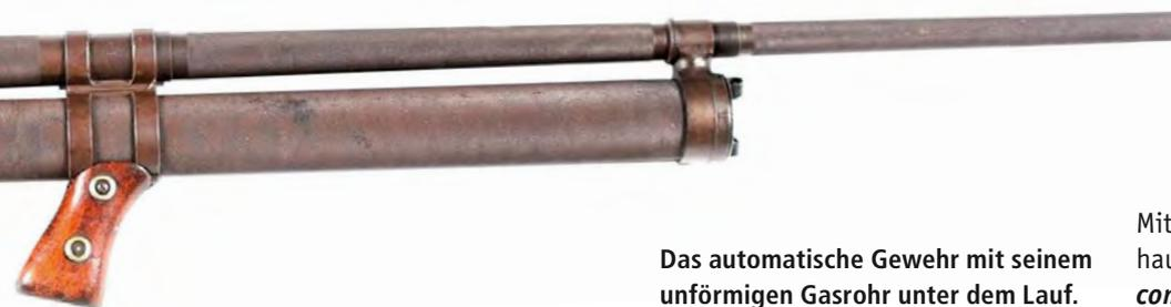
Das automatische Gewehr mit seinem unförmigen Gasrohr unter dem Lauf.
