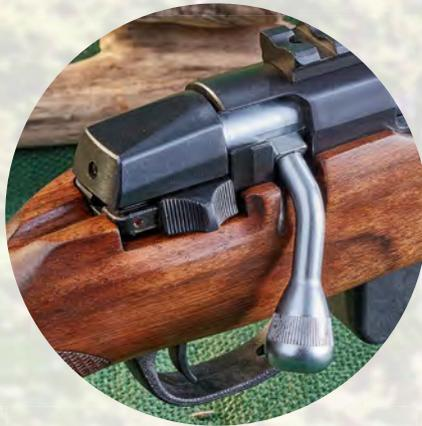
Der Sicherungsschieber der Brenner hat drei Positionen. Sicher und Kammerstängel gesperrt, sicher aber Kammerstängel frei, und entsichert. Nur bei gefühlvoller Führung arbeitet der Schieber lautlos.
