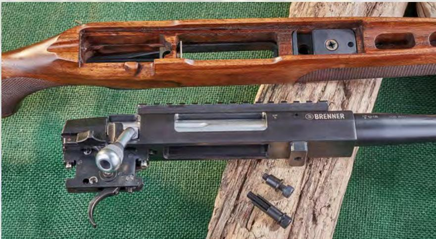
Nach Lösen des Schrauben-Sicherungslacks kann an der Brenner auch der Nachzug des Abzugzüngels eingestellt werden. Der Auslösewiderstand lässt sich um etwa 500 Gramm variieren, er liegt, ähnlich wie bei den anderen Testwaffen, zwischen 1400 und 1900 Gramm. Top: das massiv ausgeführte Rückstoßlager.
