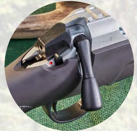
Der Sicherungshebel der Mercury lässt sich nur bei gespanntem Schloss bewegen, auch er wirkt auf den Abzug und sperrt den Kammerstängel. Allerdings gibt er, selbst langsam geführt, leise Klickgeräusche von sich.
