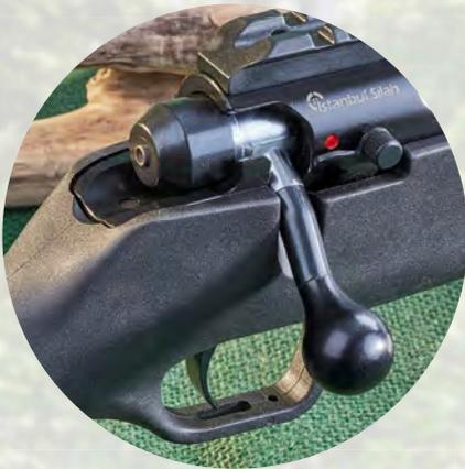
Der Sicherungshebel der Monza wirkt auf den Abzug und sperrt auch den Kammerstängel. Langsam geführt, läuft das absolut geräuschlos. Wirkt im gespannten und entspannten Zustand.
