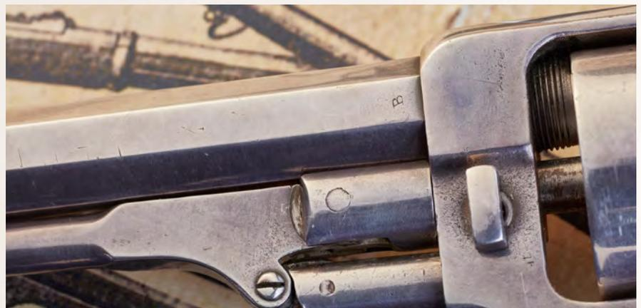
Am Lauf die Werksinspektorenmarke „B“, rechts darunter die Knebelschraube, über die man die Arretierung der die Trommelachse löst beziehungsweise aktiviert.
