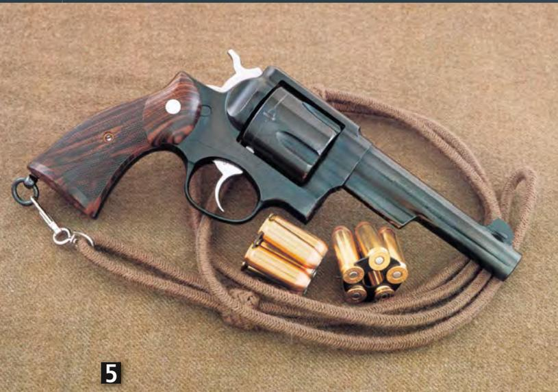
**5** Unterstatement: ein Ruger Redhawk, aber im Stil eines M1917-Revolvers, mit höhenjustierbarem Korn und Fangschnur (die ungewöhnliche Ösenposition lässt die Seriennummer sichtbar). Das Kaliber: fünf Patronen in .50 AE, gehalten in Clips.
