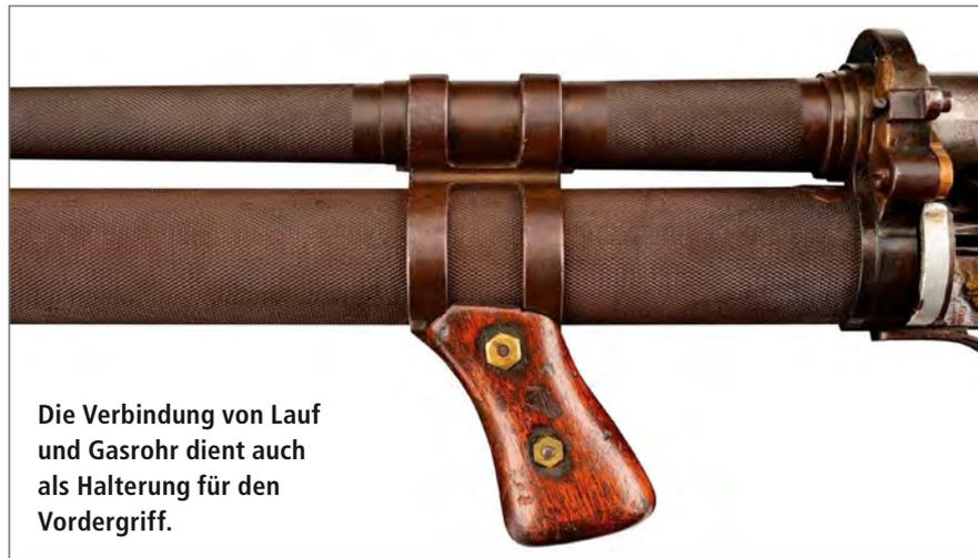
Die Verbindung von Lauf und Gasrohr dient auch als Halterung für den Vordergriff.
