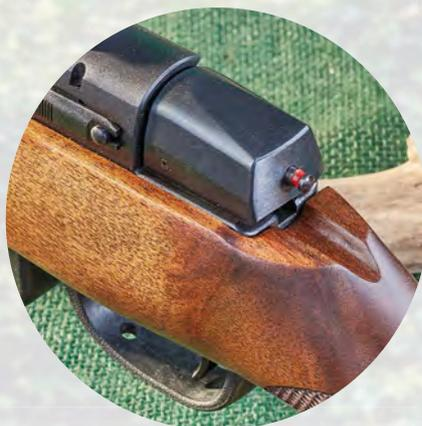
Da ist jetzt Spannung drauf: Die rote Markierung am Schlagbolzen wird erst bei gespanntem Schloss sichtbar.
