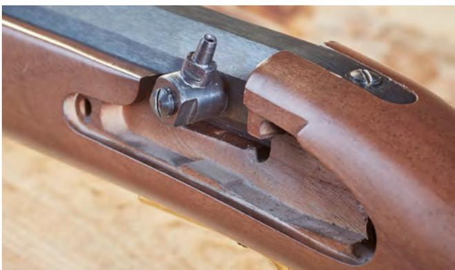
Die Perkussions-Einheit vom Typ Drum and Nipple. Man beachte die Zündkanalschraube links am Piston-Trömmelchen und das sauber ausgestochene Schaftholz der Büchse.
