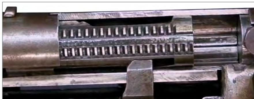
Der Verschluss des Gewehrs verriegelt über mehrere Kämme.
