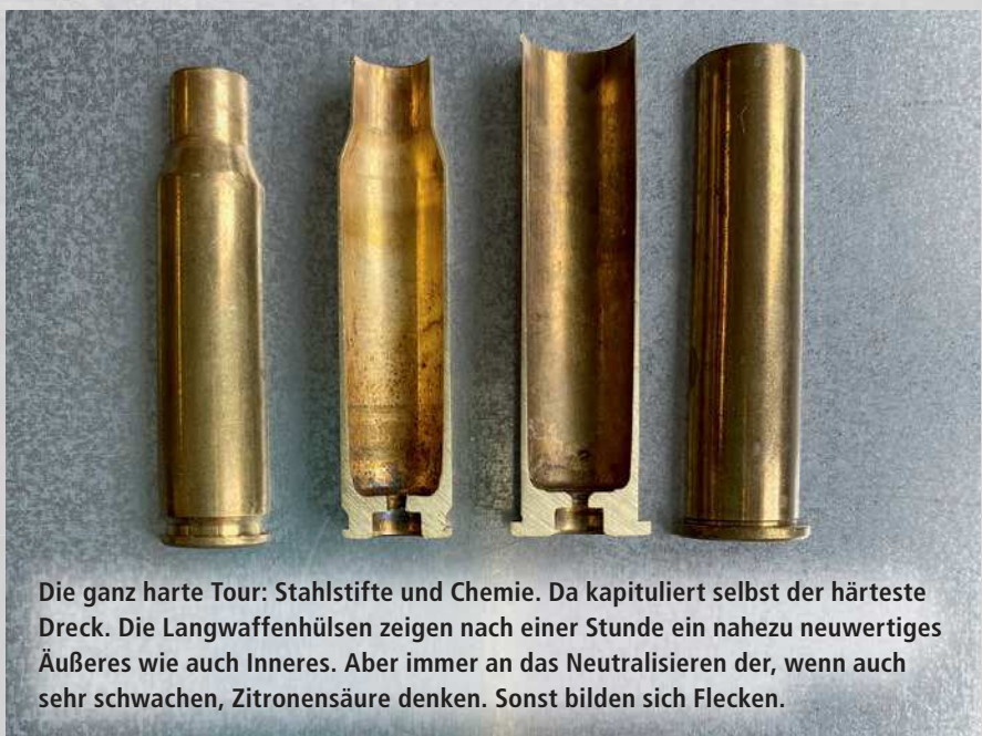
Ähnlich „fast“ blankes Innenleben zeigen die Schnitte von Hülsen 9 mm Luger und .45 ACP. Die Verweildauer im Ultraschallbecken betrug jeweils 3 x 20 Minuten. Versuche mit längeren Laufzeiten brachten kaum bessere Ergebnisse.
