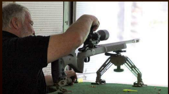
Beim Wechsel der Distanz ist „Türmchendreihen“ angesagt, Aber ohne eine ZF-Montage mit Vorneigung geht es nicht.
