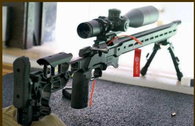
Hightech vom Feinsten: Die Kleinkaliber-Repetiergewehre (hier ein Tikka T1X) bekommen oft neue Schäfte von MDT oder anderen Anbietern. Das Zielfernrohr stammt hier von Vortex.
