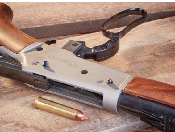
Die zwei oberen Schrauben verdecken die Bohrungen für eine Ausleger-Montage. So soll der Auswurf frei bleiben.
