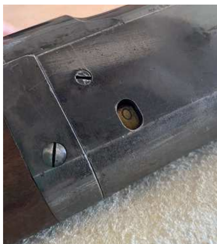
Ein sehr beliebtes Gimmick bei der Savage M 1899: die mit einem Zählwerk ausgestattete Ladestandanzeige links vorn am Systemkasten.
