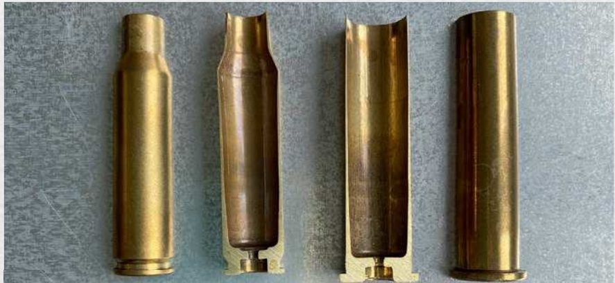
Die Flaschenhals-Hülsen, hier im Kaliber .308 Winchester, reinigt das Ultraschallbecken mit Zusatz handelsüblicher Zitronensäure von innen sehr gut. Übrig bleibt lediglich eine dezente Braunfärbung. Ebenfalls prima: die Hülsen Kaliber .45/70.
