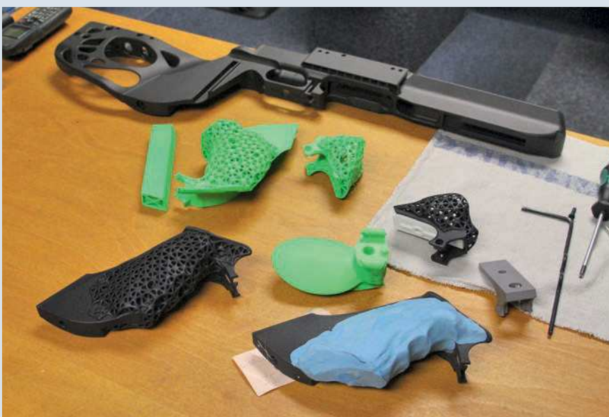
Mit Hilfe dieser Muster-Handgriffe und -Vorderstützen und viel Knetmasse werden die Vorlagen für die 3D-Fertigung nach Maß erstellt, die dann gesintert werden.
