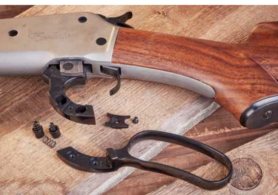
Die Kombination von Abdeckplatte und gefederten Schrauben hält den wechselbaren Lever fest an der Waffe: gut.
