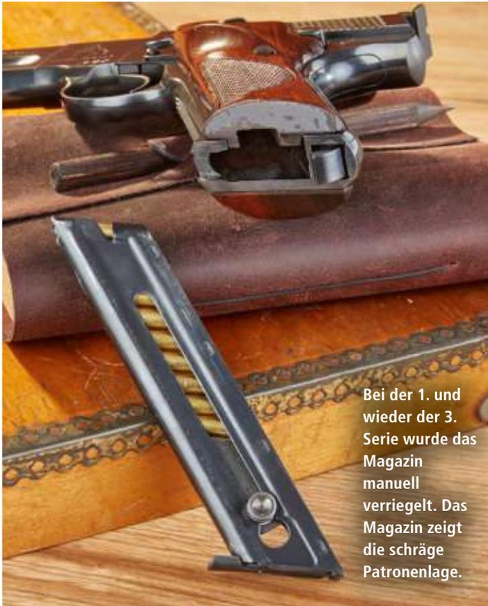
Bei der 1. und wieder der 3. Serie wurde das Magazin manuell verriegelt. Das Magazin zeigt die schräge Patronenlage.
