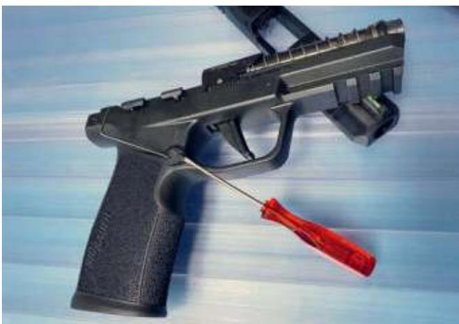
Das Umstecken des Magazinauslösers erfordert den im Lieferumfang enthaltenen, kleinen Inbusschlüssel. Dazu einen nicht im Lieferumfang enthaltenen Mini-Schraubendreher, hier einen Passenden des Rotpunktvisiers von Noblex.
