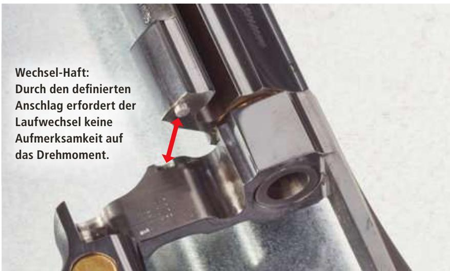
**Wechsel-Haft:** Durch den definierten Anschlag erfordert der Laufwechsel keine Aufmerksamkeit auf das Drehmoment.
