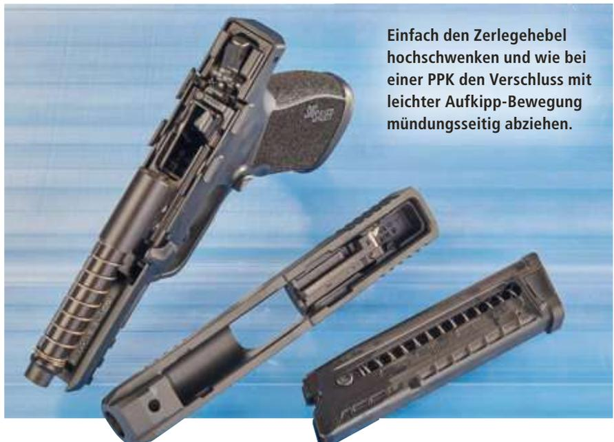
Einfach den Zerlegehebel hochschwenken und wie bei einer PPK den Verschluss mit leichter Aufkipp-Bewegung mündungsseitig abziehen.
