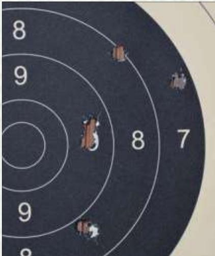
Streukreis mit Geschoss Nr. 1c, aufgelegt geschossen aus einem Gewehr des Kalibers .45.
