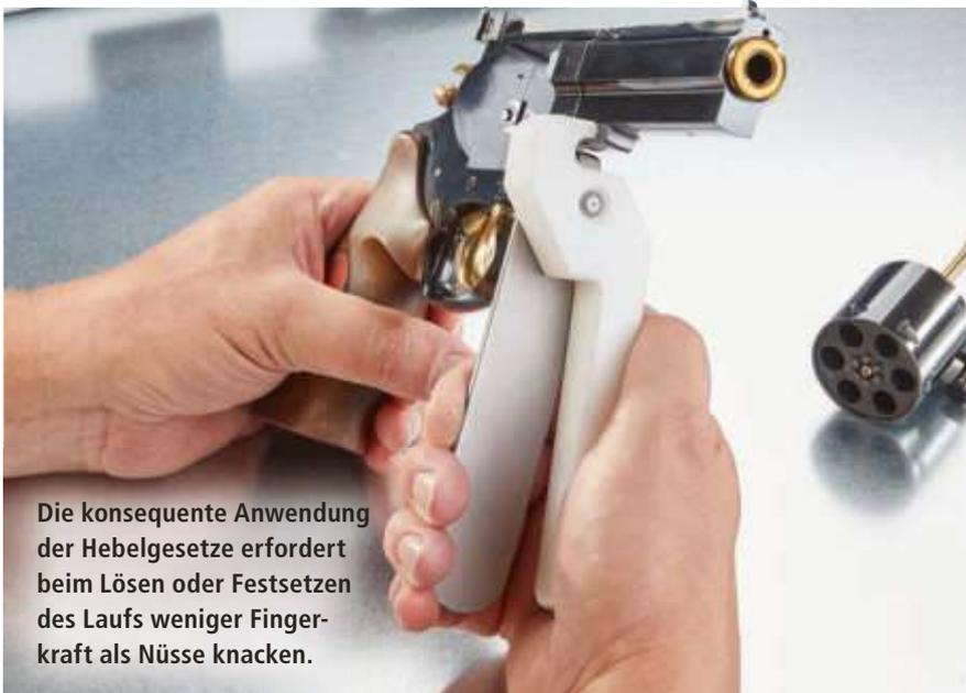
Die konsequente Anwendung der Hebelgesetze erfordert beim Lösen oder Festsetzen des Laufs weniger Fingerkraft als Nüsse knacken.
