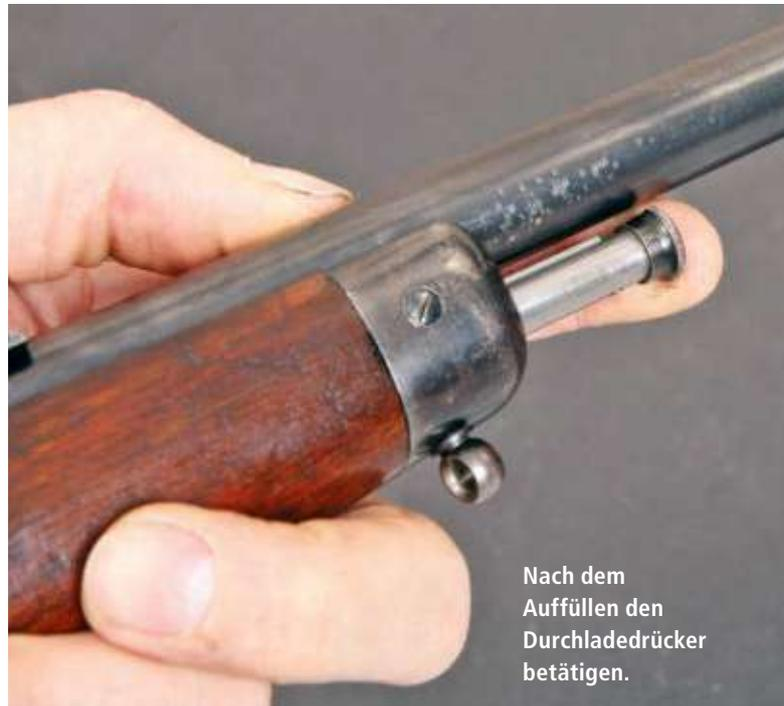
Nach dem Auffüllen den Durchladedrucker betätigen.
