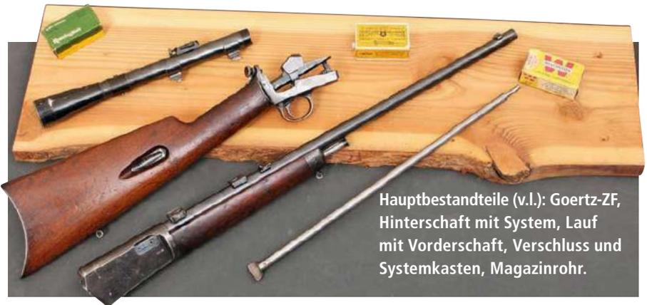
**Hauptbestandteile (v.l.): Goertz-ZF, Hinterschaft mit System, Lauf mit Vorderschaft, Verschluss und Systemkasten, Magazinrohr.**
