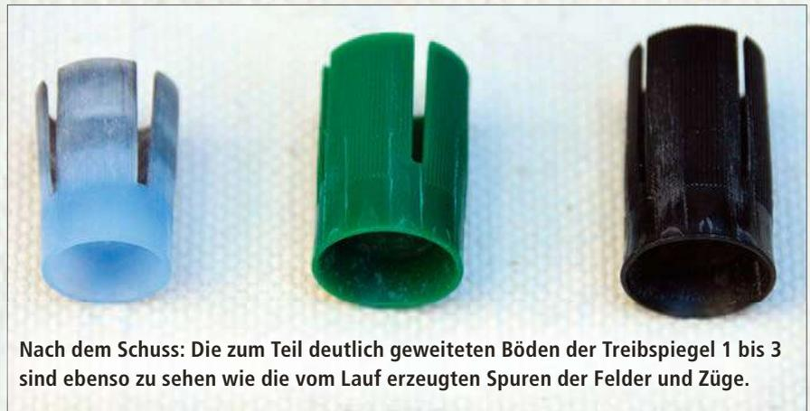
Nach dem Schuss: Die zum Teil deutlich geweiteten Böden der Treibspiegel 1 bis 3 sind ebenso zu sehen wie die vom Lauf erzeugten Spuren der Felder und Züge.
