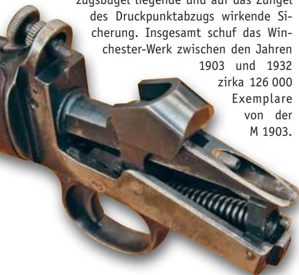
**Das M 1903-System: hinteres Systemteil mit gabelförmigem Schlaghammer, Schlagfeder, Patrone in Zuführung, links oben Zerlegeschraube.**
