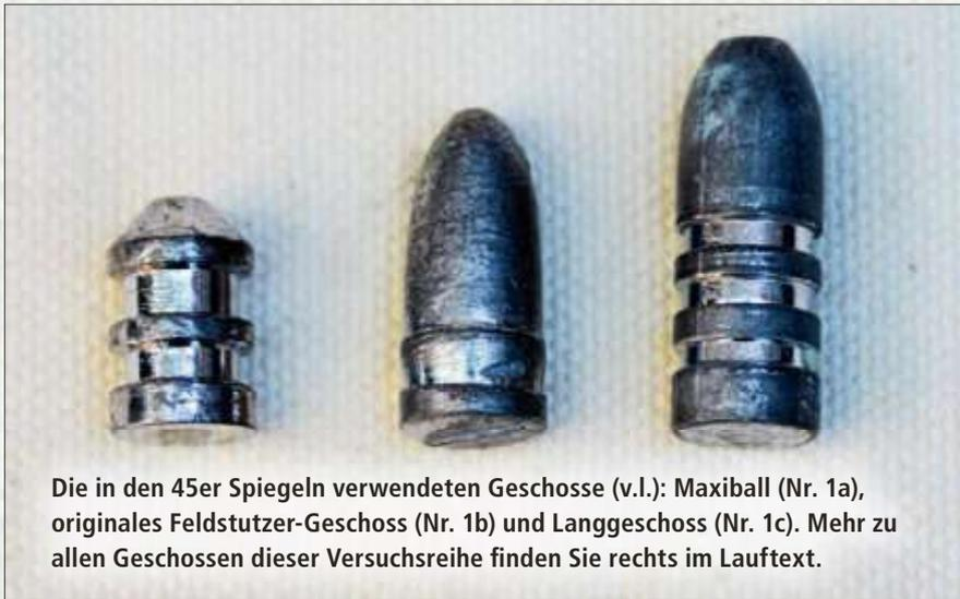
Die in den 45er Spiegeln verwendeten Geschosse (v.l.): Maxiball (Nr. 1a), originales Feldstutzer-Geschoss (Nr. 1b) und Langgeschoss (Nr. 1c). Mehr zu allen Geschossen dieser Versuchsreihe finden Sie rechts im Lauftext.
