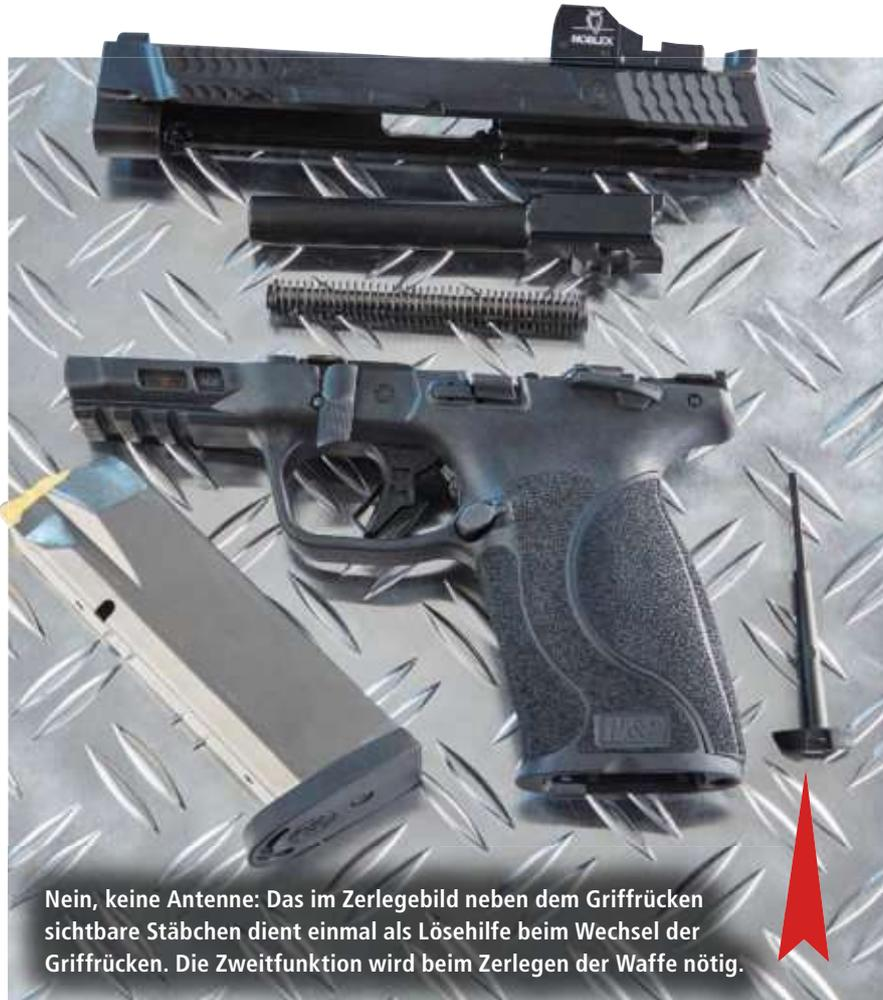
Nein, keine Antenne: Das im Zerlegebild neben dem Griffrücken sichtbare Stäbchen dient einmal als Lösehilfe beim Wechsel der Griffrücken. Die Zweitfunktion wird beim Zerlegen der Waffe.
