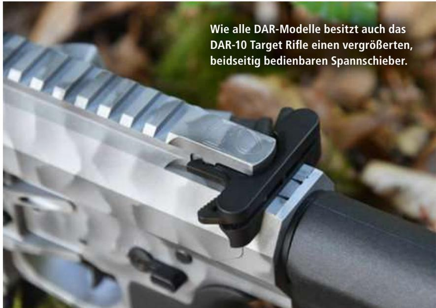
Wie alle DAR-Modelle besitzt auch das DAR-10 Target Rifle einen vergrößerten, beidseitig bedienbaren Spanschieber.
