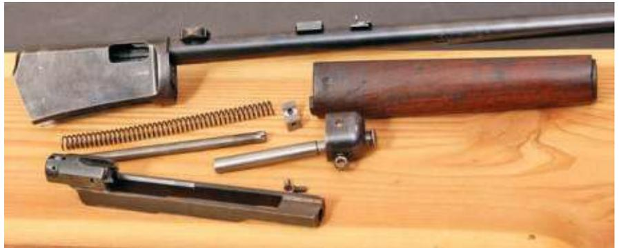
**Noch weiter zerlegt (von oben): System mit Lauf, Vorderschaft, Schließfeder mit -stange, Haltestück zu Vorderschaftkappe, Drücker mit Vorderschaftkappe, Verschluss mit Auszieher/Auswerfer.**
