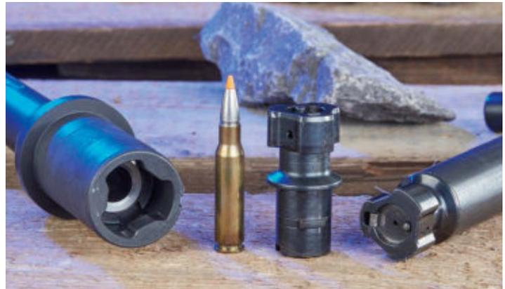
Die Verriegelungshülse ist mit der Laufwurzel verschraubt und trägt die Gegenstücke für die Verschlusswarzen. In der Mitte steht der auswechselbare Verschlusskopf, hier gezeigt im Größenvergleich zu einer Patrone in .308 Winchester.
