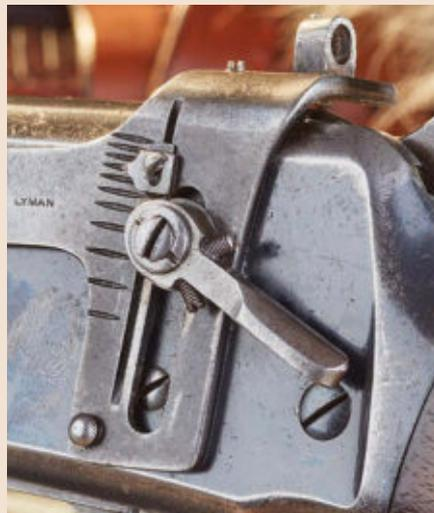
**Receiver Sight von Lyman, hier Version #38:** Lösen des Hebels, nun kann man das gesamte Element heben / senken, zwei kleine Schrauben steuern die Klemmwirkung des Hebels. Skala und Arretierschraube erlauben Einstellen und Nullen. Seitliches Justieren geht auch. Im Ring (Bild I.) sitzt ein kleinerer Klappeinsatz, so gibt's zwei Visiergrößen.
