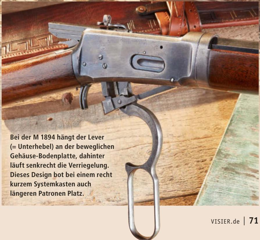
**Bei der M 1894 hängt der Lever (= Unterhebel) an der beweglichen Gehäuse-Bodenplatte, dahinter läuft senkrecht die Verriegelung. Dieses Design bot bei einem recht kurzem Systemkasten auch längeren Patronen Platz.**
