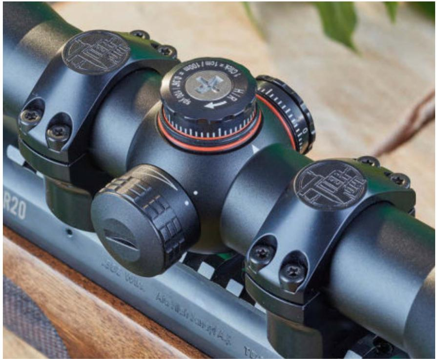
Über den links am Mittelrohr angebrachten Drehregler (hier in Position „ausgeschaltet“) lässt sich die Intensität des Leuchtpunktes im Absehen stufenlos regeln. Zum Einschalten und für mehr Helligkeit muss man ihn im Uhrzeigersinn drehen.
