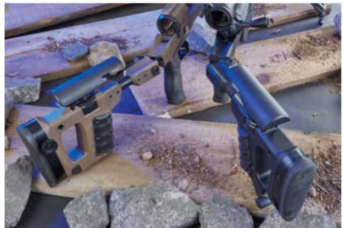
Bei der Voere X4 lässt sich der Hinterschaft rechts oder links anschlagend umbauen. Gleiches gilt für den Hülsenauswurf und für die Position des Kammerstengels.
