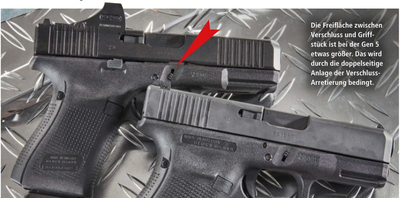
Die Freifläche zwischen Verschluss und Griffstück ist bei der Gen 5 etwas größer. Das wird durch die doppelseitige Anlage der Verschluss-Arretierung bedingt.
