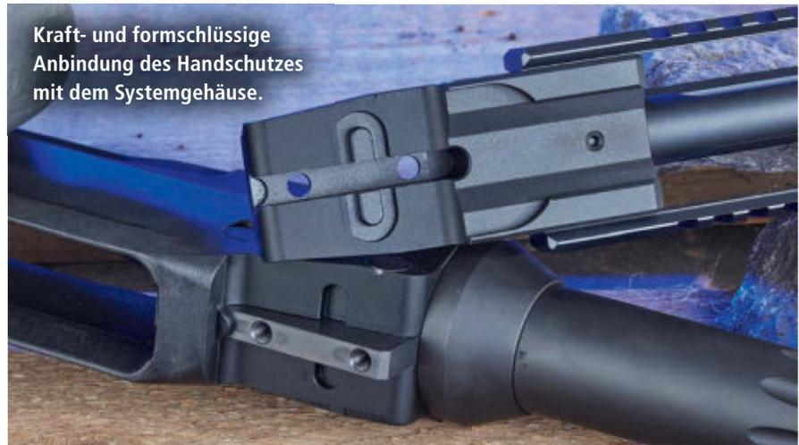
**Kraft- und formschlüssige Anbindung des Handschutzes mit dem Systemgehäuse.**
