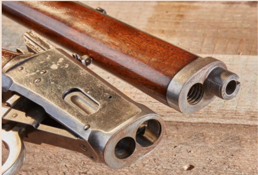
Bei geöffnetem Verschluss erlaubt das Takedown-System über den Drehhebel unten vorn am Magazin das Lösen der Röhre und danach das Abnehmen des Waffenvorderteils. Dank der Schnellgewinde-Verbindung zwischen dem Lauf und dem Systemkasten erfolgt dieses Zerlegen nach einer Viertelkreis-Drehung.
