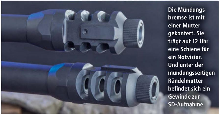
Die Mündungs-bremse ist mit einer Mutter gekonkret. Sie trägt auf 12 Uhr eine Schiene für ein Notvisier. Und unter der mündungsseitigen Rändelmutter befindet sich ein Gewinde zur SD-Aufnahme.
