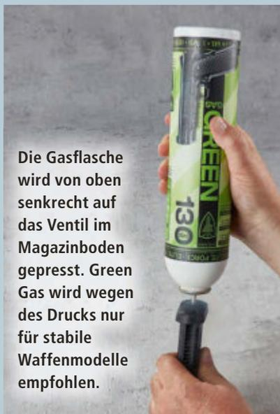
Die Gasflasche wird von oben senkrecht auf das Ventil im Magazinboden gepresst. Green Gas wird wegen des Drucks nur für stabile Waffenmodelle empfohlen.
