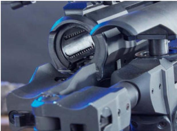
Ein Linearkugellager führt den massiven Verschluss der Voere X4. Zum Schutz des Lagers vor Verschmutzung befindet sich davor ein Radialwellendichtring.
