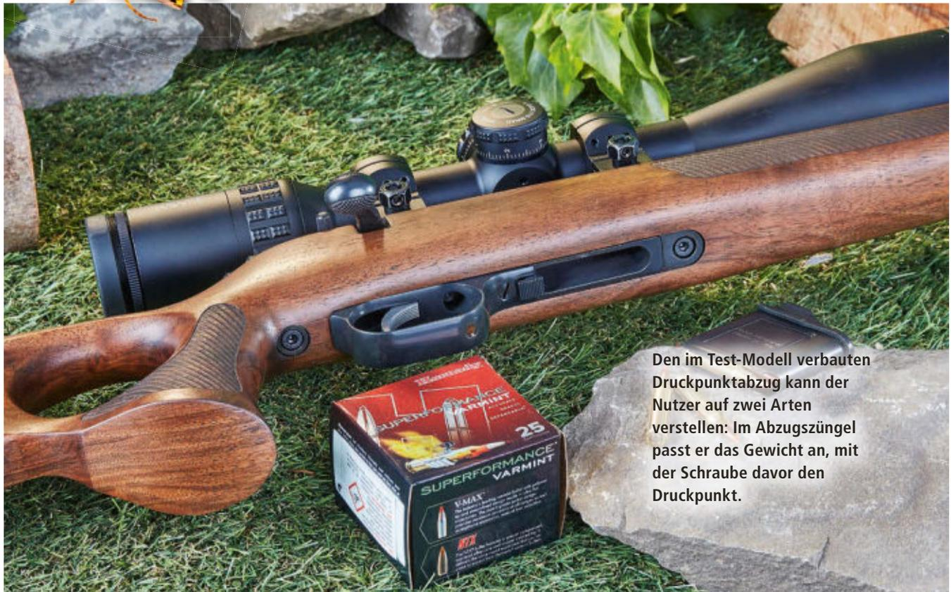
Den im Test-Modell verbauten Druckpunktabzug kann der Nutzer auf zwei Arten verstellen: Im Abzugszüngel passt er das Gewicht an, mit der Schraube davor den Druckpunkt.
