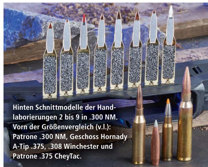
Hinten Schnittmodelle der Handlaborierungen 2 bis 9 in .300 NM. Vorn der Größenvergleich (v.l.): Patrone .300 NM, Geschoss Hornady A-Tip .375, .308 Winchester und Patrone .375 CheyTac.
