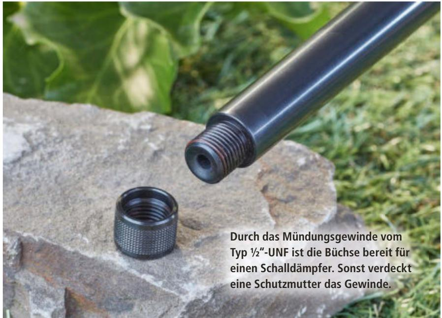
Durch das Mündungsgewinde vom Typ 1/2"-UNF ist die Büchse bereit für einen Schalldämpfer. Sonst verdeckt eine Schutzmutter das Gewinde.
