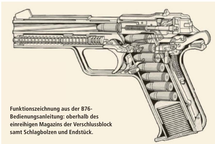
Funktionszeichnung aus der B76-Bedienungsanleitung: oberhalb des einreihigen Magazins der Verschlussblock samt Schlagbolzen und Endstück.
