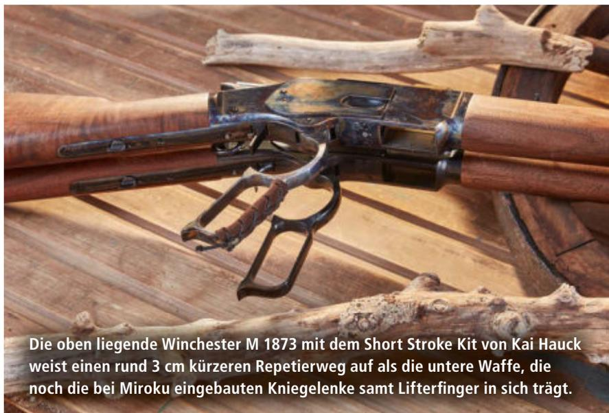
Die oben liegende Winchester M 1873 mit dem Short Stroke Kit von Kai Hauck weist einen rund 3 cm kürzeren Repetierweg auf als die untere Waffe, die noch die bei Miroku eingebauten Kniegelenke samt Lifterfinger in sich trägt.
