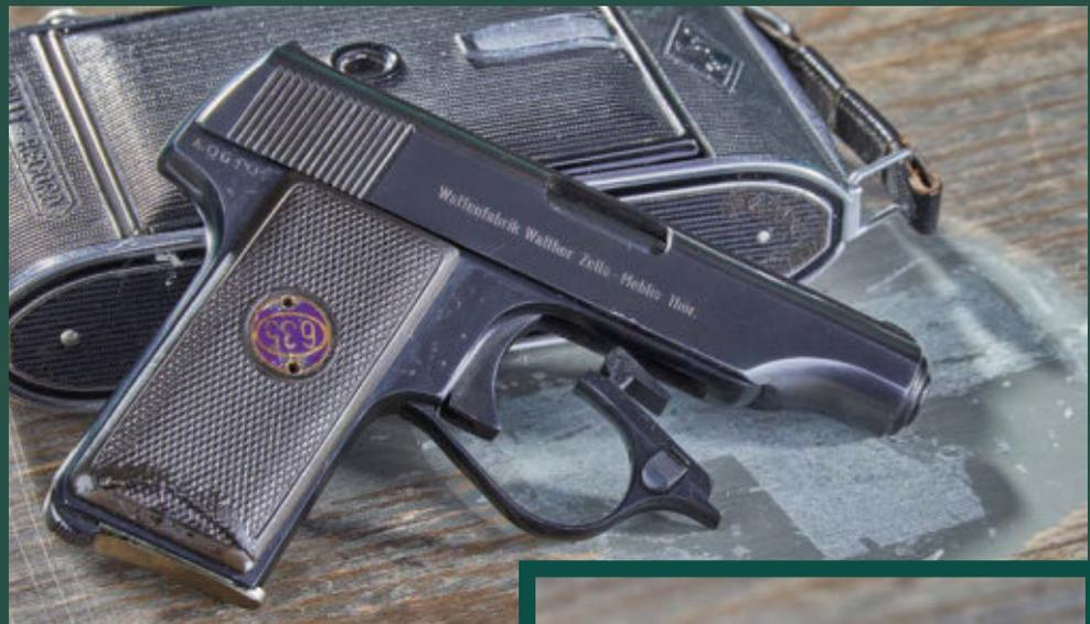
Walthers Einstieg in den Pistolenbau begann um 1910 mit einer Taschenpistole. Das Werk schuf sechs Modelle in 6,35 mm (nicht gerechnet entsprechende Versionen der Modellfamilie PP/PPK). Hier die Modelle 9, 8 und 5 (oben, v.l.), alle einreihig, Single-Action, Lauf starr verbaut, kein Außenhahn.
