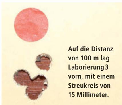
Auf die Distanz von 100 m lag Laborierung 3 vorn, mit einem Streukreis von 15 Millimeter.
