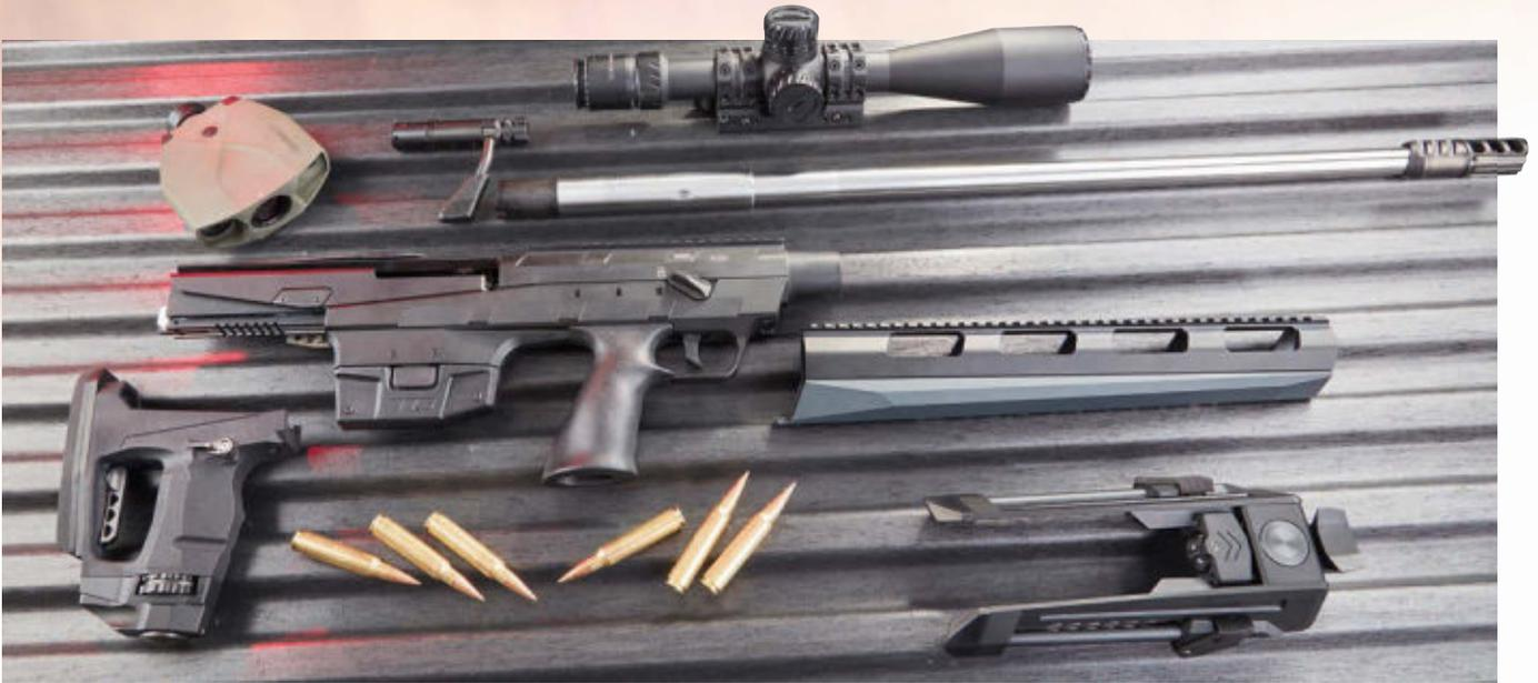
Die TTS Xceed zerlegt in die Hauptgruppen. Oben Lauf und Verschluss, darunter die Schulterstütze, der Systemträger, der Handschutz und das Zweibein. Ganz oben im Bild das ZF von Tangent Theta in einer Montage mit 6-Mil-Vorneigung von Spuhr.
