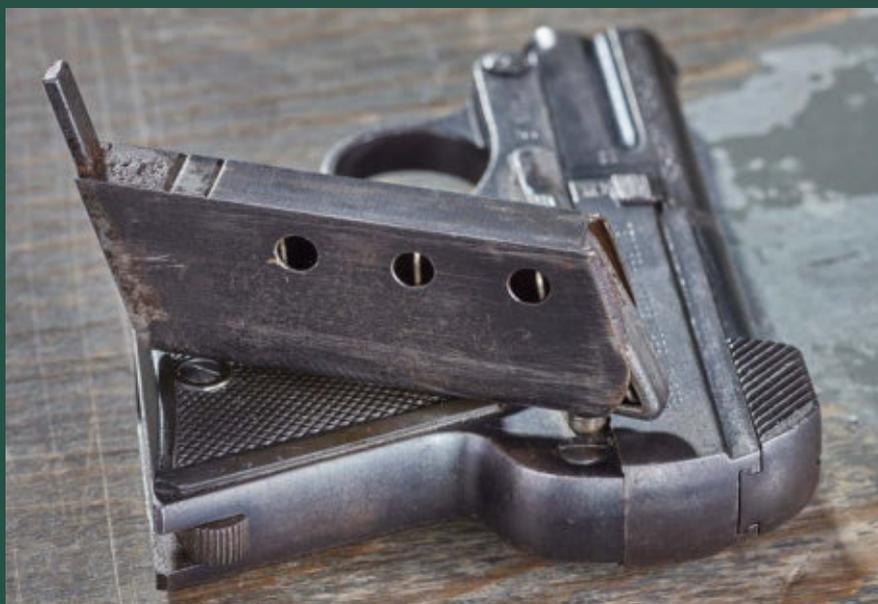
Nicht nur, dass die Handhabe des Steyr-Magazinbodens nach *hinten* zeigt, sondern auch, dass sich das Magazin wie hier ersichtlich in zwei Raststufen setzen lässt: Die obere Rast dient dem Einzelschuss.
