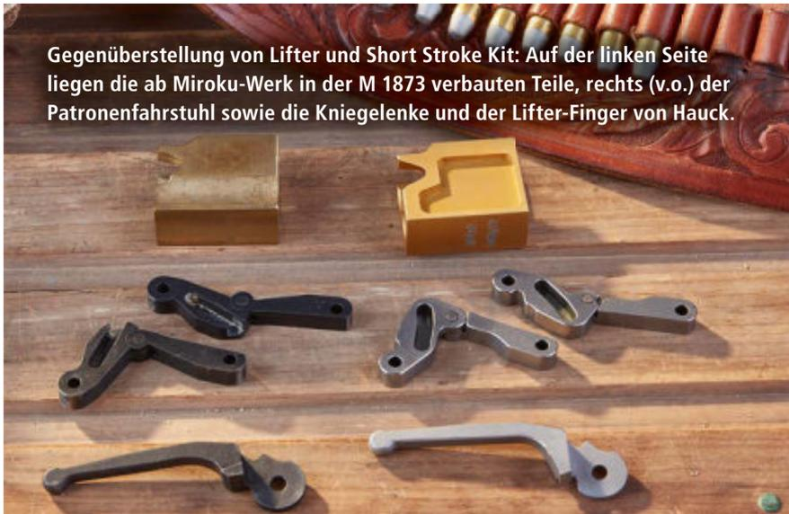
Gegenüberstellung von Lifter und Short Stroke Kit: Auf der linken Seite liegen die ab Miroku-Werk in der M 1873 verbauten Teile, rechts (v.o.) der Patronenfahrstuhl sowie die Kniegelenke und der Lifter-Finger von Hauck.
