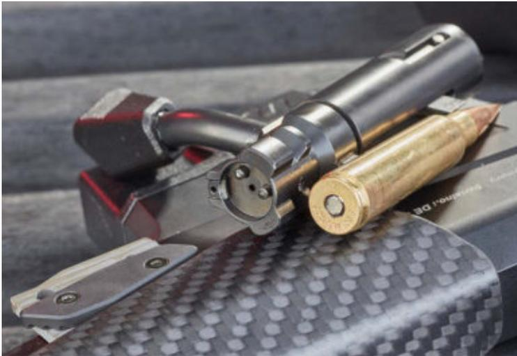
Der Xceed-Verschluss verteilt die axialen Kräfte im Schuss über sechs Warzen in Doppelreihe auf die Verriegelungshülse am Lauf.
