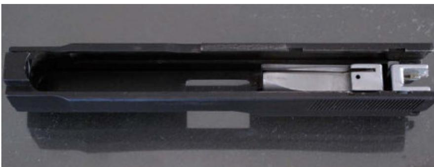
Der Schlitten von unten gesehen, in ihm eingesetzt ist der Verschlussblock samt dem Endstück. In der Längsrinne des Blocks läuft der Patronenhülsenausstoßer.
