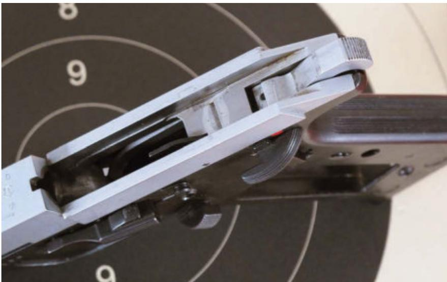
Der Blick ins Griffstück zeigt hinter dem Ausstoßer die querlaufende Steuerkante, an dieser sieht man die Härtelinie und die Marken der Gütekontrolle.
