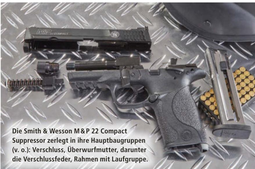
Die Smith & Wesson M&P 22 Compact Suppressor zerlegt in ihre Hauptbaugruppen (v. o.): Verschluss, Überwurfmutter, darunter die Verschlussfeder, Rahmen mit Laufgruppe.
