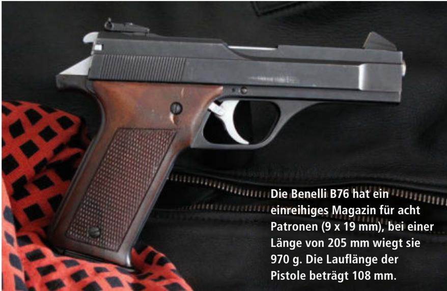
Die Benelli B76 hat ein einreihiges Magazin für acht Patronen (9 x 19 mm), bei einer Länge von 205 mm wiegt sie 970 g. Die Lauflänge der Pistole beträgt 108 mm.
