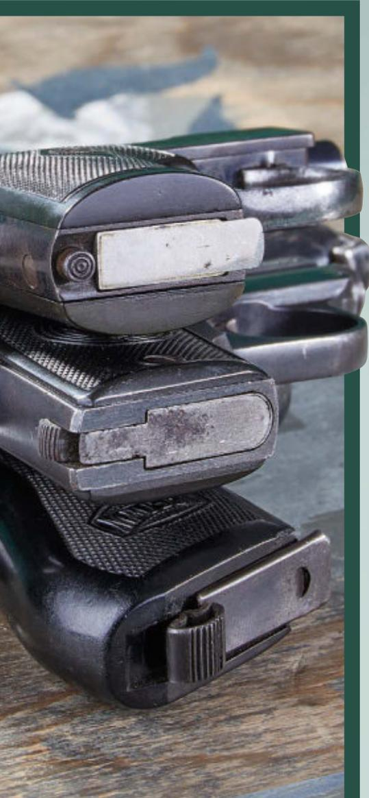
Für die Vielfalt im 6,35er Feld sprechen auch die Designs rund um Magazin und Magazinlöser (v.o.): der erwähnte runde Druckknopf unten im Griff bei Wbley & Scott, eine abwärts zu drückende Taste unten im Griff Rücken bei Steyr und ein nach hinten zu ziehendes Skelett-Element bei Mauser 14/34.
