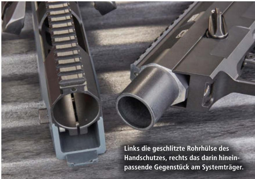
Links die geschlitzte Rohrhülse des Handschutzes, rechts das darin hineinpassende Gegenstück am Systemträger.
