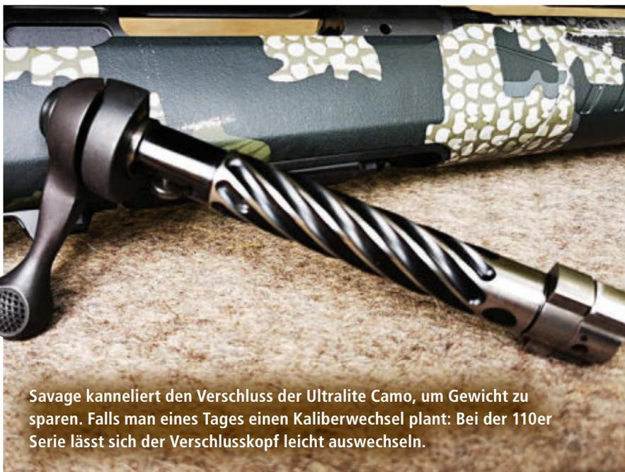
Savage kanneliert den Verschluss der Ultralite Camo, um Gewicht zu sparen. Falls man eines Tages einen Kaliberwechsel plant: Bei der 110er Serie lässt sich der Verschlusskopf leicht auswechseln.
