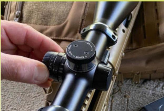
Alle Ranger 8 bieten am linken Turm die Intensitätsregulierung des Leuchtpunktes. Bis auf das 1-8x24 findet sich dort auch der Parallaxenausgleich von 20 m bis Unendlich.
