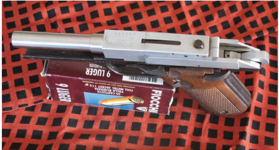
Das Griffstück mit dem montierten Verschlussstück, hinten dran erkennt man das Kupplungs-Teil. Der Hahn der Waffe ist gespannt.
