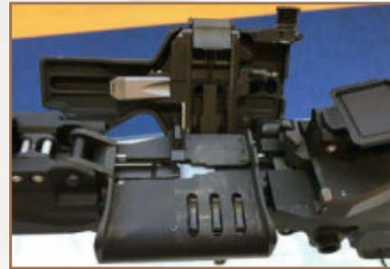
Der Gehäusedeckel des XM250 klappt zur Seite ab, was Ladetätigkeiten bei montierten Optiken und Nachtsichtvorsätzen erleichtert.
