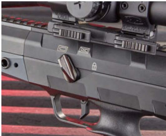
Der Sicherungswahlhebel ist griffig, leichtgängig und beidseitig bedienbar. Zum Laufausbau muss er auf das rechte Symbol zeigen.
