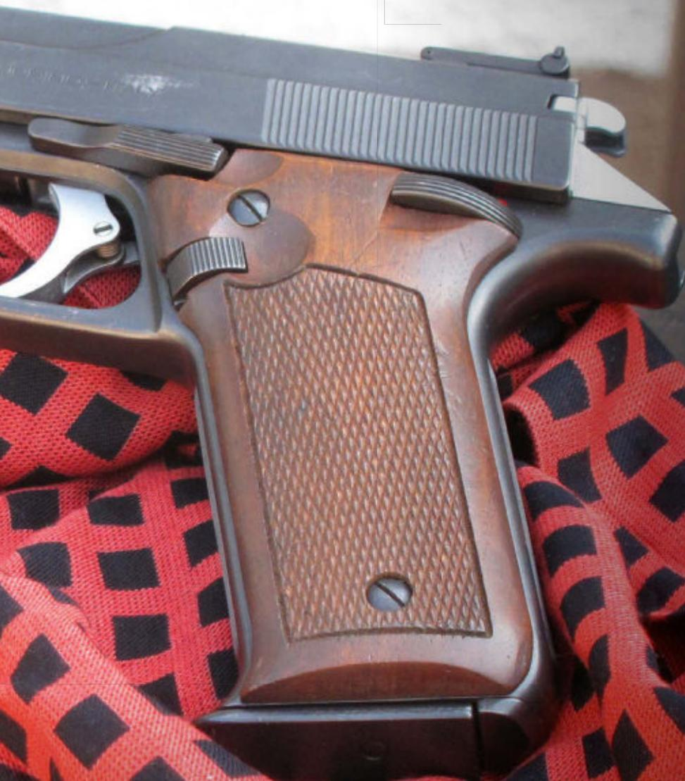
fen: Ähnlich wie bei der Luger steht er im geladenen Zustand hoch und zeigt die Patrone im Lager an. Zusätzlich ist er an der Frontseite etwas eingefräst und dort mit rotem Lack markiert. Gut gedacht, aber etwa so übersichtlich wie die Beschriftung „Geladen“ links am Luger-Auszieher. Kurz: Ob Luger oder Benelli, man schaut besser nach.
