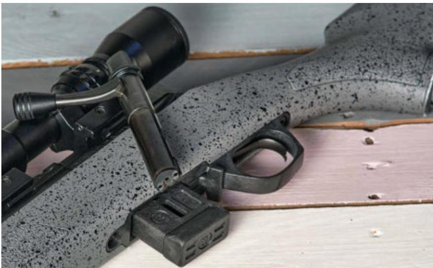
Aus der 22 l.r. -BMR entnommener Verschluss. Rechts daneben die wechselbare Abzugseinheit nach Art der Remington 700. Der Abzugsbügel besteht aus Kunststoff.
