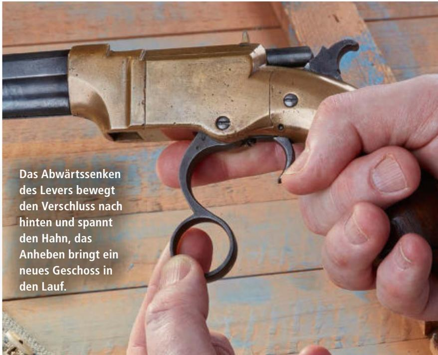
Das Abwärtssenken des Levers bewegt den Verschluss nach hinten und spannt den Hahn, das Anheben bringt ein neues Geschoss in den Lauf.
