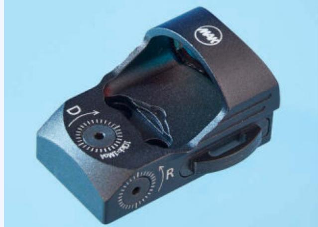
Der Hersteller selbst bezeichnet das MAKdot SH als ein Einstiegsmodell. Die technischen Daten: Preis: 334 Euro, Rotpunkt 3,5 MOA, Klickverstellung 1 MOA per Klick, Batterie: CR 2032, 7 Helligkeitsstufen, Abschaltautomatik.
