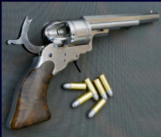
Und noch mehr Nedbal-Arbeiten: Ein detailgetreuer Nachbau einer superraren Conversion-Ausführung des Colt Paterson, ausgeführt im Kaliber .41.
