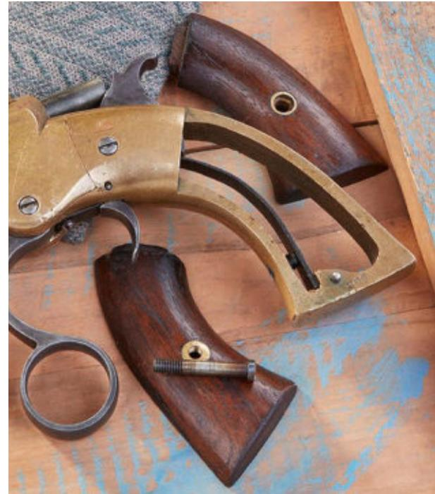
In der Griffspange unter den gefirnissten Nussbaumgriffschalen steckt eine Blattfeder, die nach dem Auslösen den fallenden Hahn antreibt.
