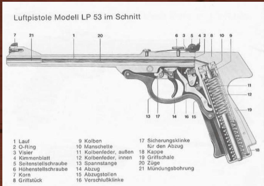
**Schematische Darstellung zur Funktion der Walther LP53, man sieht im Griff die Doppelfeder des Kolbensystems und vorn am Rahmen das Kipplaufsystem.**
