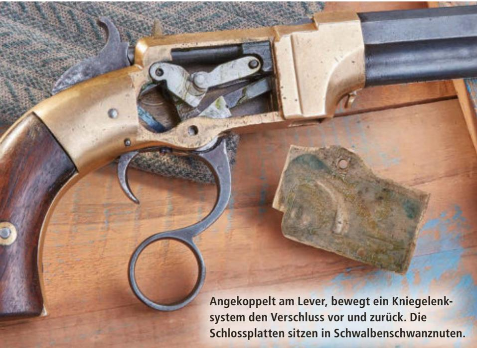
Angekoppelt am Lever, bewegt ein Kniegelenkssystem den Verschluss vor und zurück. Die Schlossplatten sitzen in Schwalbenschwanznuten.
