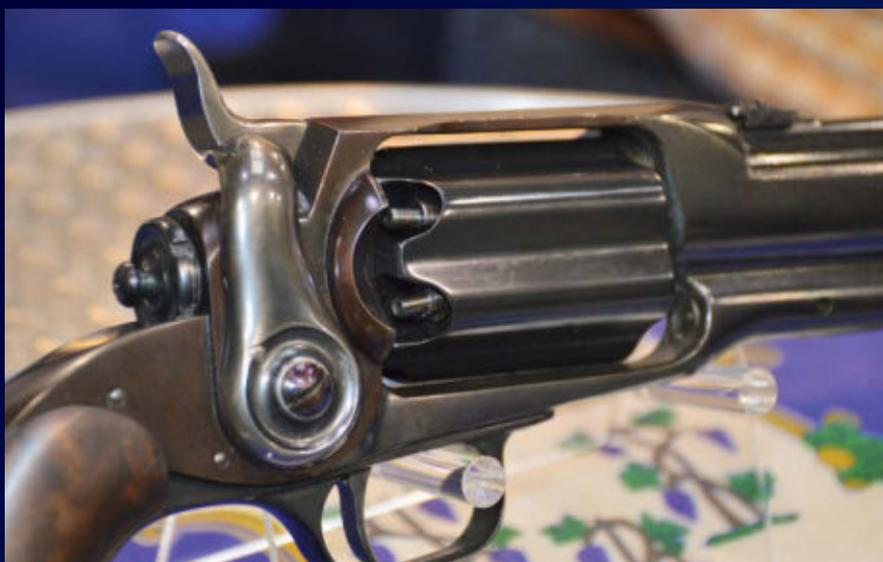
Drei 1855er Merkmale: Der geschlossene Rahmen, die durch Drehen zu lösende, nach hinten ausziehbare Trommelachse und der Seitenhahn.
