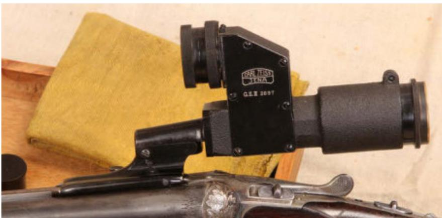
Das aufgesetzte Prismen-Zielfernrohr G.Z. III von Carl Zeiss, waffenseitig auf einer Oberhammer-Prismenschiene geführt.
