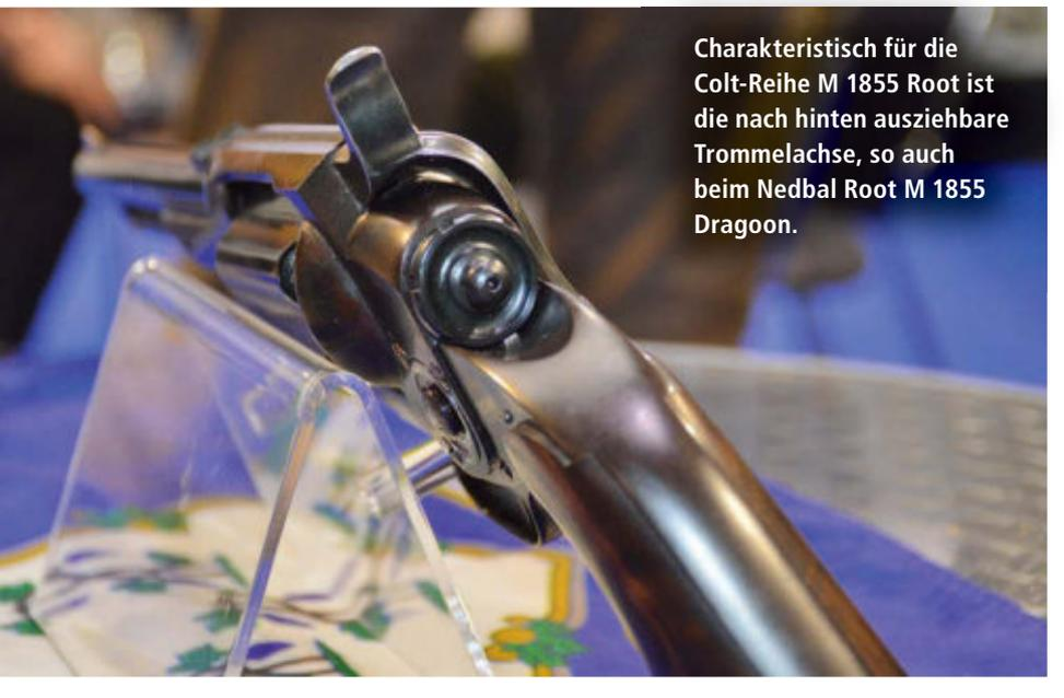
Charakteristisch für die Colt-Reihe M 1855 Root ist die nach hinten ausziehbare Trommelachse, so auch beim Nedbal Root M 1855 Dragoon.
