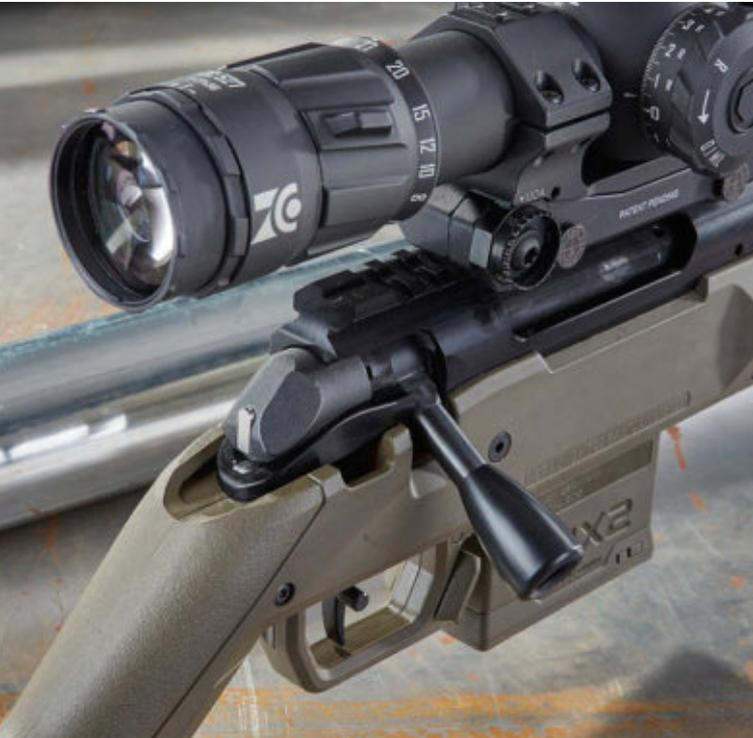
Der Sicherungsschieber der Zwei-Stellungs-Sicherung liegt im Abzugsbügel, hier in der Position „gesichert“ direkt vor dem Abzugszügel. Die Sicherung arbeitet lautlos.
