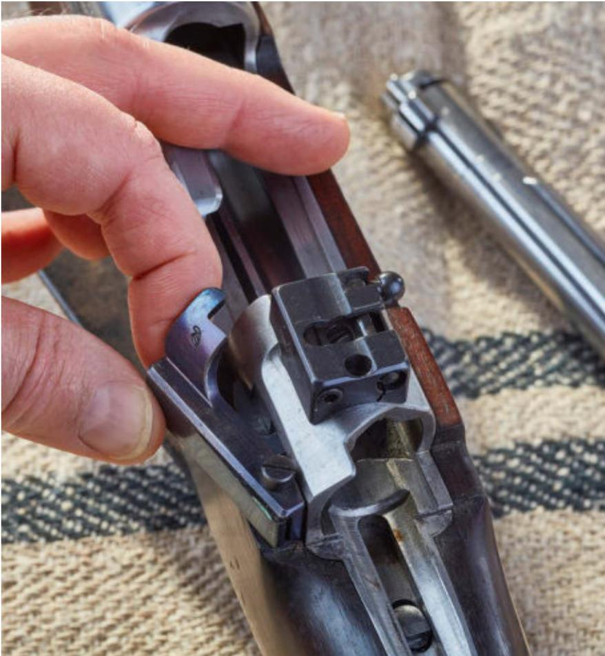
Die Verschlussperre musste einige Quadratmillimeter Fläche lassen, damit die rechtwinklige Ausnehmung die Ecke des hinteren Montagesockels umfasst.
