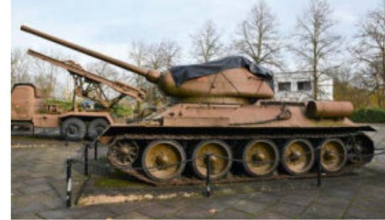
Der Panzer T34/85 war ein späteres Modell des bekannten T34, das über eine 85-mm-Kanone verfügte.
