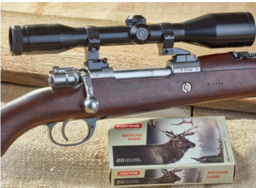
Der Kammerstängel wurde wegen des Zielfernrohres deutlich gekröpft. Und immer noch, nach über 130 Jahren, ist moderne Jagdmunition im Kaliber 7,65 mm Argentino erhältlich. Die ersten Laborierungen der 7,65 x 53 mm datieren aus dem Jahr 1889.
