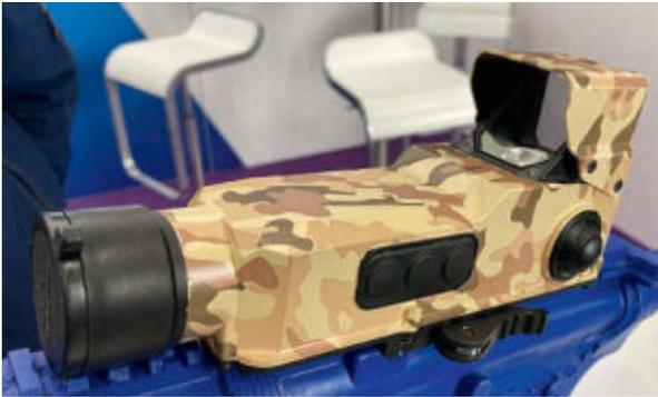
Das Thales Xtraim verbindet Reflexvisier und ungekühltes Wärmebildgerät.
