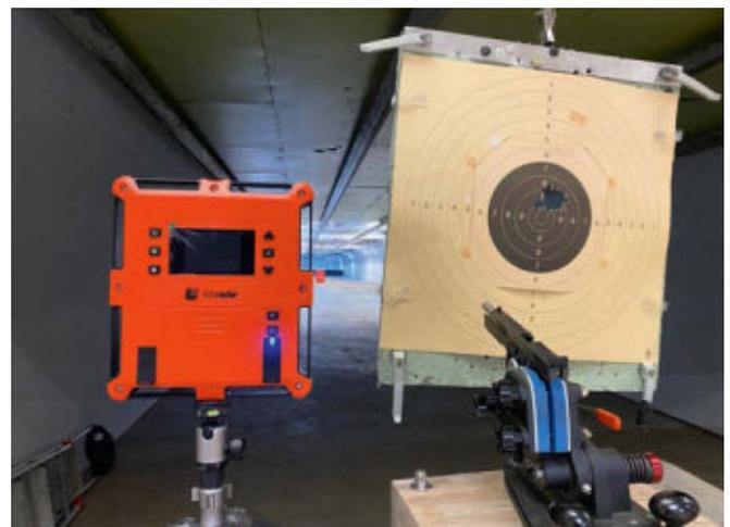
Testaufbau (v.l.): neben dem LabRadar, einem Doppler-Radar als Geschwindigkeitsmessgerät, die Ransom-Rest-Schießmaschine. Bis die Laborierung „steht“, können dutzende Tests nötig sein.
