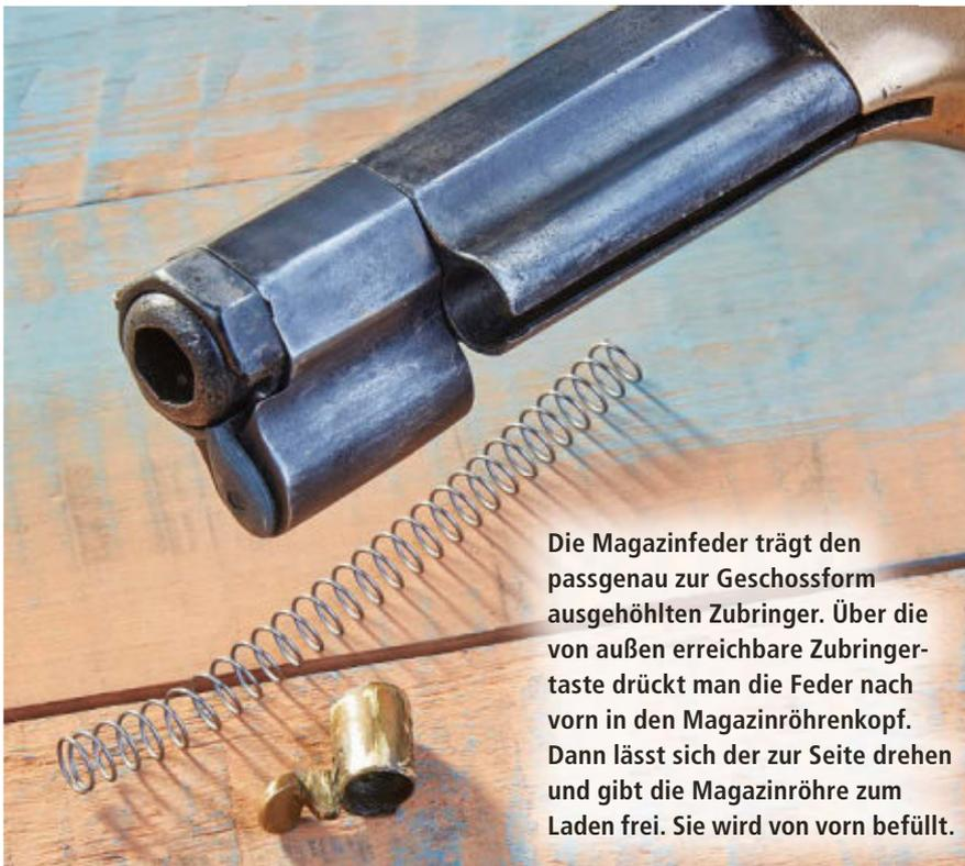
Die Magazinfeder trägt den passgenau zur Geschossform ausgehöhlten Zubringer. Über die von außen erreichbare Zubringertaste drückt man die Feder nach vorn in den Magazinröhrenkopf. Dann lässt sich der zur Seite drehen und gibt die Magazinröhre zum Laden frei. Sie wird von vorn befüllt.
