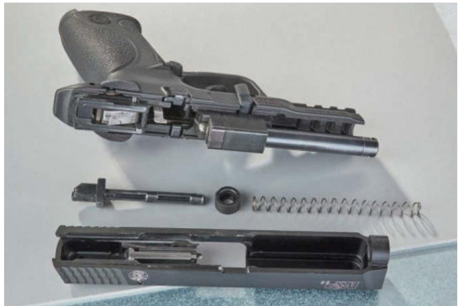
Die M & P 22 in zerlegtem Zustand (v. o.): Griffstück, Schließfederführungsstange, Fixierring, Schließfeder und ganz unten liegt der Leichtmetallverschluss.
