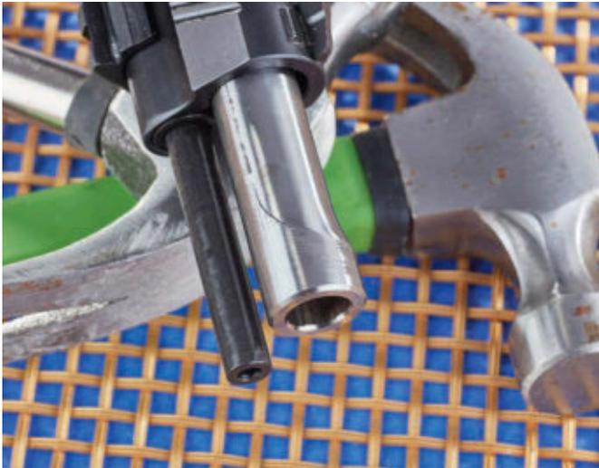
Das Schlibbild des Laufes im Mündungsbereich nach etwa 150 Schuss – nur für das Foto ohne Öl – zeigt die passgenaue Führung der Mündung im Verschluss-Durchlass. Öl ist ein Muss.
