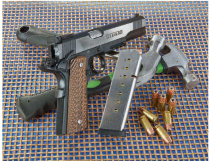
Aufs Wesentliche reduziert: Einwandfreie Funktion mit allen Geschossformen, dazu etwas Luxus in Form der doppelseitigen Flügelsicherung und eines achtschüssigen Meg-Gar-Magazins.
