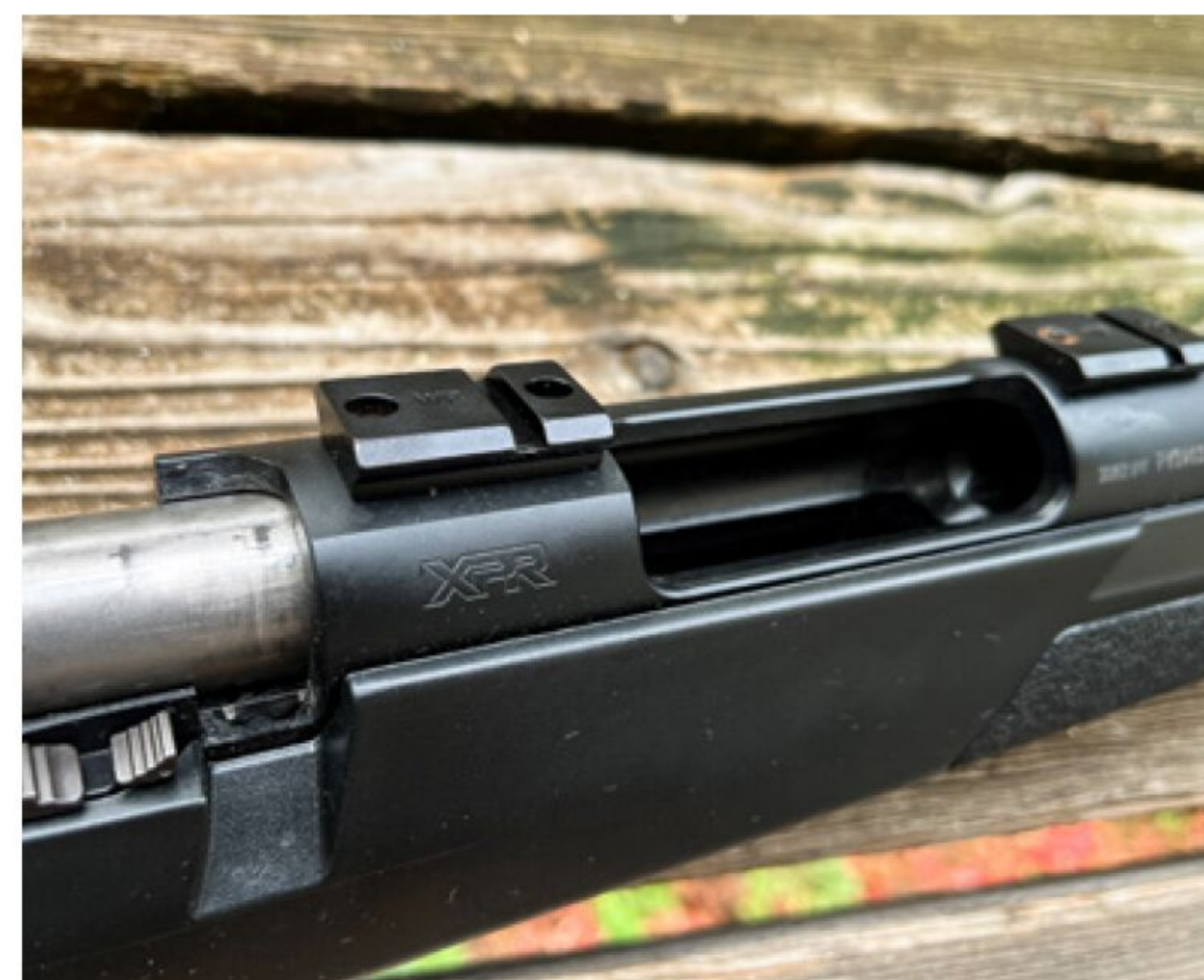
Auf dem robusten Stahlsystem sitzen zwei preisgünstige Picatinny-Basen.
