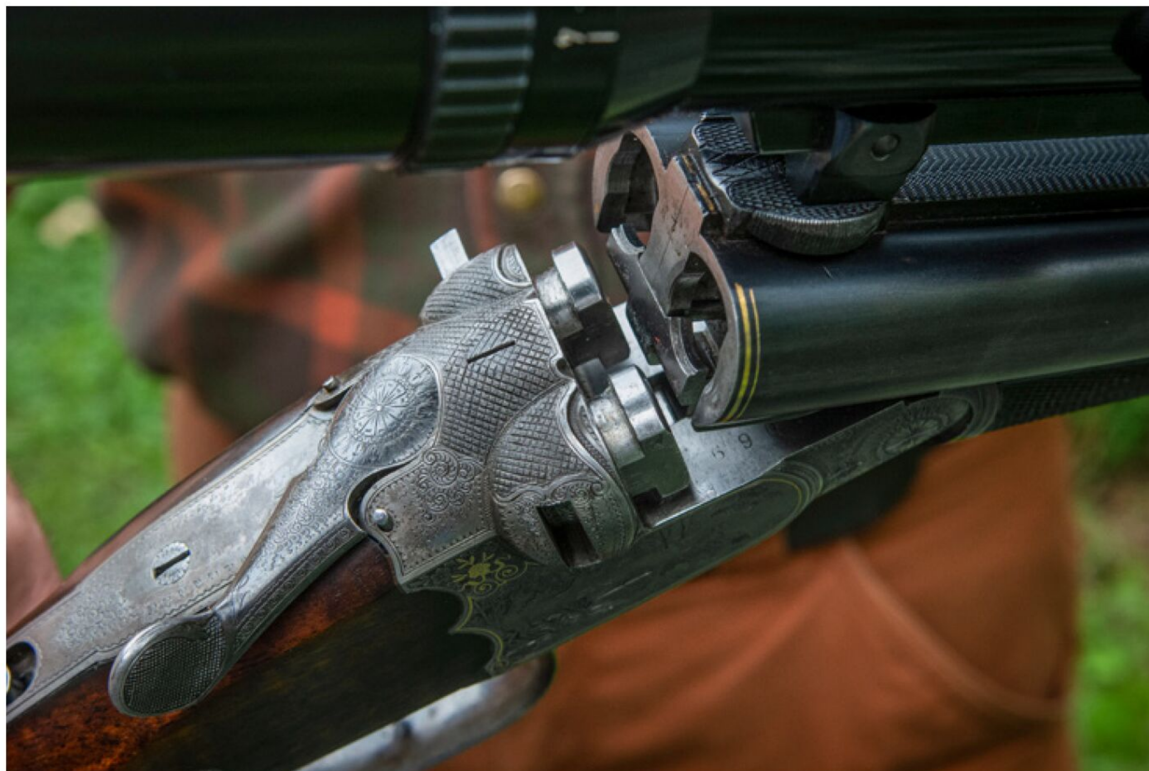
Eine Eyring-Doppelbüchse. Der Zylinderverschluss verriegelt in den Läufen. Gebaut wurde die Waffe um das Jahr 1910.
