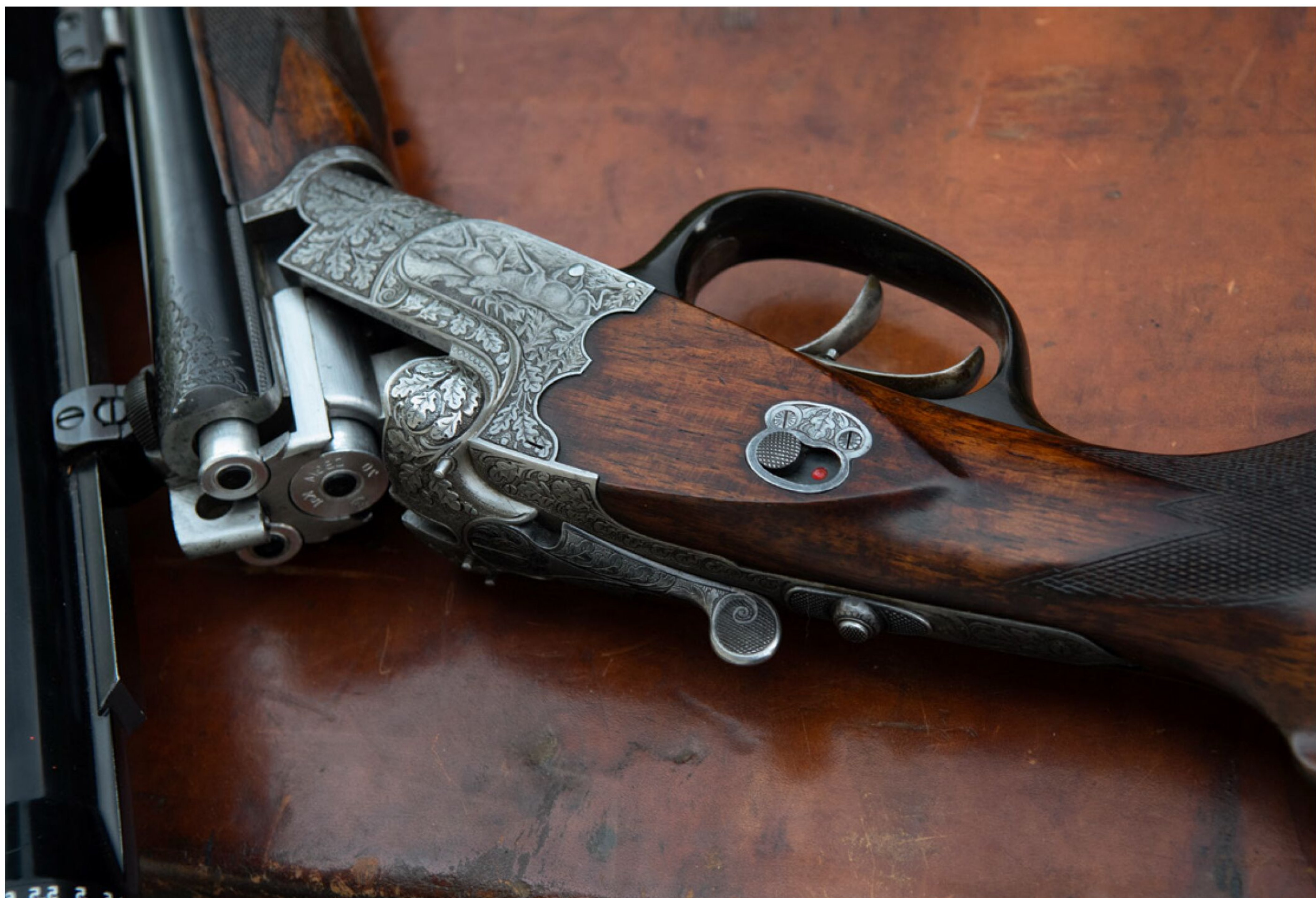
Bockdrilling im Kaliber 7x57 R mit einem 20er Schrotlauf aus dem Hause Schmidt und Hartmann, gebaut im Jahr 1939.
