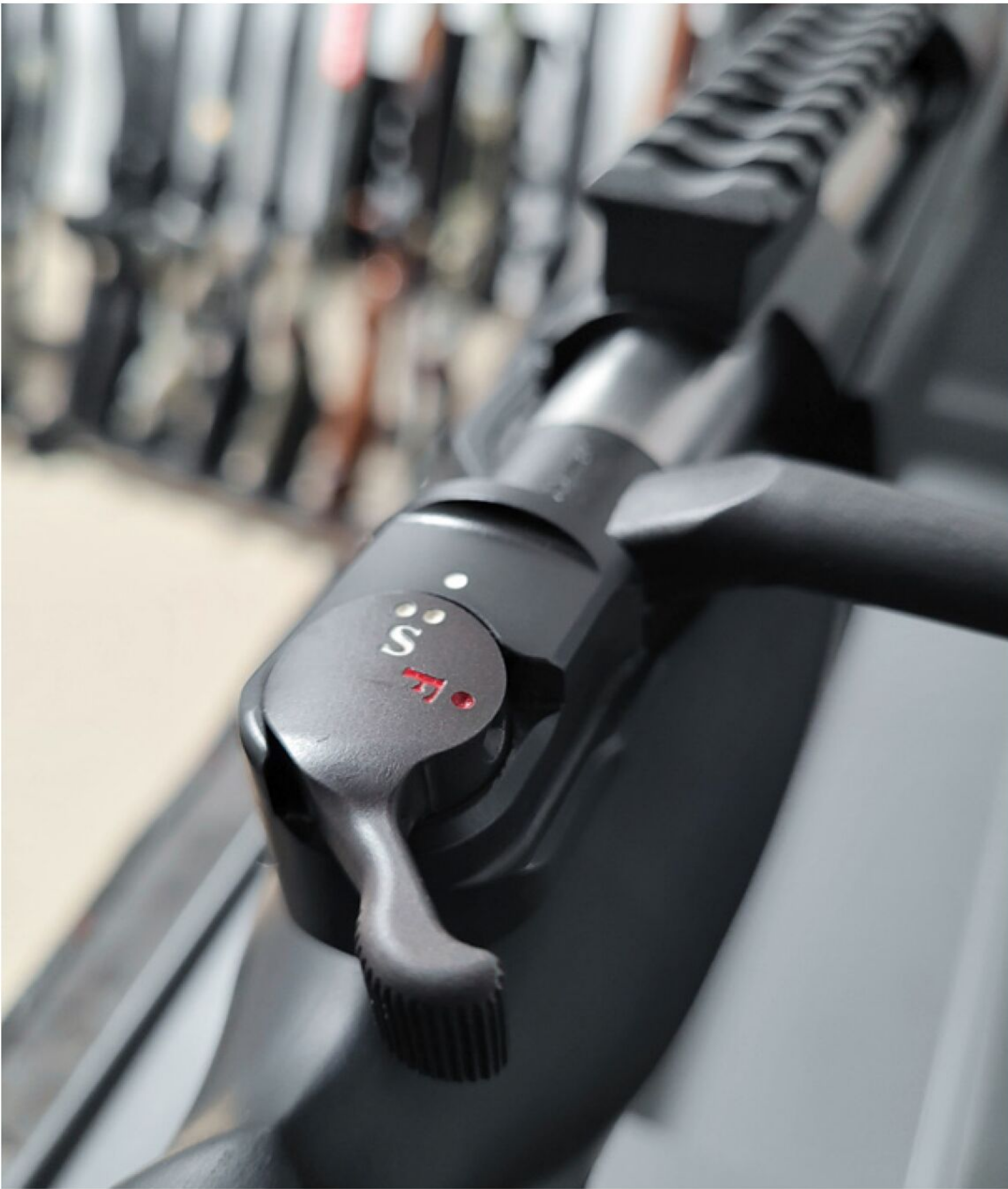
Die modifizierte Flügelsicherung macht die ganze Waffe durch die niedrige Bauhöhe führiger.
