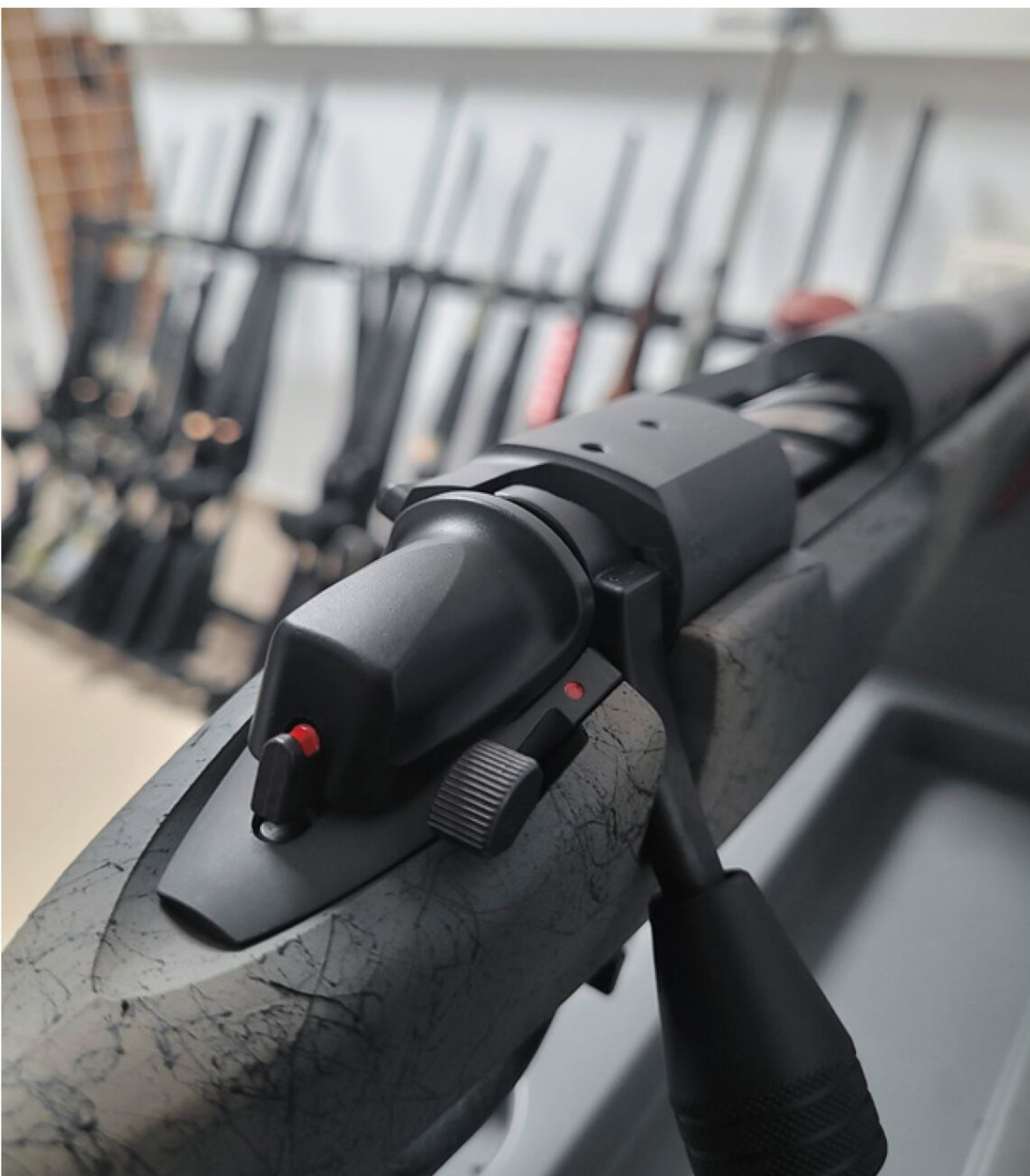
Die Abzugsicherung der Rem. 700 Systeme, wie hier an einer Bergara, ist sehr kompakt.
