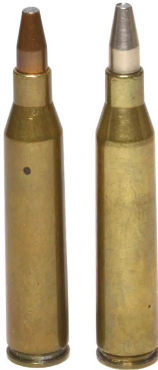
5,6X57 mit dem alten KS-Geschoss mit Flusstahlmantel und dem neuen KS mit Tombakmantel.
