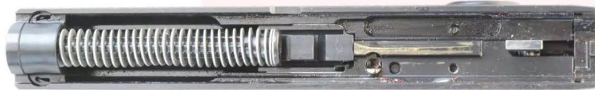
PDP mit schlagbolzengesteuertem Schloss.
