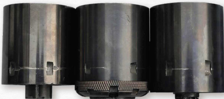
LÄNGENMASSE DER CONVERSIONTROMMELN OHNE TRANSPORTSTERN Von links: Field Conversion (IV.), Trommel der zweiteiligen Werksconversion (III.), Thin-Backplate-Werksconversion (II.)
