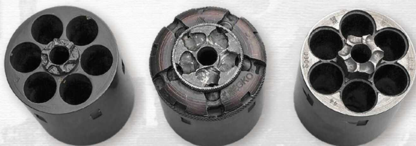
CONVERSIONTROMMELN VON HINTEN Von links: Thin Backplate Werksconversion 6-schüssig .44 Colt (II.); Trommel der zweiteiligen Werksconversion, 5-schüssig .45 Colt (III.); Field Conversion 6-schüssig .44 Special (IV.)
