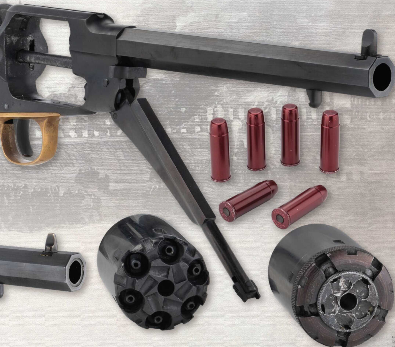
NEDBAL SANTA BARBARA REMINGTON NEW MODEL 1863 ARMY Seriennummer 15224. Unten: Die 6-schüssige Perkus- sionstrommel links sowie die 5-schüssige Patronentrommel rechts (Sammlung Michael van der Meulen).
