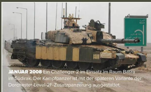
**JANUAR 2008** Ein Challenger 2 im Einsatz im Raum Basra im Südirak. Der Kampfpfanzter ist mit der späteren Variante der Dorchester-Level-2F-Zusatzpanzerung ausgestattet.
