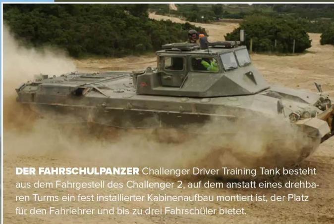
**DER FAHRSCHULPANZER** Challenger Driver Training Tank besteht aus dem Fahrgestell des Challenger 2, auf dem anstatt eines drehbaren Turms ein fest installierter Kabinenaufbau montiert ist, der Platz für den Fahrlehrer und bis zu drei Fahrschüler bietet.
