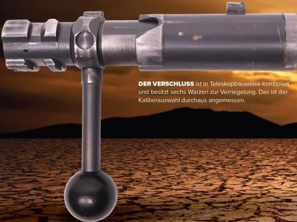
**DER VERSCHLUSS** ist in Teleskopbauweise konzipiert und besitzt sechs Warzen zur Verriegelung. Das ist der Kaliberauswahl durchaus angemessen.
