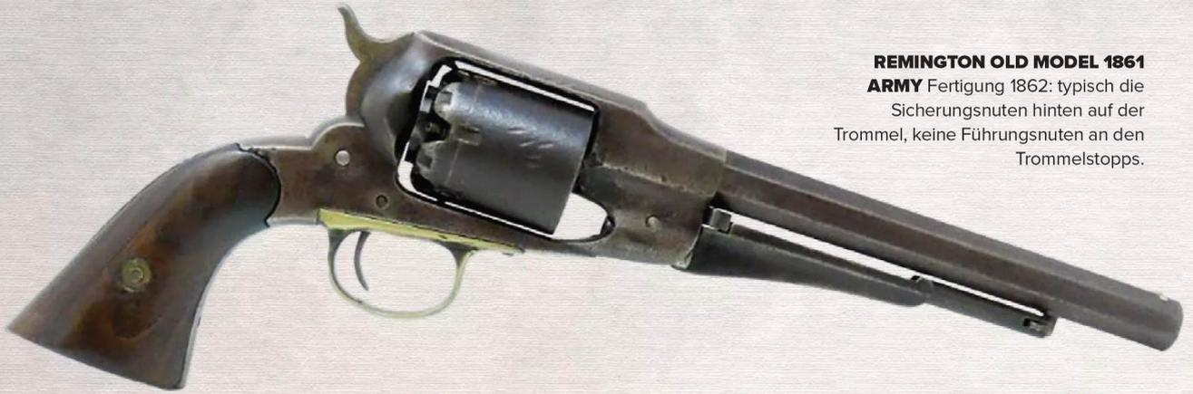
**REMINGTON OLD MODEL 1861 ARMY** Fertigung 1862: typisch die Sicherungsnuten hinten auf der Trommel, keine Führungsnuten an den Trommelstopps.
