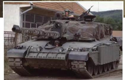
**DIE PASSIVE CHOBHAM-ZUSATZ-PANZERUNG** ist im Bereich der Seiten-schürzen des Fahrzeugs angebracht, eine Reaktivpanzerung vom Typ ROMOR-A an der Wannenvorderfront.
